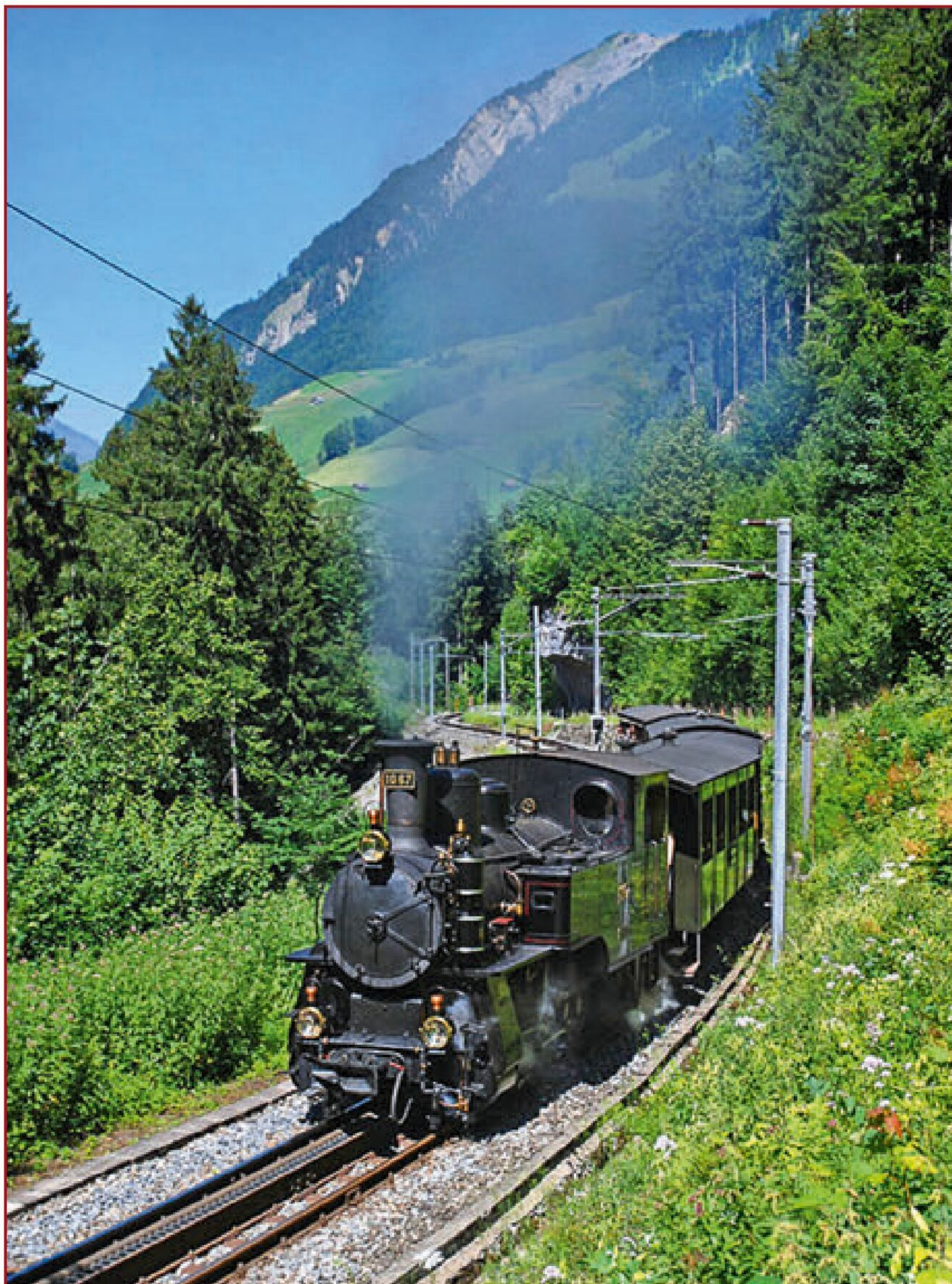
Voller Einsatz: Auf dem Weg zum Brünig-Pass kommt der Zahnstangenantrieb zum Einsatz – auch mit dem LGB Modell ist echter Zahnradbetrieb wie im Vorbild möglich.
