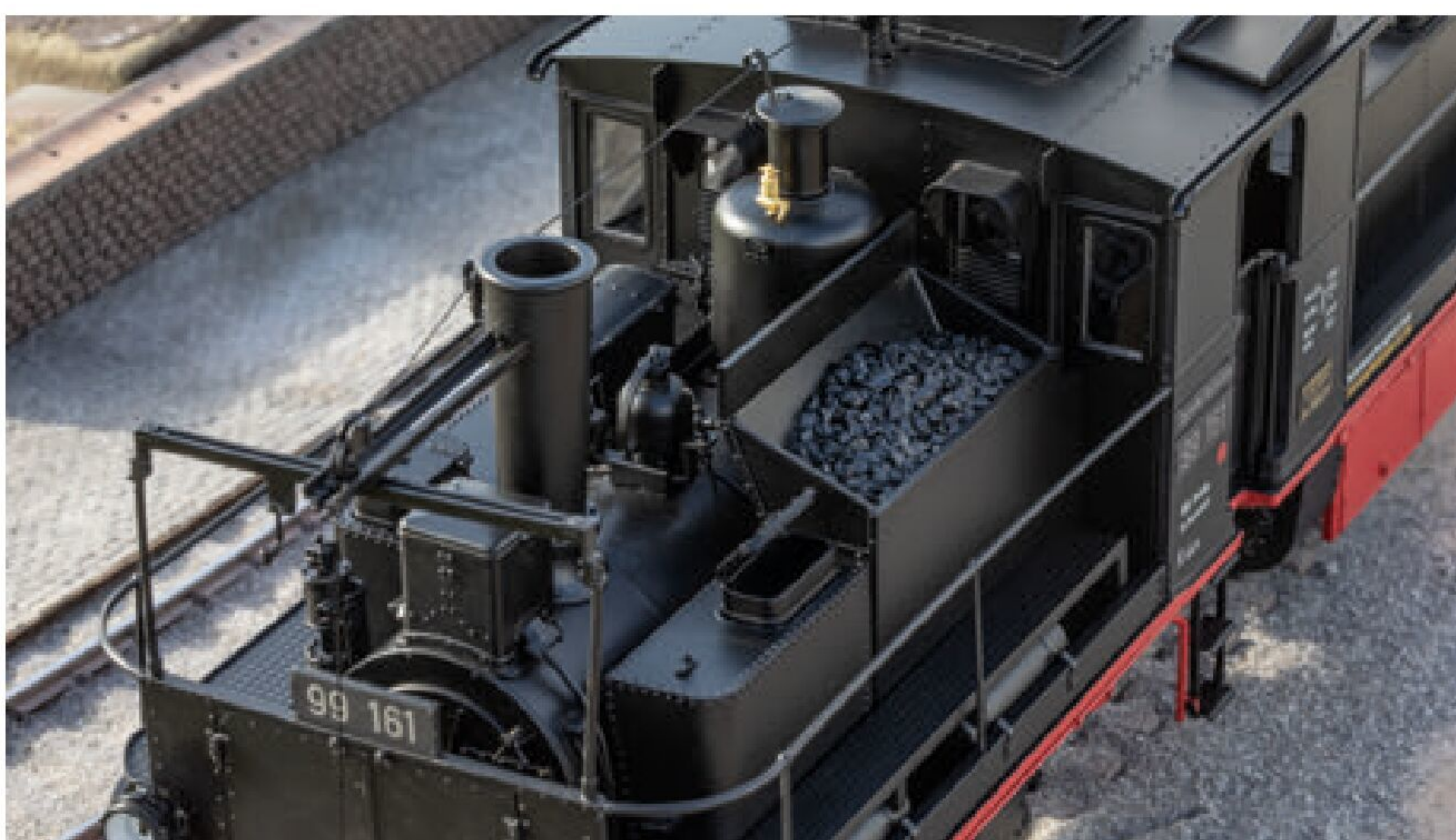
Unverkleidet: Die Überdachung wurde in den 1920er-Jahren entfernt – die Epoche III-Version gibt diesen Betriebszustand inklusive Druckluftbremse und Lichtmaschine wieder.
