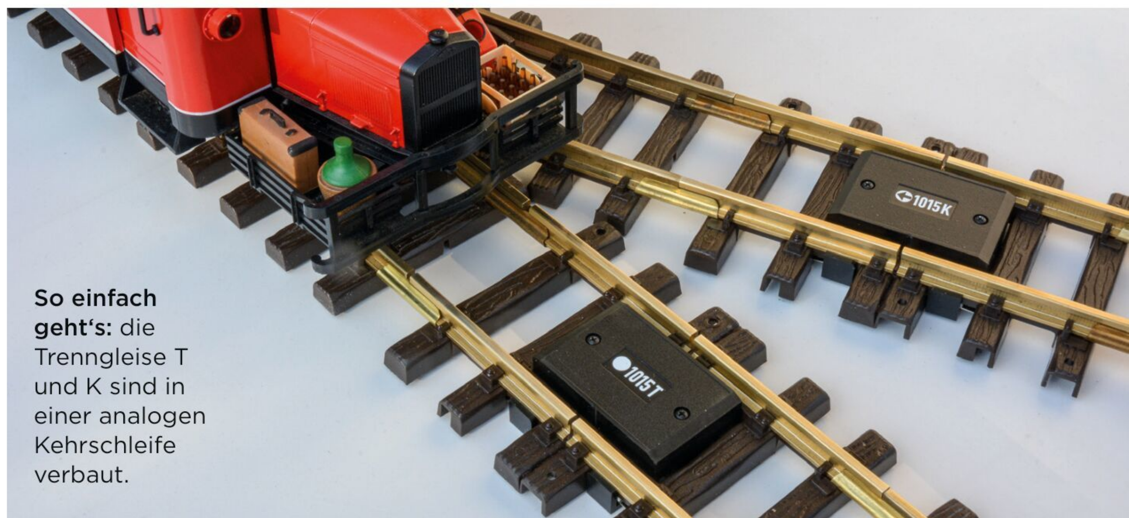
Set 10151: Mit den 15 cm langen Trenngleisen (T und K) kann einfach eine analoge Kehrschleife aufgebaut werden.
