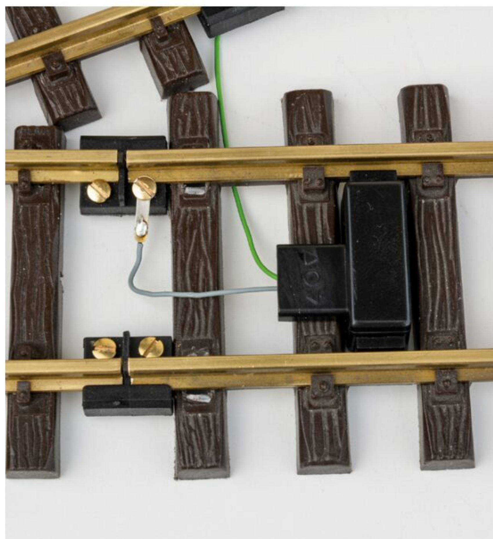
Variante 3: Beispielhafte Kehrschleifensteuerung mit Kontakten. Die grüne Litze geht an Sens 1. Der Abstand zwischen Gleiskontakt und Trennstelle sollte auf der Anlage jedoch größer sein.
