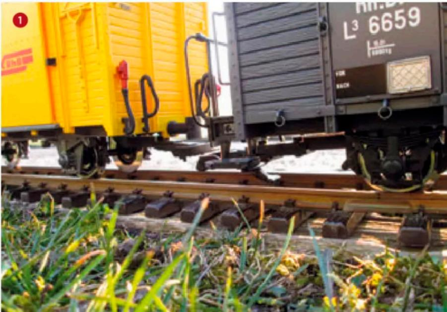
Der graue Wagen steht auf einem abgeknickten Schienenstoß. Da hilft ein gezieltes Unterfüttern des Gleises.
