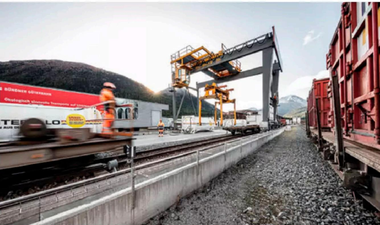
Zum GUZO gehört ein weithin sichtbarer Portalkran aus dem Jahr 1999 mit einem Traggewicht von 30 Tonnen – dazu eine Umschlaghalle mit gedeckter Umladerampe.
