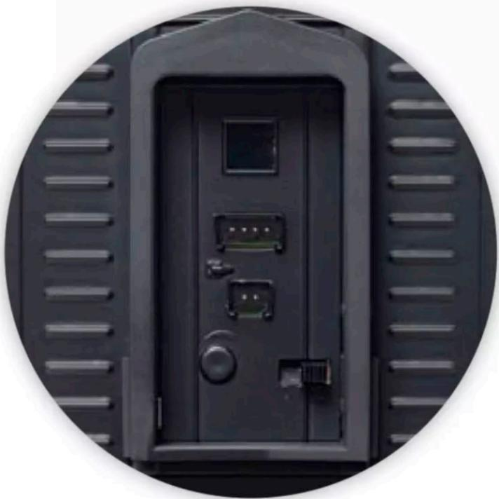
**Kontaktfreudig:** Der zweipolige Anschluss ist für den Fahrstrom, der vierpolige für die Sound- und die Mehrzug-elektronik.
