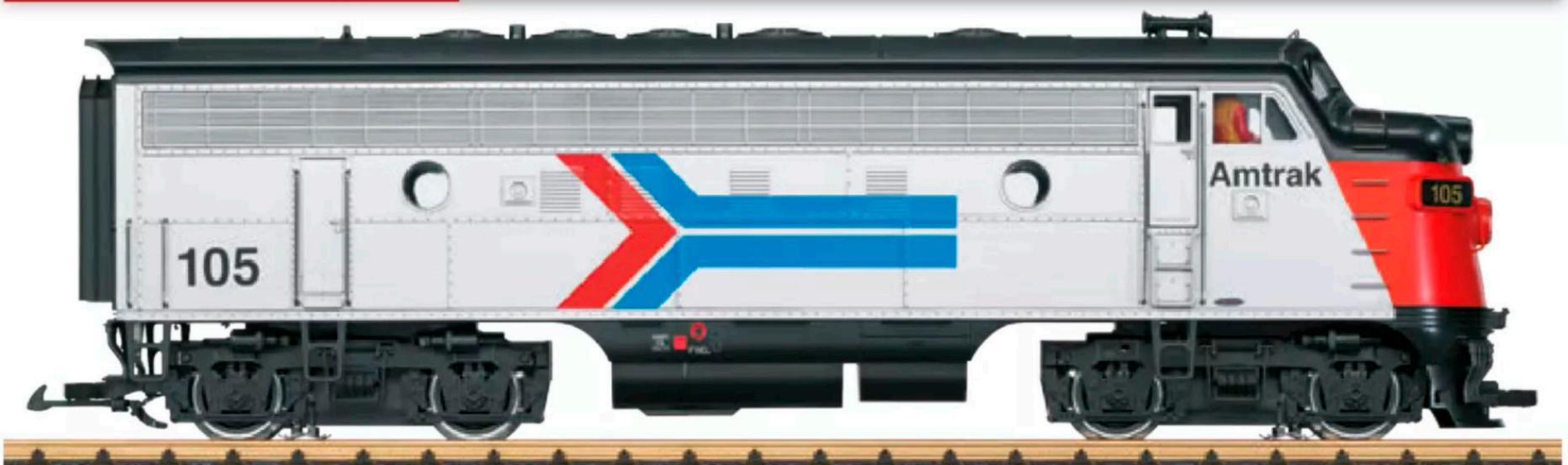
**Kräftig:** Zwei Bühler-Motoren treiben die vier Achsen an beiden Drehgestellen der F7A an.
