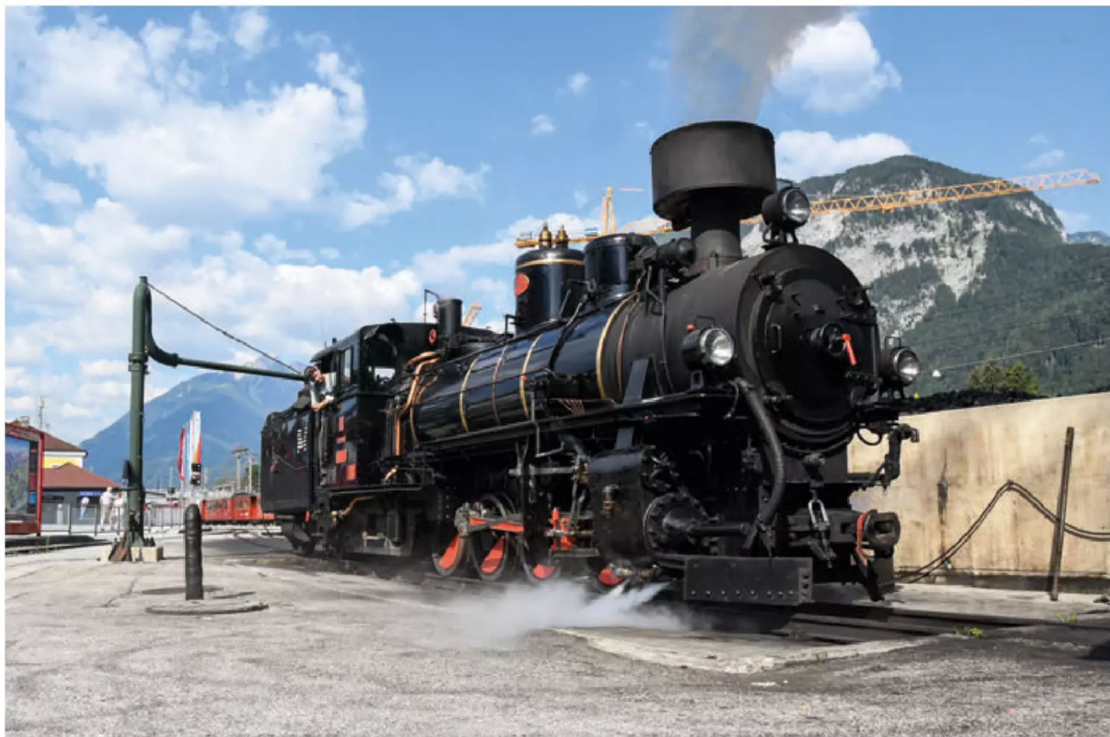
Zum Frühstück erst mal auftanken: Lok 4 III wird vor dem Heizhaus Jenbach für den Tagesdienst hergerichtet. Ihr Wasser bezieht die imposante Veteranin über einen historischen Wasserkran aus einem Tiefbrunnen.
