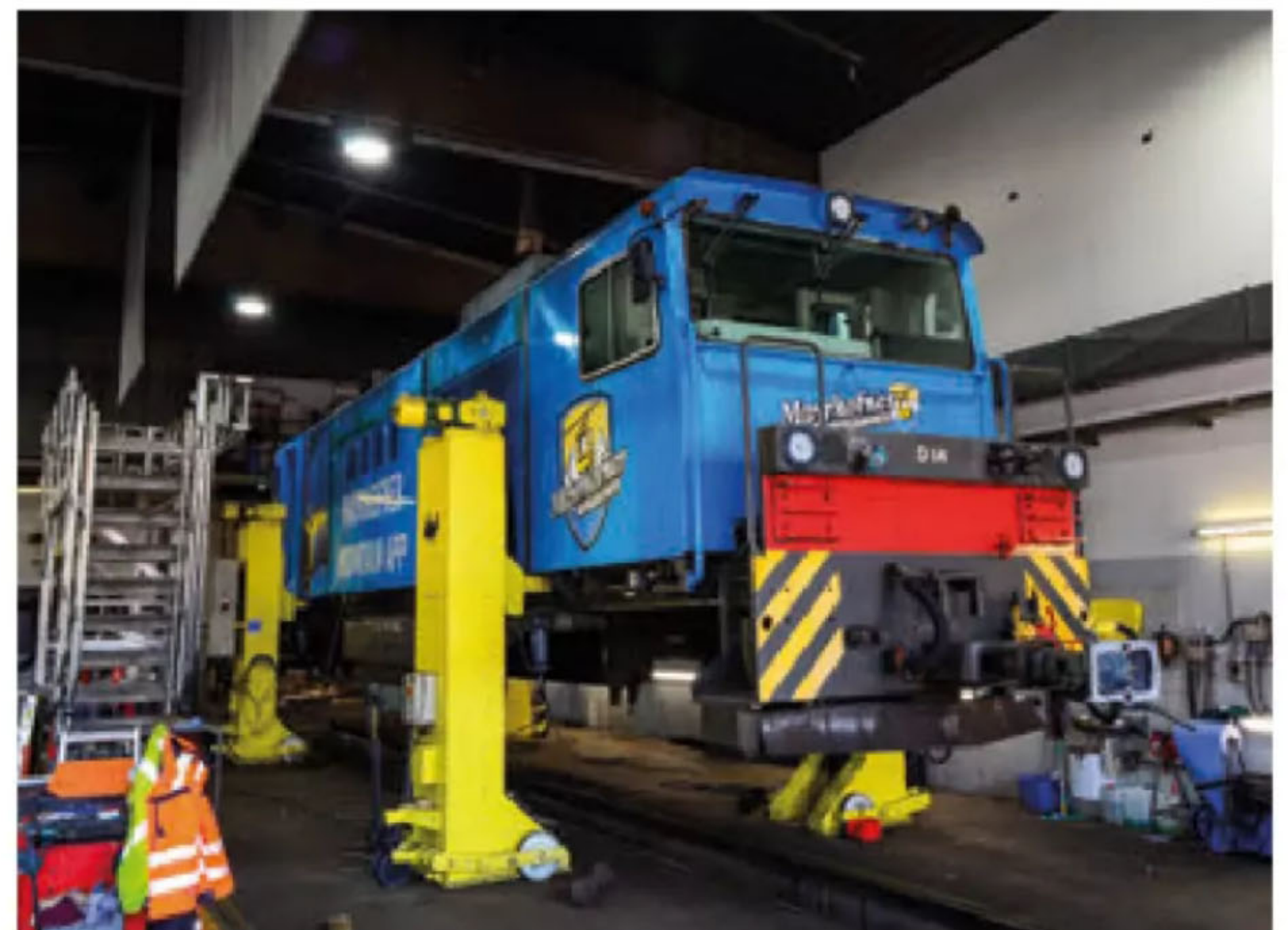
50 Tonnen auf vier Hebeböcken: Die D14 „Penkenbahn“ macht im Bahnbetriebswerk Jenbach Station für eine planmäßige Revision.
