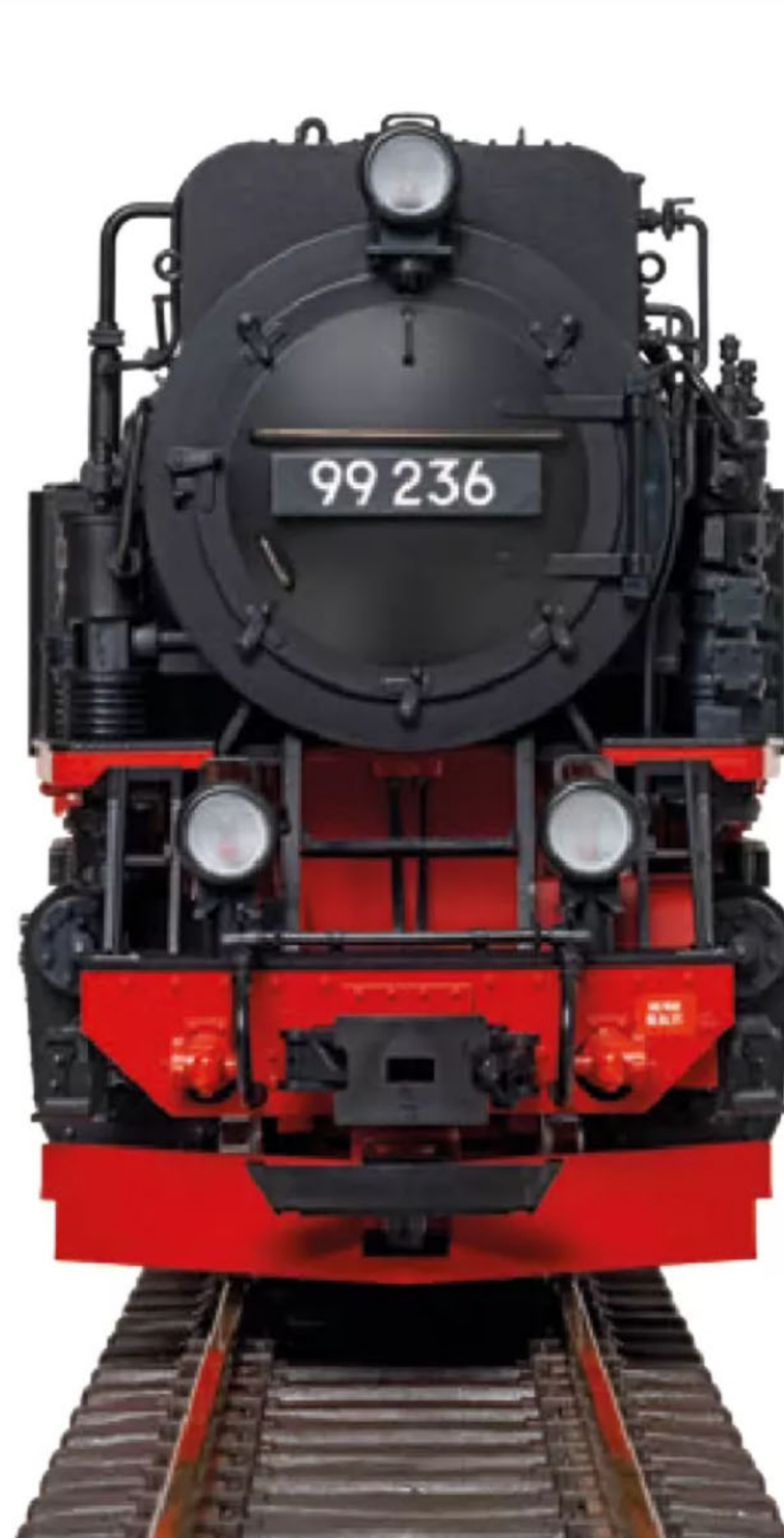
Typisch: Der Mischvorwärmkasten über der Rauchkammer ist ein markantes Erkennungszeichen der Neubaulok.
