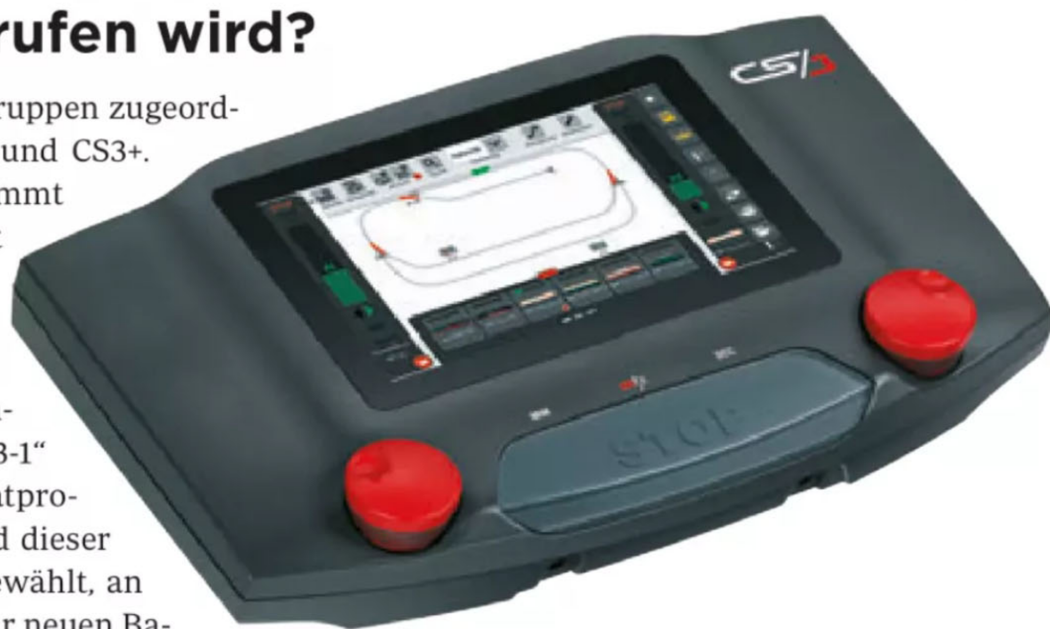
Neugruppierung: Mit der Funktion „Transfer an“ wird an der CS3 (LGB 60226) die Zuordnung der Rückmeldekontakte in eine andere Gruppe vorgenommen.
