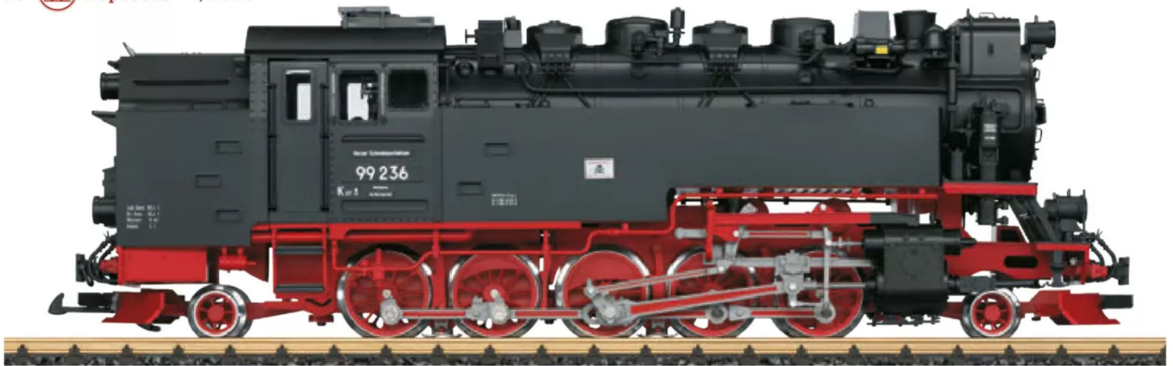
Kraftvoll: Zwei kräftige Bühler-Motoren treiben fünf Treibradsätze der mächtigen Dampflokomotive an.
