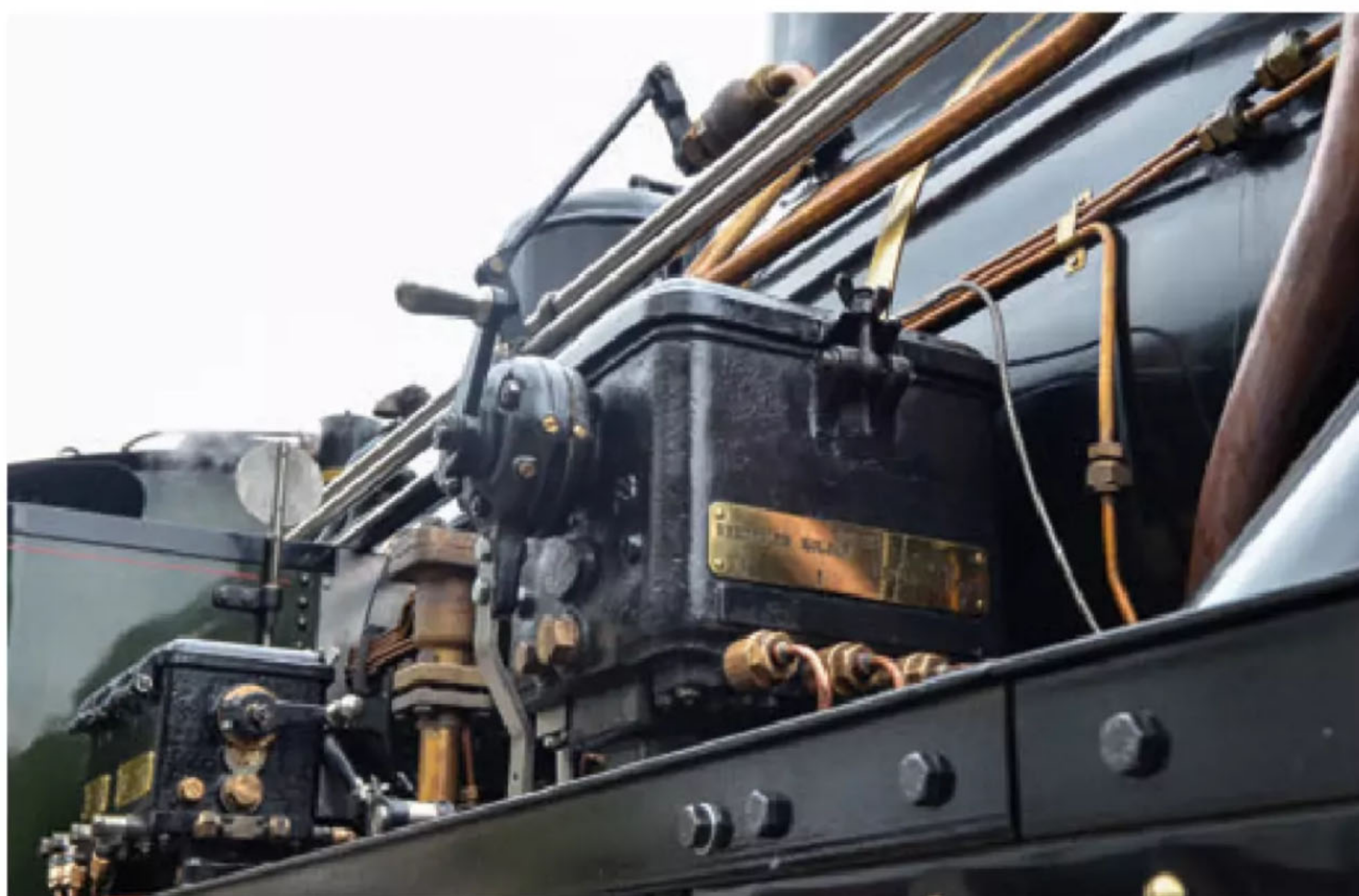
Ein Kunstwerk für sich: Die zahlreichen Zuleitungen für die Kolben rechts und die Schieber (hinten und vorn) sind komplett neu und in Messing ausgeführt.
