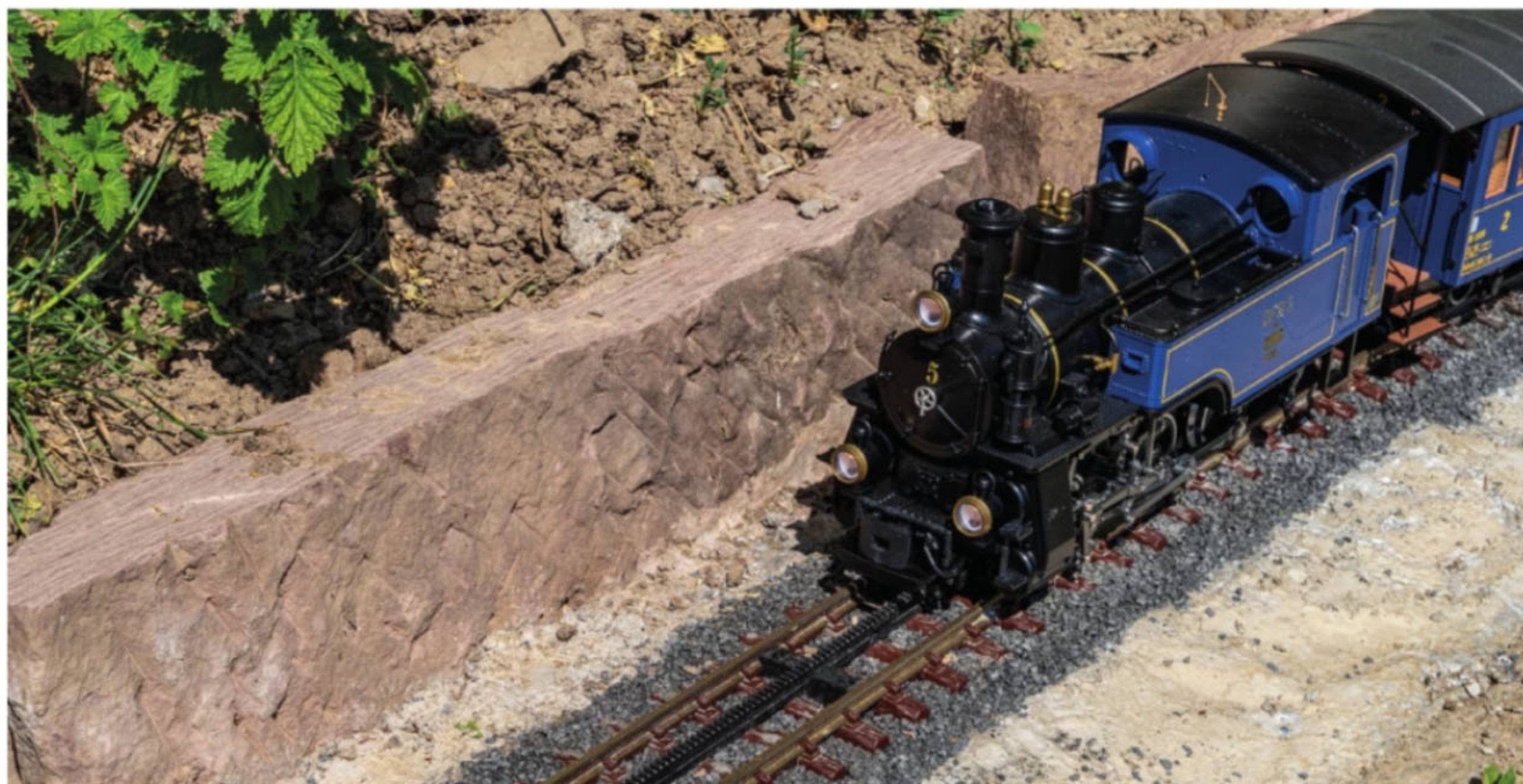
Locker: Mit Zahnstangen-Unterstützung schaffen LGB Zahnradloks problemlos Steigungen von zwölf Prozent.
