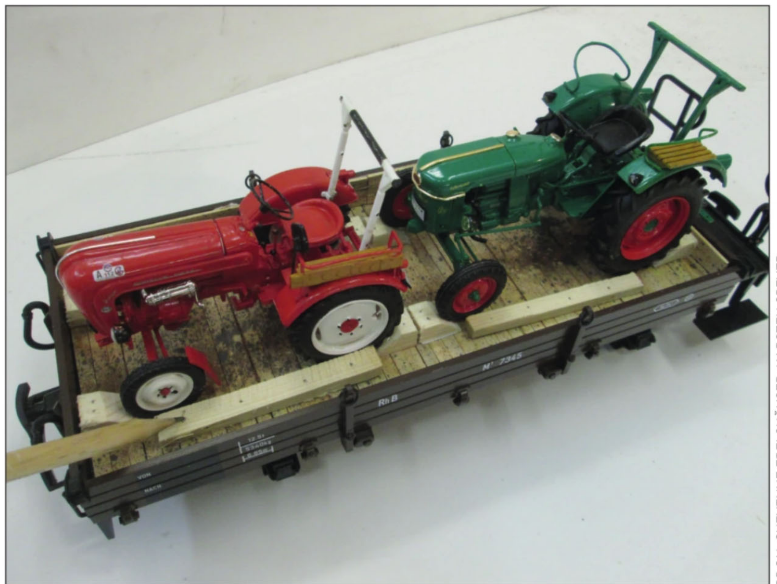
Sicherung: Festlegehölzer und Radvorleger sichern die Ladung.
