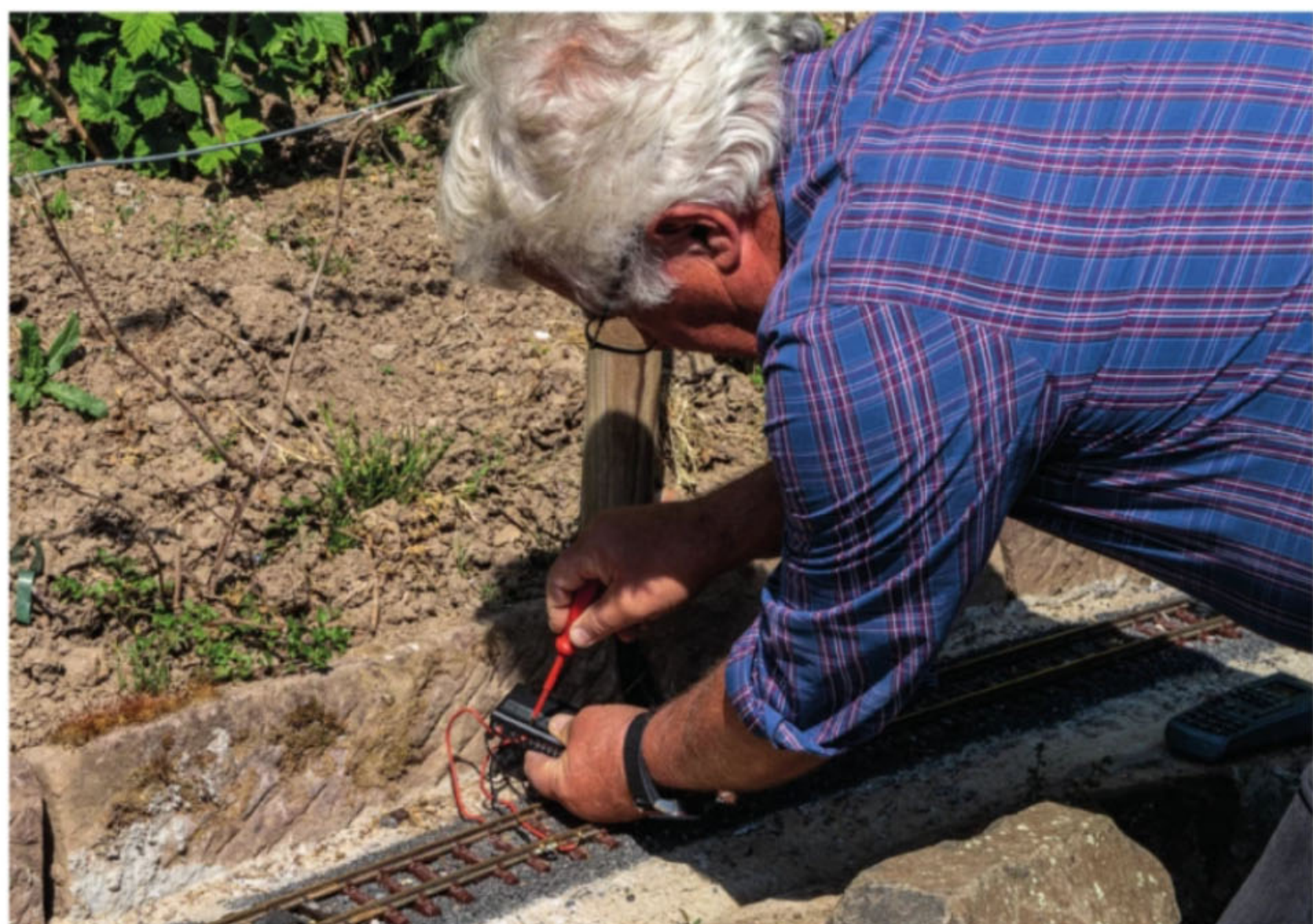
Kabelarbeit: Nach dem Einschottern kommt die Elektrik dran. Hier wird der Vierkanal-Weichendecoder angeschlossen.
