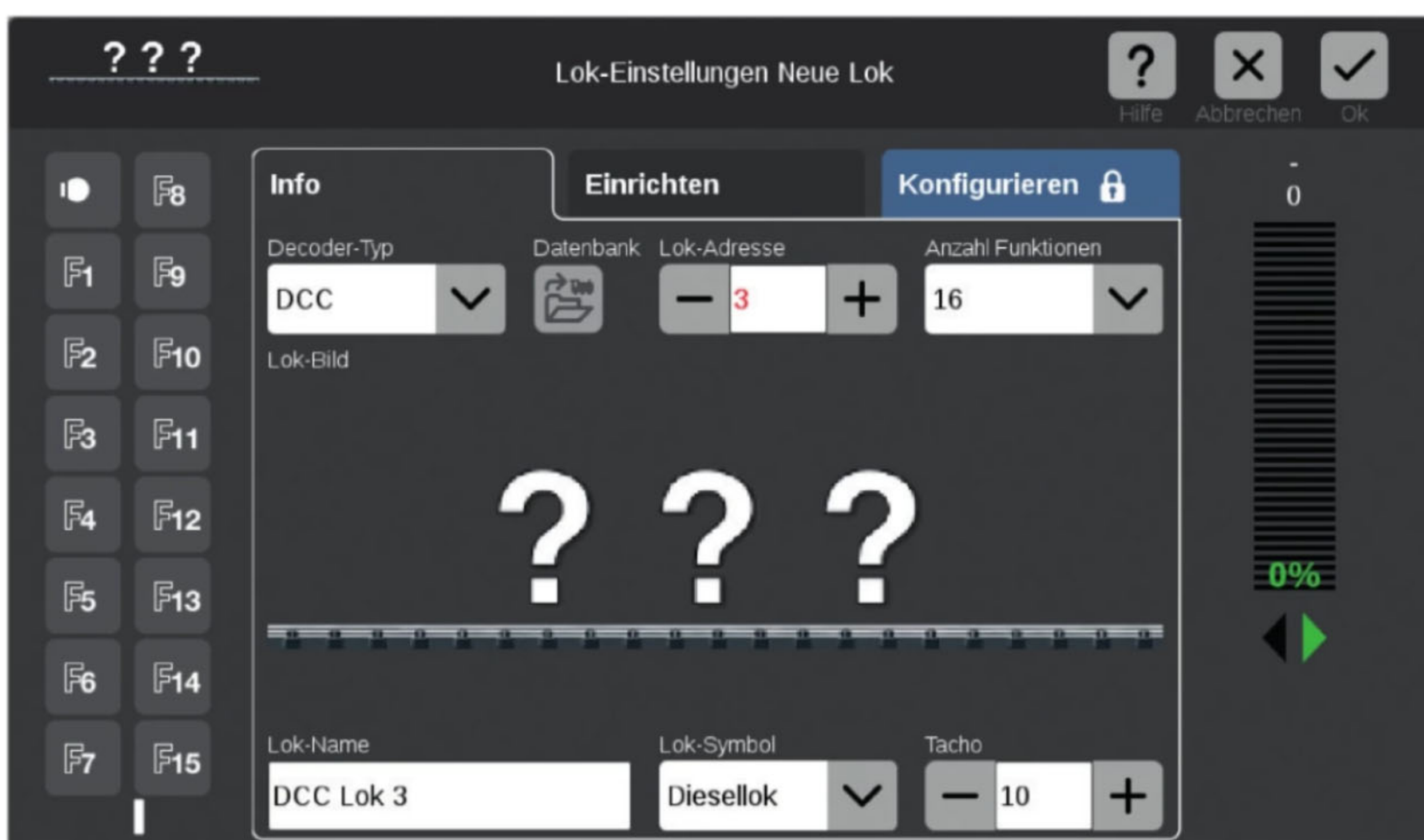
Neue Lokomotive: In den Lok-Einstellungen werden die wichtigsten Parameter der Lokomotiven eingestellt – besonders Decoder-Typ und Lok-Adresse müssen korrekt sein.
