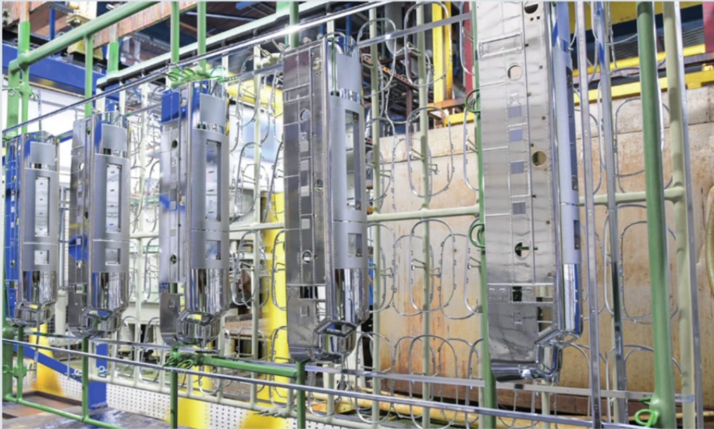
Fertig: Die verchromten F7-Lokkästen haben sämtliche Bäder des Veredelungsprozesses durchlaufen.
