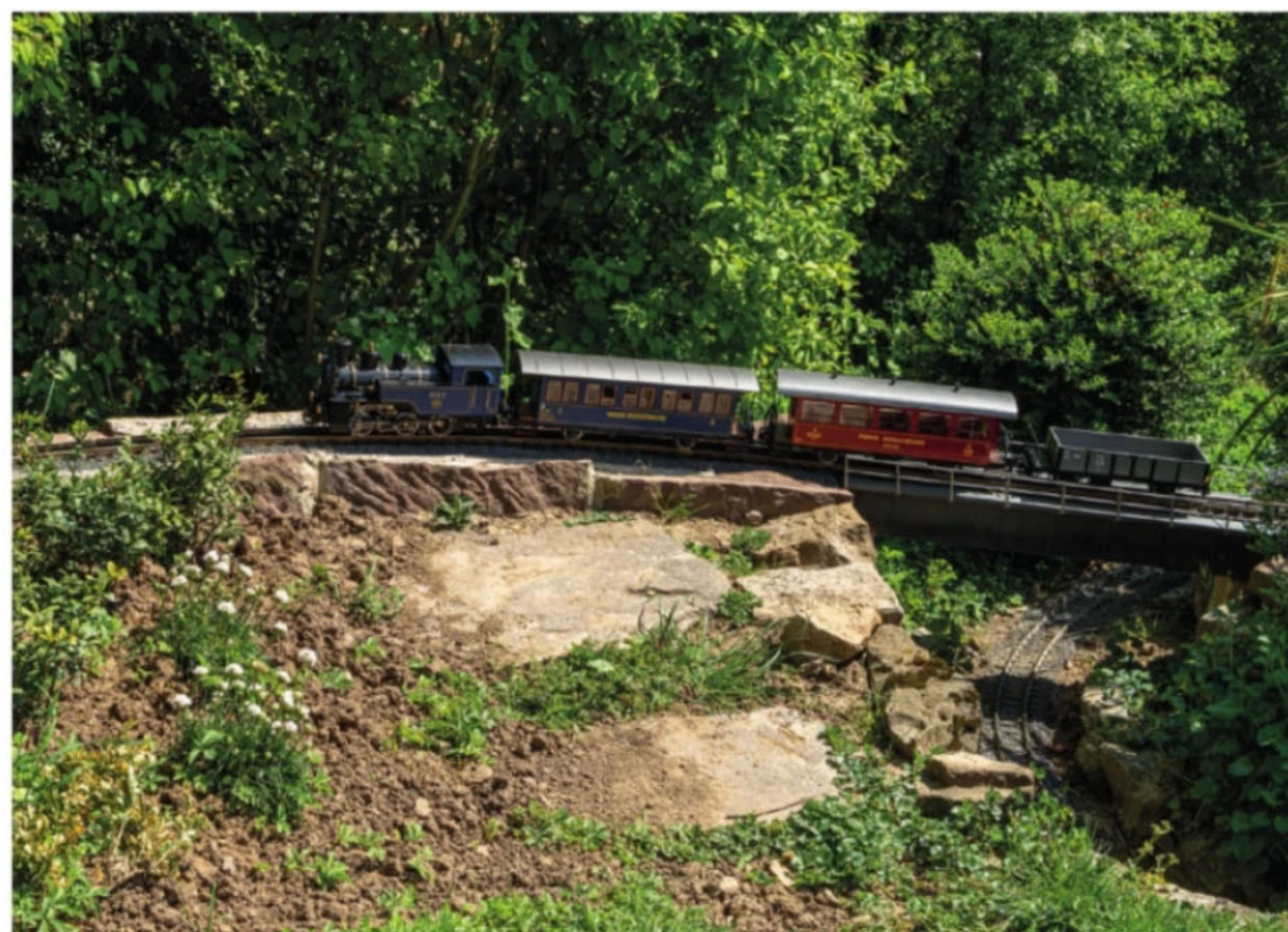
Sanfte Biegung: In den Kurven der Zahnradstrecke verlegte Uwe Müller R5-Gleise.
