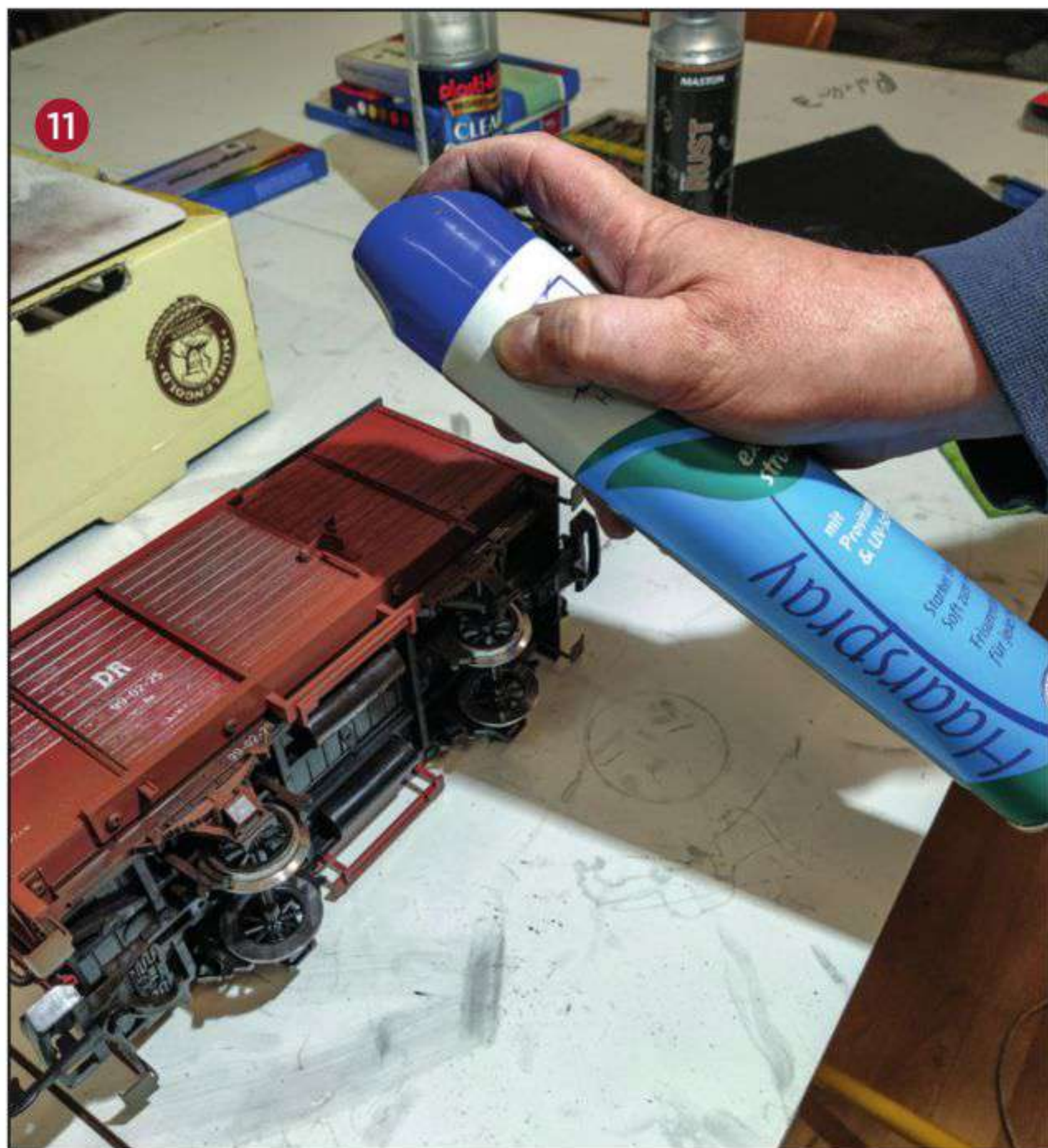
Haftung: Haarspray schützt die Grafit-schicht bei Indoor-Einsätzen.
