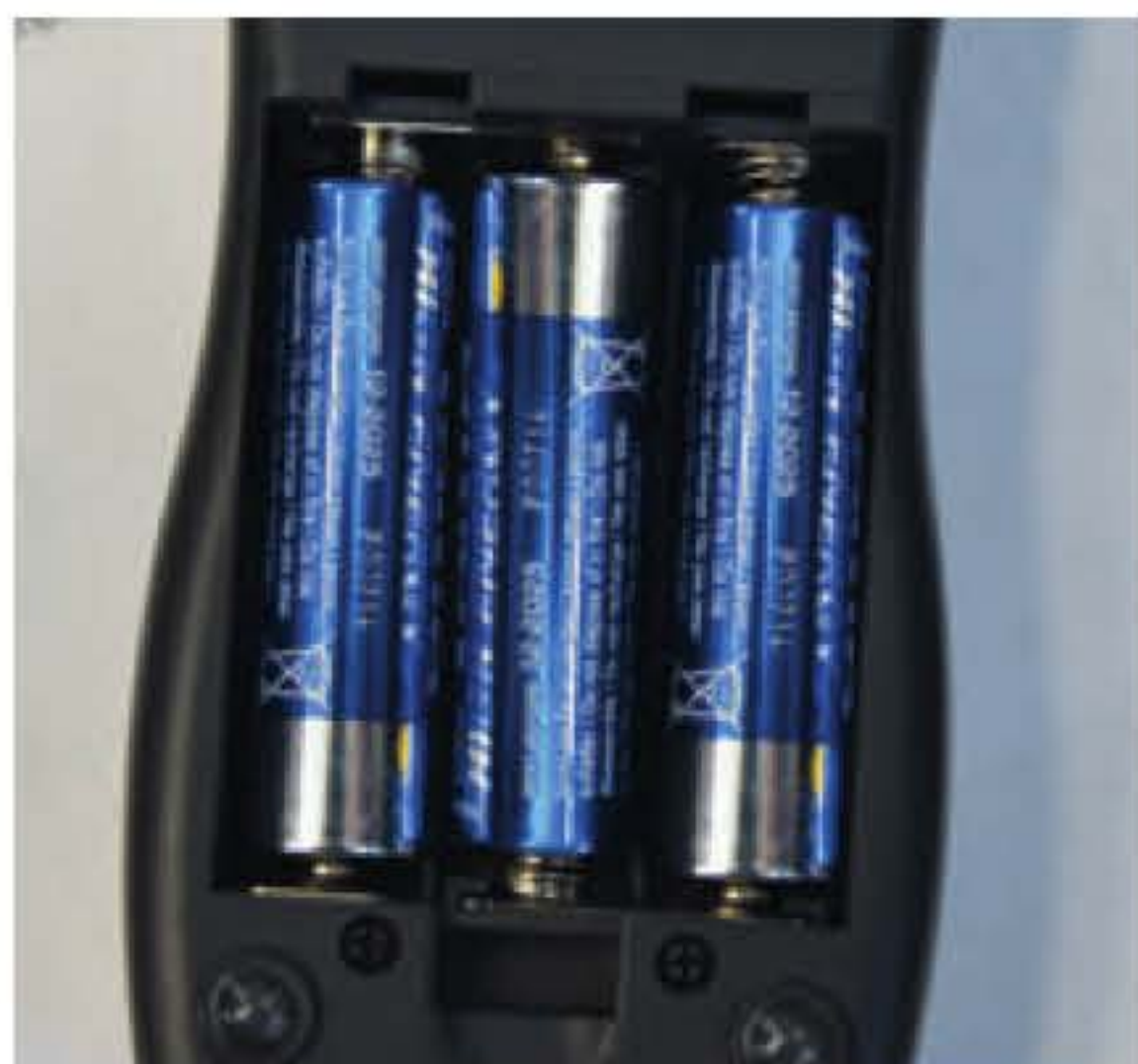
Kabellose Freiheit: Drei Batterien vom Typ AA versorgen den RC3 Funkhandsender mit Strom.
