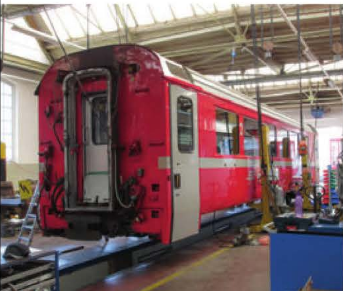
Rollmaterial: Noch fehlen die Drehgestelle.
