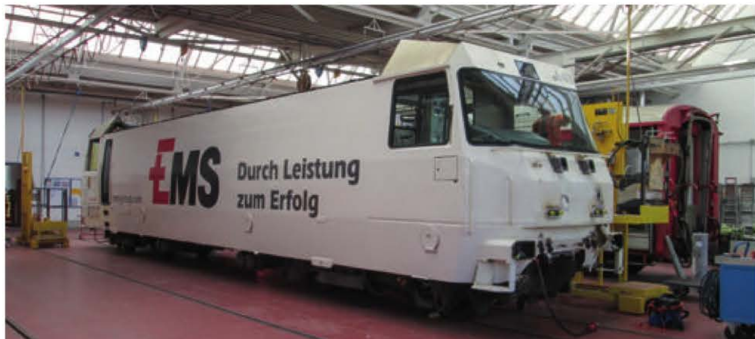
Refit: Die Ge 4/4 643 bekommt ein neues Bremssystem und die Zugsicherung ZSI 127.
