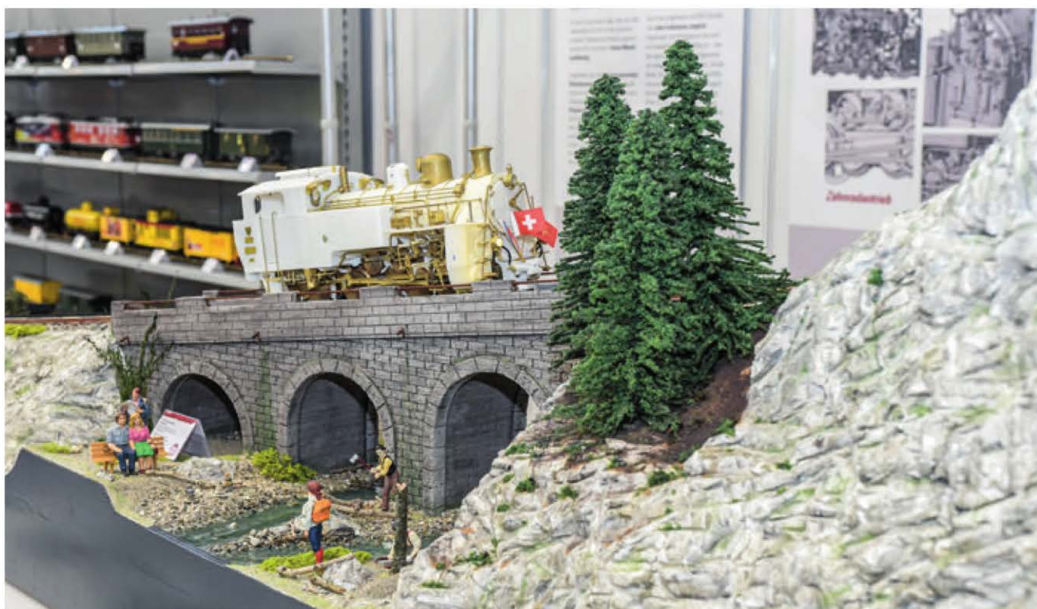
Dauerläufer: Das Funktionsmuster der HG 4/4 war auf dieser Bergstrecke mit acht Prozent Steigung drei Tage lang im Dauereinsatz.
