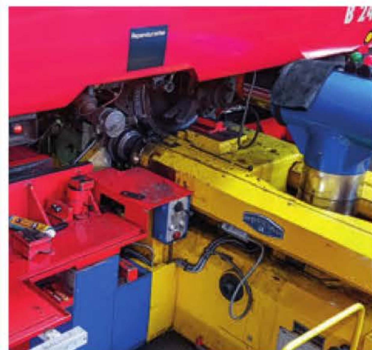
Zeitsparend: Die Unterflur-Radsatzdrehbank beschleunigt die Reparatur.
