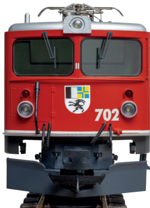
Geänderte Front: Ursprünglich hatten Lok 701 und 702 Übergangstüren an den Stirnfronten und damit drei Stirnfenster. Bis Ende der 80er wurden sie auf die neue Front mit zwei Fenstern und ohne Tür umgebaut.
