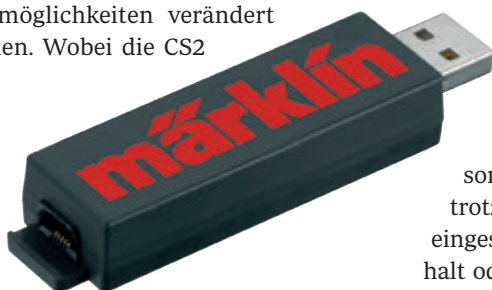
Der Decoder-Programmer (Art. 60971): An ihn wird die Adapterplatine (Art. 55129, oben) angedockt.
