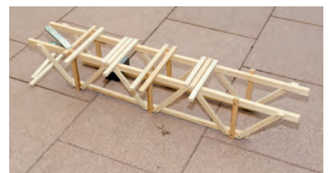
Stab-Vielfalt: Die 16 Querbalken müssen in einer bestimmten Reihenfolge auf dem oberen Teil der Brücke montiert werden.
