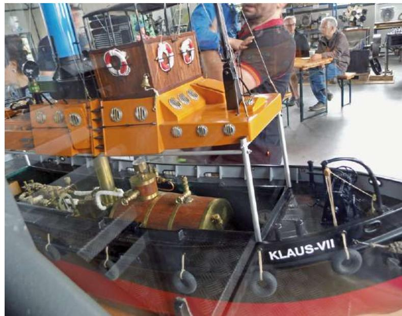
Neuheit in einer Vitrine: So sieht der Dampftrieb bei einem Schleppermodell aus.
