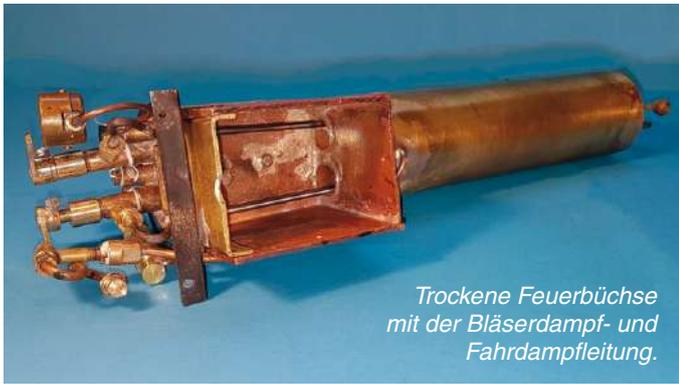
*Trockene Feuerbüchse mit der Bläserdampf- und Fahrdampfleitung.*
