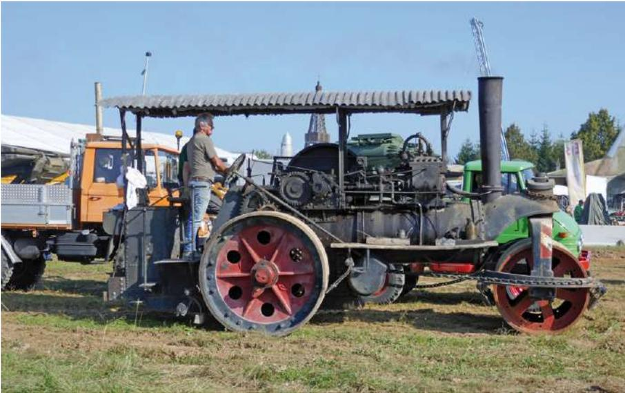
*Die rechte Seite der Walze zeigt: Es handelt sich um eine 4-Wellenmaschine; dies ist gut, da der untere Teil des Kreuzkopfes bei Vorwärtsfahrt belastet wird und sich dort das Maschinenöl verschleißmindernd sammelt; hierbei dreht das Schwungrad gegen die Fahrtrichtung! Zu beachten ist außerdem die gute Konstruktion der Lenkschnecke im großen Ölbad vor dem Hinterrad; denn Dampfwalzen sind in der Regel bei niedrigeren Geschwindigkeiten schwierig kraftsparend zu lenken ...*
