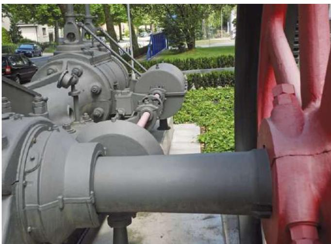
Zylinder mit Ventilantrieb, geteiltes Schwungrad, der Korrosionsschutz ist hervorragend.
