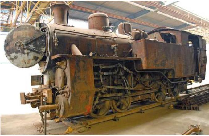
**Dampflok HG 4/4. Zustand der Lok Nr. 704 bei Beginn der Aufarbeitung in der DFB-Lokwerkstätte in Chur. Vor der Zerlegung am 09.02.2007. Foto: Hansueli Fischer**
