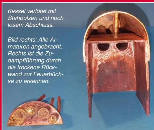
Kessel verlötet mit Stehbolzen und noch losem Abschluss.
