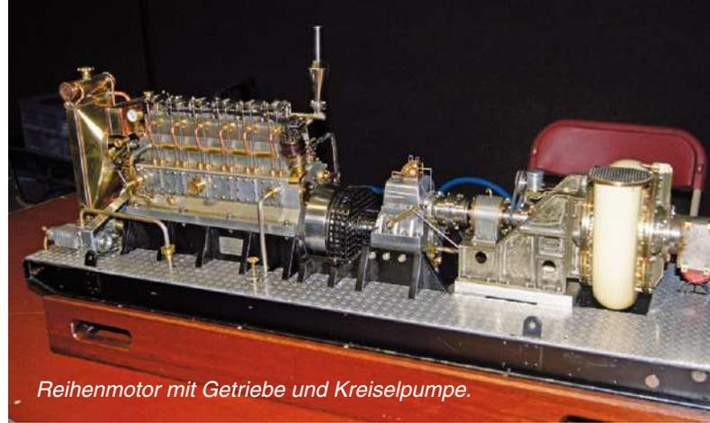
Reihenmotor mit Getriebe und Kreiselpumpe.
