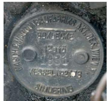
Fabrikschild Baujahr 1931; zulässige Dampfspannung 12 bar; Kessel-Nummer 2173 neben der Feuerlochtür; zu deren Bedienung dient die Kette.
