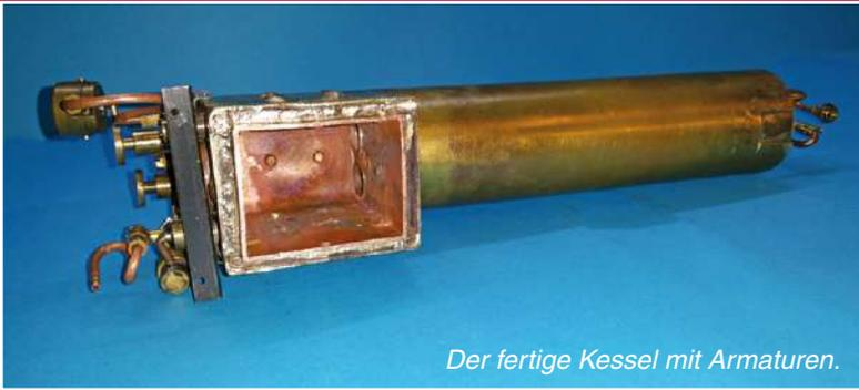
Der fertige Kessel mit Armaturen.
