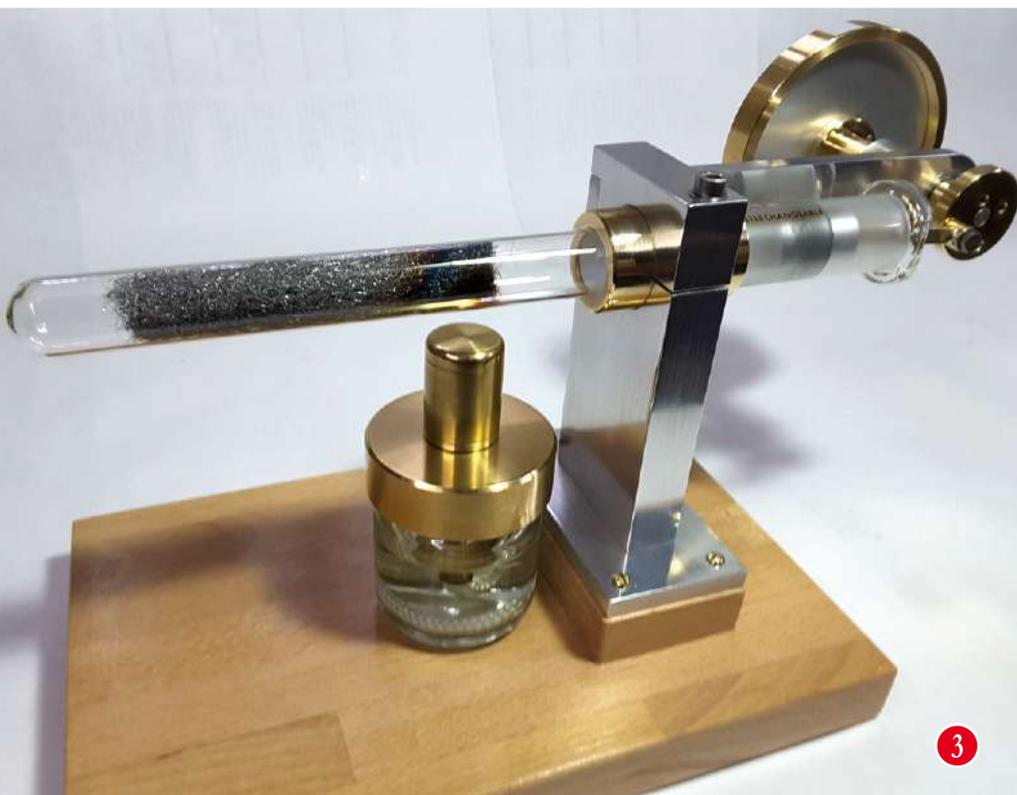
Dieser Motor hat nichts mit Thermoakustik zu tun. Da müssen ganz andere Effekte wirksam sein. Ich habe daher beschlossen, den Motor mit einer Messeinrichtung zur Aufnahme eines Druck-Kolbenweg-Diagramms zu versehen.
