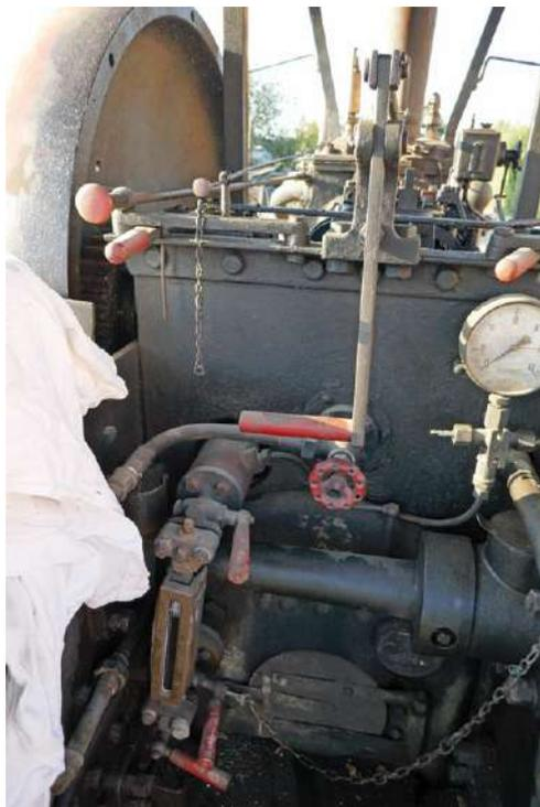
Der Dampfhebel hier im Stil der Lokomotiven; der Wasserstandsanzeiger mit seinen Hähnen; die beiden roten Hebel oben rücken wechselseitig das Getriebe ein; das Manometer mit der leicht reduzierten ebenfalls rot gekennzeichneten Höchstdruckanzeige von 10 statt 12 bar.
