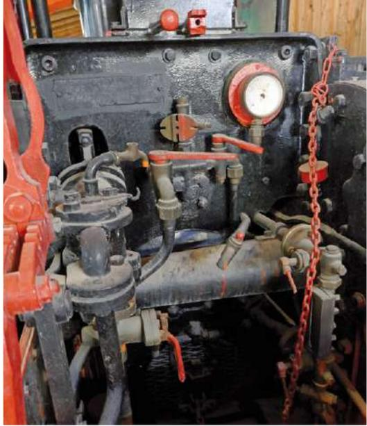
Führerstandsblick natürlich total im Burrell Style: rechts unten der Wasserstand; darüber Manometer; großer roter Hebel oben Dampfzufuhr-Injektor; links daneben Wasserpumpe; links daneben in Feuerrot die Umsteuerung der Maschine.
