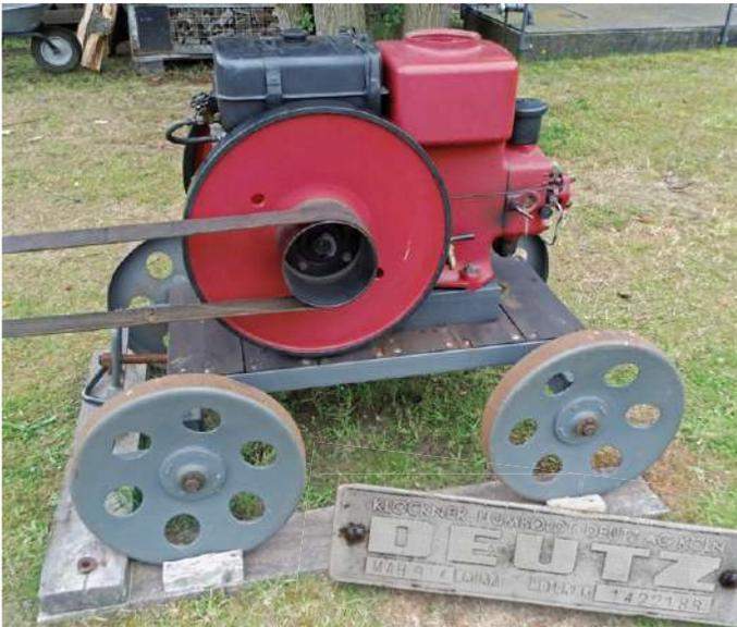
*Technik der 1950er: Liegender DEUTZ-Dieselmotor Typ MAH 914, 10 PS, Baujahr 1952.*
