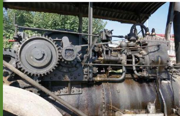
*Seitenstudie der Walze: gut sichtbar die oben angebrachte Wasserpumpe mit Windkessel sowie die zuvor nie gesehene Bauart der zwei Sicherheitsventile auf dem Zylinder und das Dampfregelventil vor dem halbkreisförmigen Zudampfrohr. Die oberste Z-förmige Stange dient der Steuerung der Zischhähne.*
