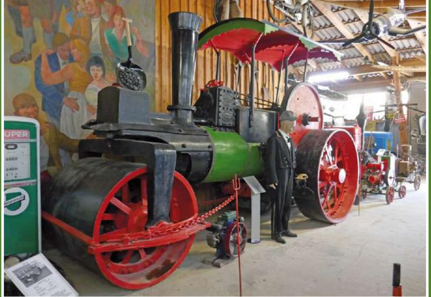
Dampfwalze mit Zweizylinder-Verbundsystem auf einer Treibstange ausgeführt und patentiert durch die Firma Burrell, Großbritannien. Vertrieben und für sich beschildert durch und für die Firma Theodor Ohl aus Limburg an der Lahn. Wahrscheinlich nachgefertigter, ungewöhnlicher Schornstein ...
