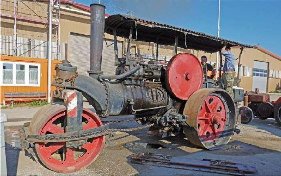
*Simmering-Dampfwalze im Morgenlicht; gut zu sehen das Abdampfrohr vom Zylinderblock zum Schornstein; das große Mannloch zur Reinigung und Inspektion; die gegossenen Räder vorn und hinten; der Werkzeugkasten am Tender; der Zylinderblock mit Hoch- und Niederdruckzylindern.*
