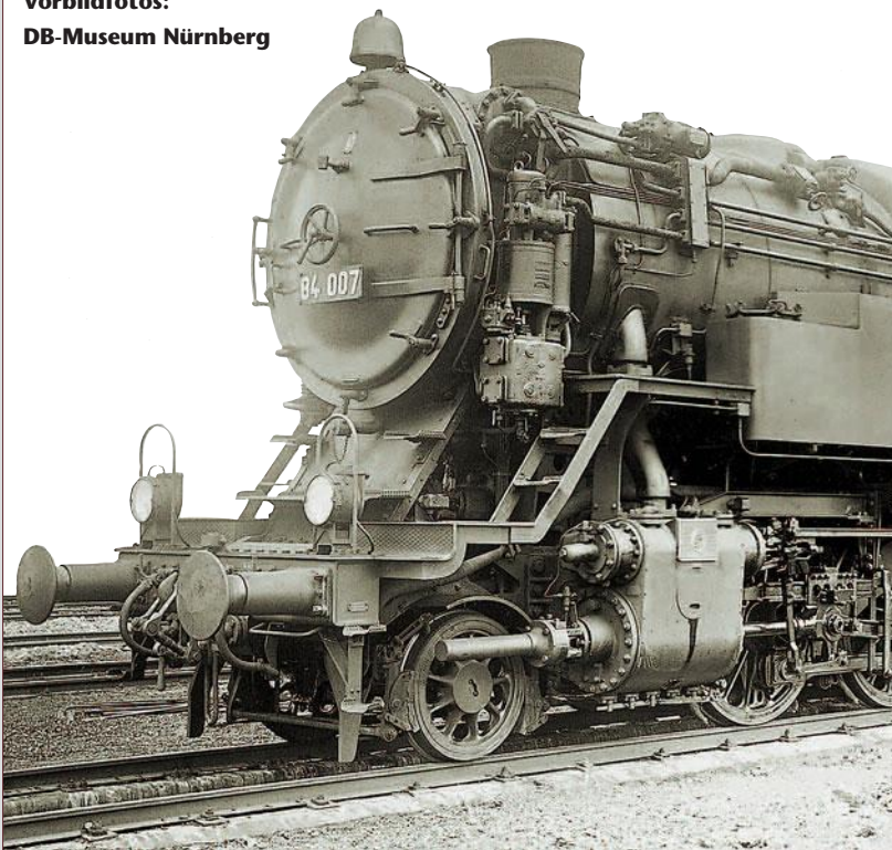
Des Vorbilds linke Seite: Speisepumpe und Lichtmaschine am Kessel einer Einheitslok der Baureihe 84.
