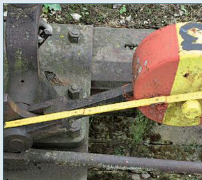
Anordnung Stellbock und Weichenlaterne. Länge Stellhebel (oben)
