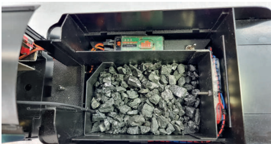
Im Tender rechts eingebaute RC-Empfängereinheit
