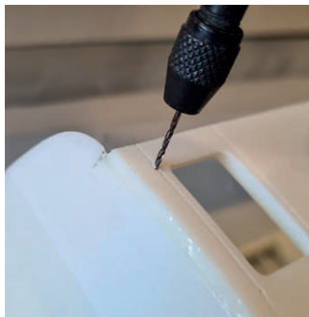
Aufbohren der vorgedruckten Löcher für die Türbeschläge, wobei rechts ein Testscharnier angebracht wurde, um die Passform zu überprüfen
