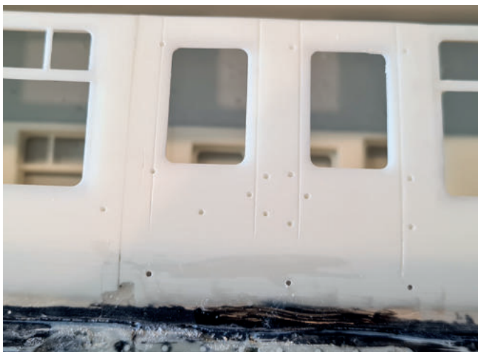
Die unzähligen Löcher rund um den Schaffnerwagen für die verschiedenen Beschläge, die zu gegebener Zeit angebracht werden. Rechts werden die Türnuten nach der Neugestaltung des unteren Bereichs der Seitenwände wiederhergestellt
