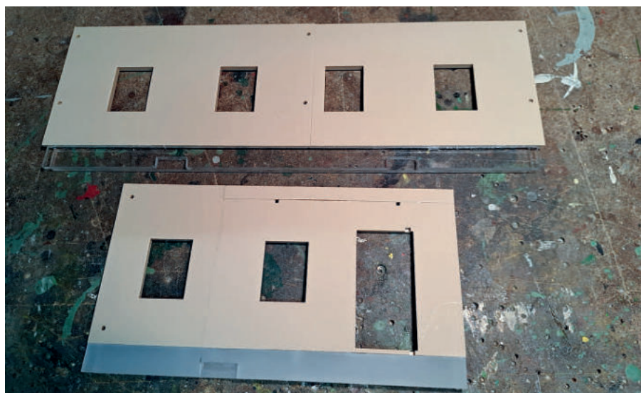
Eine Seiten- und eine Stirnwand vor dem Verkleben
