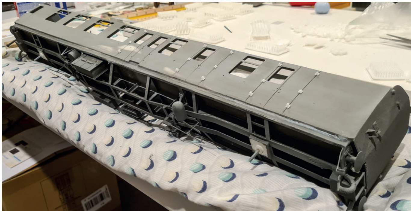
Der BSK (Brake Second Corridor) mit montierten Scharnieren. Man beachte das alte Blech, das darunter gefaltet wurde, um ein weiches Polster für die Scharniere auf der anderen Seite zu bilden. Beachten Sie auch die Schwelle unter der Schaffner-Tür in der Mitte des Wagens
