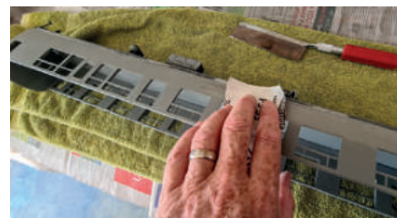
Abschleifen der ersten Grundierungsschicht
