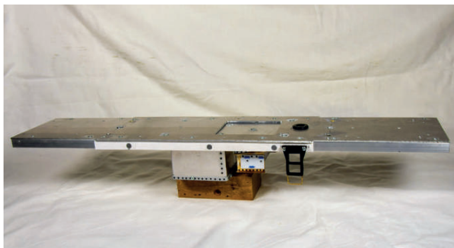
Der Brückenrahmen mit dem Wassertank und dem angedeuteten Unterteil der Feuerbüchse samt Aschkasten (soweit es das Ausdrehen der Fahrgestelle zulässt)
