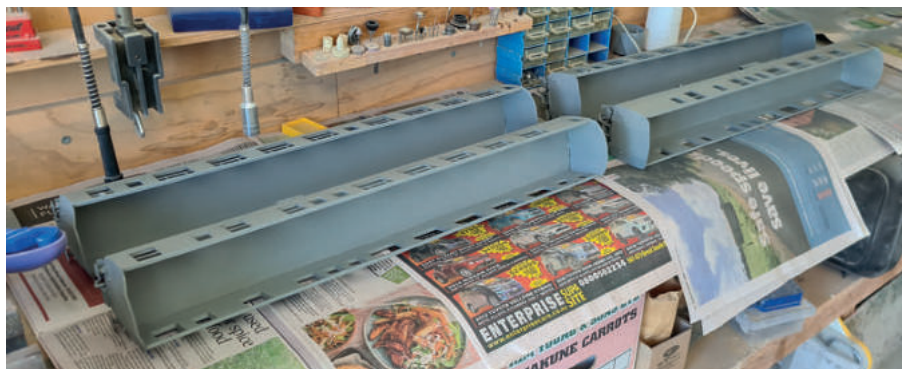
Vier Rümpfe, die mit der ersten Grundierung versehen wurden
