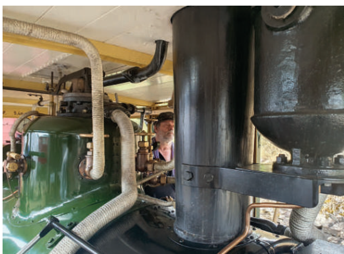
Am, auf, um und um den Kessel herum sind doch viele Armaturen für Saug- und Druckluftbremse, Abdampf in Kondensator oder direkt, und „das übliche“ verbaut (Foto: Dr. Walter Gekeler)
