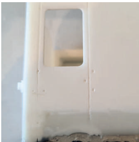
Aufbohren der vorgedruckten Löcher für die Türbeschläge, wobei rechts ein Testscharnier angebracht wurde, um die Passform zu überprüfen
