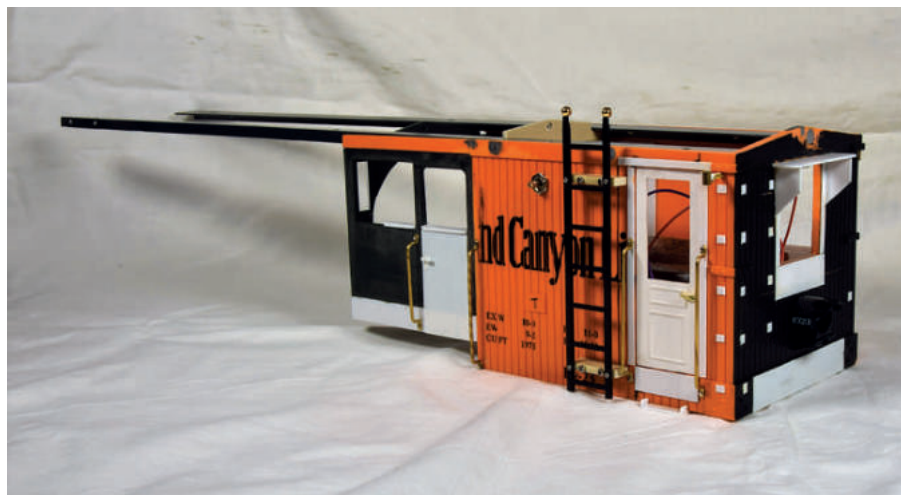
Der hintere Aufbauteil mit Führerstand 2, Vorräteteil, Raum für den Heizer und den beiden Längsträgern für das Dach
