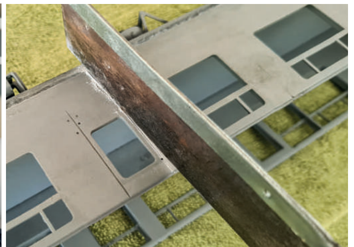
Die unzähligen Löcher rund um den Schaffnerwagen für die verschiedenen Beschläge, die zu gegebener Zeit angebracht werden. Rechts werden die Türnuten nach der Neugestaltung des unteren Bereichs der Seitenwände wiederhergestellt
