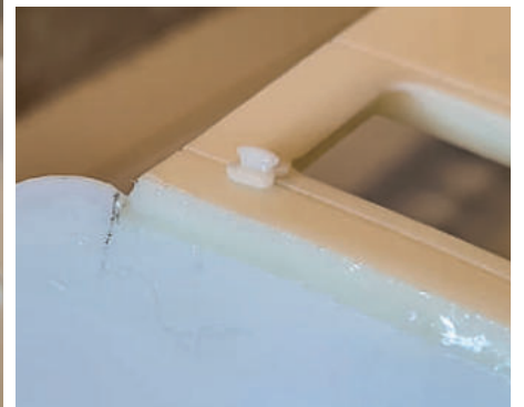
Aufbohren der vorgedruckten Löcher für die Türbeschläge, wobei rechts ein Testscharnier angebracht wurde, um die Passform zu überprüfen
