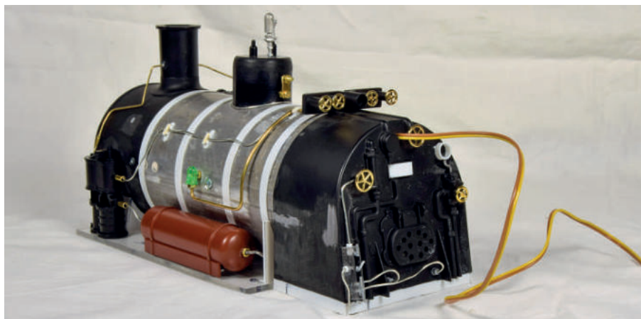
Der Kessel von hinten, die Feuerbüchsenrückwand ohne Regler aber mit angedeuteten Brennern. Das Reglergestänge greift, in hoher Lage von den beiden Führerständen kommend, in den Hebel am Dampfdom ein.
