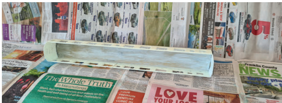
Die weiße Ätzgrundierung ist aufgetragen, und die Karosserie steht in einer provisorischen Spritzkabine aus alten Zeitungen
