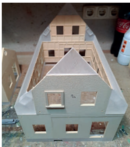
Aufgerichtetes Dachgeschoss: Giebelwand mit 3 Ergänzungen und die längsseitigen Übermauerungen
