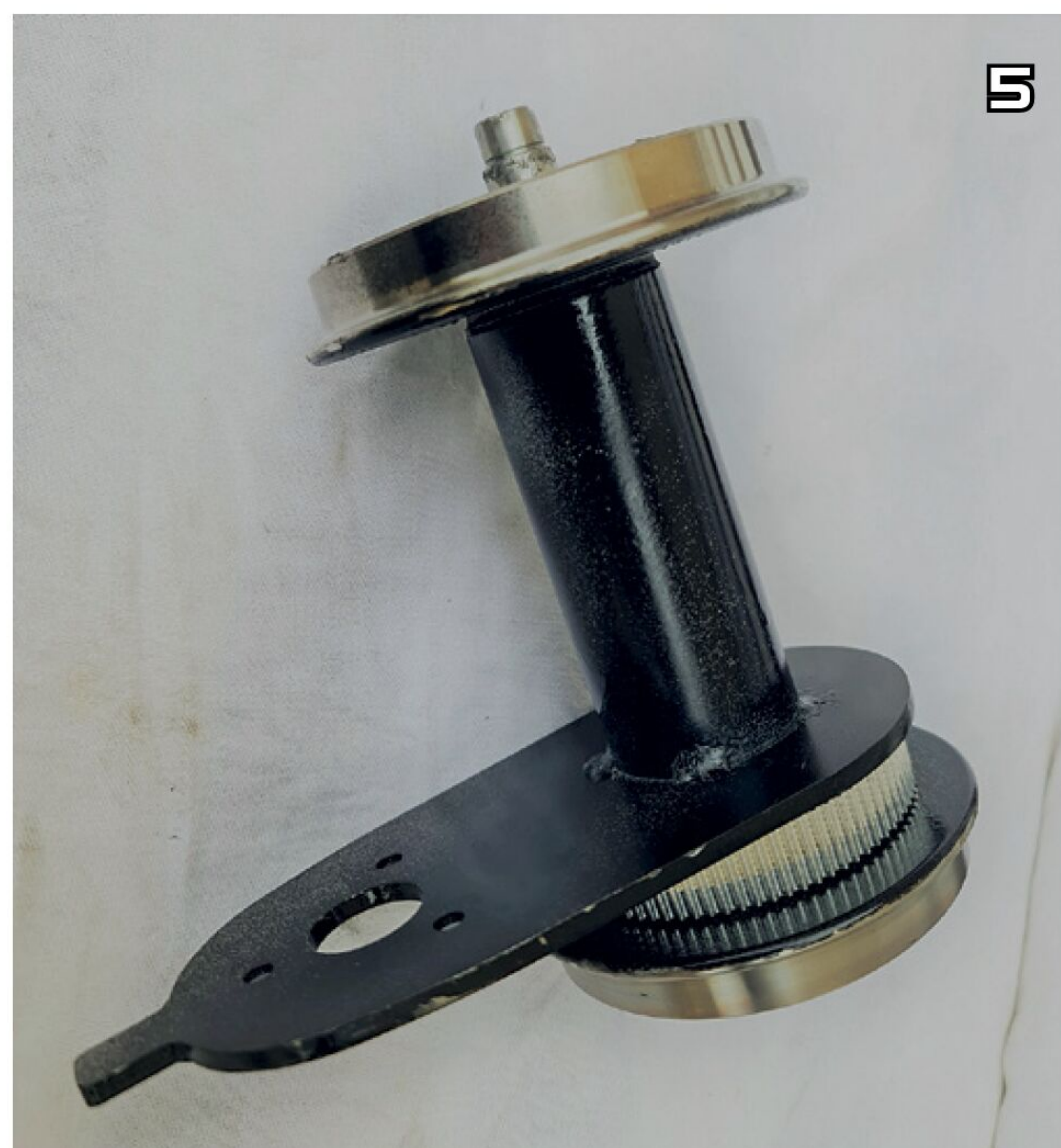
Tatzlagerantrieb, noch ohne Riemen und Motor
