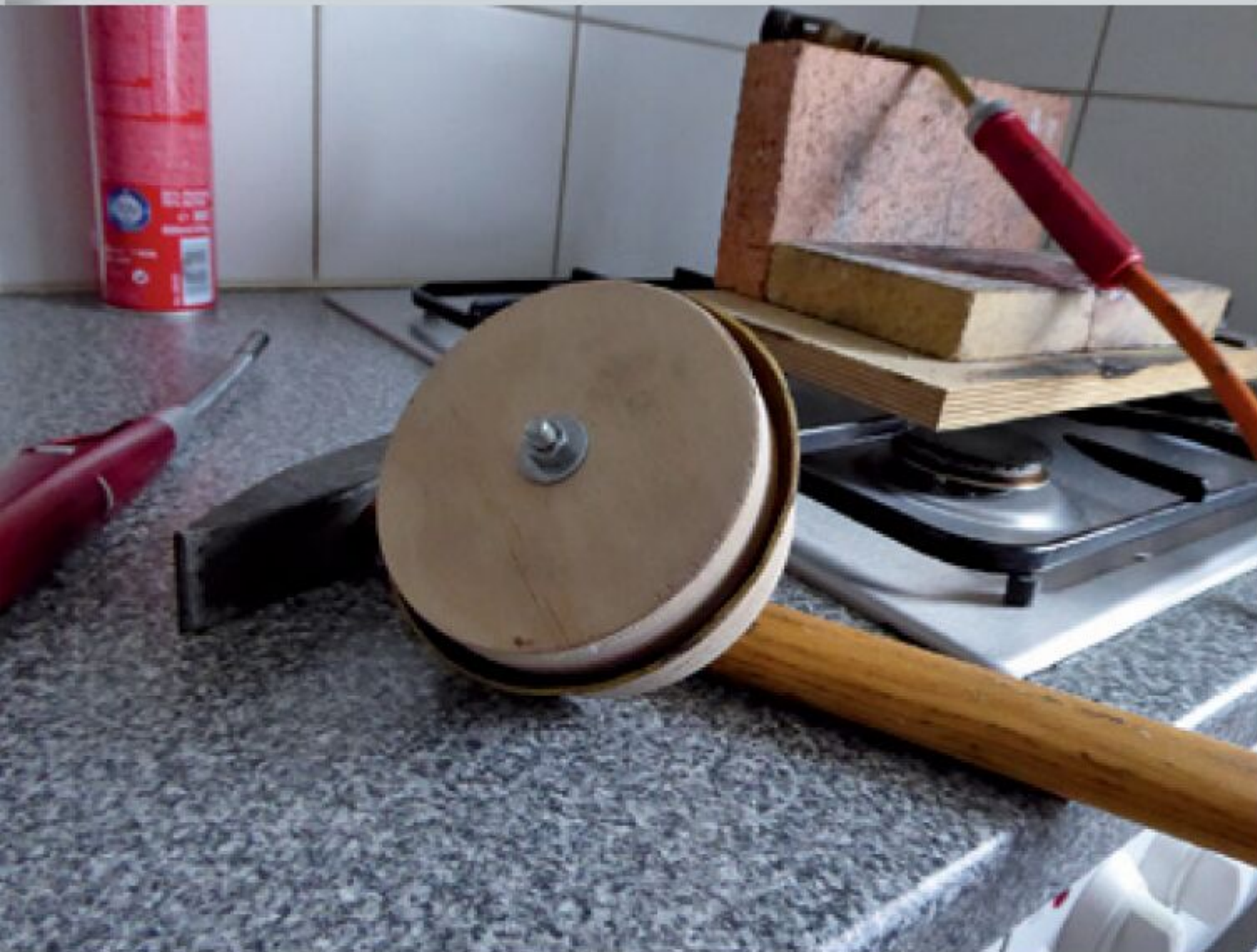
Durch das Bearbeiten ist der Rohling wieder hart geworden ...
