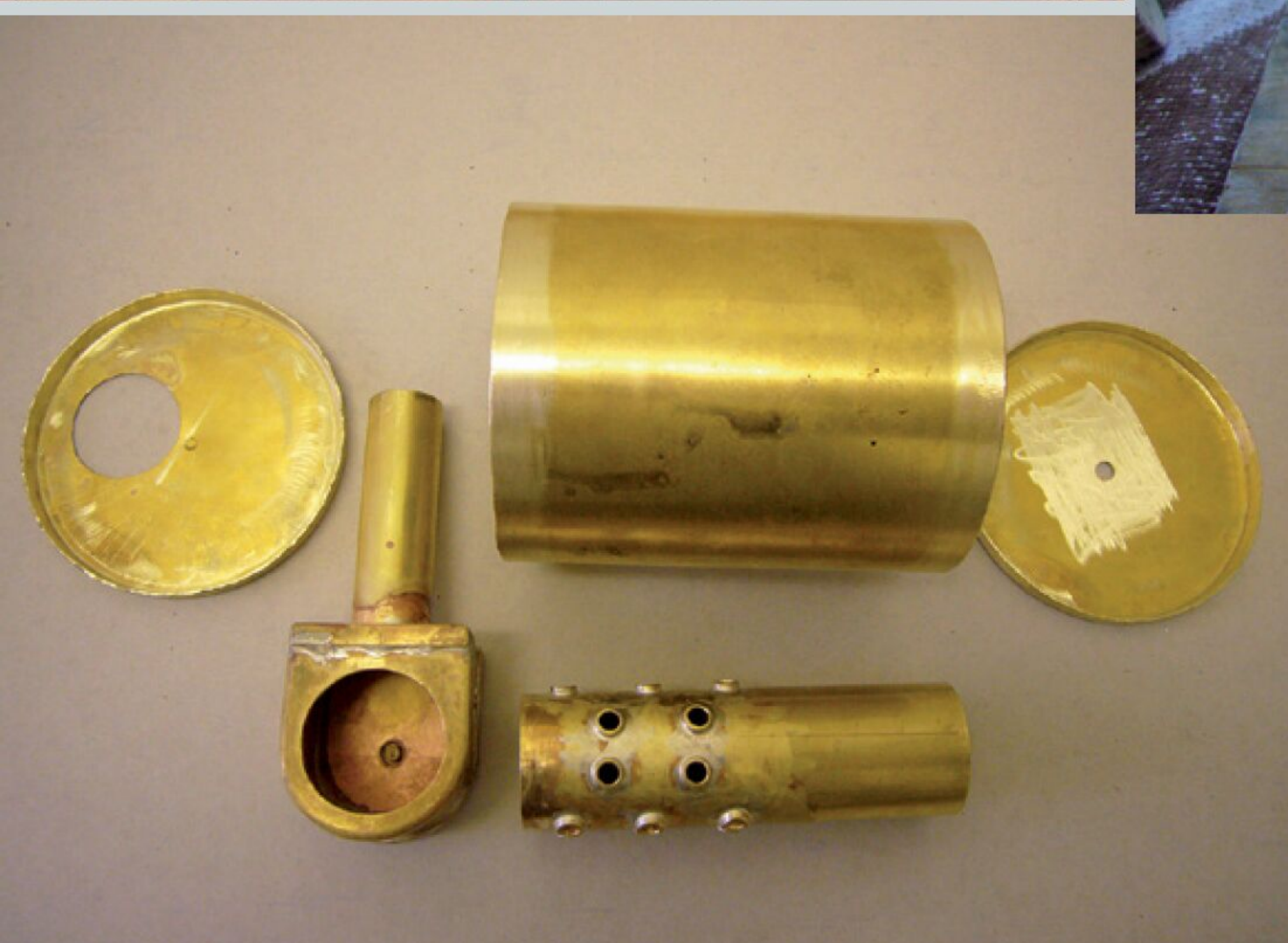
Vorbereitete Bauteile für einen liegenden Kessel, unten die Einbau-Rauchkammer mit Innenkamin und das Feuerrohr mit eingelöteten Siederohren
