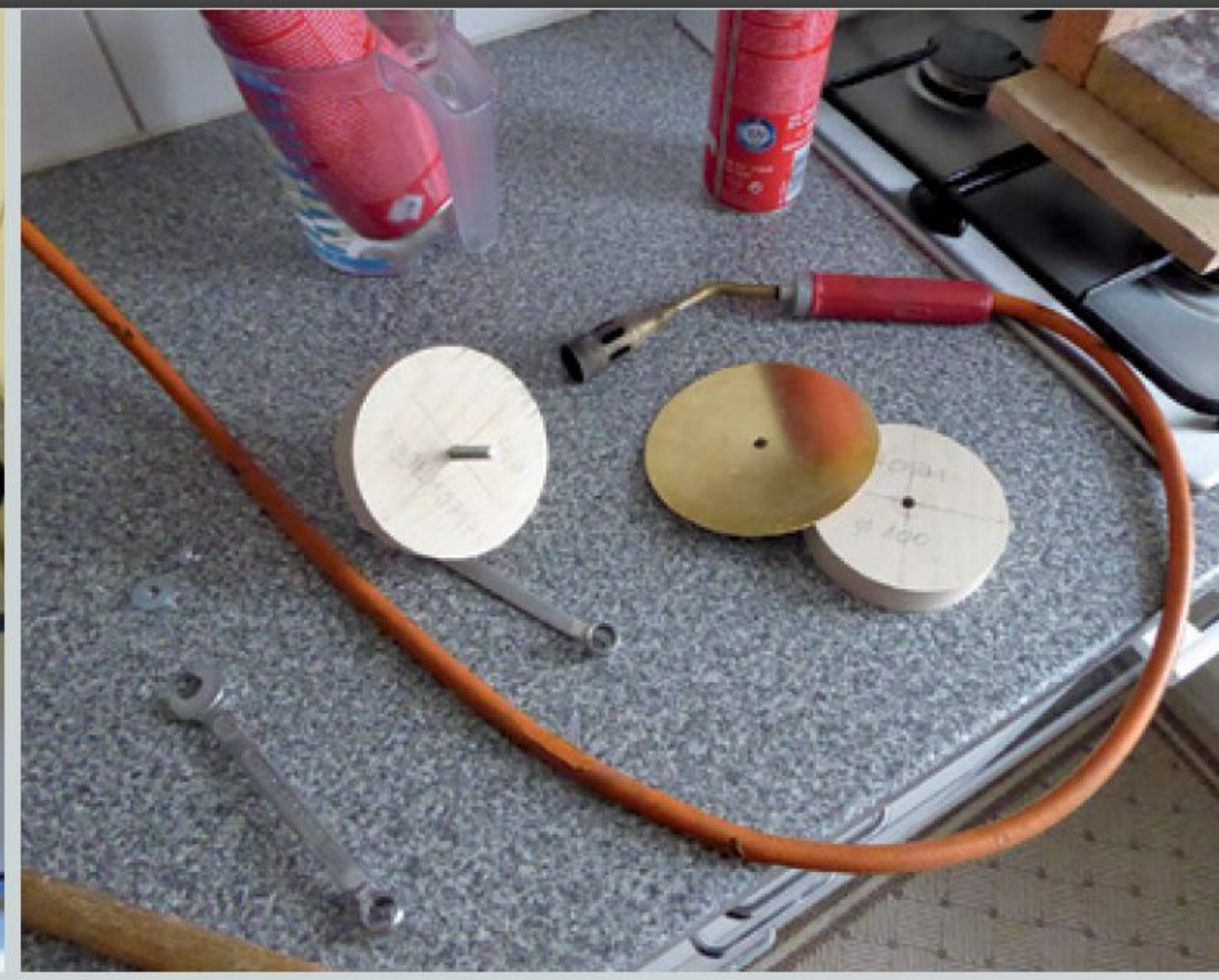
Der Rohling ist bereit zum Bördeln.
