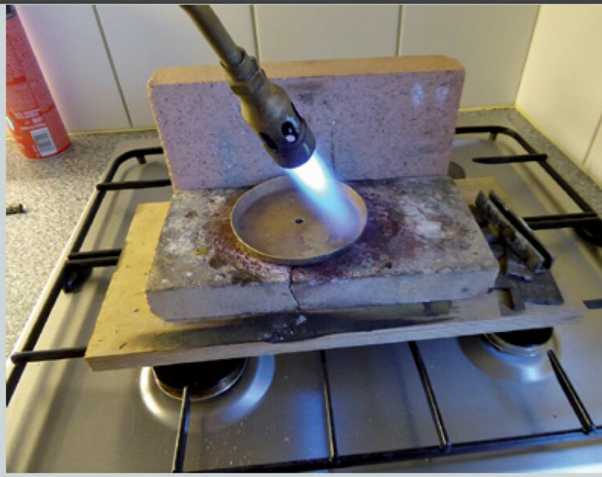
Ein Rohling wird geglüht.
