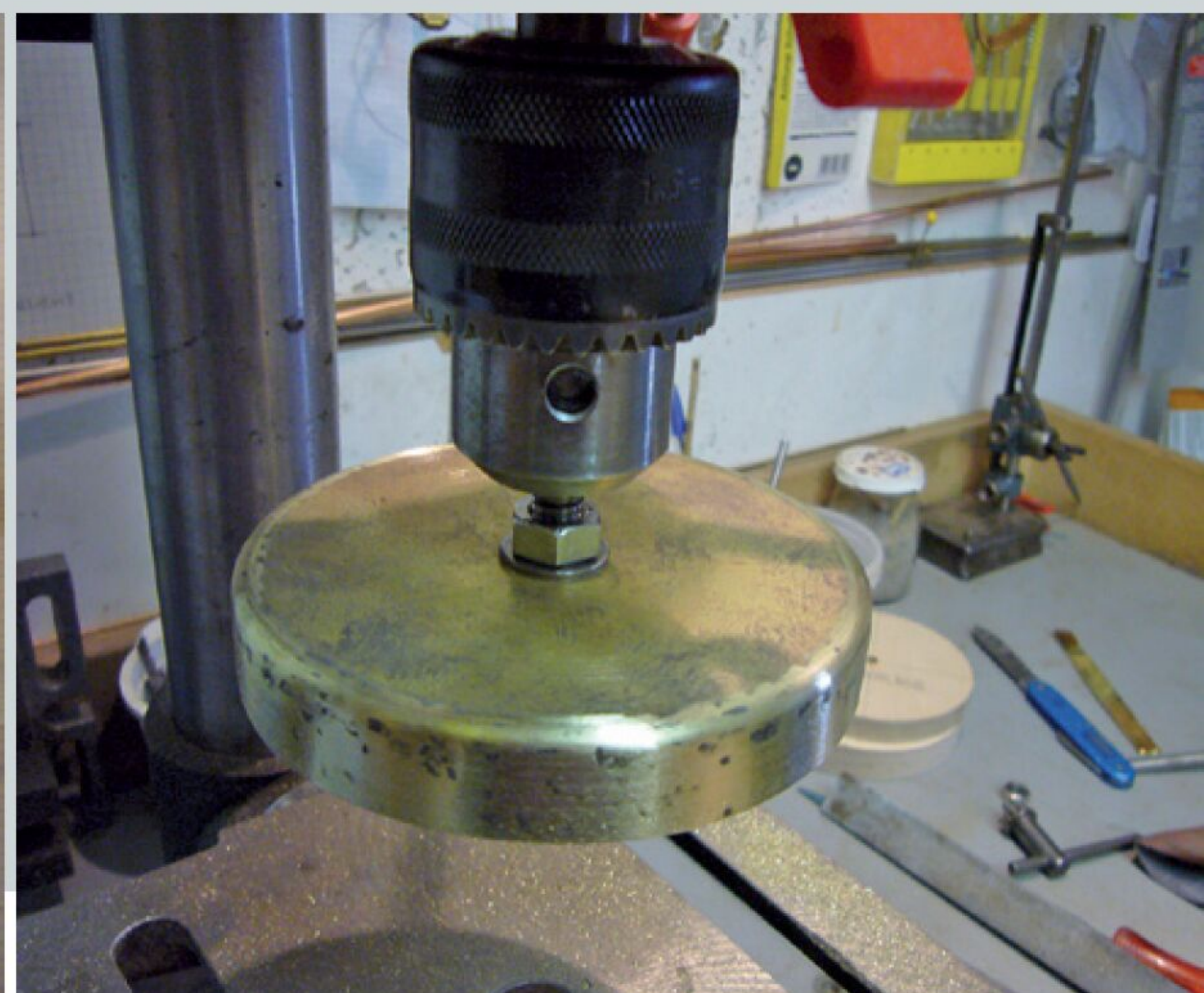
Bearbeitung mit der Bohrmaschine. Mit einer Drehmaschine ginge das professioneller.
