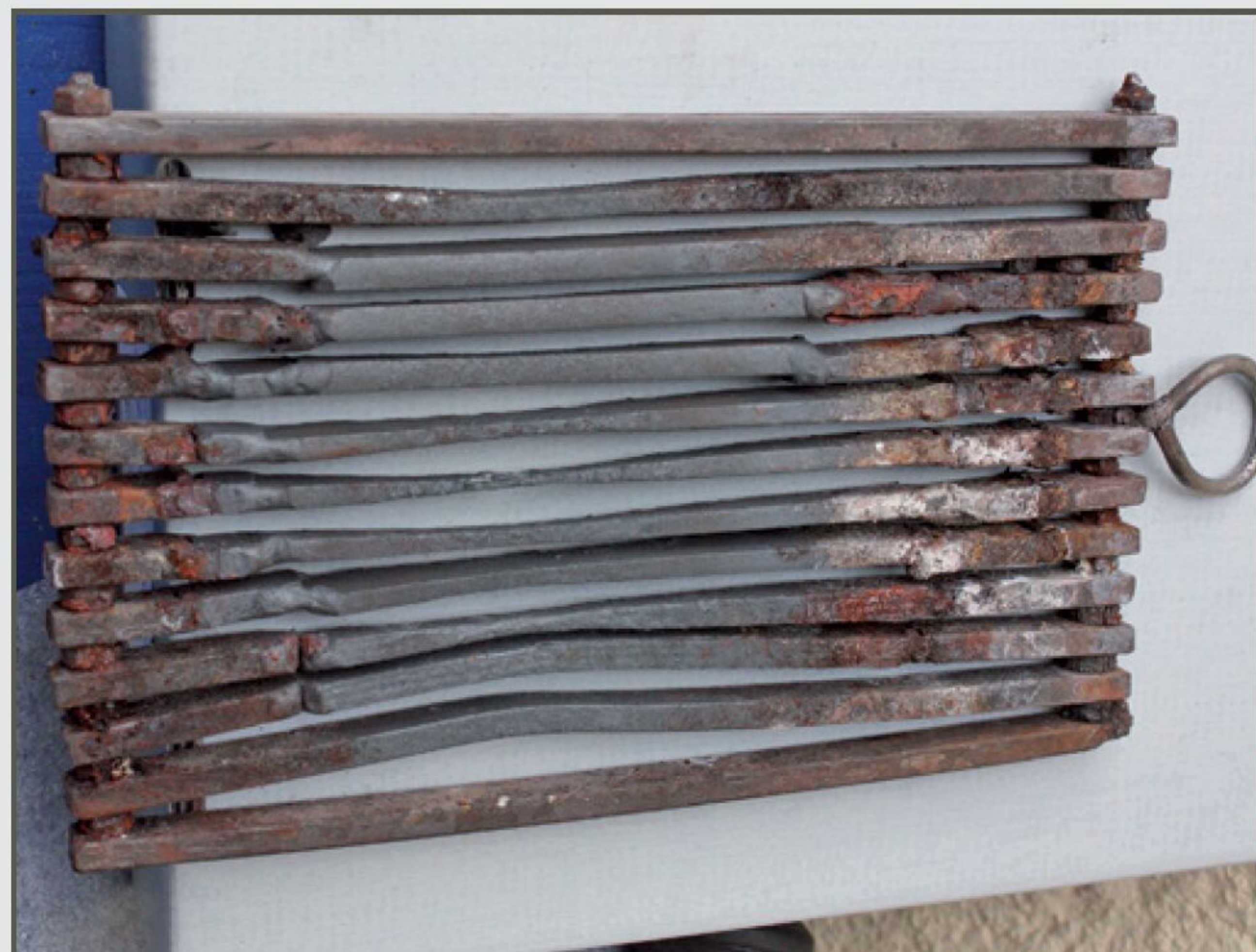
Der Rost aus der G ¾ mit den abgebrannten Stäben. Nach Auskunft der Arbeiter beim Stahlhändler handle es sich bei diesem Material um „Niro“. Eine Klassifizierung – 1.4301 oder 4571 – kann nicht genannt werden.
