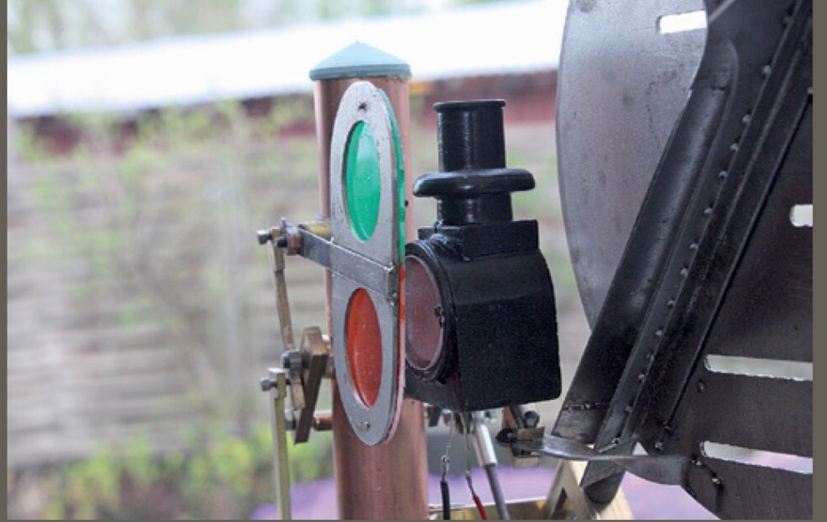
Die Eigenbau-Signallaterne im Maßstab 1:7,5 mit LED-Lämpchen. Die Vorbilder hatten für die Aufhängung am Signalmast einen seitlichen „Blechanbau“ mit Schlitz, der in einen passend gebogenen Eisenhaken am Signal passte. Den „Stangenverhau“ für das Hochschieben (und Abnehmen) der Lampen habe ich mir gespart.
