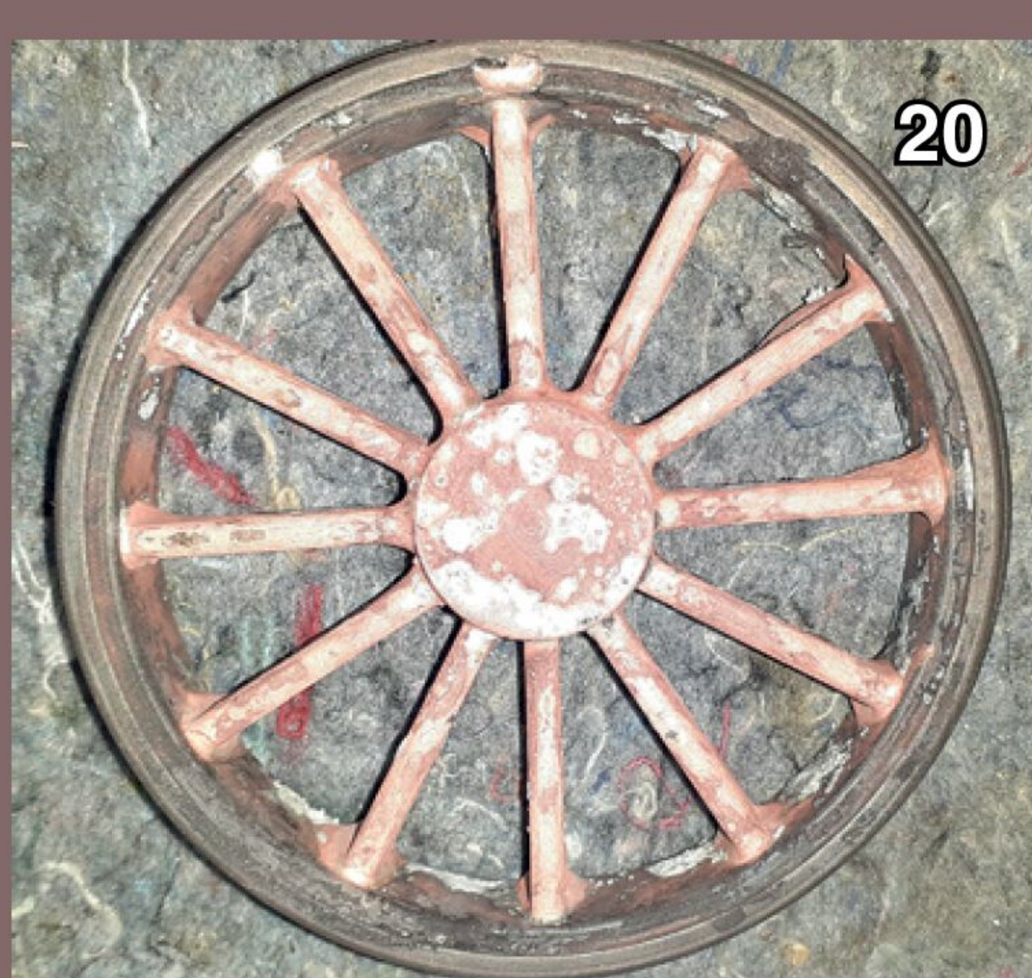
Das fertig gelötete Rad, in welches noch die Achslagerung eingedreht wird.
