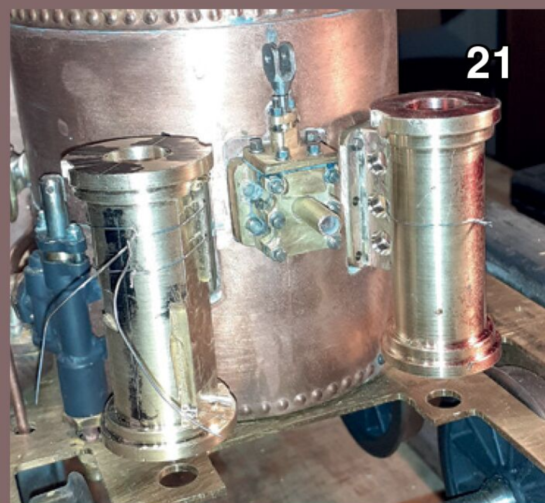
Mit einer Lehre zum Hartlöten vorbereitet.
