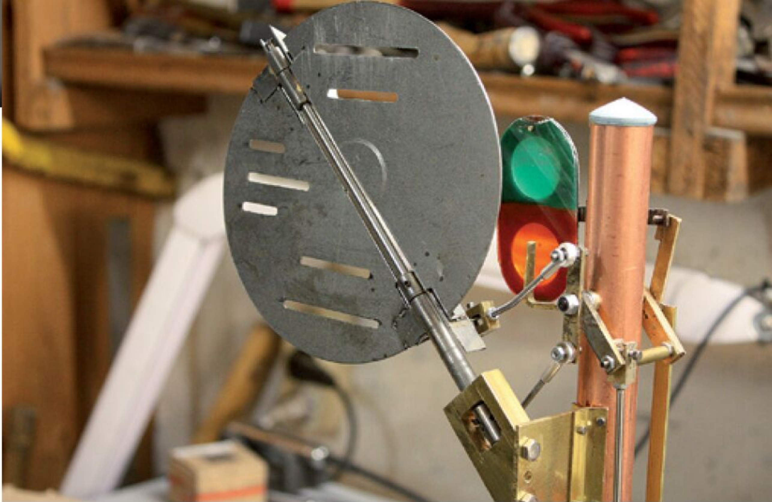
Nahaufnahme des „Kreuz-Hebels“, mit dessen vertikalem „Auf und Ab“ über die mit Kugelgelenk versehenen Stellstangen die horizontale Bewegung der zwei Scheibenhälften vor sich geht.
