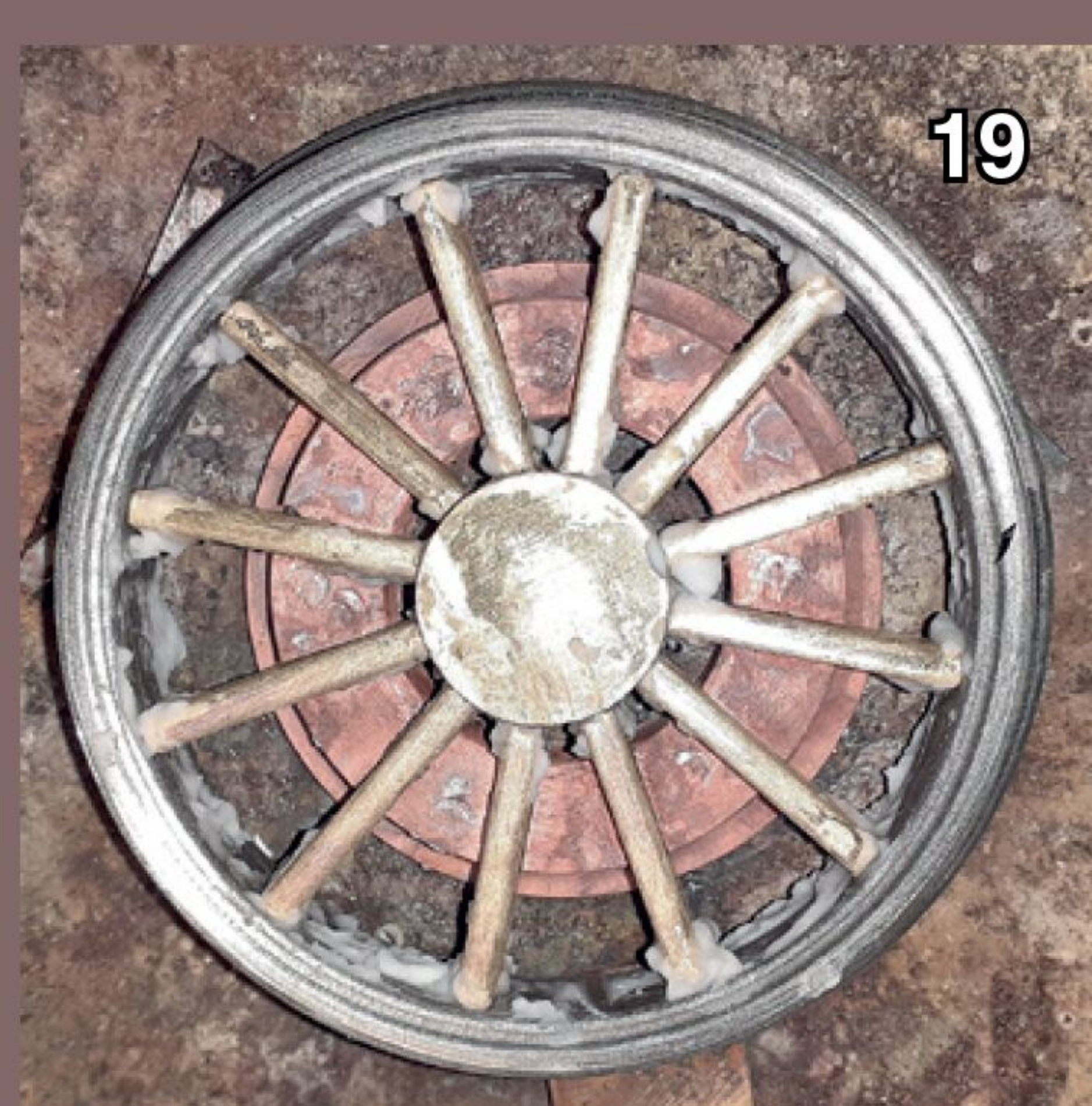
Mit einer Lehre zum Hartlöten vorbereitet.
