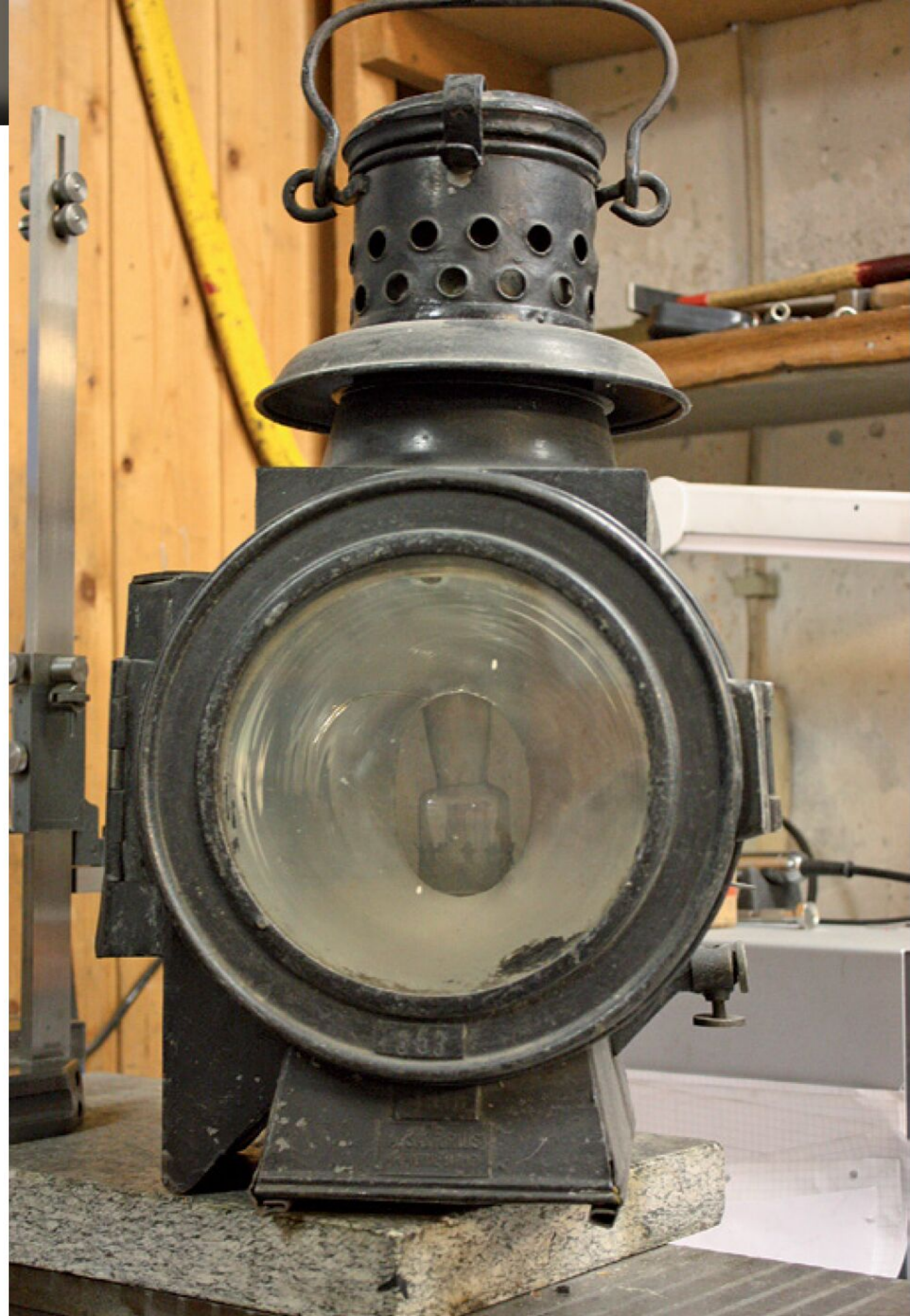
Eine Original-Signallampe, die noch mit Petroleum betrieben wurde. Uns wurde vor Jahren ein zweites „Modell“ verehrt, das bereits mit den bekannten 5-kg-Propan-Flaschen betrieben wurde.
