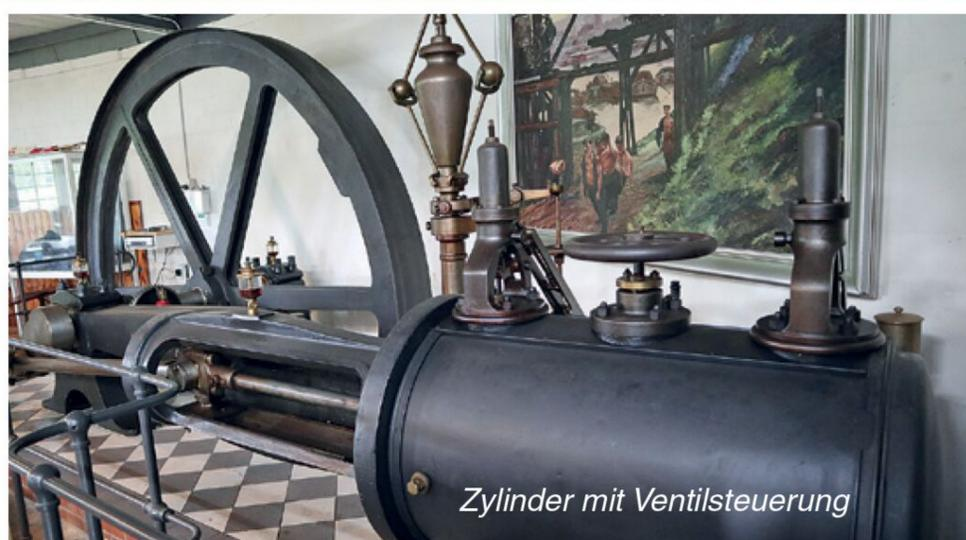
*Zylinder mit Ventilsteuerung*
