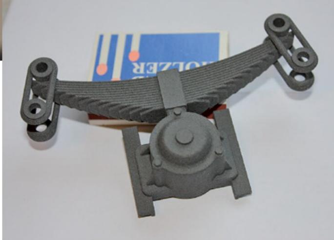
3D-gedrucktes Federpaket. Diese und auch andere gezeigte Arbeiten „verraten“, dass zum Gelingen jedes „3D-Drucks“ eine perfekt erstellte CAD-Datei Voraussetzung ist.
