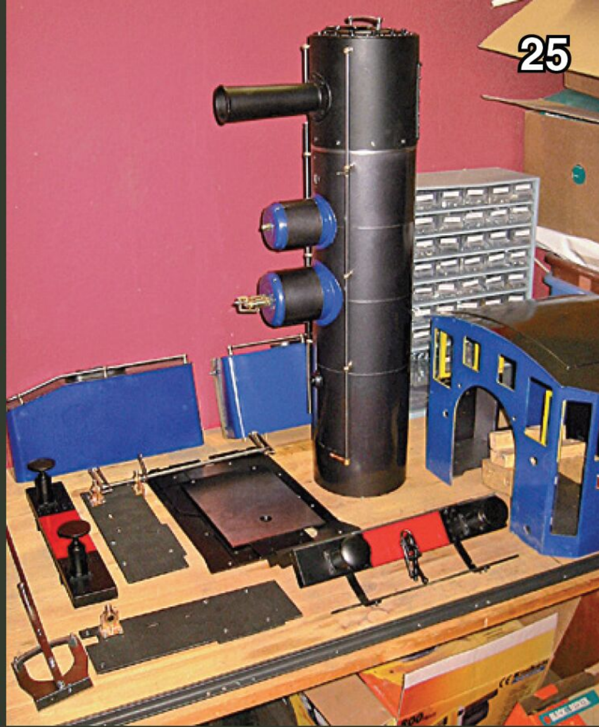
Die Lokomotive besteht aus mehreren Baugruppen, welche miteinander verbunden sind; meist mit ein paar Schrauben und Flügelmutter. Dies macht es leicht, die Lokomotive für Reparaturen zu zerlegen.
