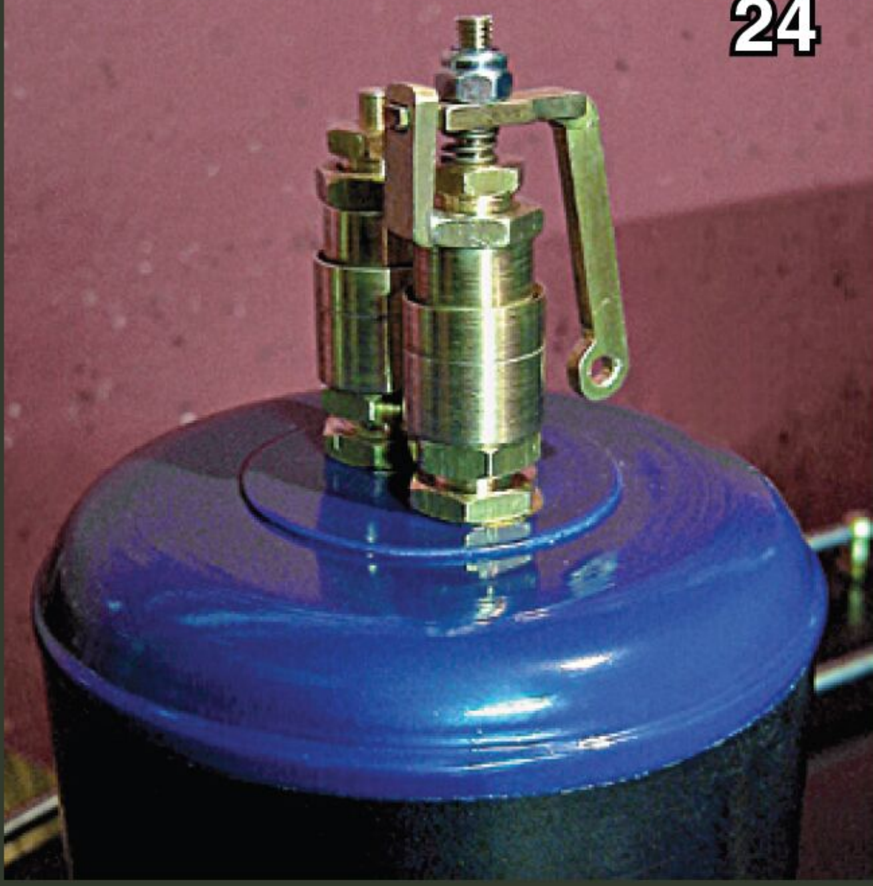
Die beiden Sicherheitsventile montiert auf dem Dampfdom.
