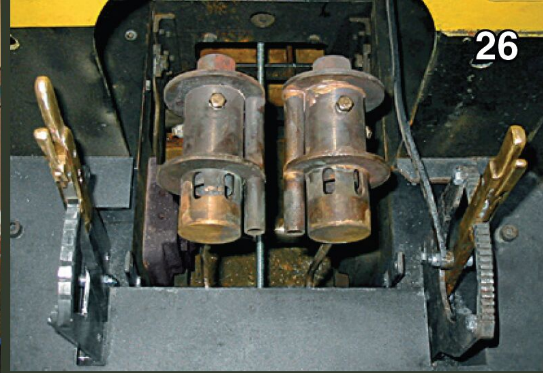
Ein Blick ins Innere des Führerhauses; der Kessel ist entfernt. Links auf dem Boden ist die Libelle von einer Wasserwaage zu sehen. Diese hilft den richtigen Wasserstand im Kessel zu bestimmen, wenn die Lok nicht in der Ebene steht. Der Handbremshebel befindet sich im Gegensatz zum Vorbild auf der linken Seite. Der Umsteuerhebel befindet sich auf der rechten Seite. Dazwischen sind die beiden Propangas-Brenner aus Cu-Ni-Rohr positioniert.
