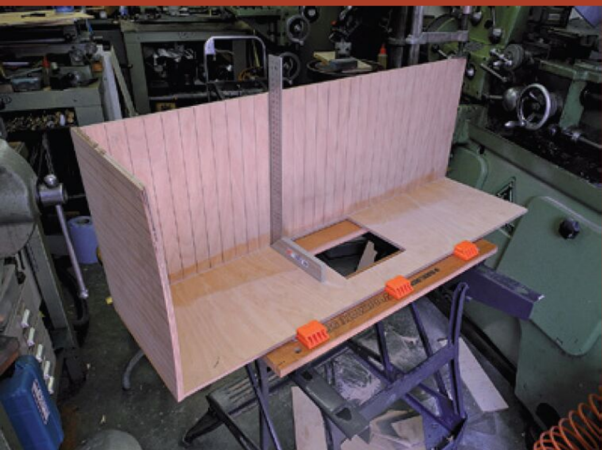
Das Fräsen der Rillen
