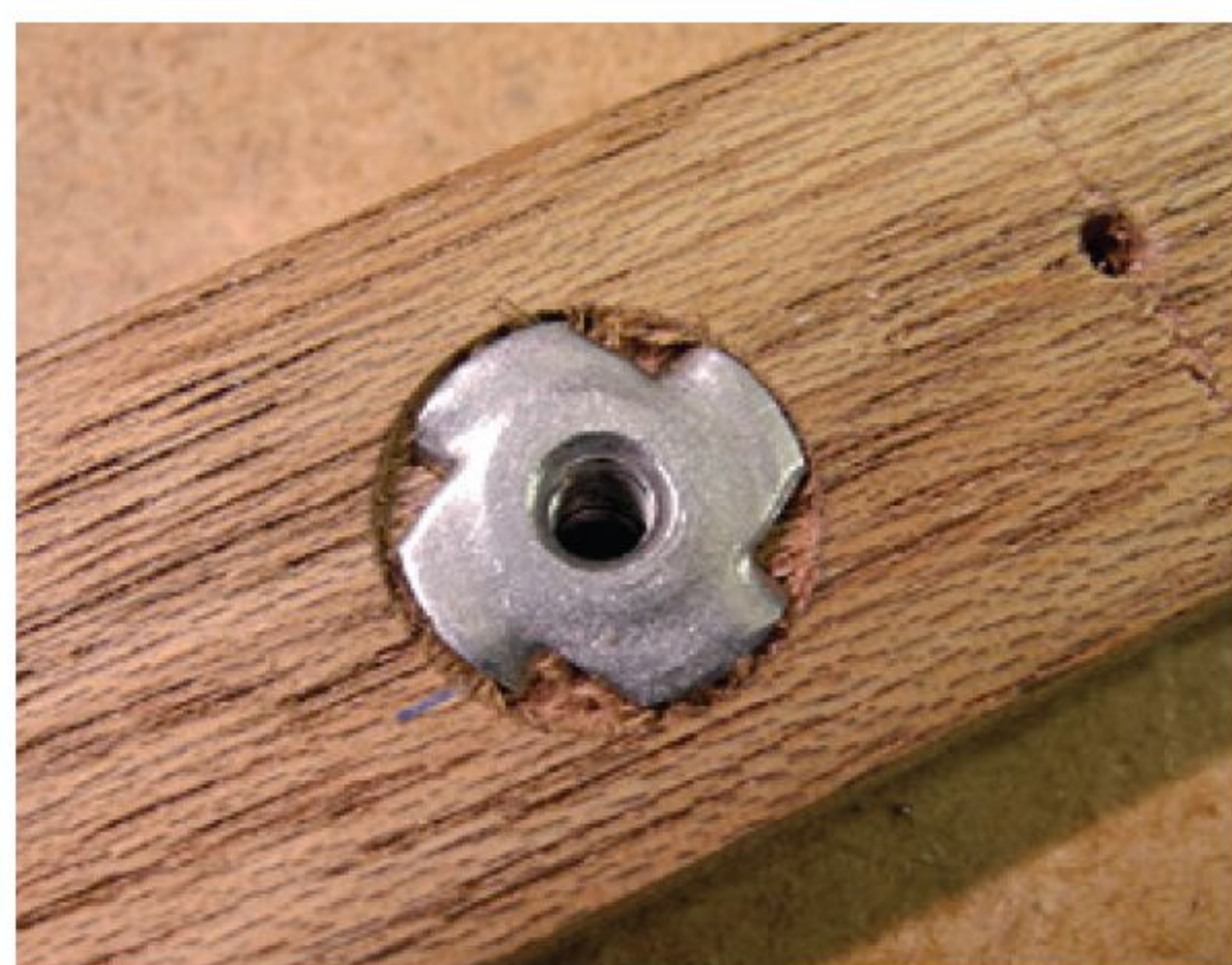
Einschlagmuttern an der Bodenunterseite des Wagenkastens
