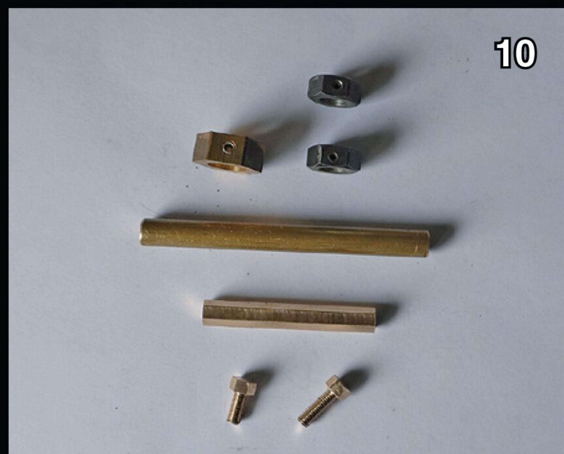
6kt-Schrauben M5 auf einfache Art hergestellt
