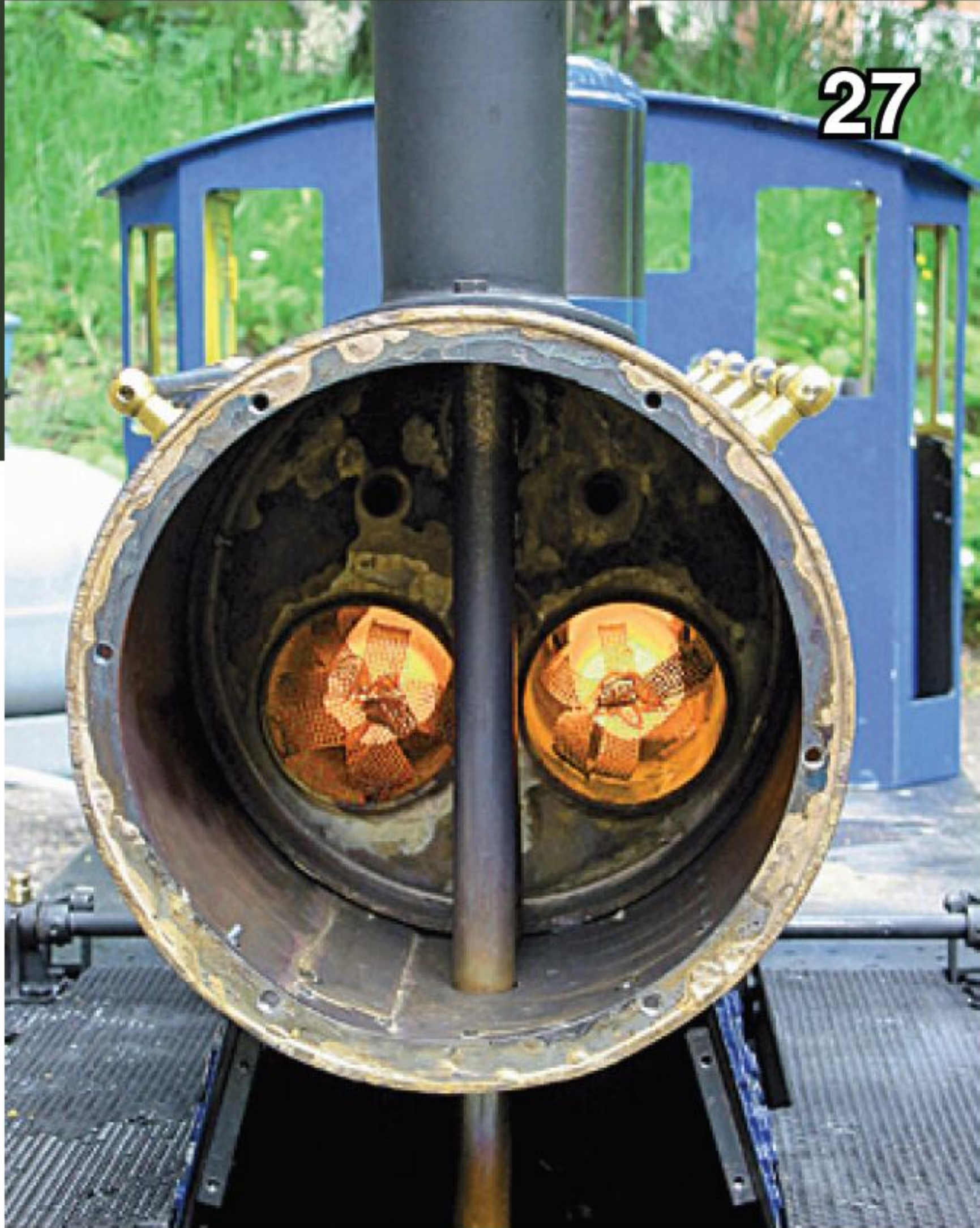
Die glühenden Kegelstrümpfe aus Nickel-Drahtgeflecht strahlen ihre Hitze in die Flammrohre ab. Die Temperatur erreicht hier 1.000 °C. Aufgrund der unorthodoxen Feuerung ist eine Gebläsedüse in der Rauchkammer überflüssig. Stattdessen wird der Abdampf aus den Zylindern über ein Rohr fast bis zur Spitze des Schornsteins geleitet.
