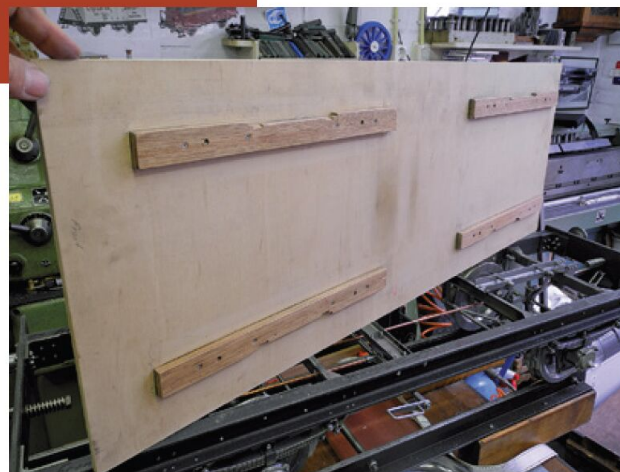
Lamellen mit Einschlagmuttern
