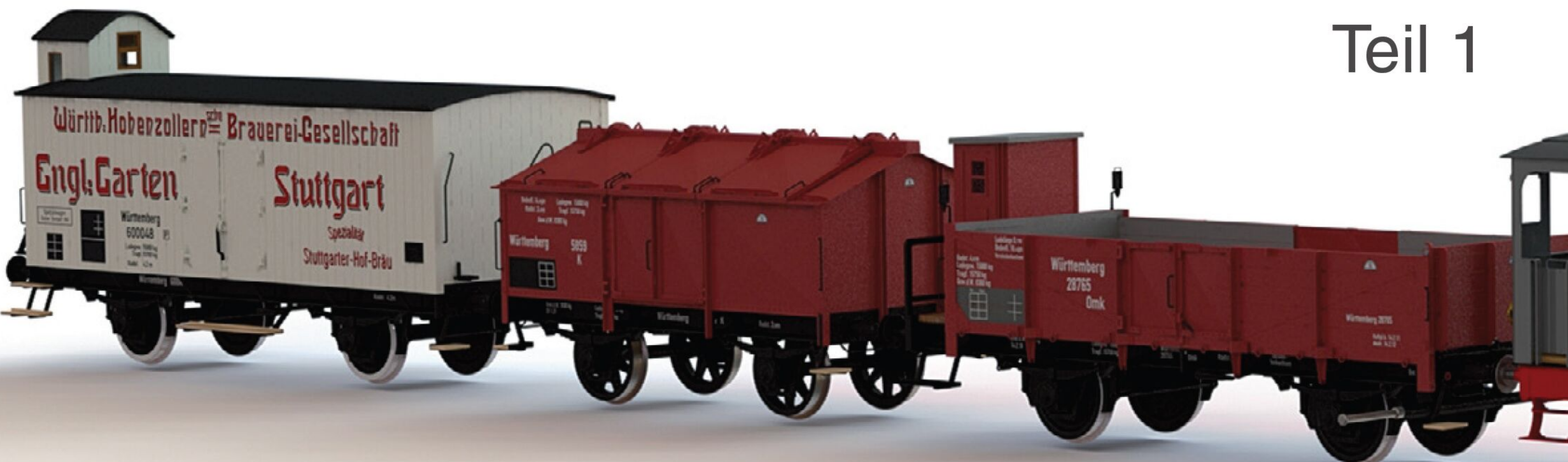
Württembergische T3, Omk Wagen, Klappdeckelwagen und Bierwagen in 3D CAD Solidworks
