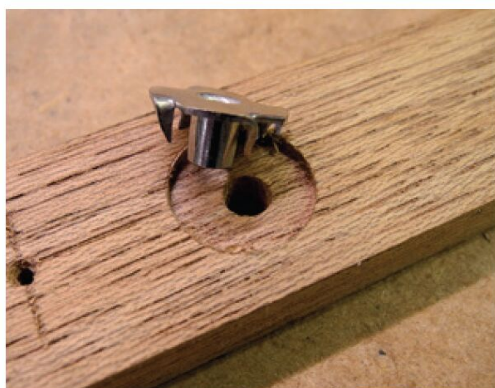
Einschlagmuttern an der Bodenunterseite des Wagenkastens
