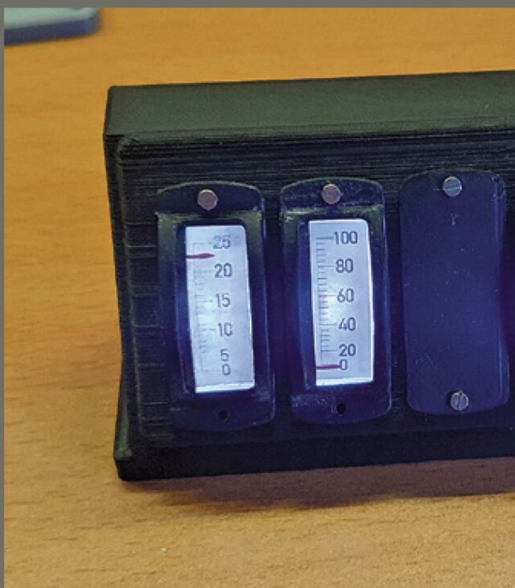
Ein Voltmeter, ein Amperemeter (beide mit eingeschalteter Beleuchtung) und die Statusanzeige (Fehler; Betrieb; Fahrt)
