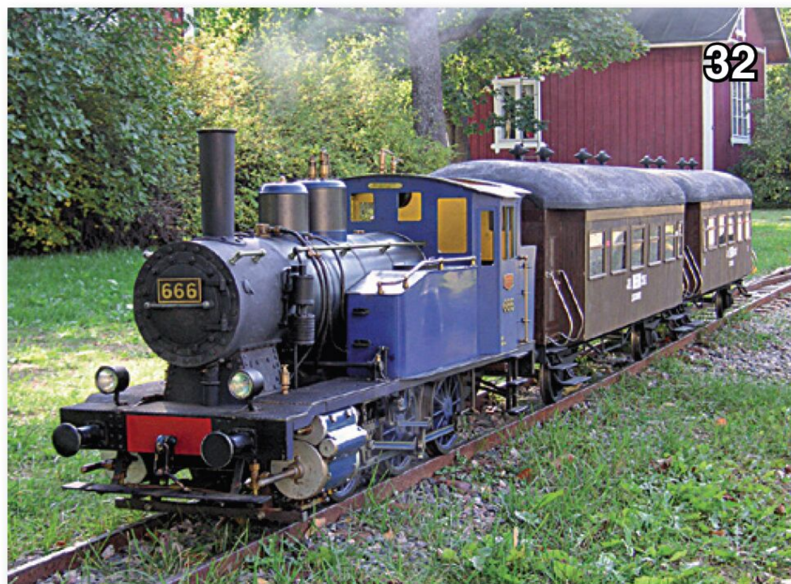
Die beiden Personenwagen können durch das Aufsetzen von detailgetreuen Wagenkästen aus Sperrholz in vorbildähnliche Reisezugwagen verwandelt werden.
