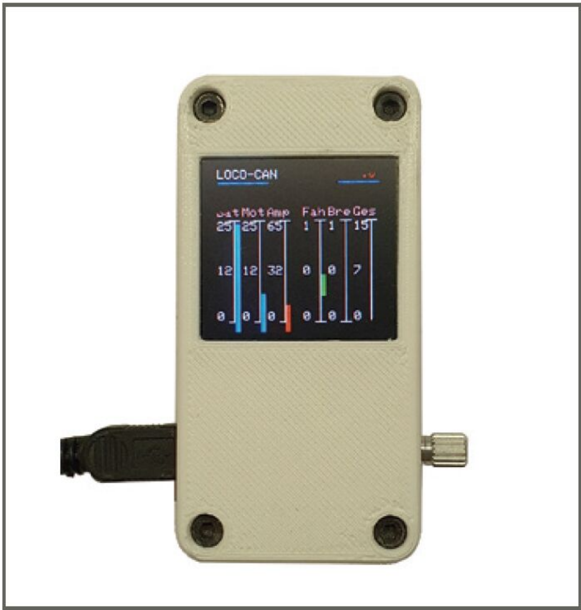
Der mobile CAN-Monitor kann Werte anzeigen, Einstellungen ändern oder eine Verbindung zu einem Laptop herstellen.
