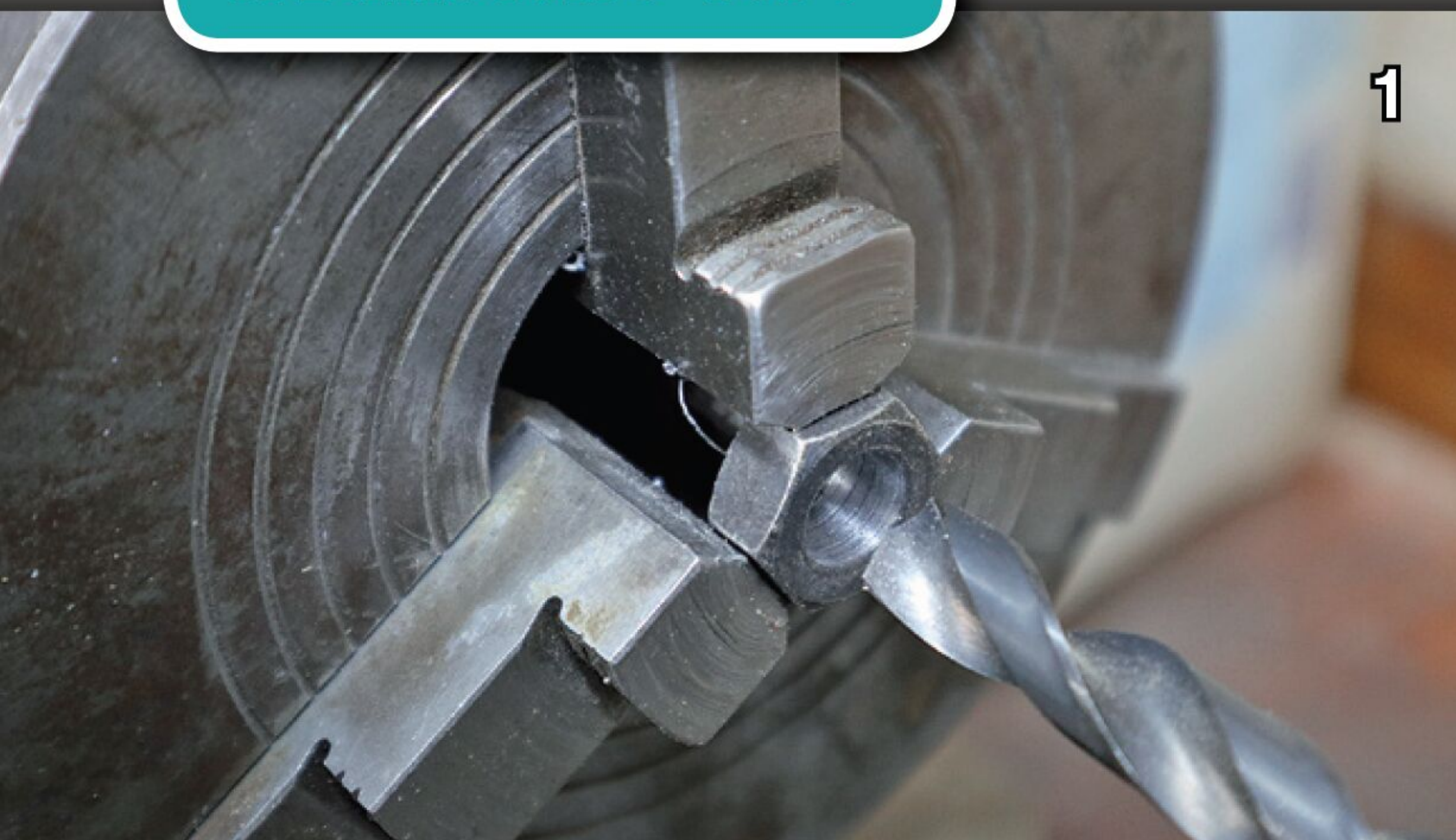
6kt-Mutter ausbohren auf Ø 10
