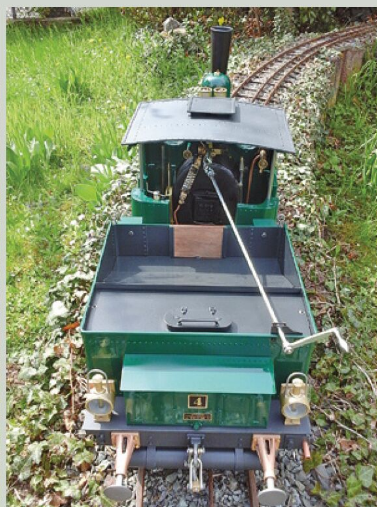
Blick von hinten, gut zu erkennen die Reglerverlängerung überm Tender
