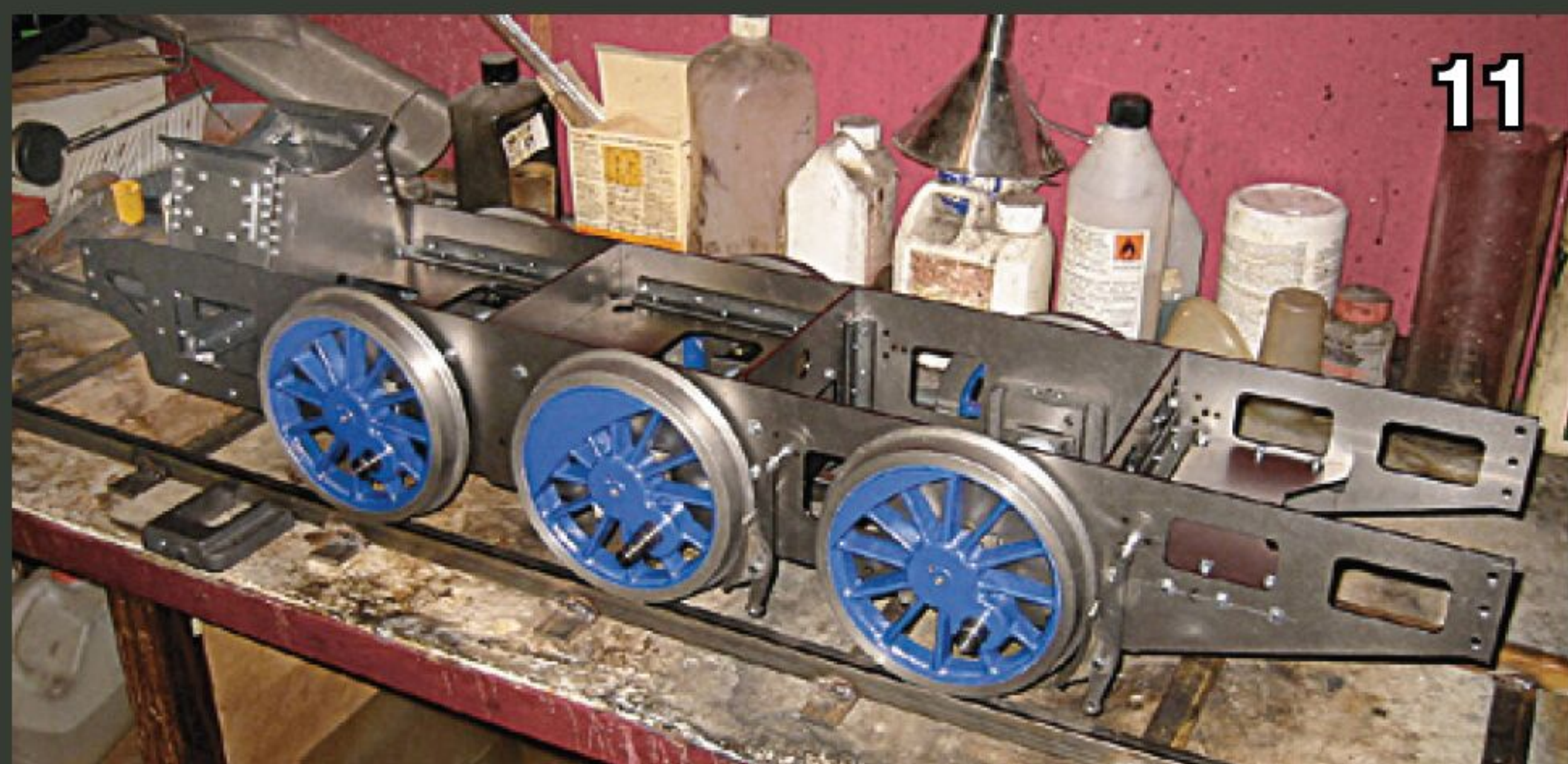
Der Rahmen ist schnell mit rechteckigen Profilen und kleinen Schrauben montiert. Die kastenartige Konstruktion macht den Rahmen trotz der relativ dünnen Stahlplatten sehr steif.
