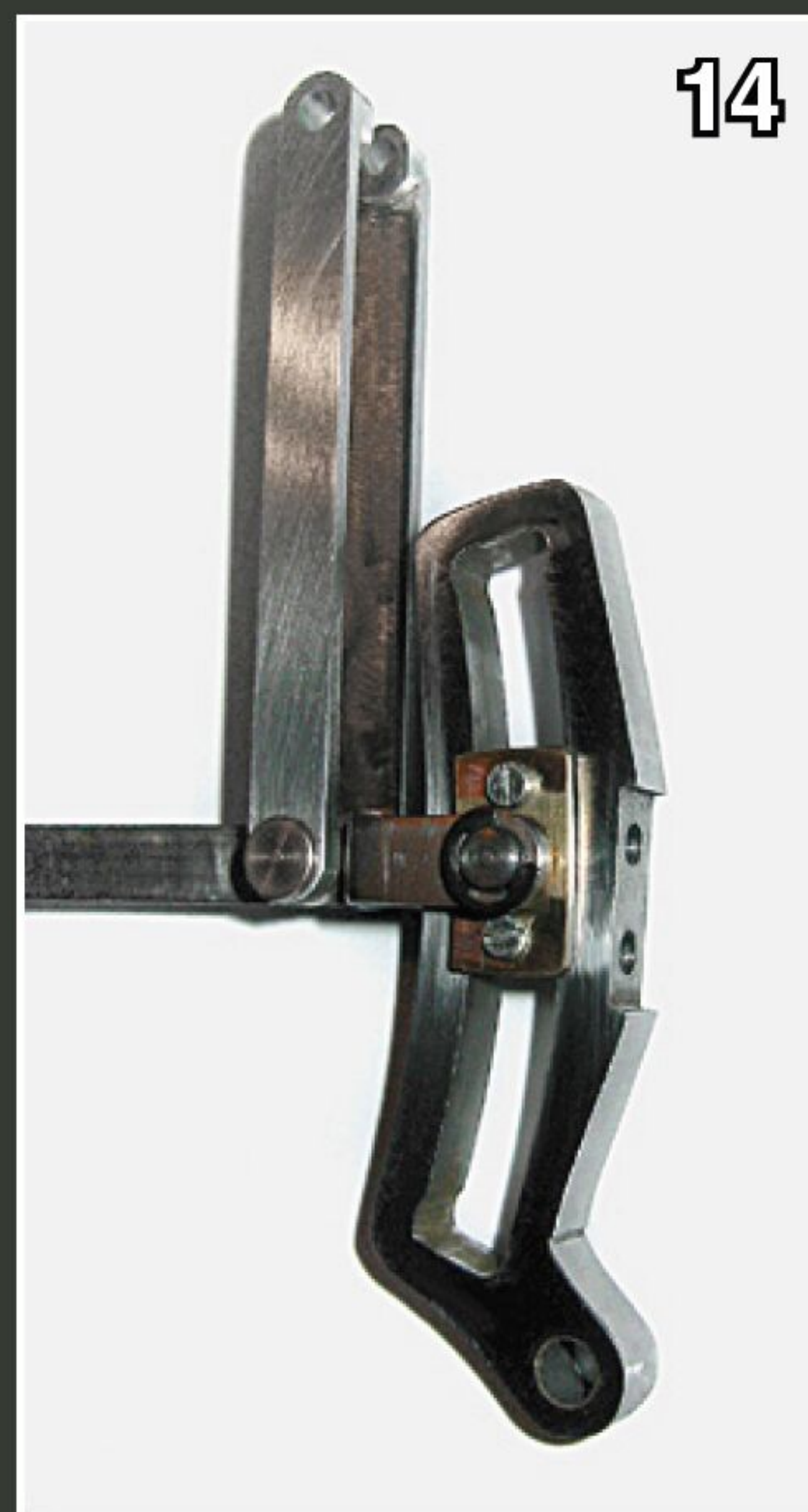
Die Teile der Walschaert/Heusinger-Steuerung müssen in engen Toleranzen hergestellt werden, damit eine genaue Funktionsweise sichergestellt ist.
