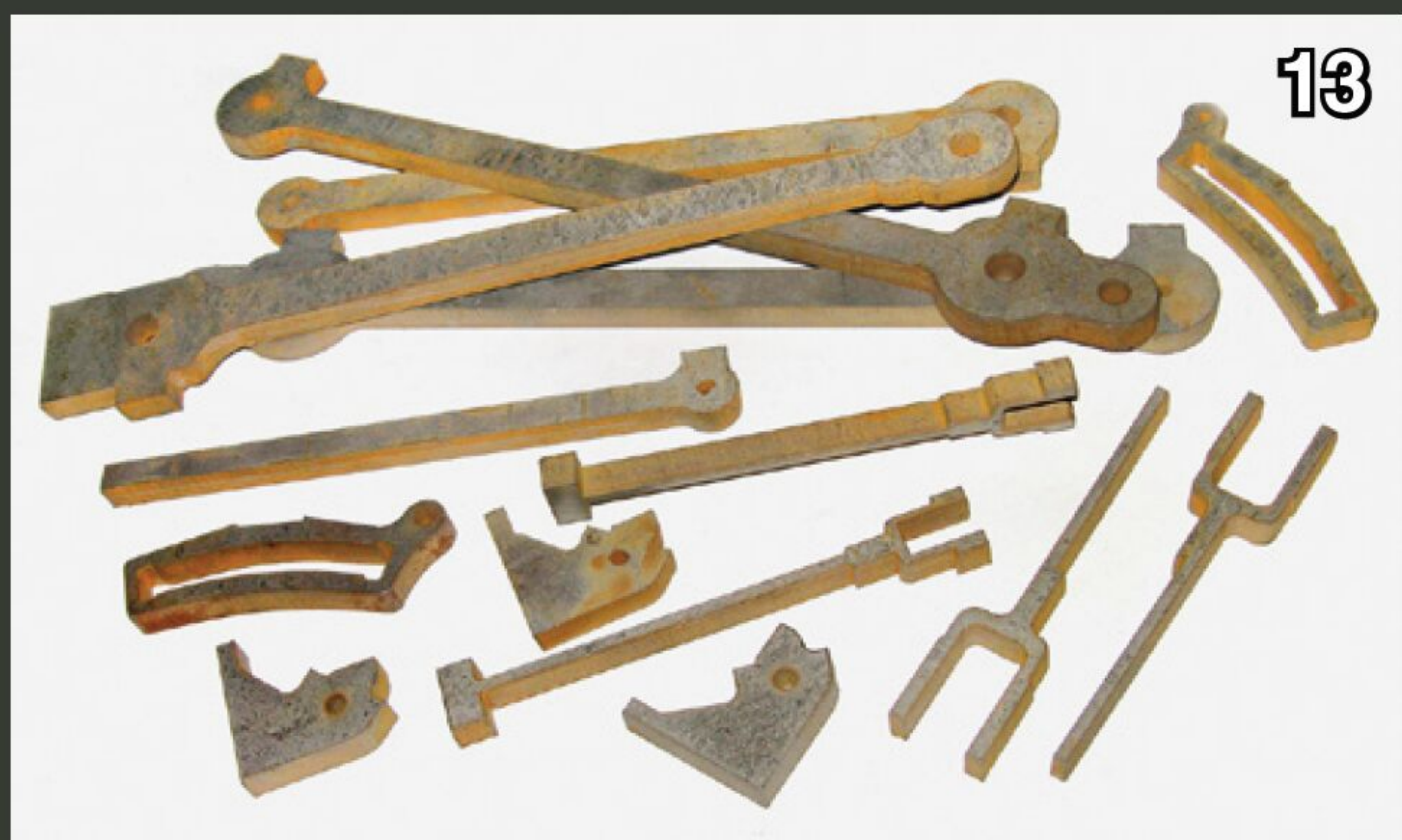
Die Teile für die Steuerung wurden aus 8 mm Stahl mit einem 0,8 mm Wasserstrahl und einem Druck von mehr als 3.000 bar geschnitten.
