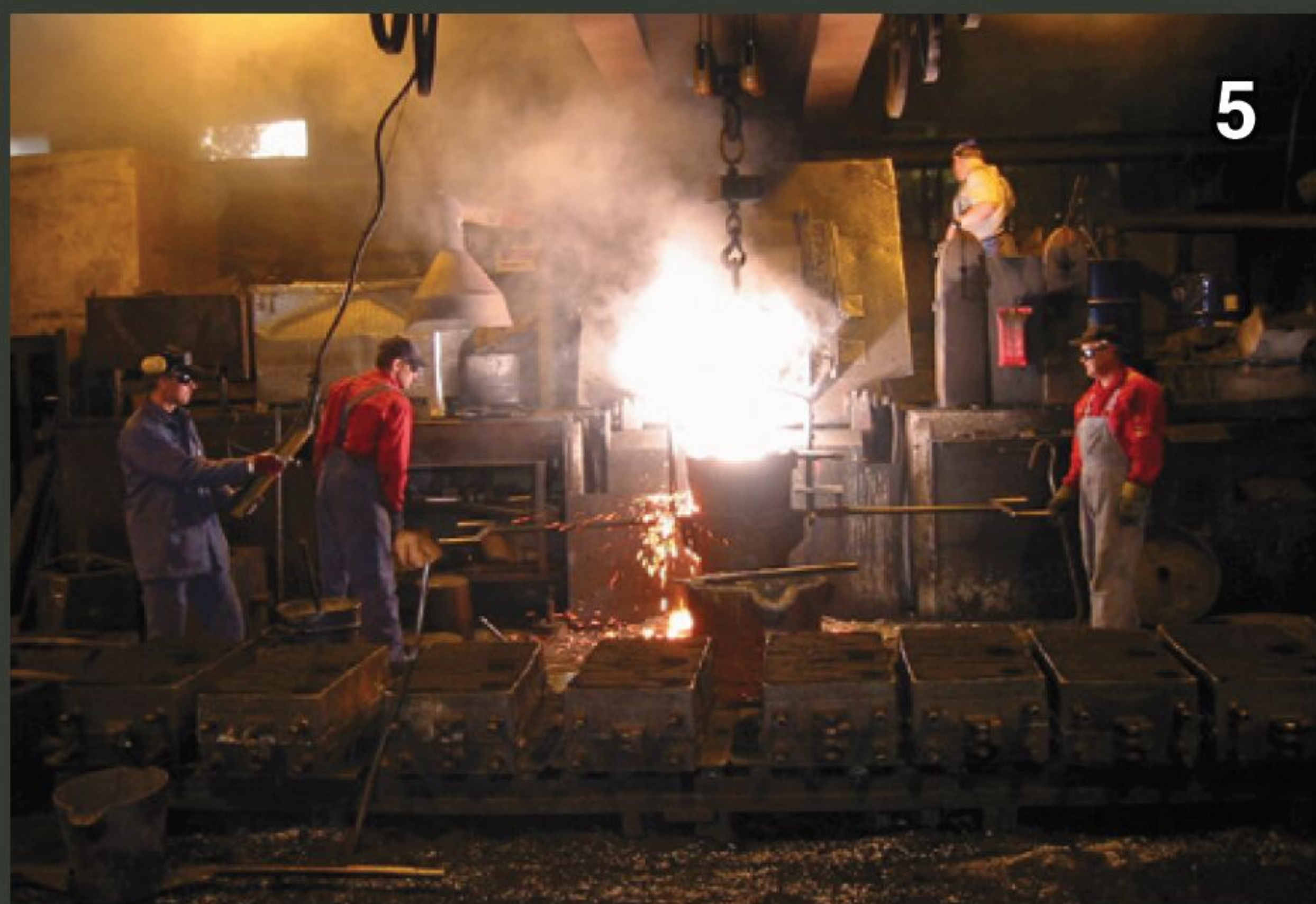
Weiglhendes flssiges Eisen wird aus dem elektrischen Induktionsofen gegossen. Im Vordergrund sind einige Gussformen zu erkennen.
