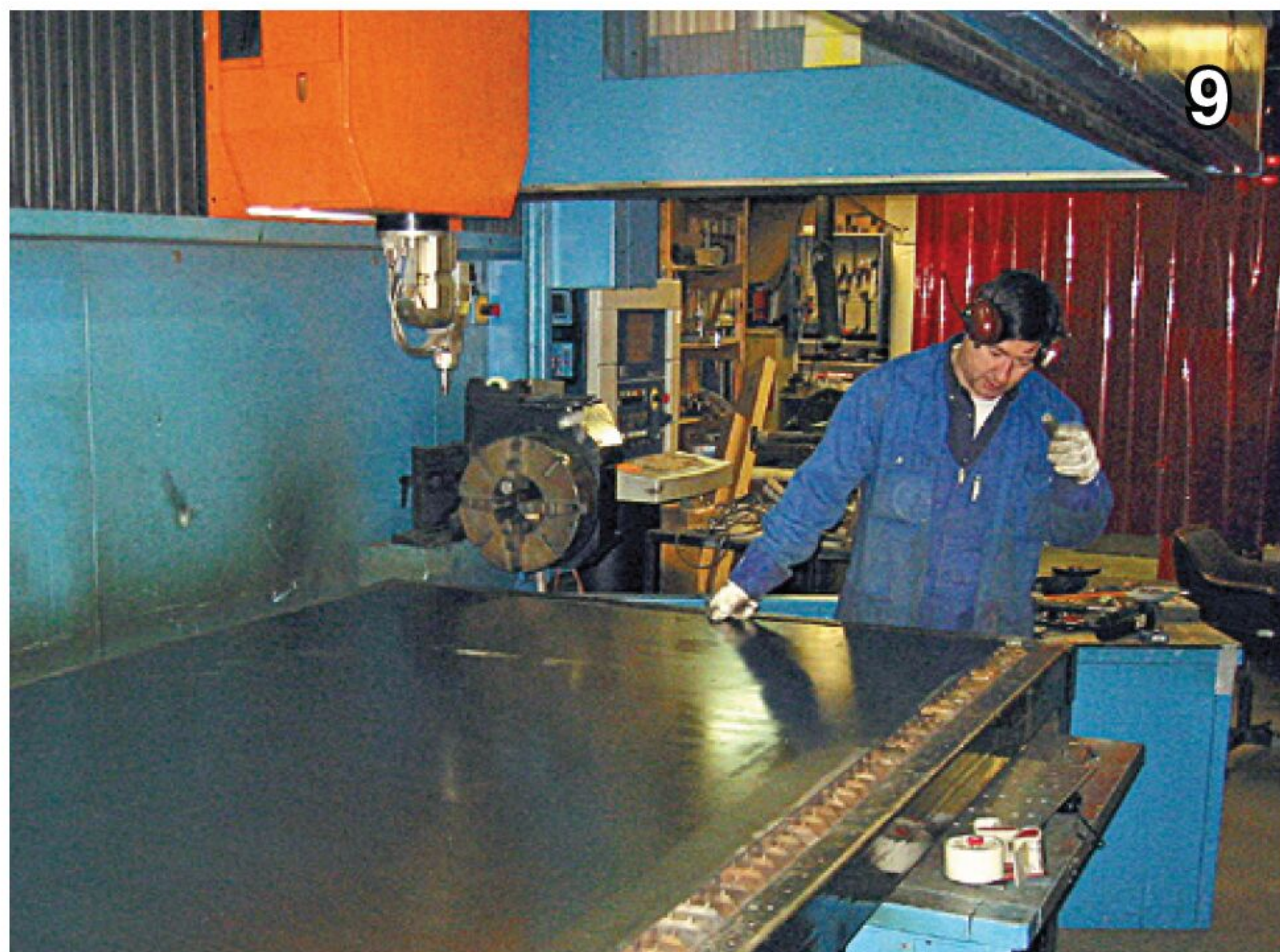
Der Laser-Maschinist legt eine 1,5 x 3 m groe Stahlplatte auf das Schneidbett. In dem orangefarbenen Kasten sind ein leistungsfhiger Laser und ein computergesteuerten Schneidkopf, welcher in 5 Achsen bewegt werden kann (X, Y, Z und zwei Drehrichtungen)
