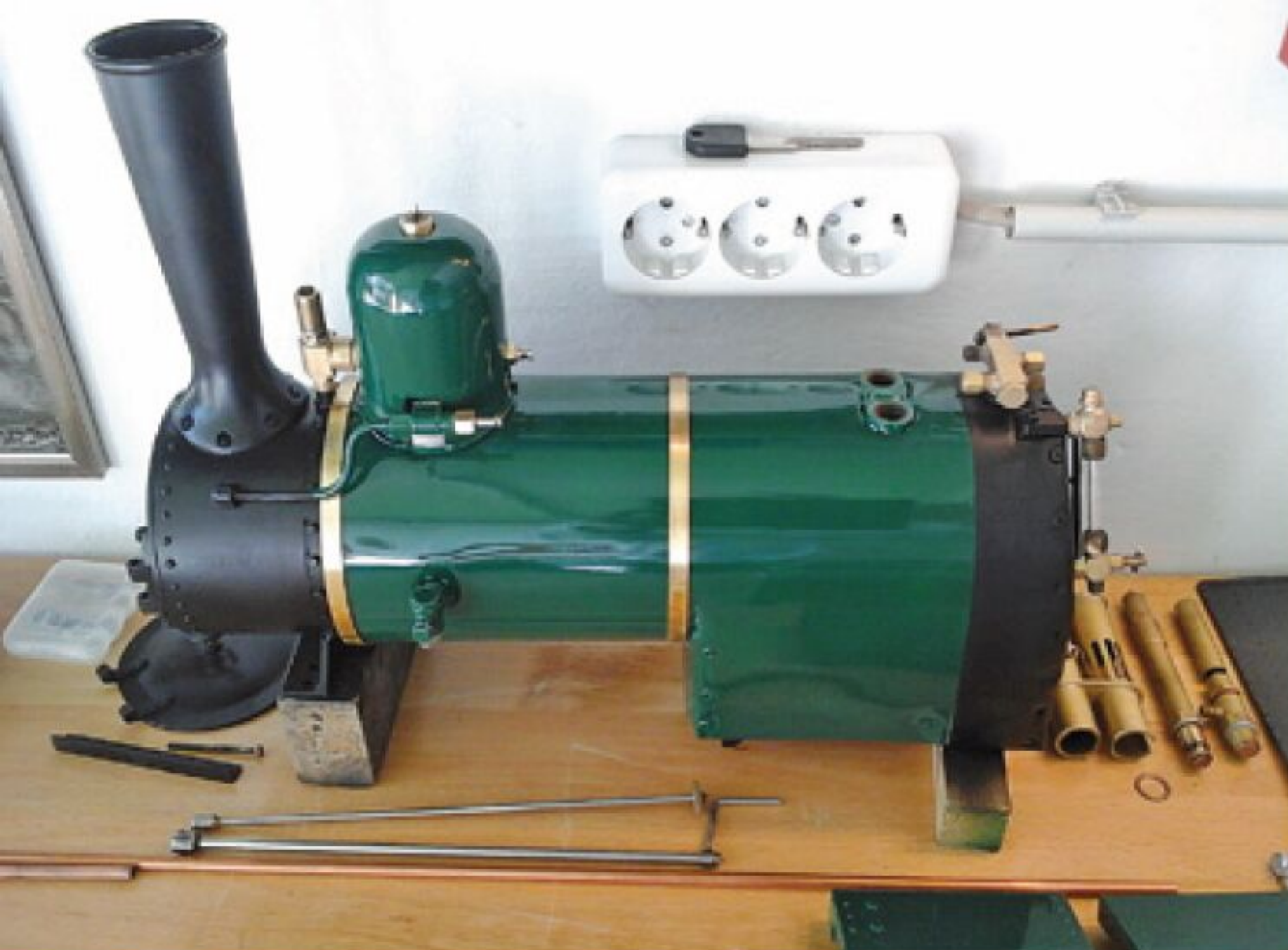
Kessel diesmal mit MS-Kesselbändern, klein, aber fein
