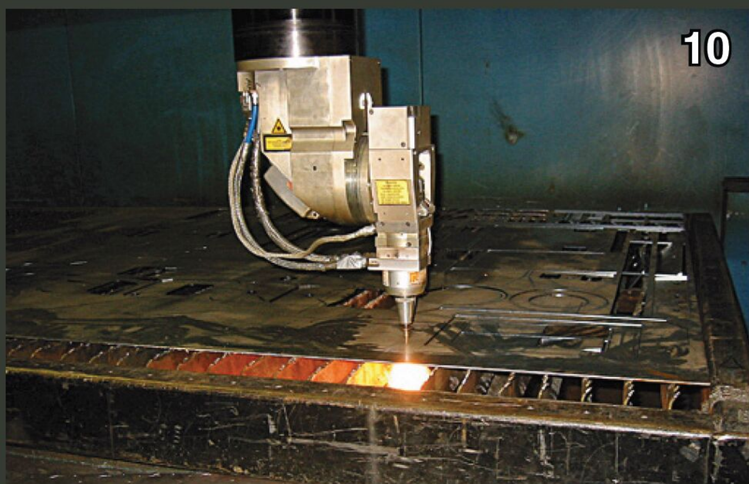
Ein 2,5 Kilowatt starker, aber nur 0,1 mm dünner Laserstrahl schneidet sich mit einer Geschwindigkeit von mehr als 50 mm pro Sekunde durch die 3 mm dicke Stahlplatte. Über hundert Teile wurden in weniger als einer Stunde aus dem Stahlblech geschnitten.
