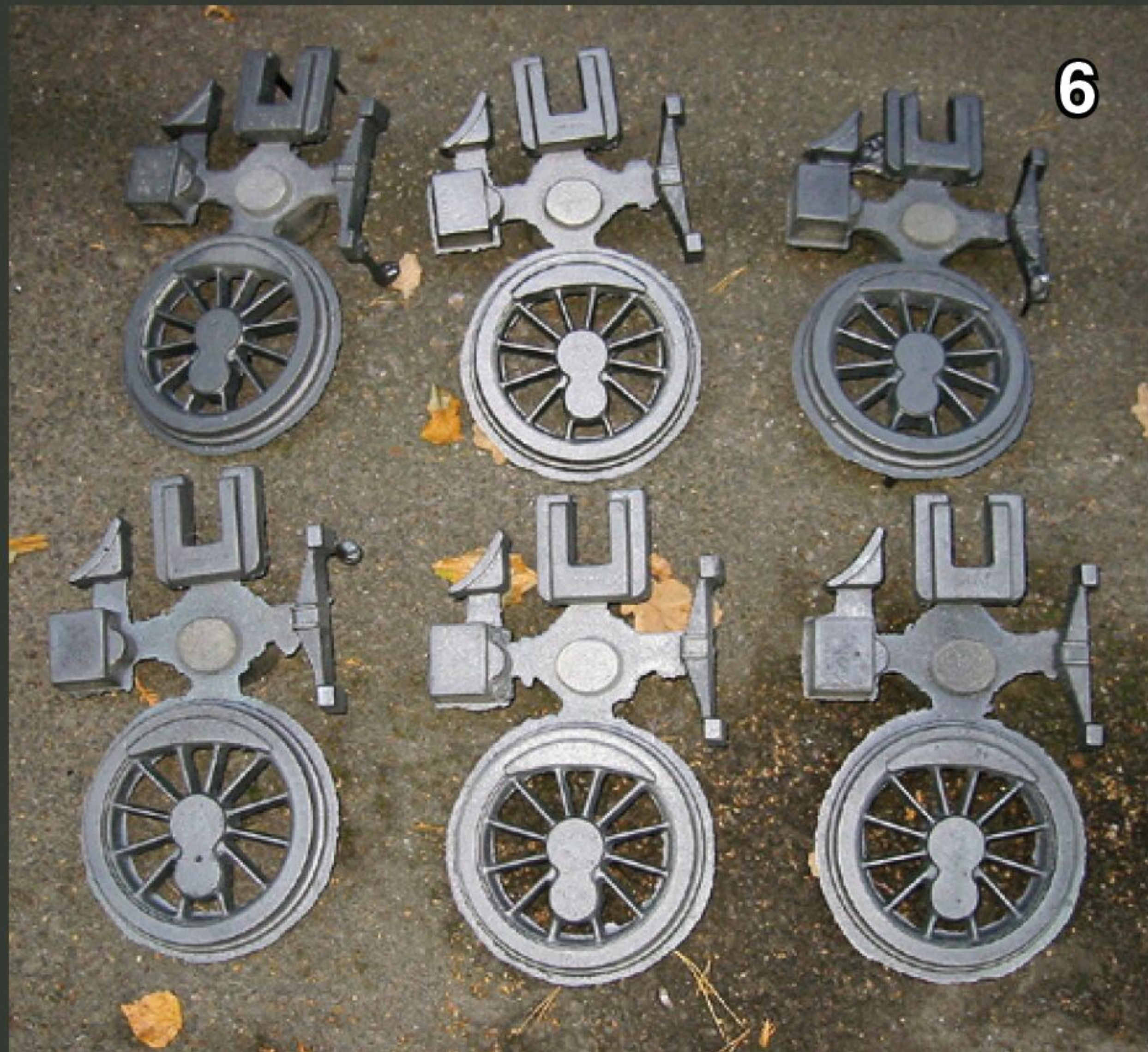
Ein Satz Rohgussteile bestehend aus Rdern, Achslager, Bremsbacken und ein paar anderen Teilen.
