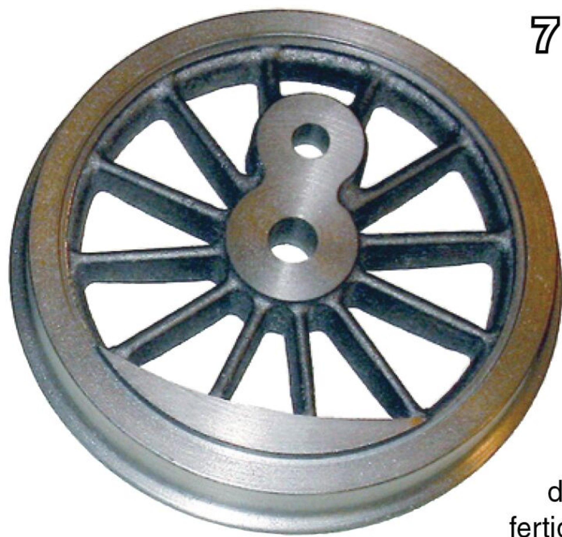
Ein Satz Rohgussteile bestehend aus Rdern, Achslager, Bremsbacken und ein paar anderen Teilen.
