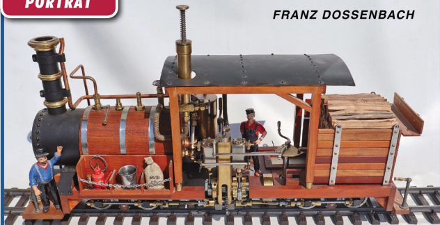
Auf diesem Foto ist der ursprünglich eingebaute handbetätigte Öler gut erkennbar.
