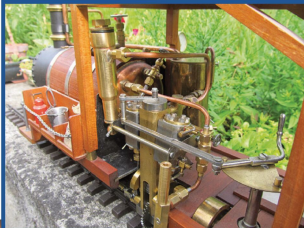
Verdrängungsöl, Hebel: Vorwärts-Rückwärts, Speiseventil
