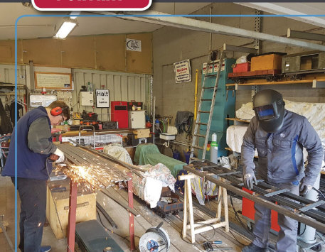
Neue Gleise und Weichen werden mit einer extra angefertigten 12-m-Radius-Gleisschablone gebaut.
