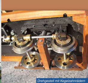
Drehgestell mit Kegelzahnradern
