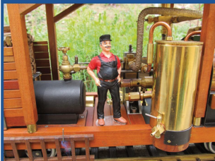
Gasbrenner, Lokführer, Kondensatbehälter
