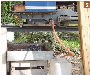
„Darjeeling“ Stehkessel mit Wasseranschluss zum Füllen und Entleeren und dem hinteren Besichtigungsstopfen und „DANGER“-Anhänger.
