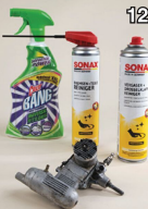
Gereinigt mit Schalldämpferreiniger und Harzentrferner.
