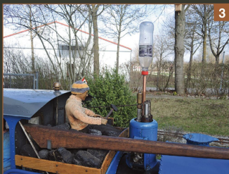
Oben auf dem Kessel das Ausdehnungsgefäß
