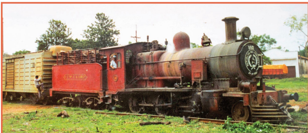
Die Zuglok des „Internacional“ in Paraguay. Man beachte das Fehlen jeglicher Bremsleitung an der Pufferbohle, am Tender sieht es natürlich genauso aus. Eine paraguayische Spezialität sind die klappbaren Puffer, die dem Rangierer die Arbeit erleichtern, sowie zusätzliche Ketten als Hilfskupplung.
