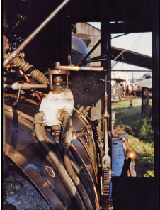
Die Dampfbremse der Baldwin – einzige Betriebsbremse auf diesen Loks!
