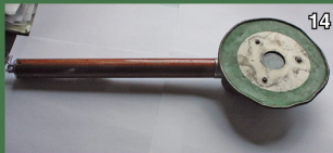
Der beleuchtete Befehlsstab von vorn. In dem langen Griff befanden sich die Batterien und der Druckschalter. Durch das mittlere farblose Glas konnte auch von hinten das Leuchten des Birchens kontrolliert werden.
