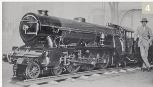
Der Flying Scotsman im Maßstab 1:3 auf 15-Zoll-Spur mit Steam-Power ohne Ende. Die Lok erhielt den Namen Green Goddess trotz fliegenden Schottens als Vorbild. J.E.P. Howey als stolzer Besitzer der Lok nach Fertigstellung 1925 bei Davey, Paxman.
