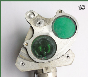
Die Rückseite, wo der Verstellmechanismus der zwei Scheiben gut zu erkennen ist. (Fotos: S. Baum)
