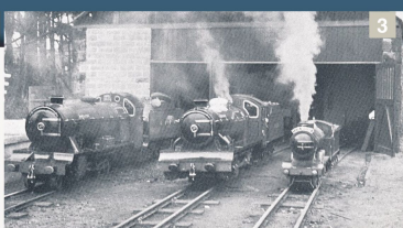
Der Größenvergleich zeigt es: links Lok River Esk im Maßstab 1:3 und rechts die Little Giant im Maßstab 1:3,8. In der Mitte steht die überbreite Heywood-Lokomotive, von der das Laufwerk weiterverwendet wurde. Der weniger leistungsfähige Ursprungskessel wurde durch einen passenden Normkessel ersetzt.
