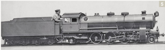
Von 1925 bis 1950 verließen 15 Lokomotiven die Werkhallen, die weitgehend baugleich waren. Umgesetzter Entwurf von Martens im Maßstab 1:3 auf 15 Zoll Spurweite.
