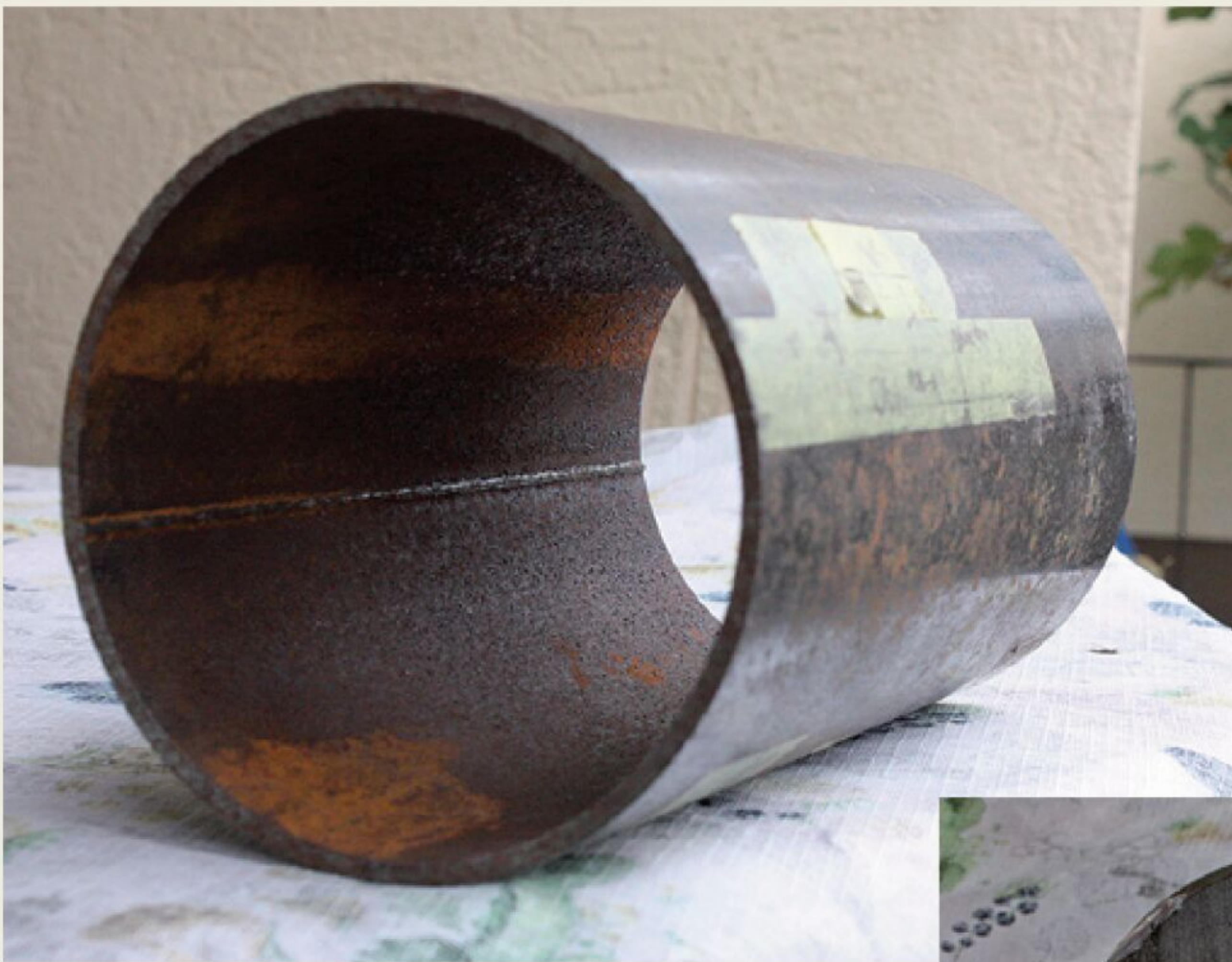
Rohrabschnitt eines Stahlrohres (vermutlich der Güte St 52), aus dem ein Kessel gebaut und dieser längst durch „Niro“ ersetzt wurde. In halber Höhe der Rohrrinnenseite ist deutlich die maschinelle Schweißnaht zu erkennen. (Foto: S. Baum)
