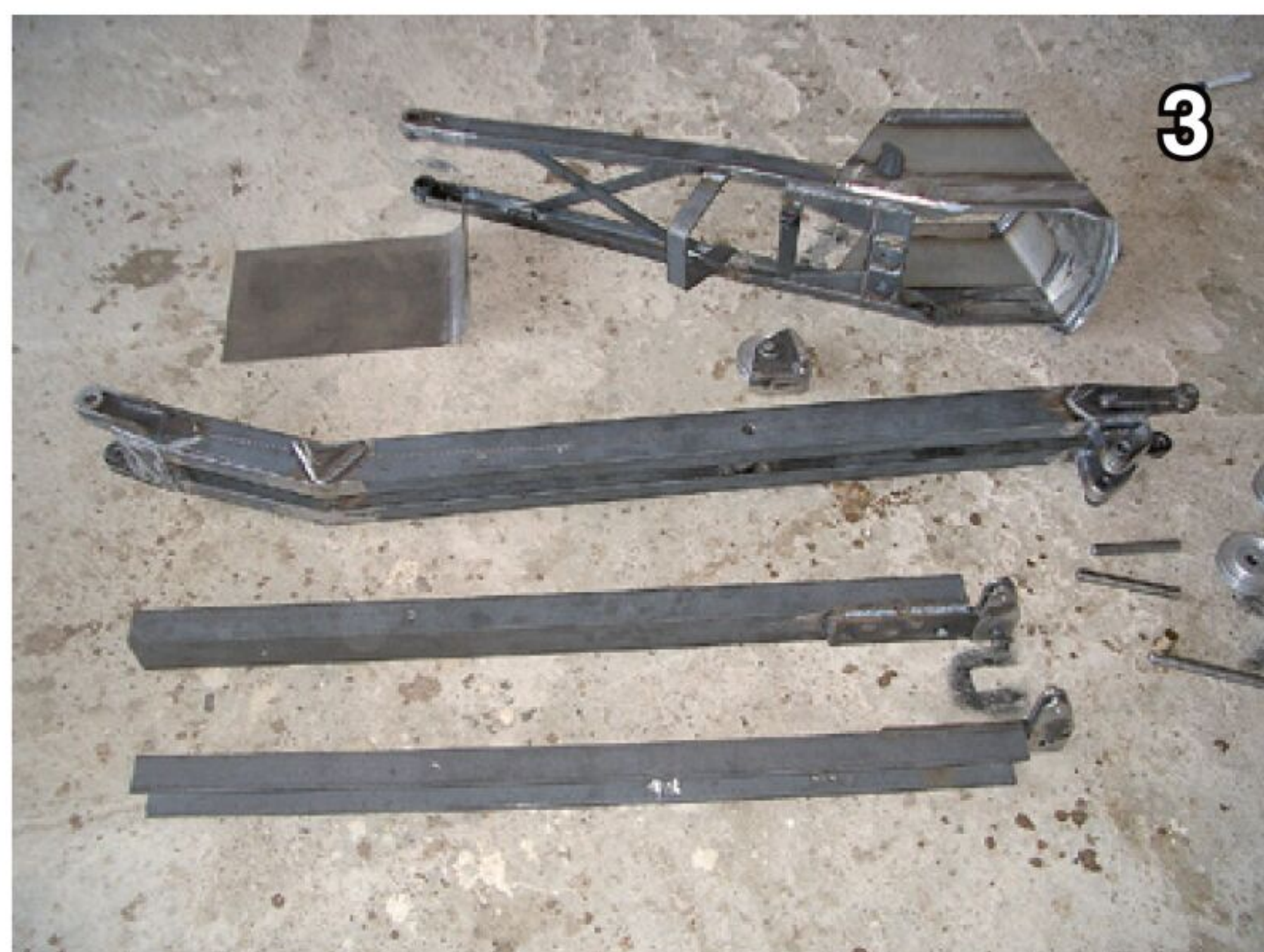
Löffel-Arm und Oberwagenteile nach dem Schweißen
