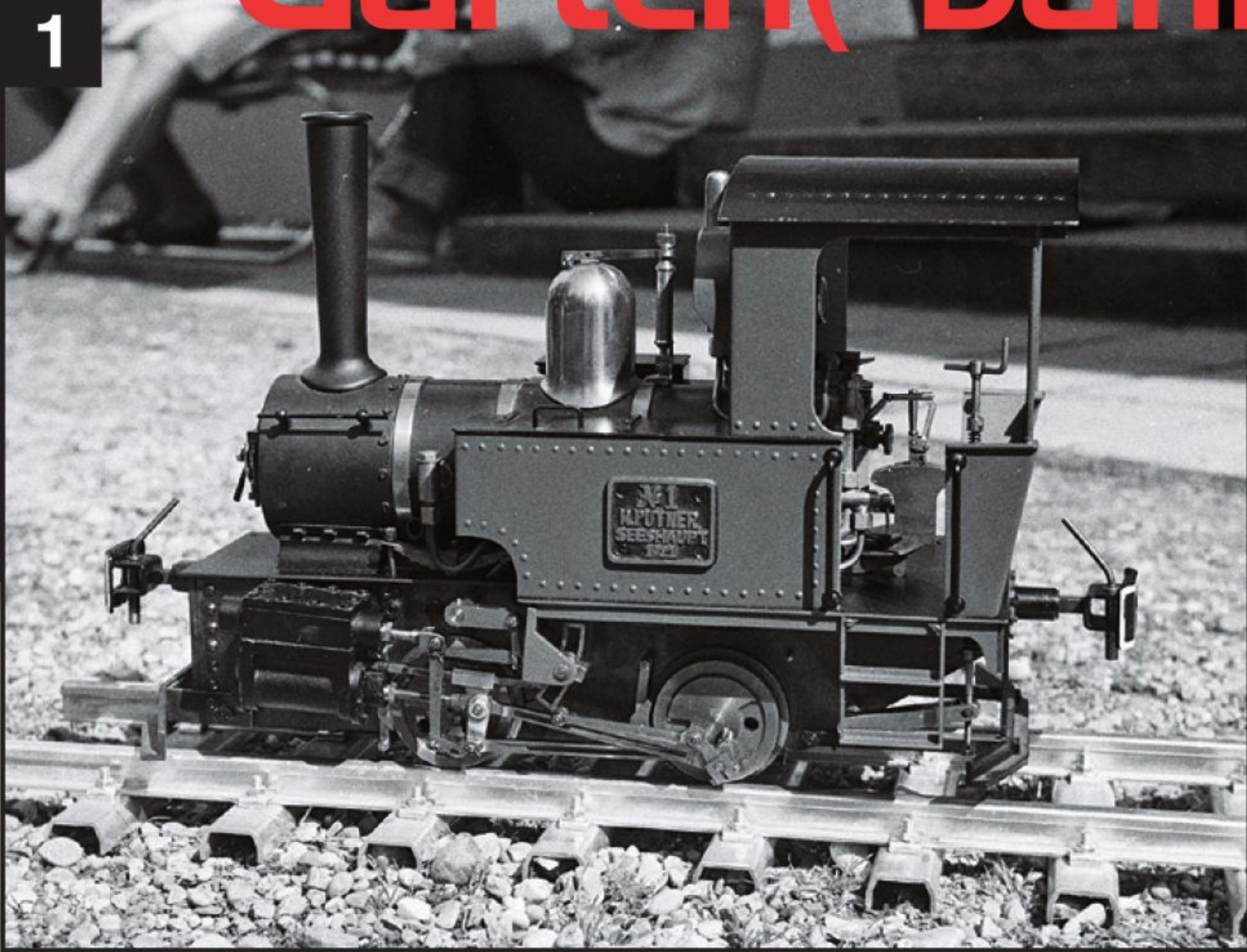
Wolfgang Putners entzückende free-lance-Feldbahnlok (Foto 1973, E. Ulrich). Mit ihrem langen Schornstein erinnert sie sehr an das Modell der Feldbahnlok der Egger-Bahn. Man beachte auch das liebevoll polierte Bronze-Gussteil der Dampfdomverkleidung.
