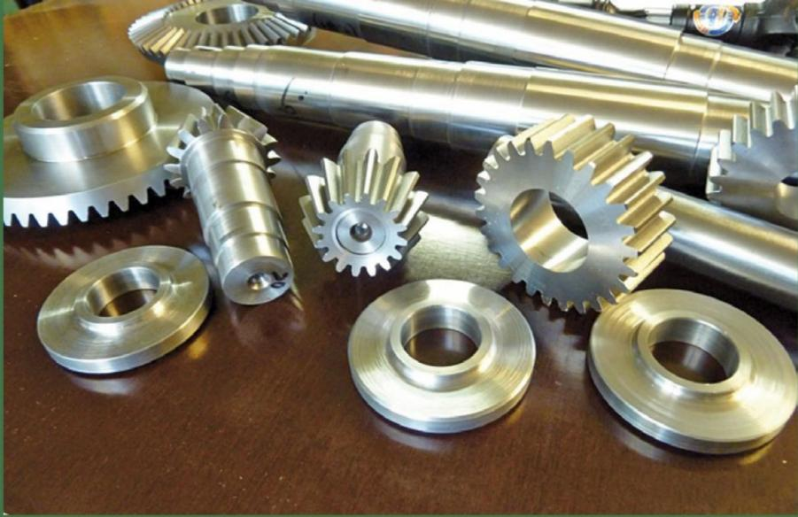
*Symphonie in C 45: Einheitlich aus dem wunderbaren Material Feinkornbaustahl, hundertstelgenau gefertigt, sind diese Achsen, Ringe und (zugelieferten) Zahnräder: Teile für eine Diesellok mit Gelenkwellen und Kegelrad-Achsgetrieb.*
