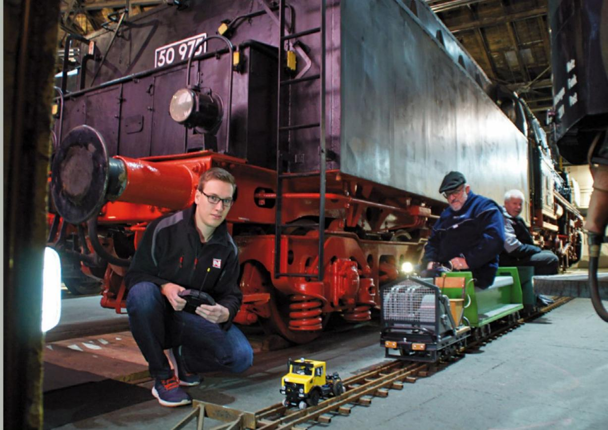
*Florian Schreiter aus Hilpoltstein hat diesen voll zweiwege-tauglichen UNIMOG mit pneumatisch betätigten Führungs-radsätzen rein aus originalen LEGO-Teilen konstruiert. Auch als Funkfernsteuerung ist ausschließlich das Fabrikat LEGO zulässig. Das kleine Maschinchen hatte auf unserem Vierspur-Gleis seine Premiere im Schienenmodus. Renaissance der 3½-Zoll-Baugröße!*
