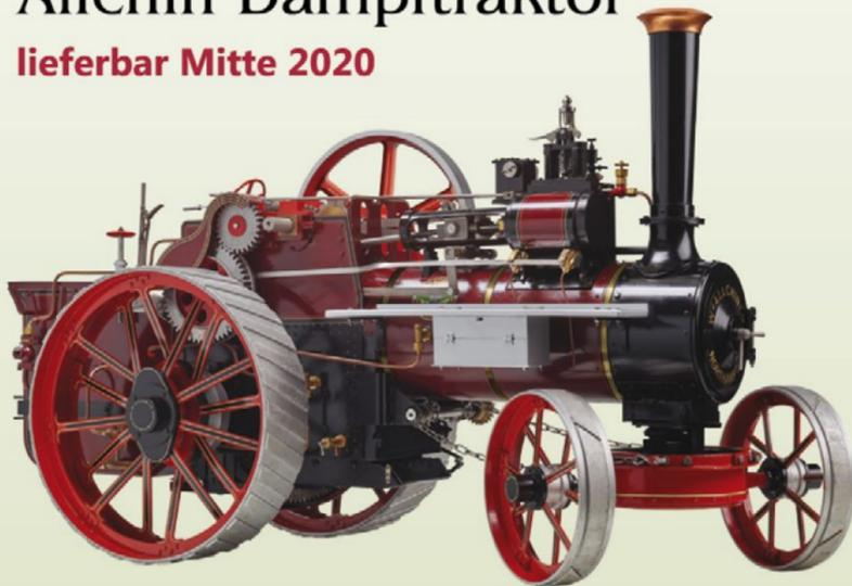
Alle Kessel sind aus Kupfer gefertigt und mit Silberlot hartgelötet. Sie werden hydraulisch auf den doppelten Betriebsdruck getestet und nach der Endmontage einem weiteren Test unter Dampf und Kohlefeuer unterzogen.
