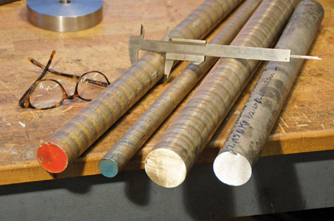
Eine weitere Form von Halbzeug ist Strangguss: Gusswerkstoffe, geliefert als Rund- oder Vierkantmaterial. Wir sehen links Lagerbronze in 3 Abmessungen, rechts außen liegt Leichtmetall-Kolbenlegierung vom Typ MAHLE 138. Der Dampflokbauer wird daneben natürlich auch noch Grauguss bevorraten!
