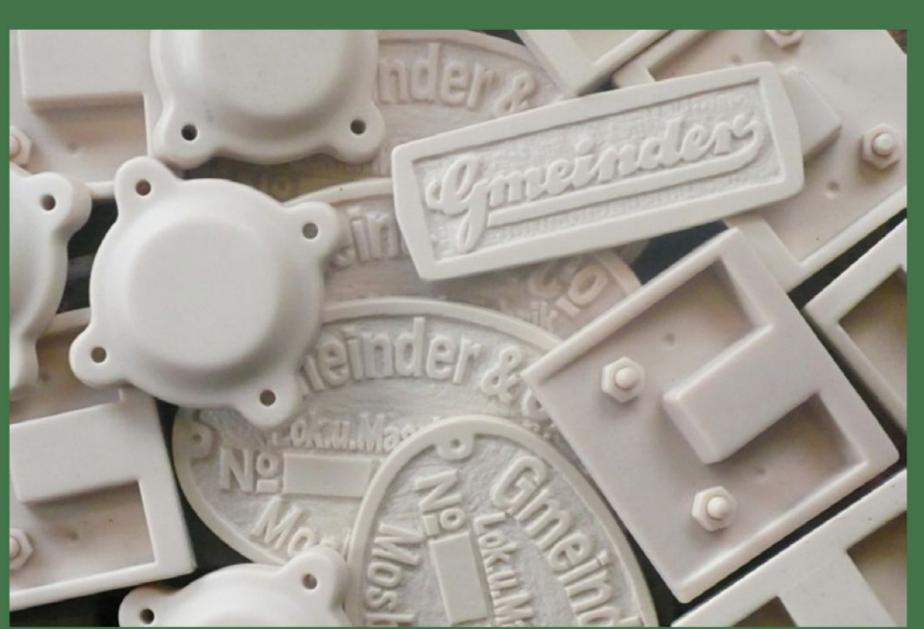
Eine Revolution im Formenbau bedeutete die Einführung von Silikon: problemlose Abformung durch das hochelastische Material, kein Verkleben, auch ohne Trennmittel! Es eignet sich ideal zum Vergießen von Gips, Beton und diversen zweikomponentigen Kunststoffen. Das rotbraune Material ist eine hitzefeste Sorte, die sich sehr gut für den Weißmetall-Guss eignet!
