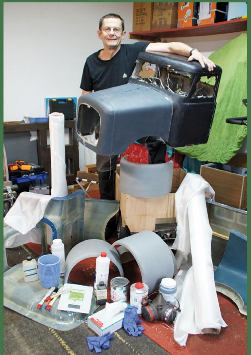
Da wird der Modellbauer zum Chemiker: Flaschen mit Reaktionskomponenten, Trennwachs und Reinigungsmitteln werden vorgehalten, dazu noch Glasseide und Carbongewebe und zur Verarbeitung die grammgenaue Digitalwaage nebst Rührstäben, Bechern und Pinseln. Und, am wichtigsten: der Schutz der Gesundheit mit Handschuhen, Einmalkittel und Atemschutzmaske! Als Produkt sehen wir das eben aus der siebenteiligen Negativform geholte Führerhaus einer KAELBLE- Zugmaschine für Straßenroller.
