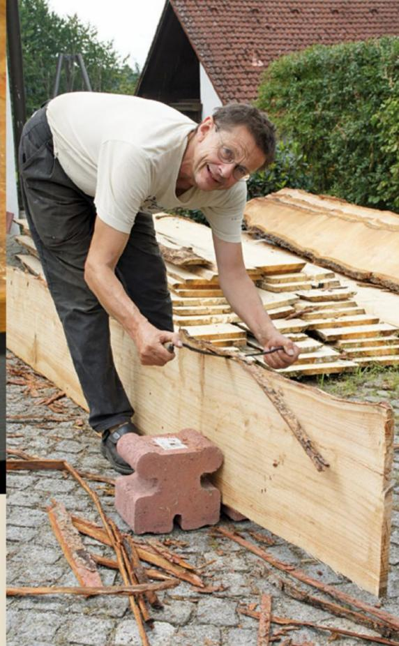
Das Sägewerk hat geliefert! Als Erstes muss die Rinde ab, denn unmittelbar darunter beginnt der Käfer sein zerstörerisches Werk! Danach wird sauber aufgeschichtet: in allen Richtungen mit der Wasserwaage tariert, auf mindestens drei Punkten schnurgerade aufliegend, gleich hohe Distanzleisten als Zwischenlage. So wird dem wertvollen Rohstoff eine mindestens zwei Jahre dauernde Trocknung für die Weiterverarbeitung ermöglicht.
