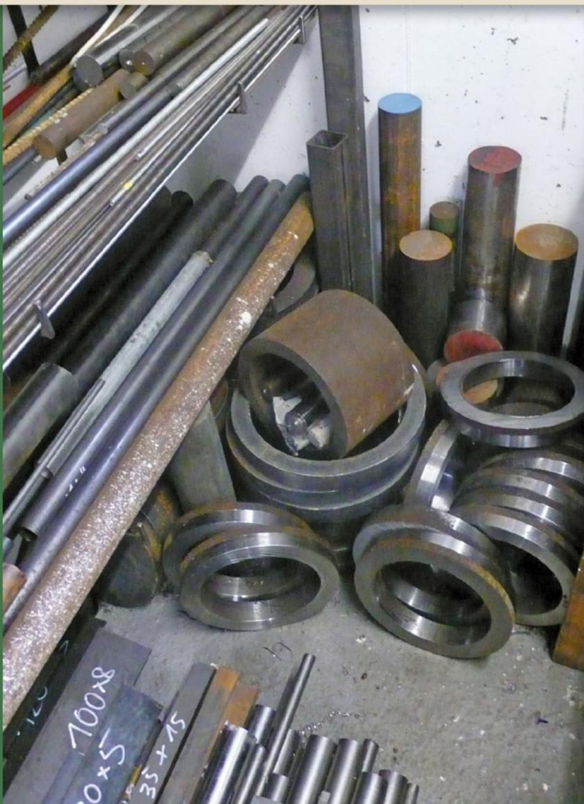
Blick in eine Ecke des Lagers: Diverse Profile aus schwarzem, gewalztem Baustahl, fein säuberlich beschriftet, daneben Blankstahl und polierte Wellen aus Feinkornbaustahl C45. Die bereits teilweise überdrehten Radkränze sind in Eigenarbeit aus Rohrabschnitten entstanden, während der größere Durchmesser (340 mm) als Auftragsarbeit aus 40-mm-Stahlblech plasmageschnitten wurde.
