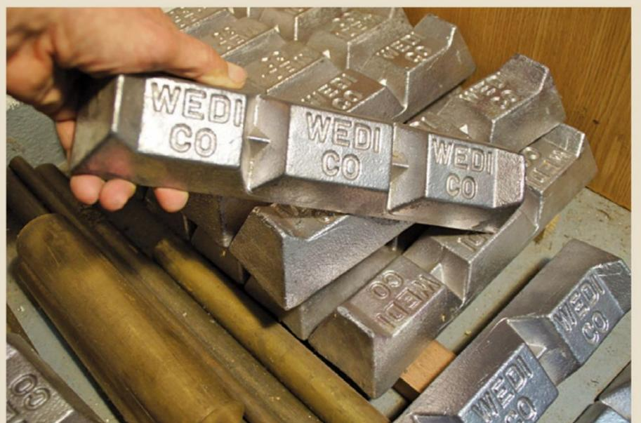
*Weißmetall-Lagerlegierung kauft man in Barrenform. WM 10 besteht überwiegend aus (giftigem!) Blei und kann bei einem Schmelzpunkt von ca. 280 Grad bequem mit Hilfe einer Propanfeuerung vergossen werden.*
