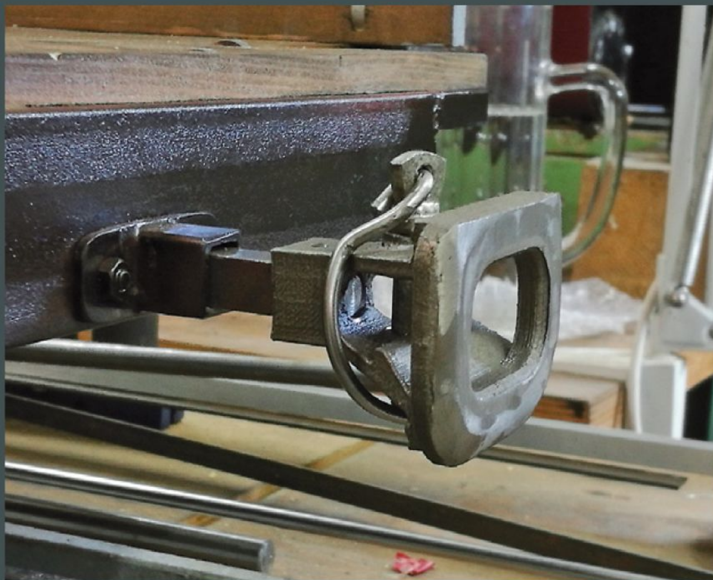
Da alle Bohrungen mitgegossen sind, muss nur der Anguss entfernt werden
