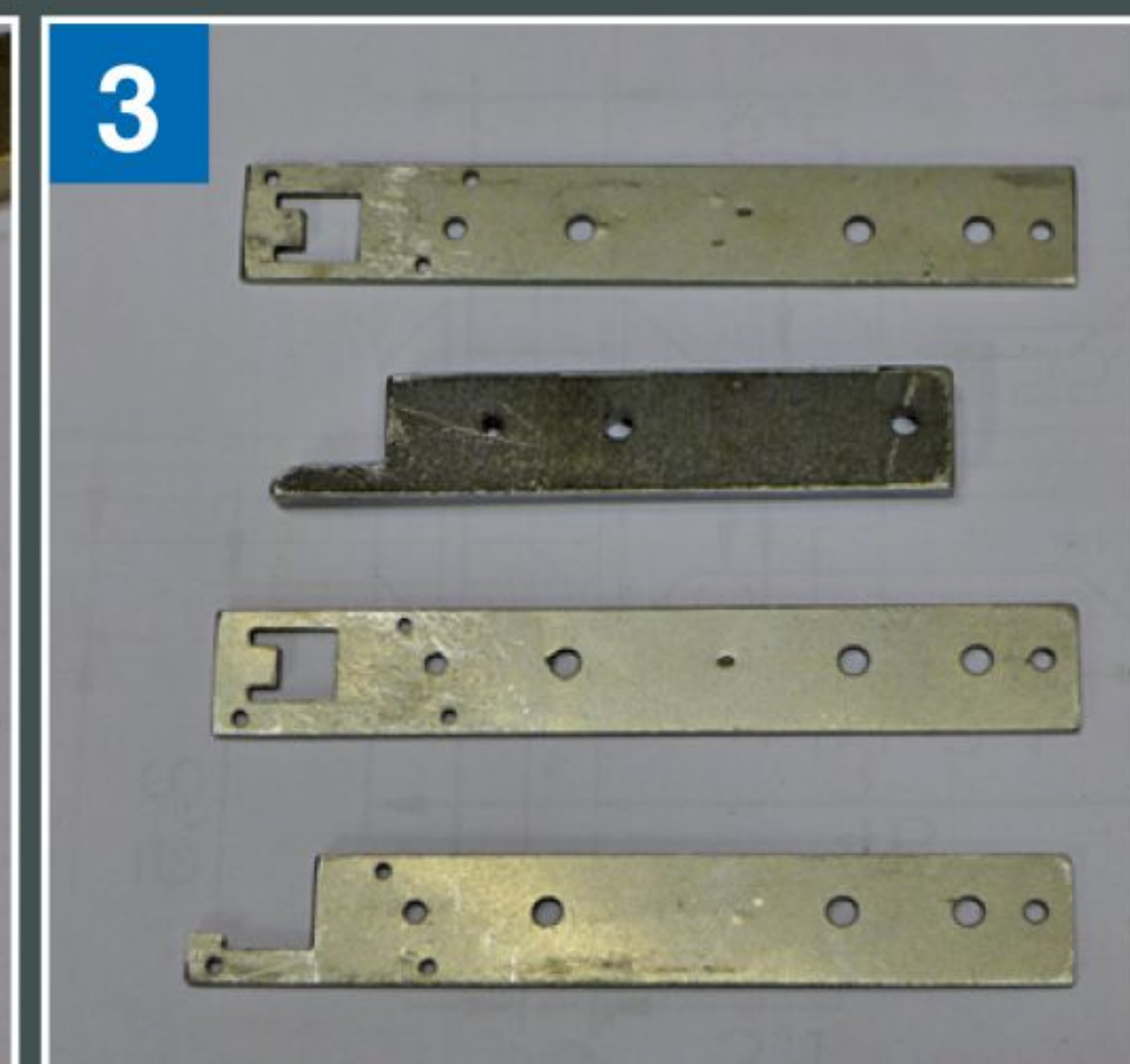
Blechteile 2 und 6 mm (Laserteile) nach Zeichnung 1 – 3
