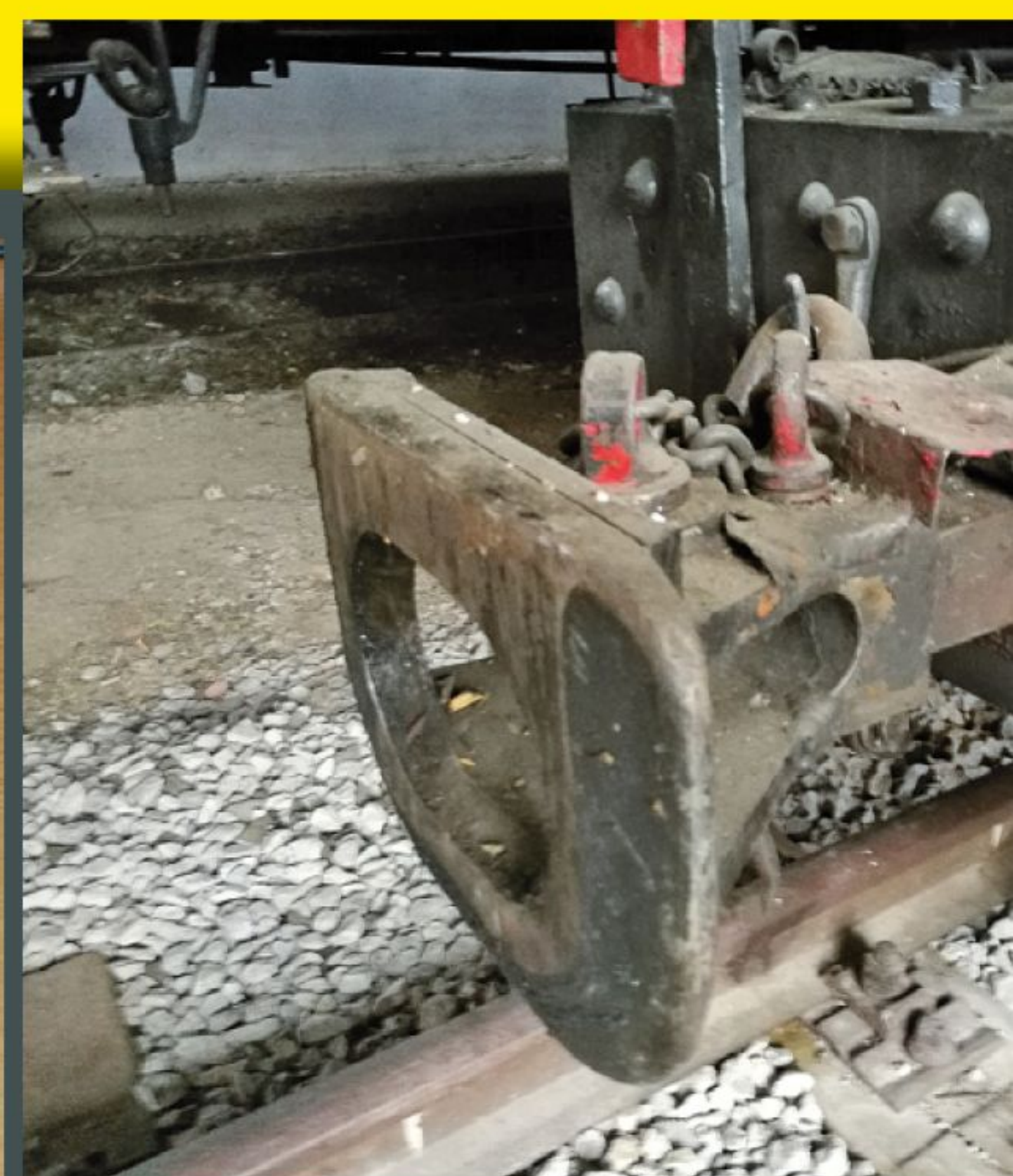
Kupplungskopf der bosnischen Kupplung auf der Mariazeller Elektrolok 1099.02 im Depot des Technischen Museums Wien
