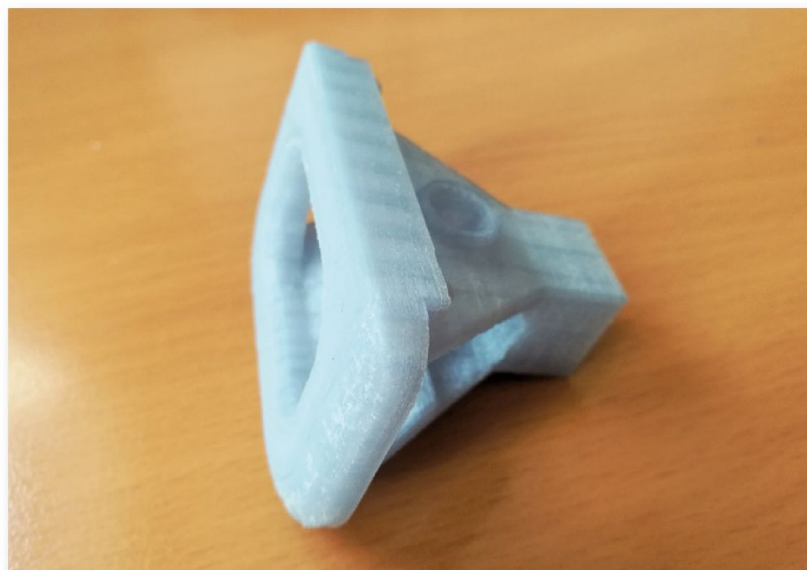
Das fertig gedruckte Modell eines Kupplungskopfes in Moldlay
