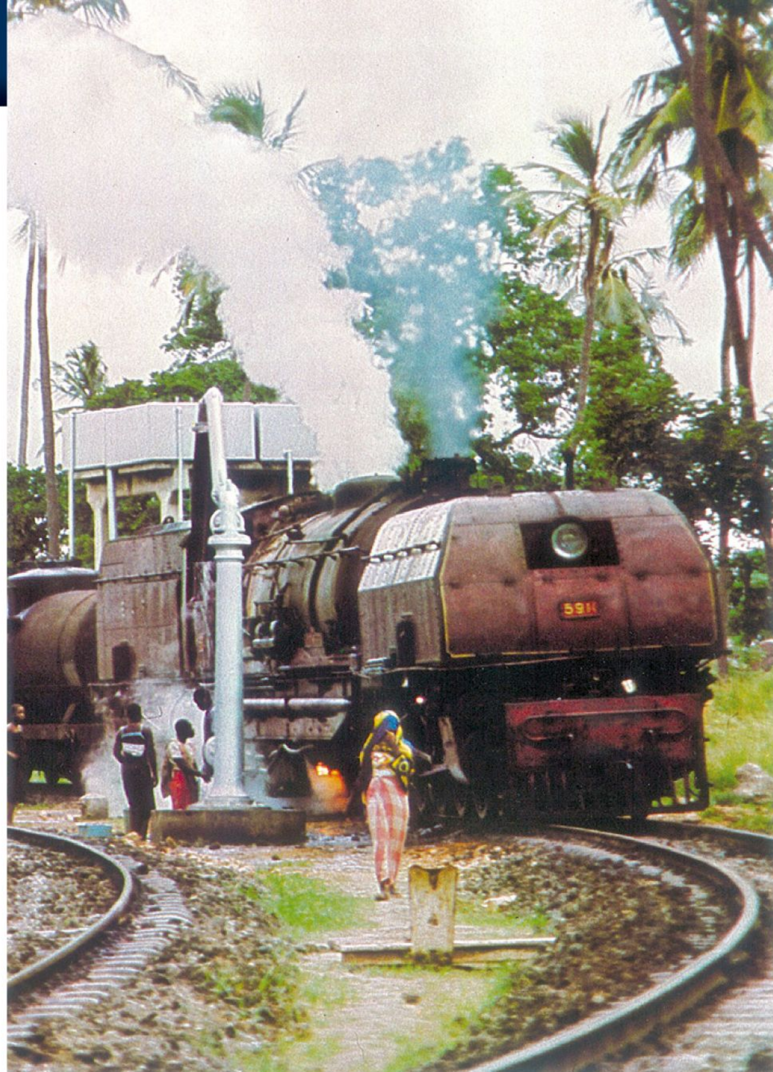
Die Öl-gefeuerte 5911 „Mount Sekerri“ der EAR mit der Achsfolge 2D1+1D2 braucht Wasser. Die Tender hatten ein Fassungsvermögen von 39 m³ und an Heizöl konnten 12,3 m³ gebunkert werden. In einem LOKMAGAZIN-Beitrag von 1973 werden Loks der Reihe 59 als die „größten Dampfloks der Welt“ bezeichnet! Die wenigen Fotos lassen erkennen, dass alle 34 Maschinen Giesl-Kamine hatten!
