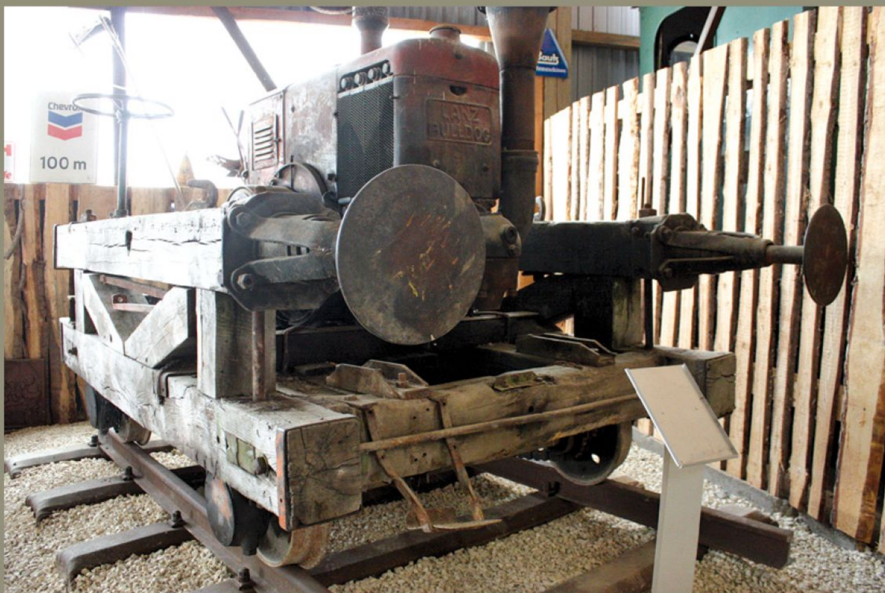
Das Unikum einer „handgemachten“ Rangierlok. Die „Zug- und Stoßvorrichtung“ besteht aus zwei alten Puffern, die mit einiger Wahrscheinlichkeit von einem alten Länderbahn-Güterwagen stammen könnten. Ein Kupplungshaken ist nicht zu entdecken! An der rückwärtigen „Lokseite“ ist „weder-noch“ zu finden! Foto: S. Baum
