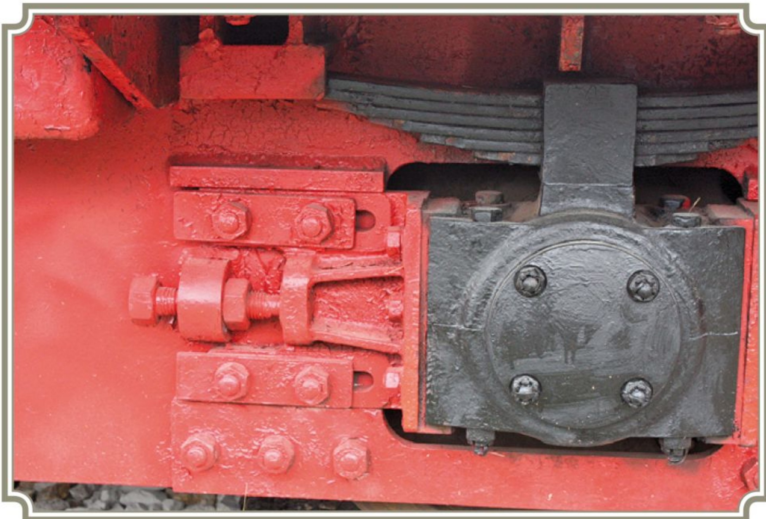
Das nachstellbare Lager einer privaten Rangierlokomotive von der „Güte“ einer Köf III, die beim BEM Nördlingen überlebt hat. Foto: S. Baum
