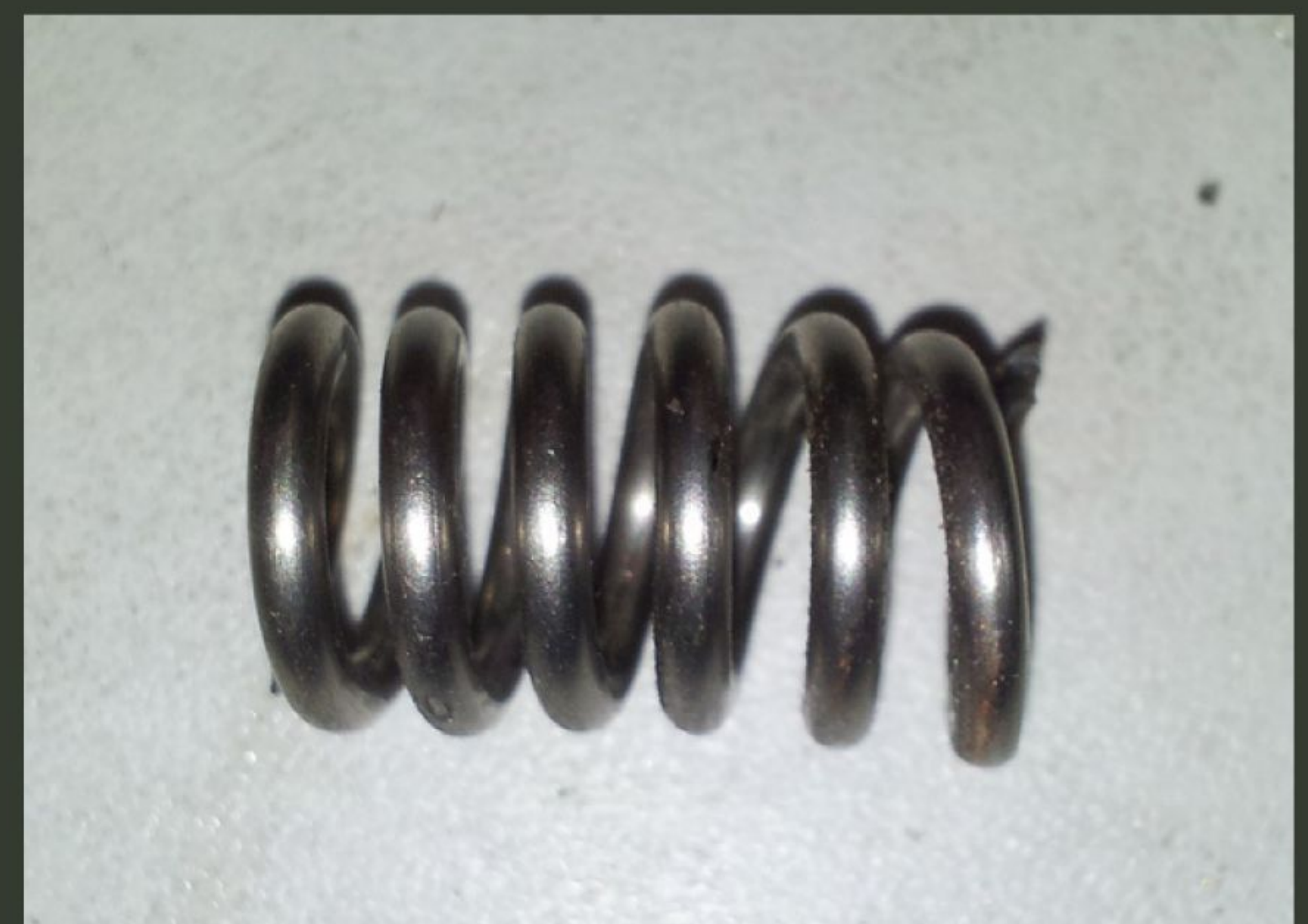
Meine erste gewickelte Feder. Als Wickelkern diente ein Bohrer.
