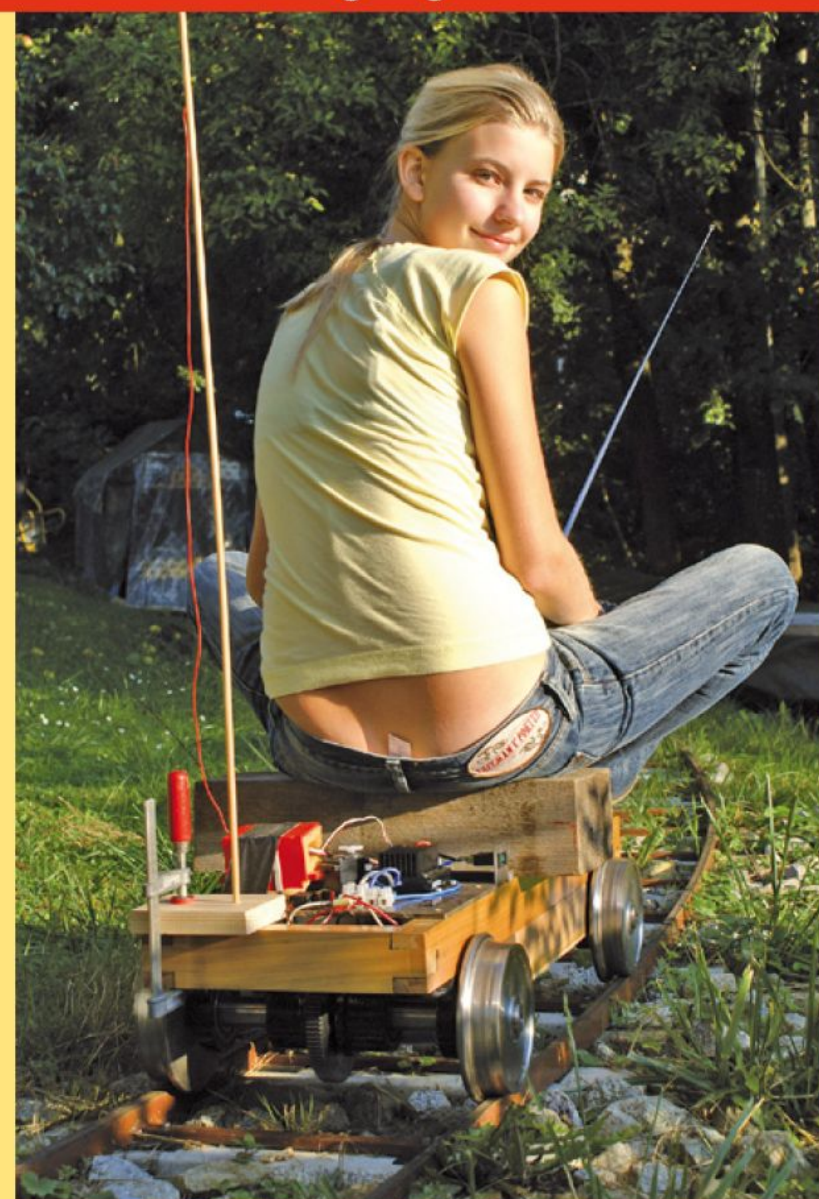
Ein erster Anlauf im Jahre 2007, noch mit analoger Technik, war wenig erfolgversprechend. Unbeherrschbare Funkstörungen durch Bürstenfeuer der Kollektoren ließ das Testfahrzeug zwar nicht außer Kontrolle geraten, aber die stets ruckelnde Fahrweise machte wirklich keinen Spaß! Äußerst sperrig waren auch die 1,5 m lange Senderantenne und das einen ganzen Meter messende Empfangskabel!
