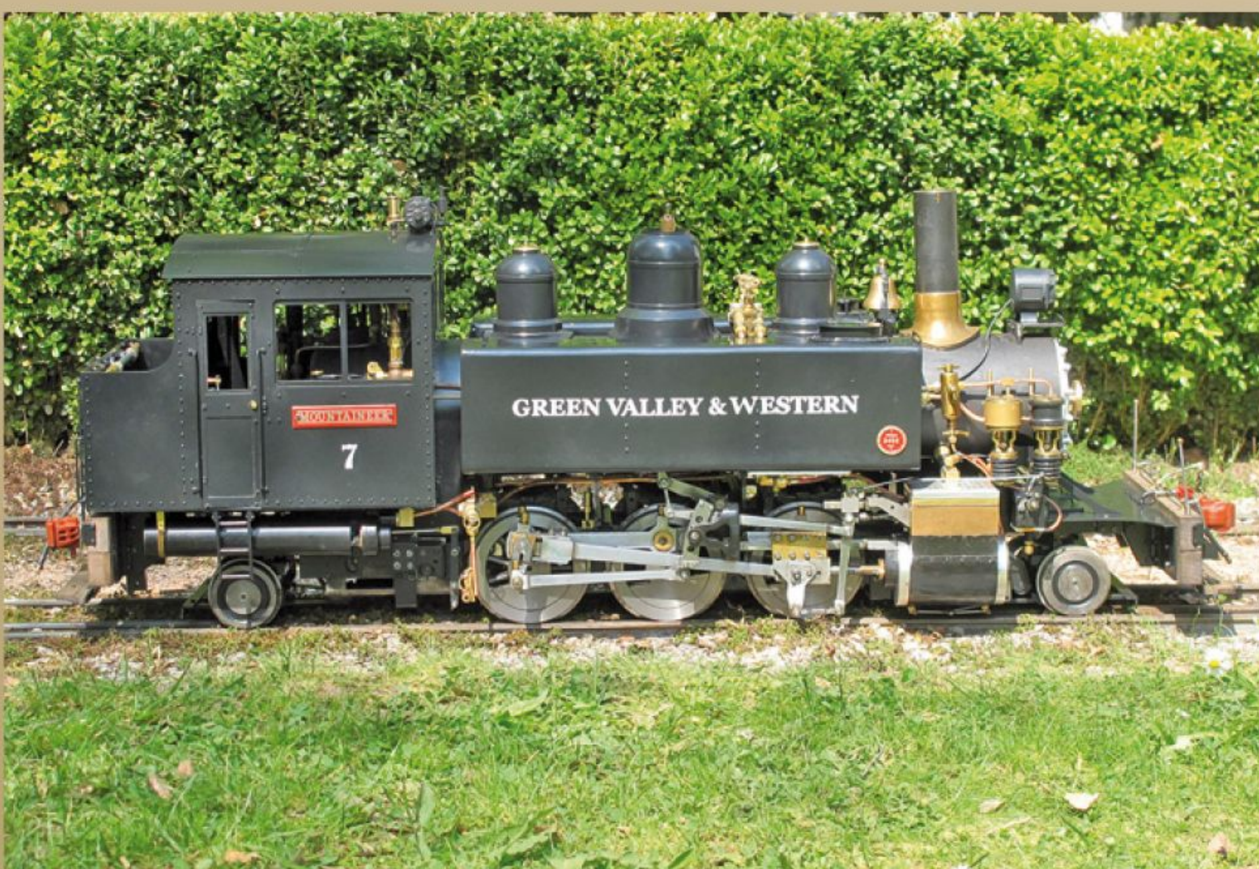
GV&W Nr. 7 in der Seitenansicht. Auch wenn es auf den ersten Blick nicht so aussieht, die Grundmaße des Fahrwerks sind gegenüber der Ausgangslok nicht verändert worden, vom Umbau von Außen- auf Innenrahmen abgesehen. Unter dem Führerhaus ist Platz genug für die Mehrklangpfeife, die Pumpen sind auf der rechten Seite konzentriert, wie es auch bei den Vorbildern gelegentlich der Fall war.
