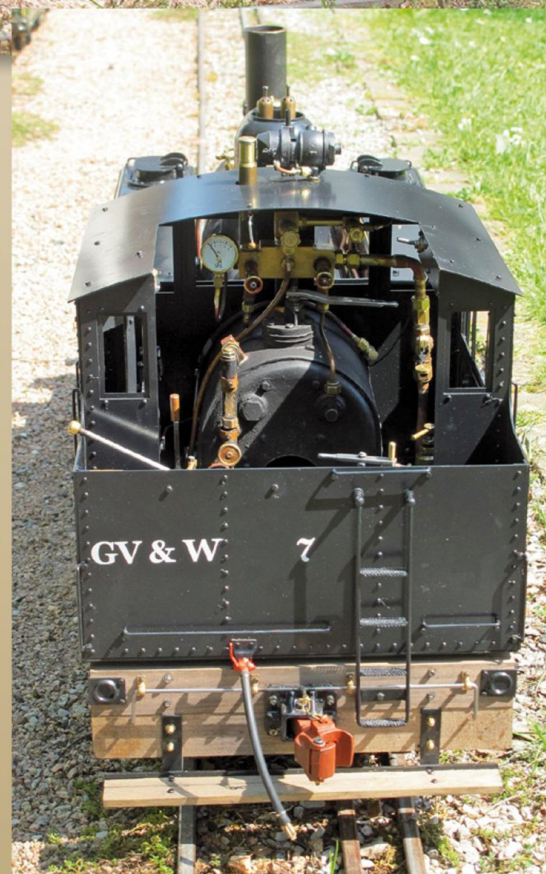
Die Rückansicht lässt neben den genannten Details auch gut den typischen durchlaufenden Rangiertritt und die Auslösevorrichtung für die Zentralkupplung erkennen.
