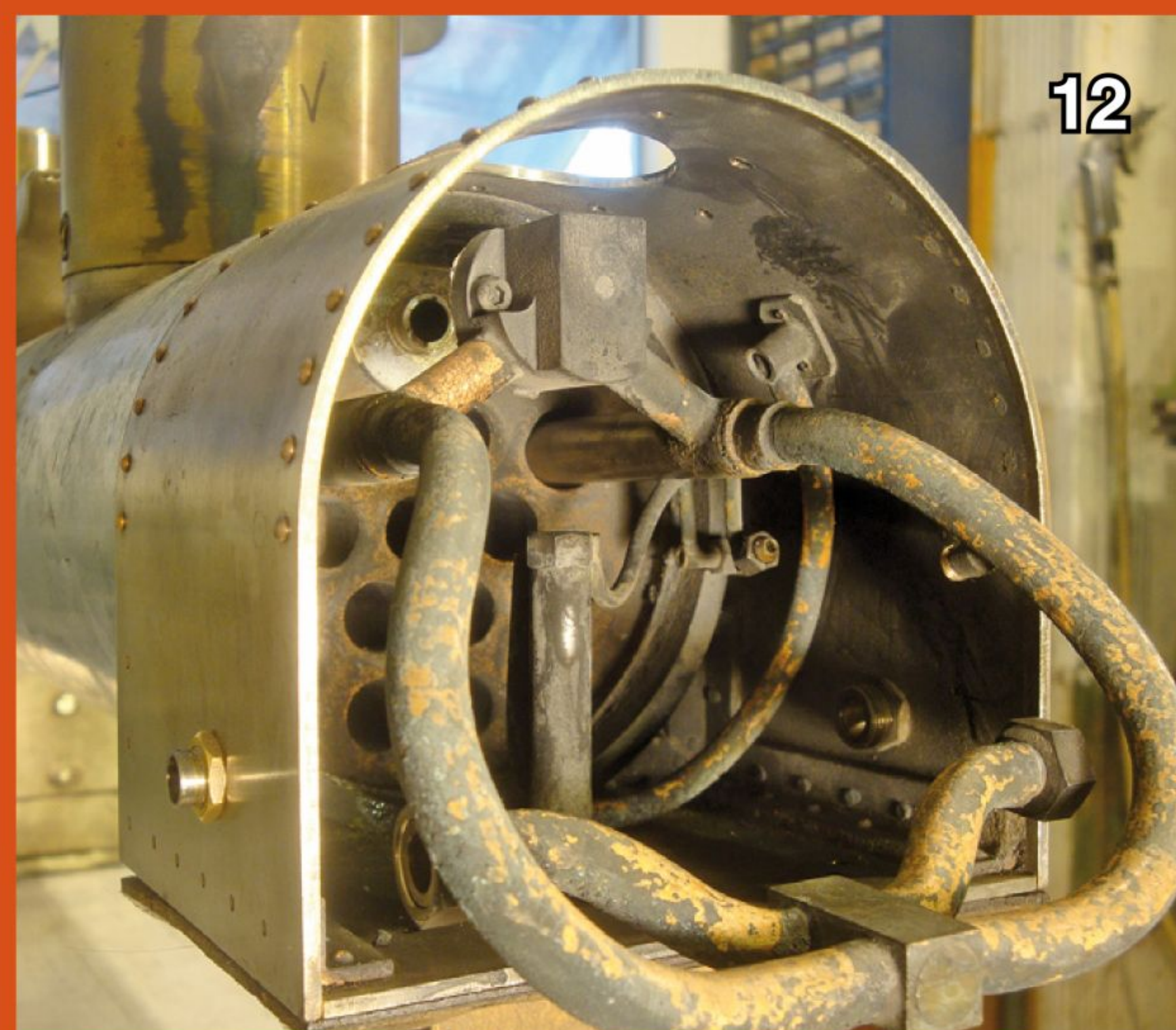
Überhitzer der Parisienne hier halb herausgezogen. Abgeschraubt werden müssen: Petticoat, Schnüffelventil-Saugstutzen, Nassdampf-Sammler (2 Schrauben), 2 seitliche Heißdampf-Anschlüsse, Ölanschluss. Die anderen Leitungen bleiben: Auspuff, Bläser, Zylinderöl, Ejektor-Auspuff.
