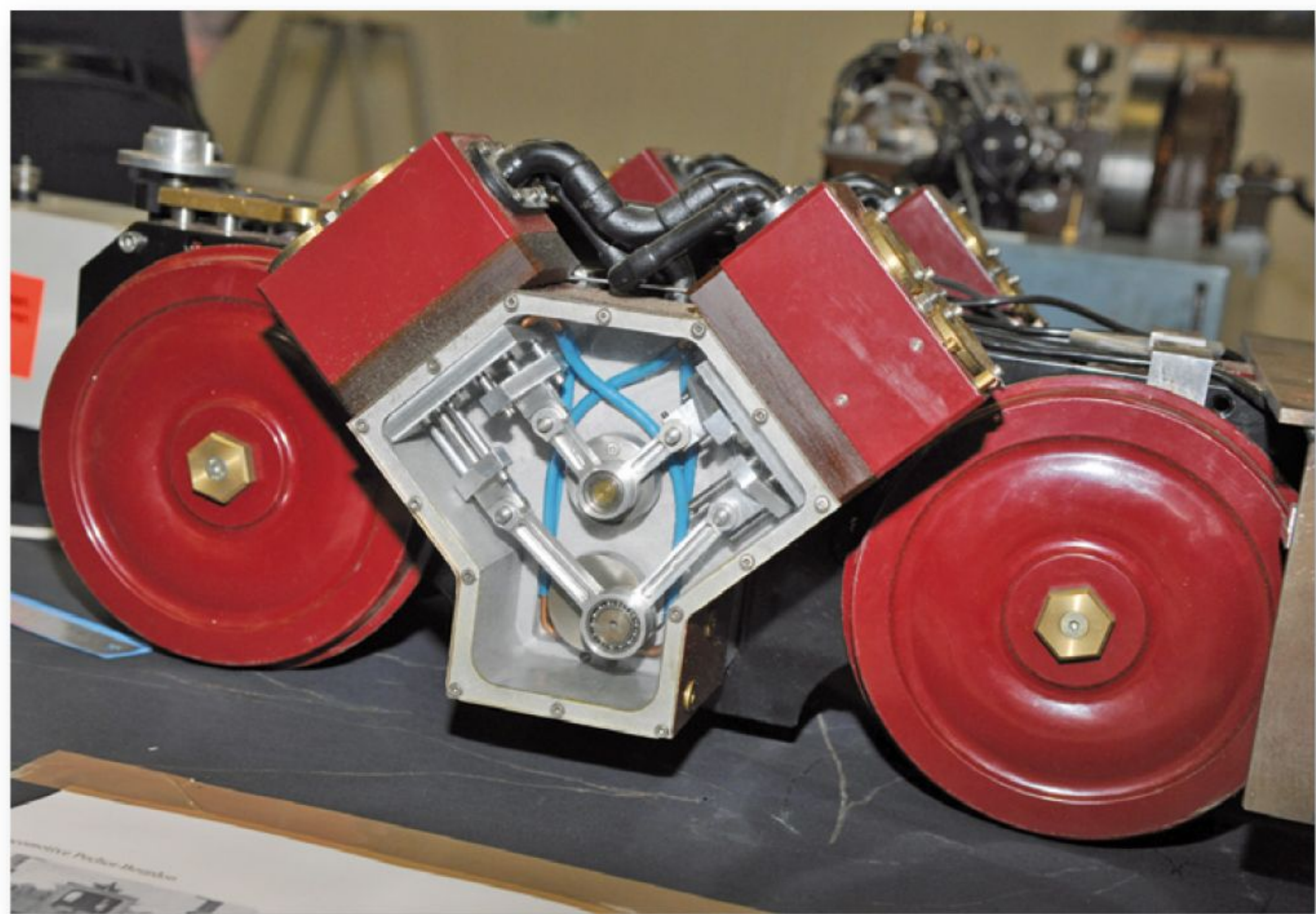
Fahrgestell mit integriertem V-Antrieb der P  chot-Bourdon-Lok.
