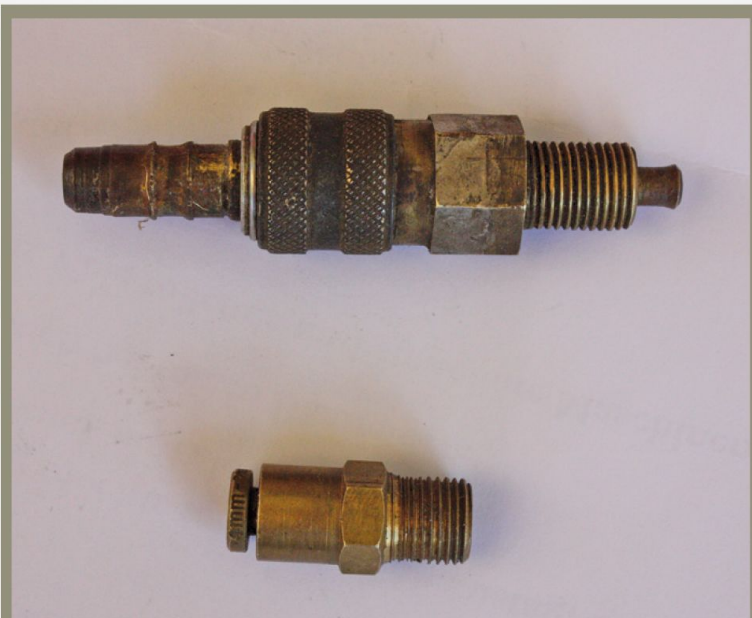
Die allseits bekannte Kupplung, die für Drücke absolut passend ist, nicht aber auf der Saugseite , wo kleinste Undichtigkeiten den Wasserzulauf zu einem Injektor stören können. Auch beim kleineren „Nachbarn“, der nach einer völlig anderen Idee konstruiert ist, gab es „Probleme“, die uns veranlassten, den Schlauch zum Injektor nur noch auf ein Stückchen Kupferrohr aufzuschieben .
