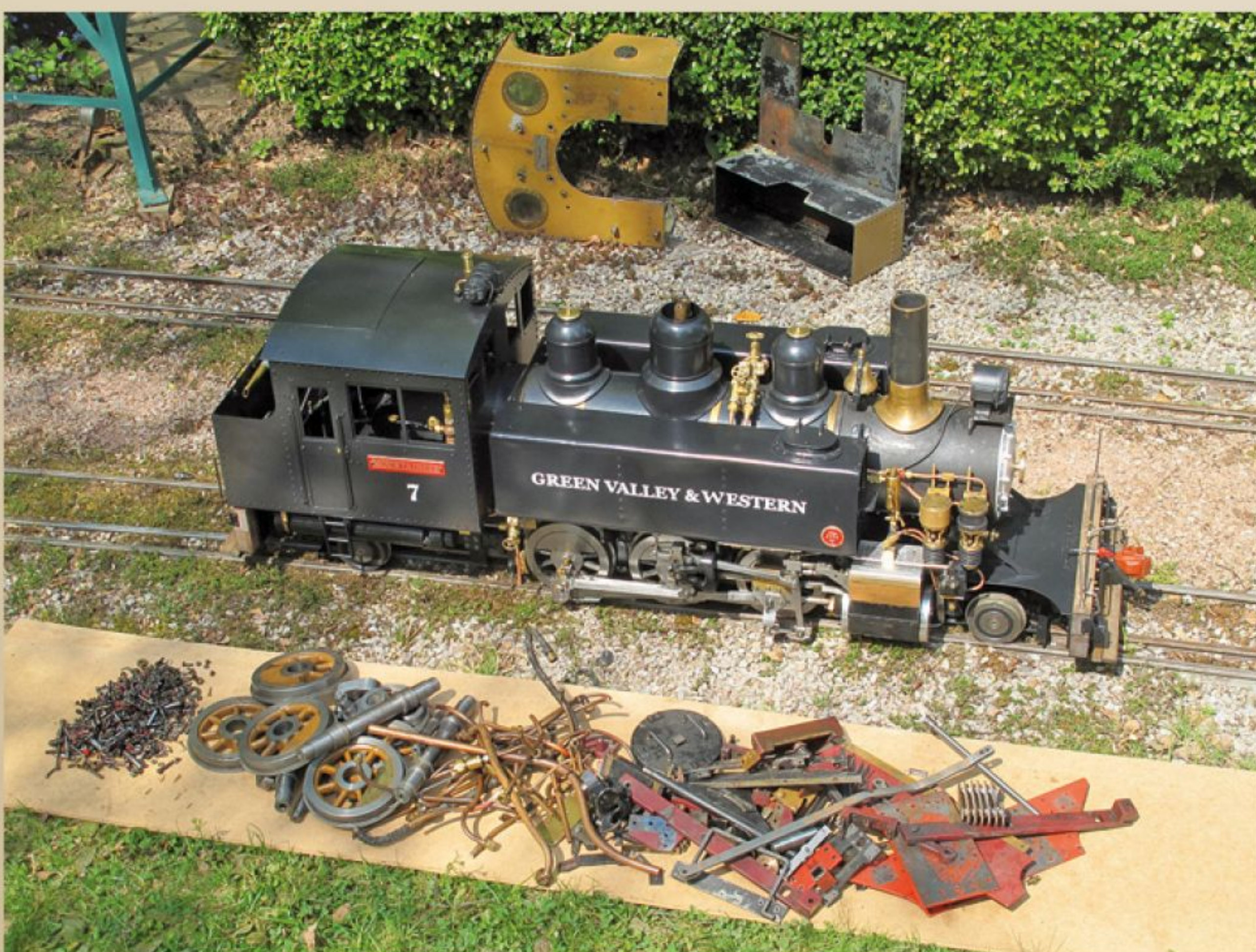
Green Valley & Western Nr. 7 zwischen den übrig gebliebenen Schrottbergen der 3½" Ausgangslok. Bemerkenswert auch der kleine Berg ausgetauschter zölliger Schrauben, es gibt aber immer noch eine ganze Menge Zollschrauben bei der Lok.
