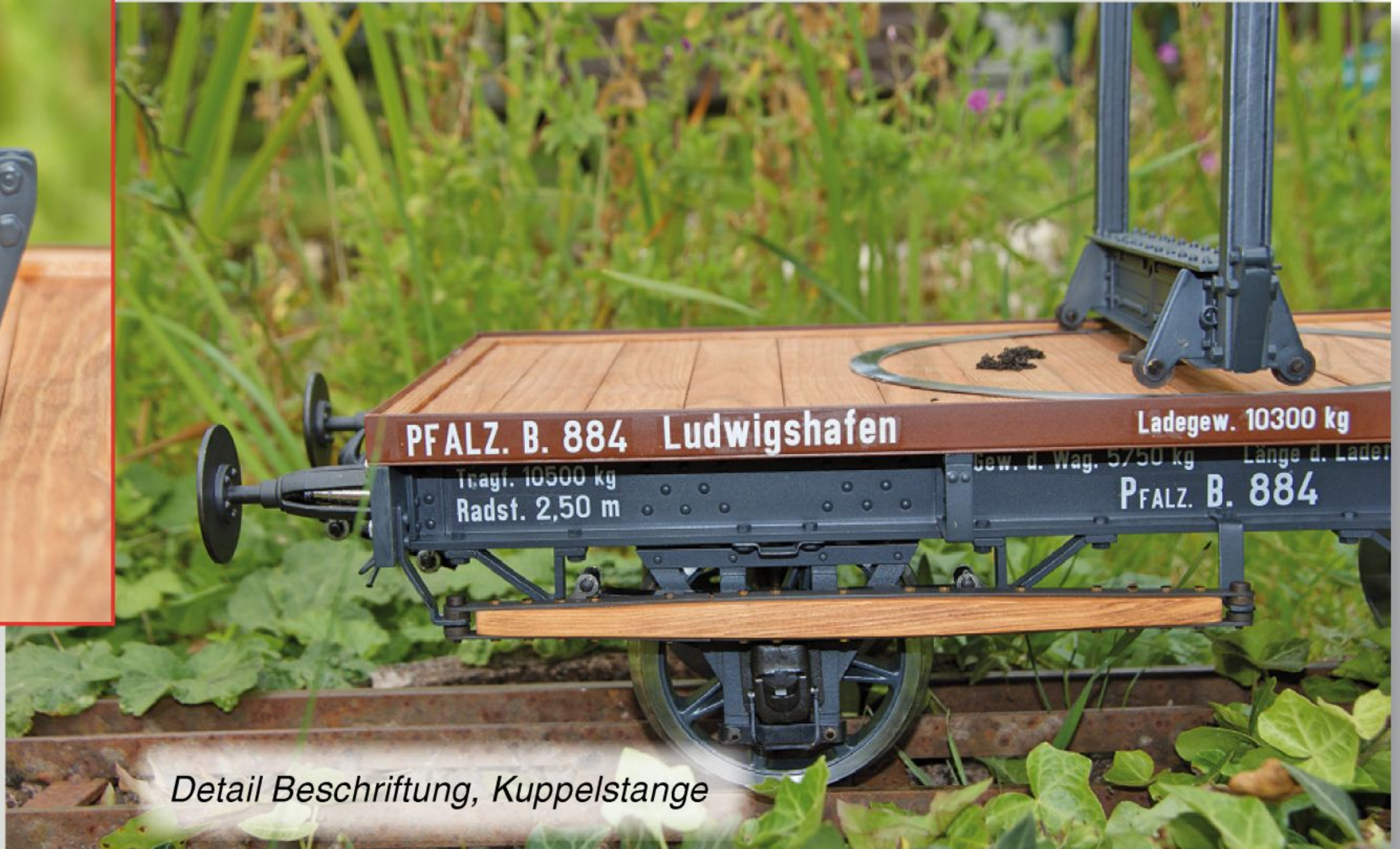
Drehschemel gibt's nur als Paar, wie sonst. Hier gut zu sehen die unterschiedlich langen Kuppelstangen
