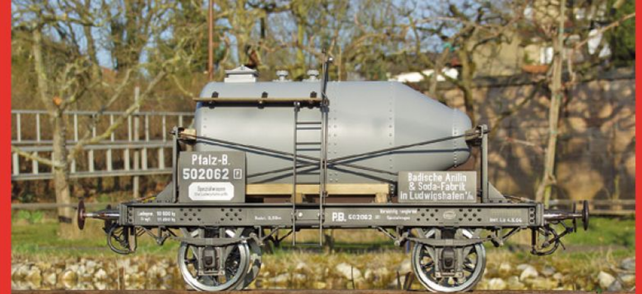
Seitenansicht, gut zu erkennen die Verspannung der Haltehölzer
