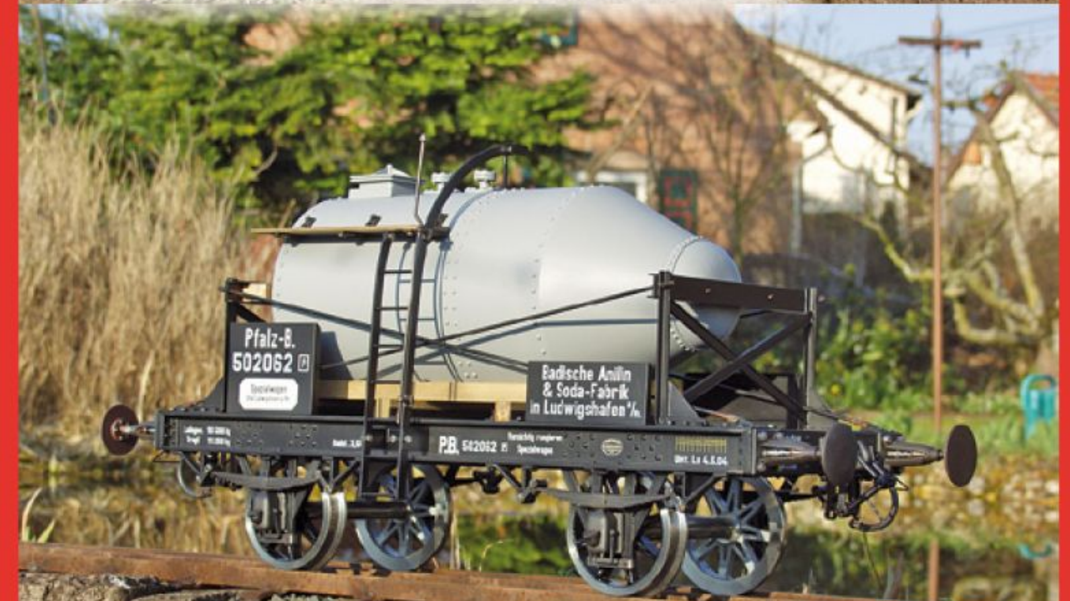
Seitenansicht, gut zu erkennen die Verspannung der Haltehölzer
