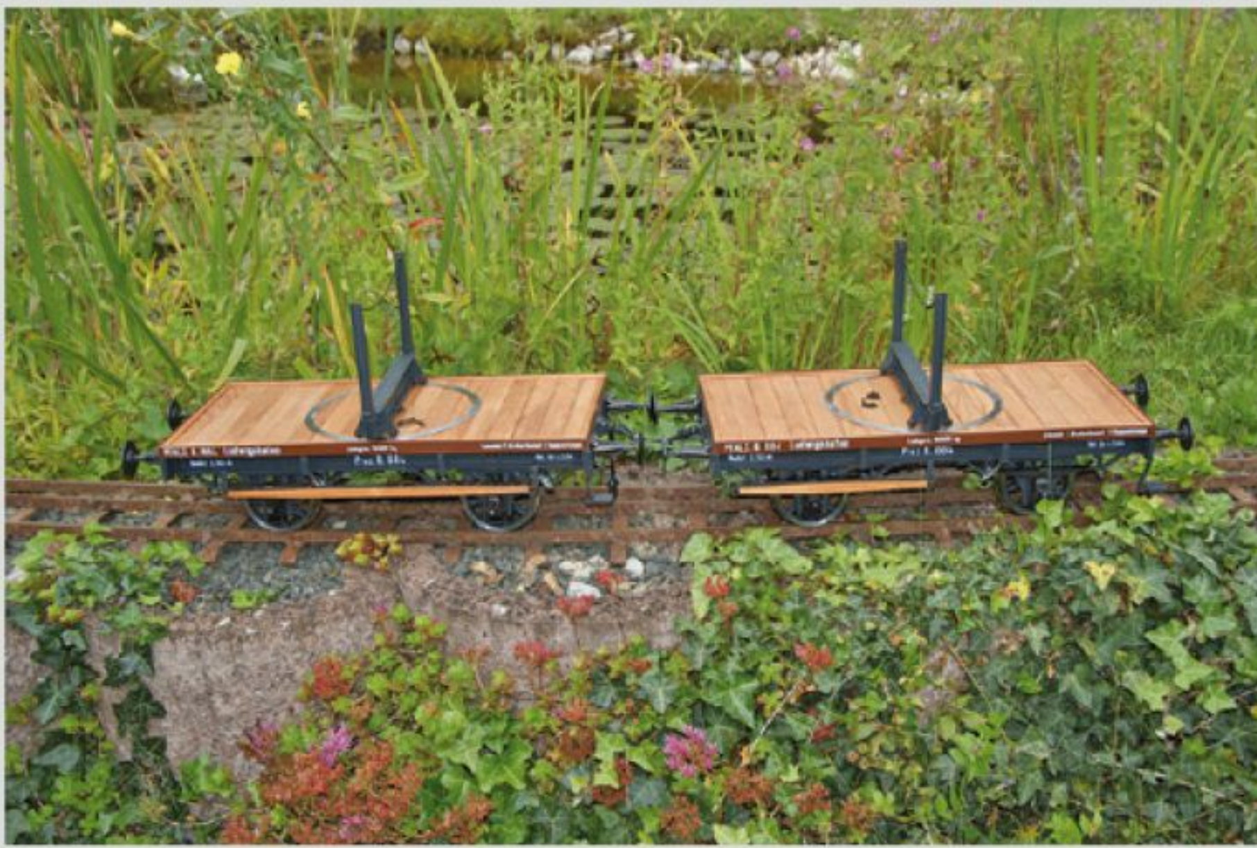
Drehschemel gibt's nur als Paar, wie sonst. Hier gut zu sehen die unterschiedlich langen Kuppelstangen
