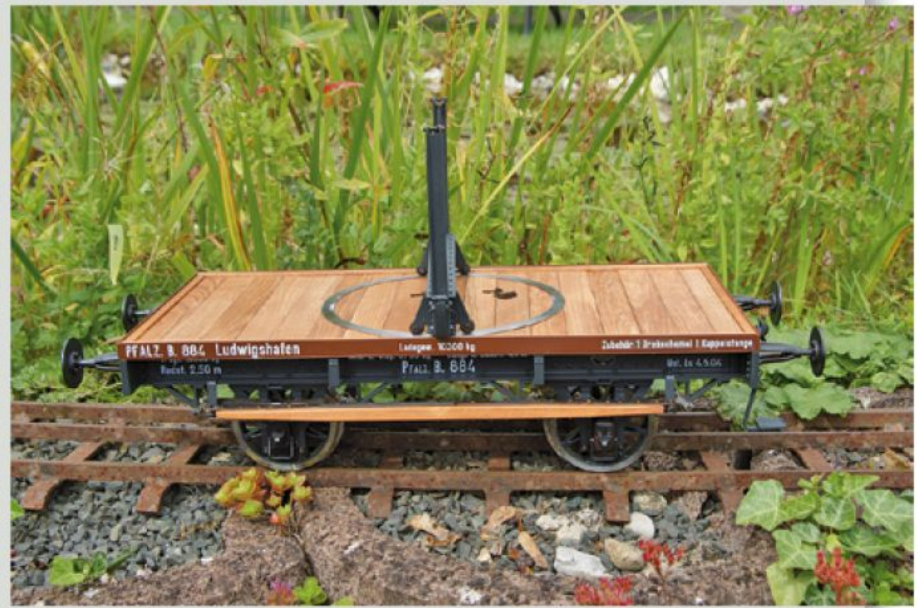
Seitenansicht-Laufbahn für die Schemel aus 1 mm Schwarzblech ausgesägt und aufgeklebt
