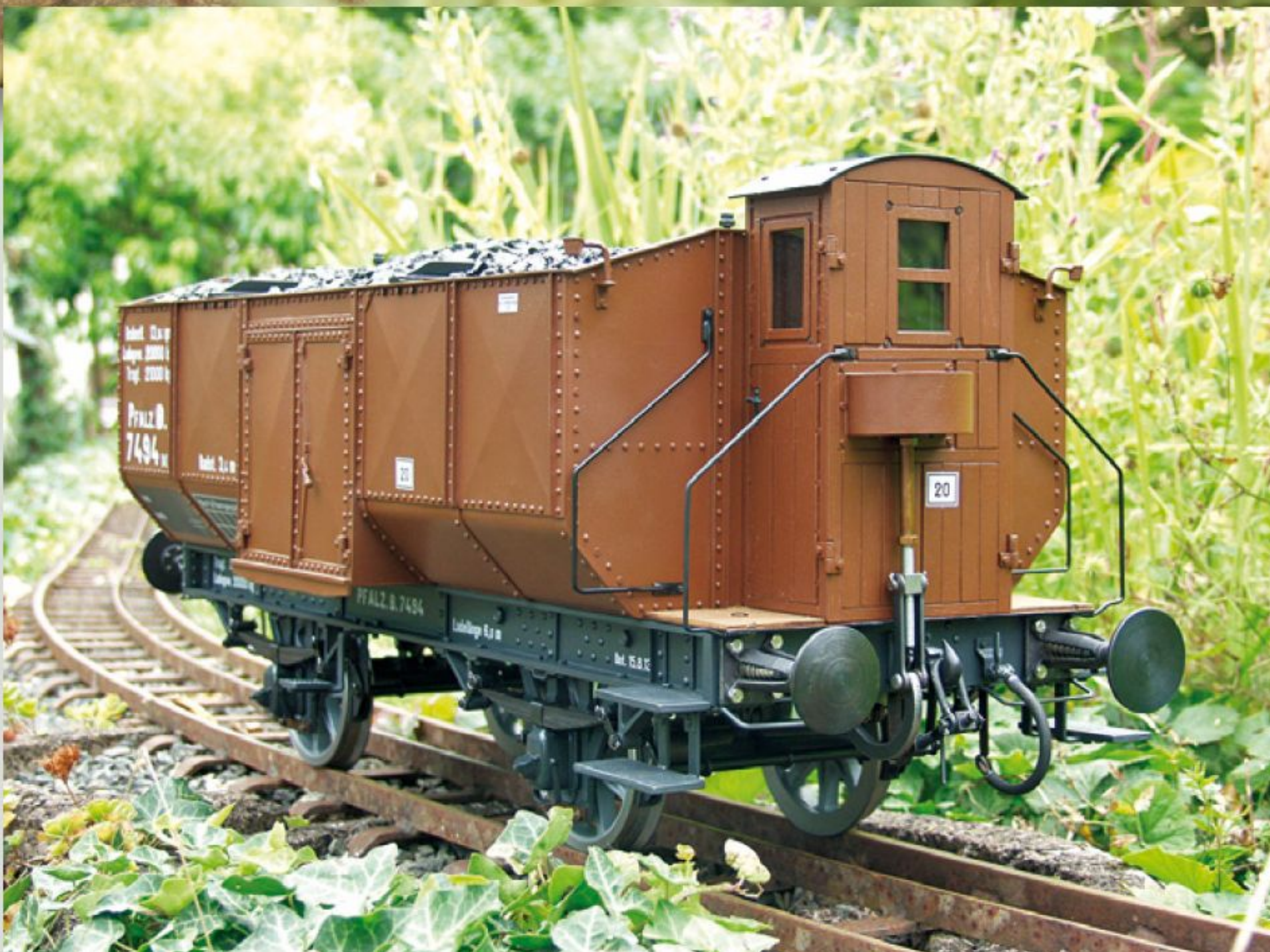
Ansicht Bremserhaus, Details wie Handbremsanlenkung, Holzbeplankung des Bremserhauses
