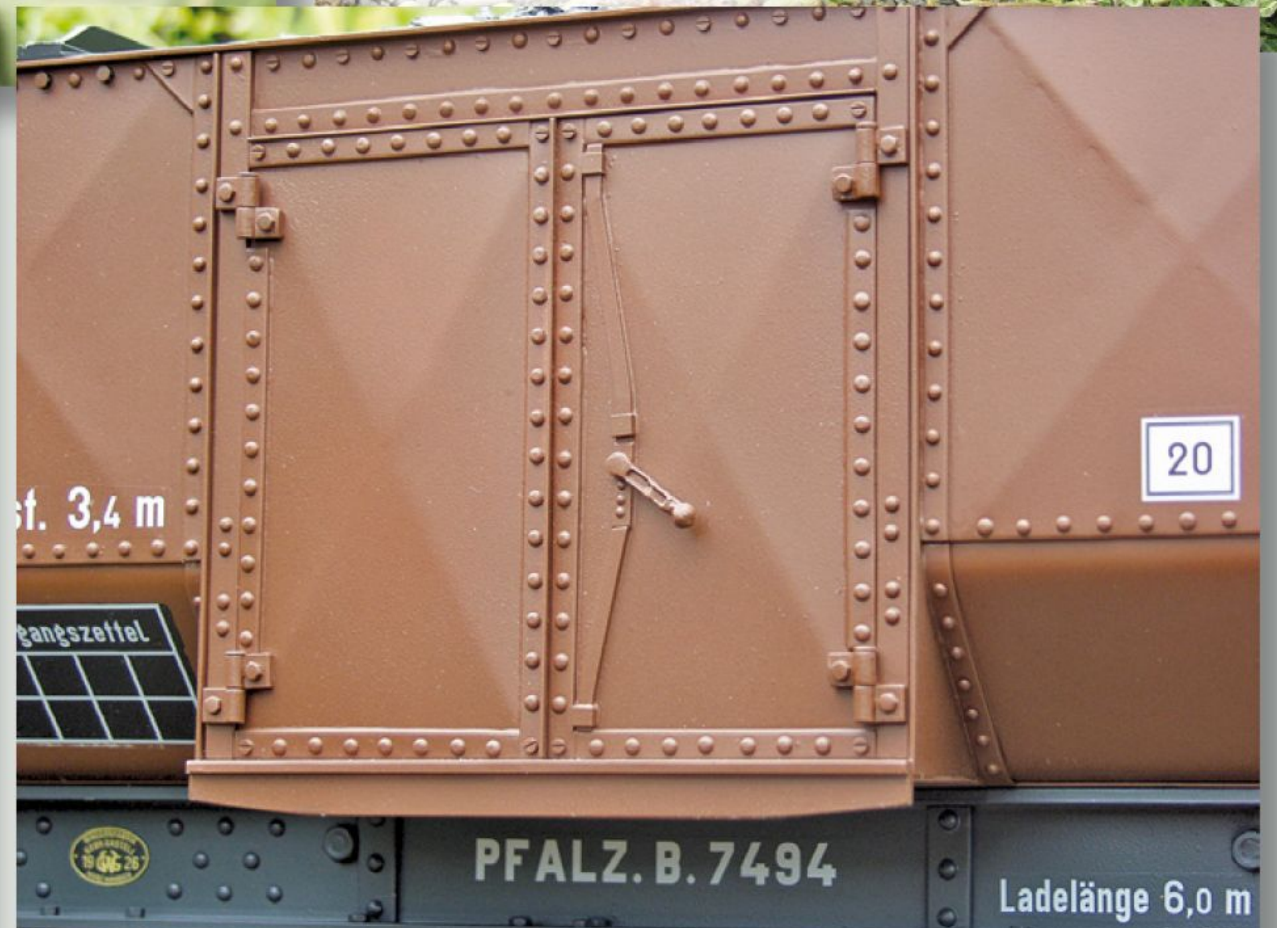
Detail Türen mit Verriegelung, lackiert, beschriftet, Fabrikschild
