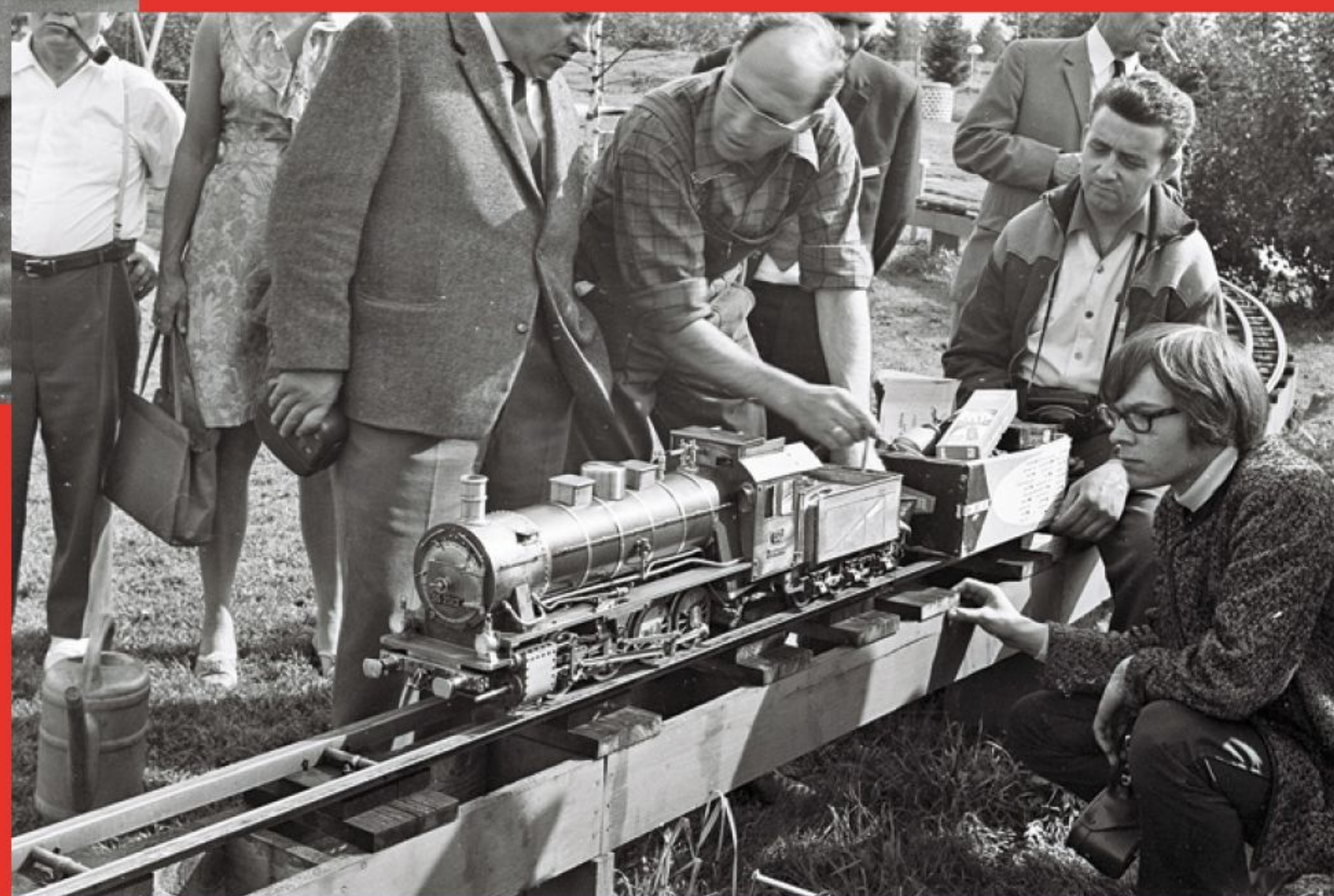
Manfred Knapfer (Bildmitte) bringt mittels Handpumpe den Wasserstand im Kessel seiner 552502 auf die nötige Höhe, während Horst Haußer (Mannheim, rechts) etwas skeptisch zuschaut und Hans-Reinhold Rosner (München, darunter) das Triebwerk der kleinen Lok inspiziert. Der etwas füllige Herr im Jackett links ist nicht identifiziert.
