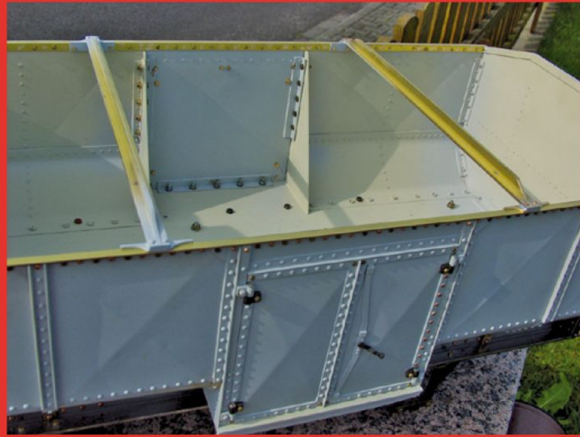
Alle Teile werden innen mit Winkeln verschraubt
