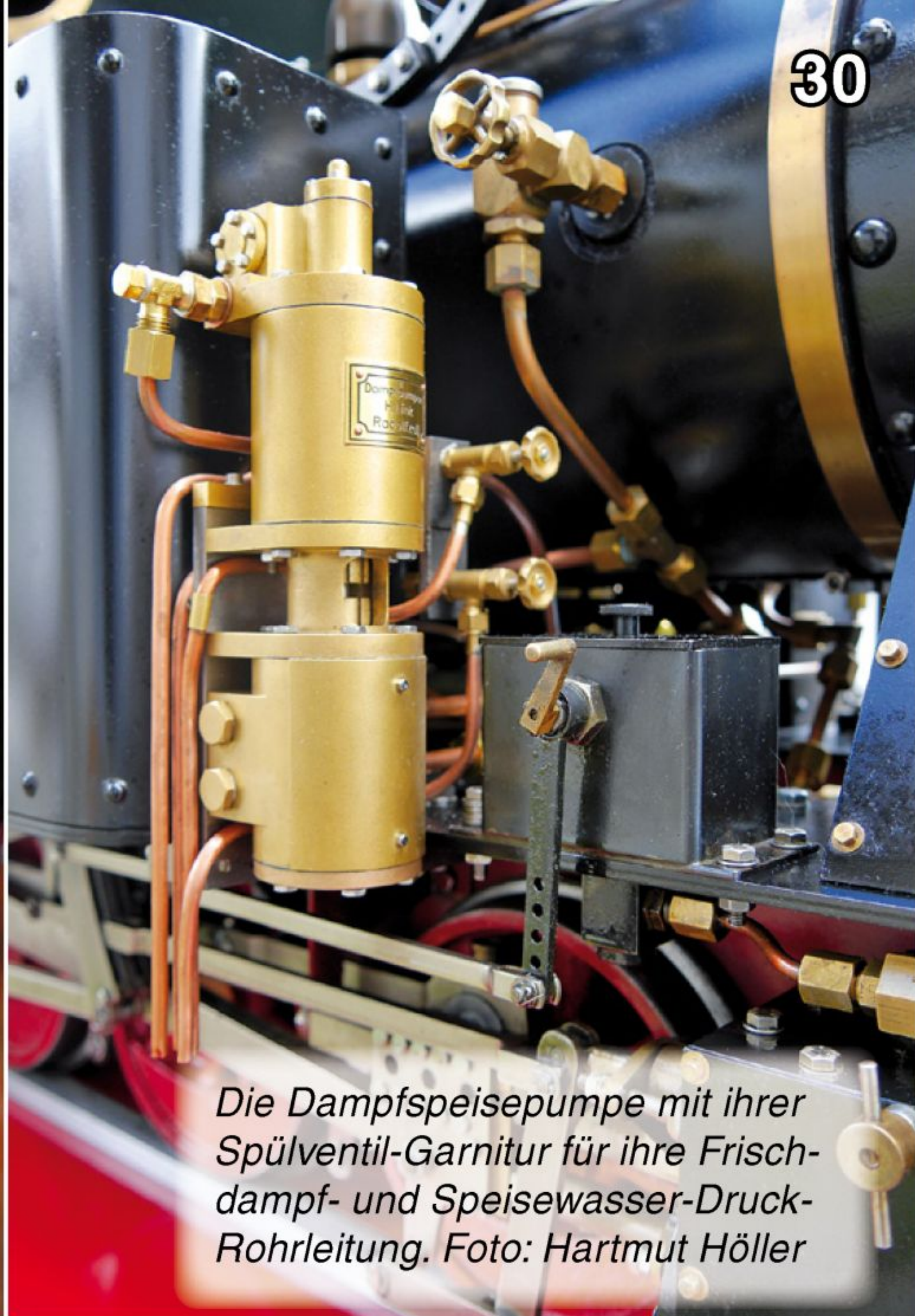
Das Dampfventil für die Dampfspeisepumpe (Draufsicht auf das 30 mm Handrad). Foto: Hartmut Höller
