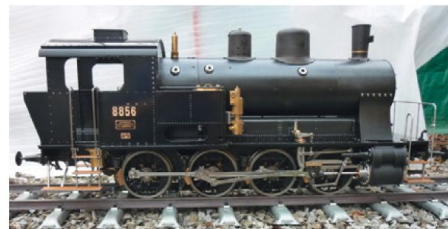
Modell Nr. 8856, 5 Zoll, mit Doppelachspumpe, Dampfpumpe, Luftbremsen, Blattfederung mit Ausgleich.
