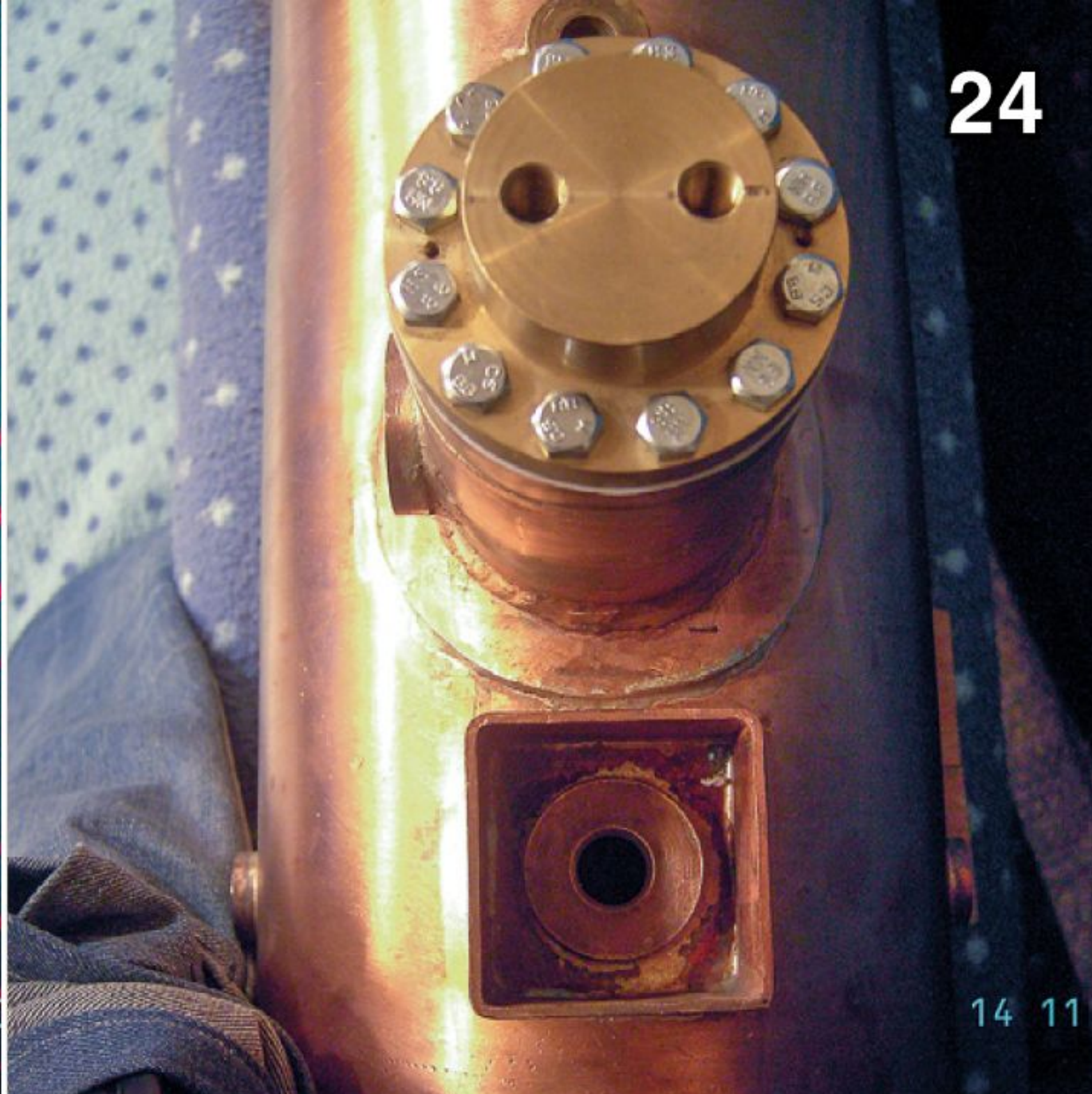
Der Dampfdom mit umfangreich verschraubtem Dampfdomdeckel und den zwei Gewindeanschlüssen für die beiden Dampf-Sicherheitsventile. Foto: Hartmut Höller
