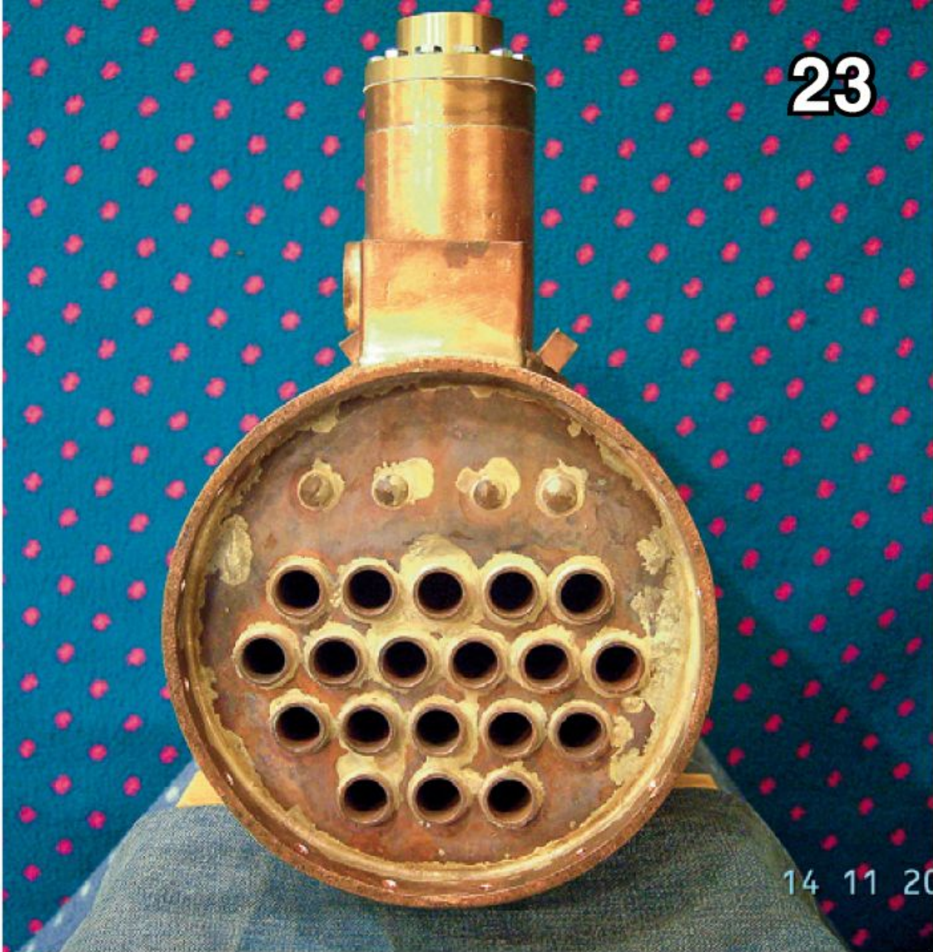
Die 19 Rauchrohre mit jeweils 16 mm lichter Weite. Foto: Hartmut Höller
