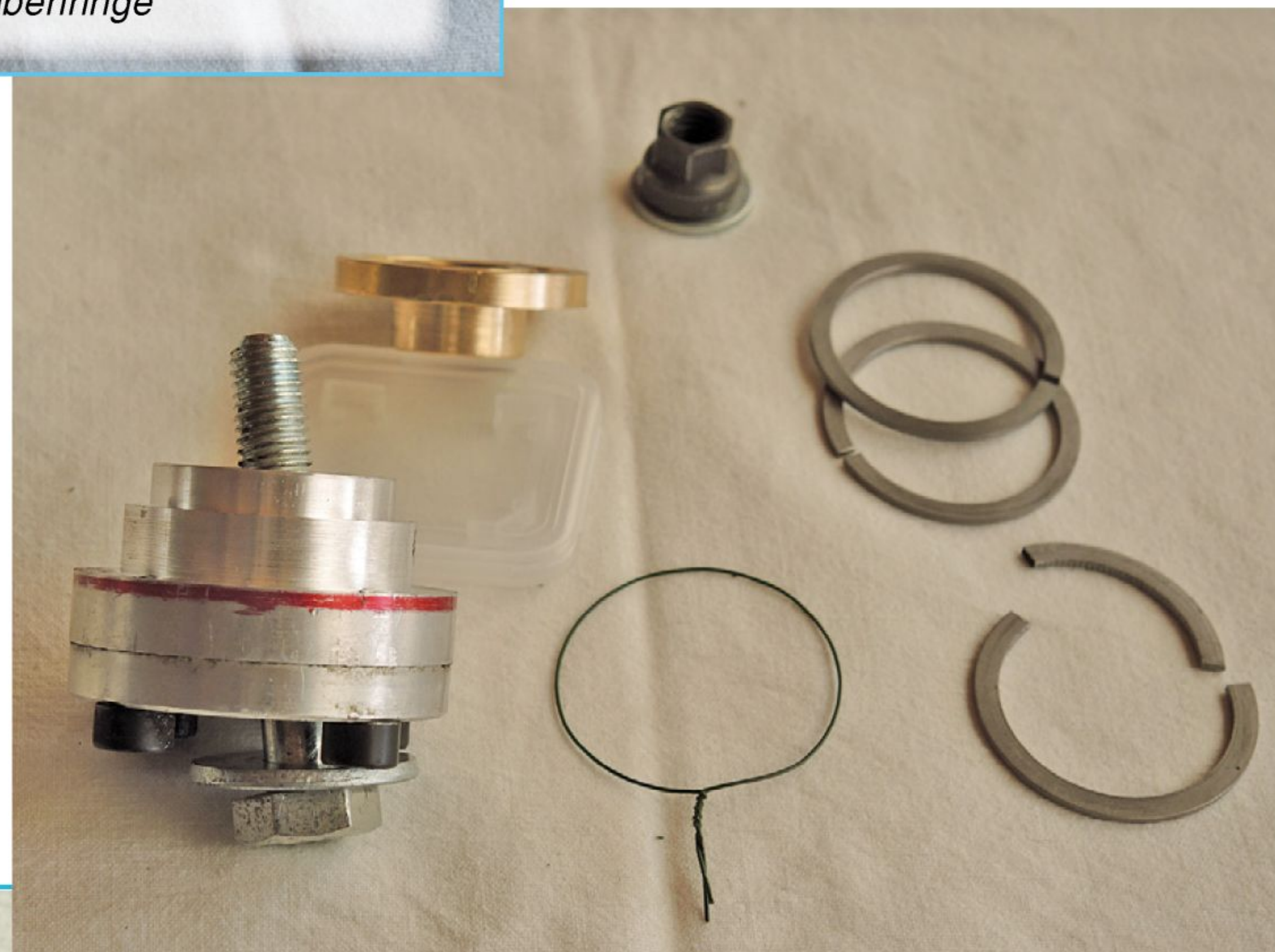
Drahtschlinge, Kolbenringe und das Futter zum Überdrehen
