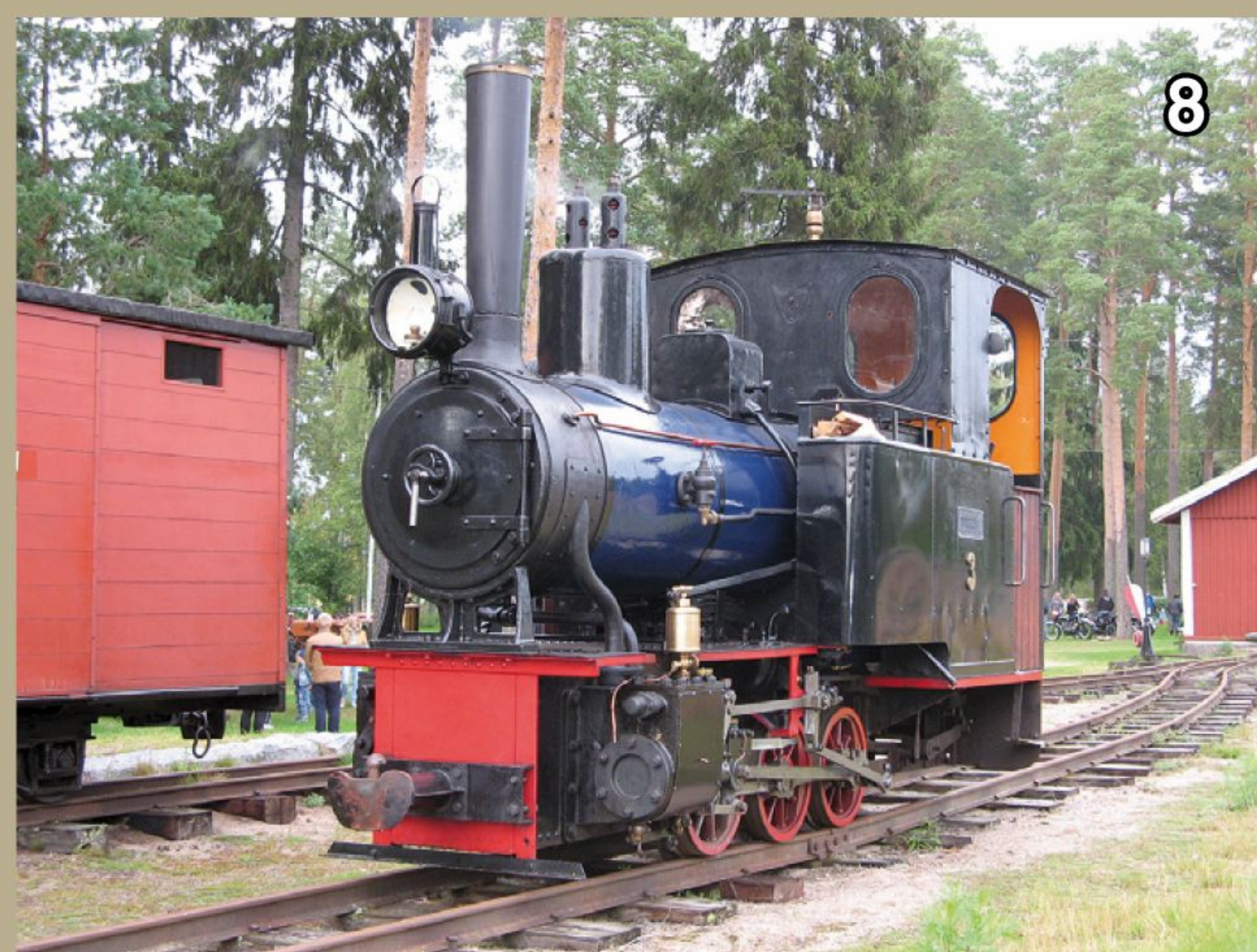
Bild 6 zeigt eine Cn2t-Dampflok, die als O&K 7325/1920 von Ohrenstein und Koppel in Berlin gebaut wurde. Die Maschine verfügt über 30 PS und ist als Lok 3 im Finnischen Eisenbahnmuseum NYKARLEBY JERNVÄG, so heutzutage, in Betrieb zu sehen. Foto: Keith Burgees
