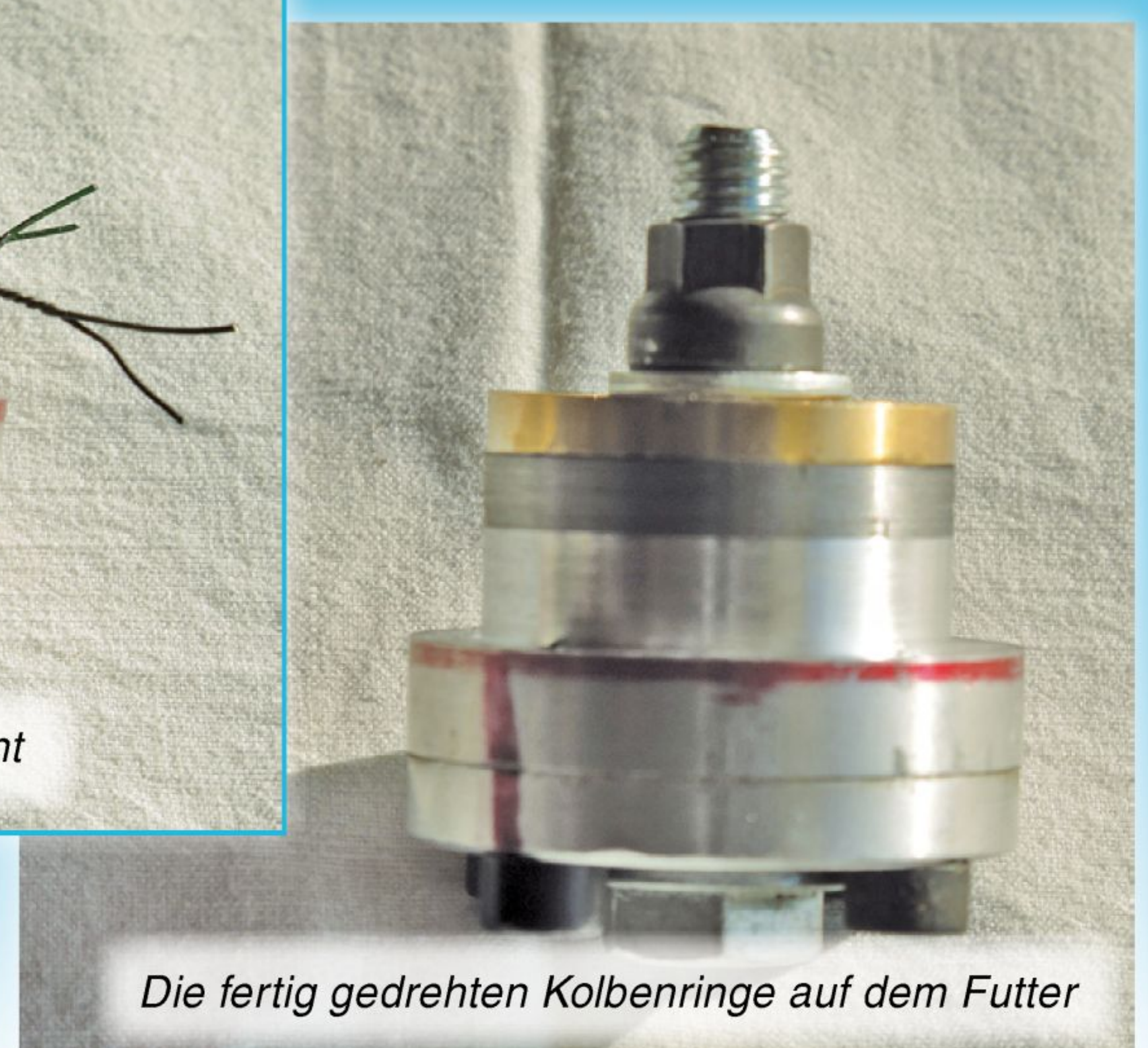
Drahtschlinge, Kolbenringe und das Futter zum Überdrehen
