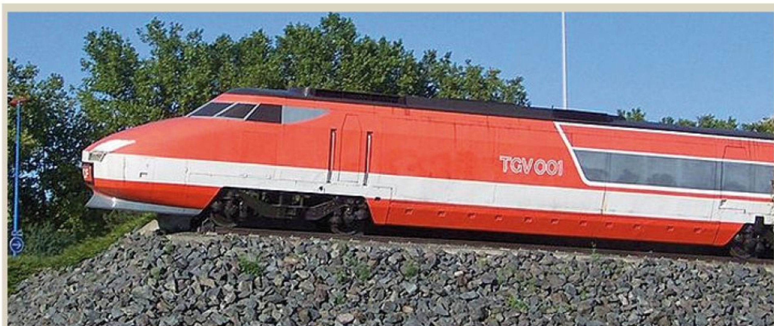
Gasturbinen-Versuchs-TGV von 1972 an der A36 bei Belfort. Kasten Orange RAL2003, Streifen RAL9002
