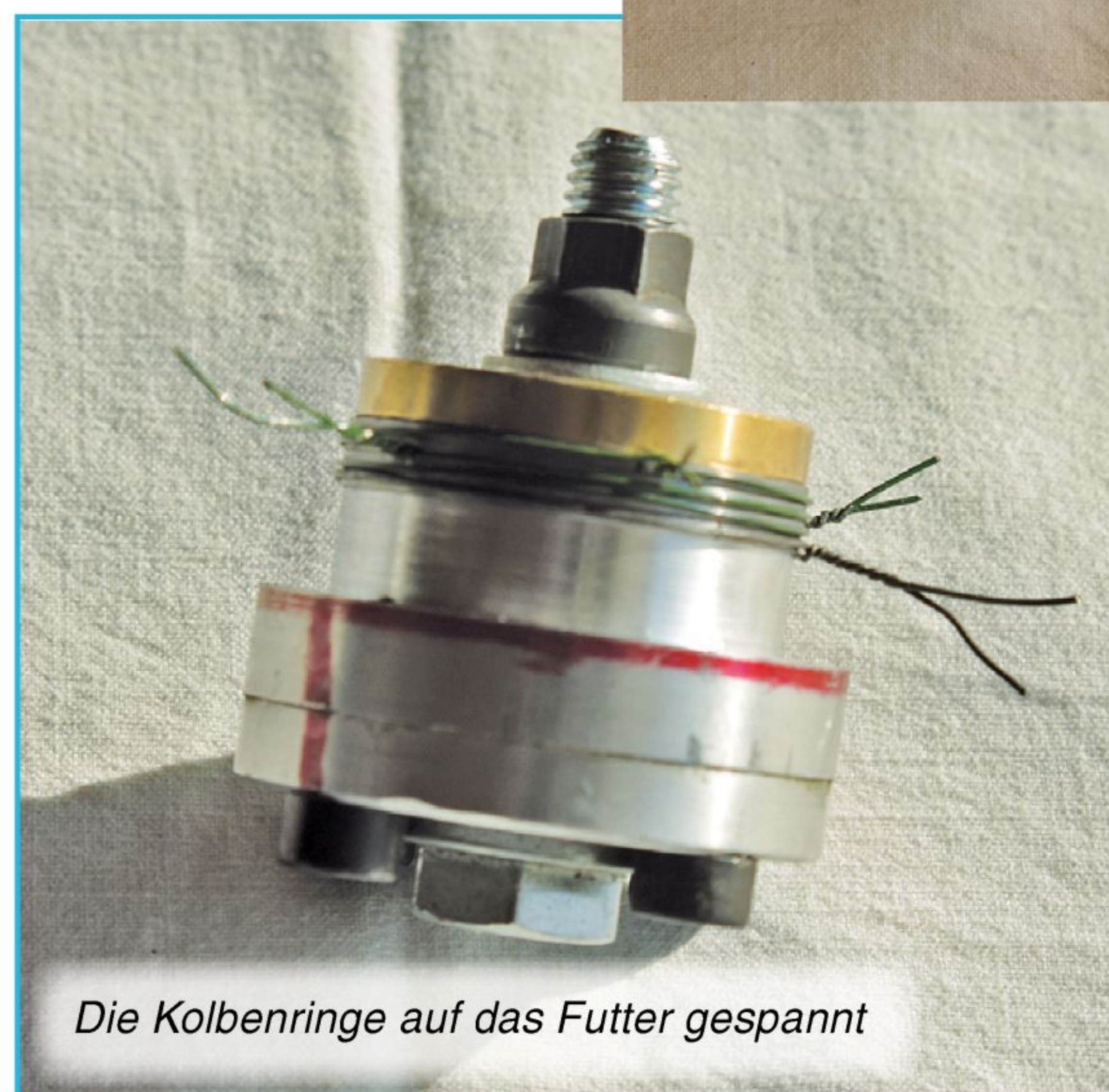
Drahtschlinge, Kolbenringe und das Futter zum Überdrehen
