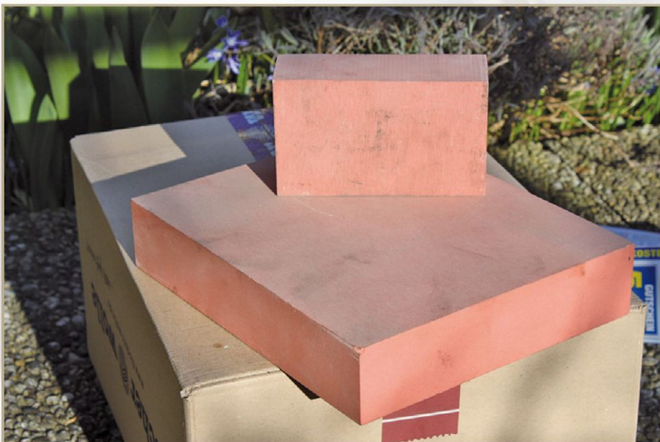
Ein Block „Kunstholz“, der auf einer großen Schreiner-Kreissäge schon zurecht geschnitten wurde. Die fast „a...-glatte“ Oberfläche und soviel wie keine erkennbare Struktur lassen die Frage aufkommen, was das Material mit „Holz“ gemeinsam hat?
