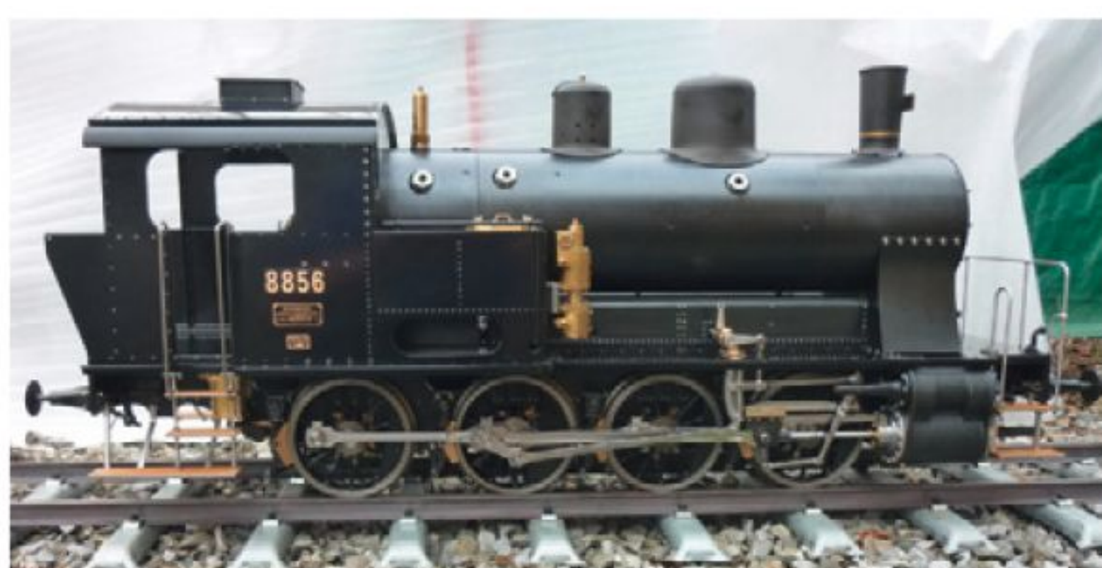
Modell Nr. 8856, 5 Zoll, mit Doppelachspumpe, Dampfmaschine, Luftbremsen, Blattfederung mit Ausgleich.
