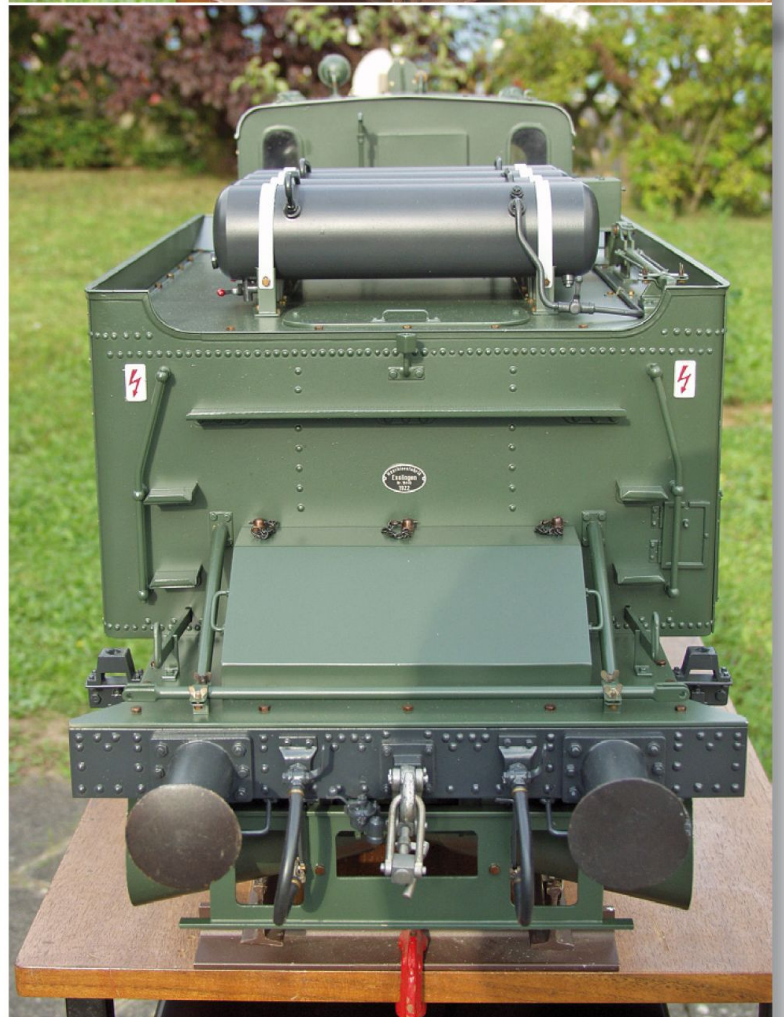
Details von hinten – Innenräumer mit Betätigungsstangen zum Ablassen, Abschleppstange, Werkzeugkasten, Lampenhalter, Luftbehälter inkl. Leitungen und Absperrhähnen.
