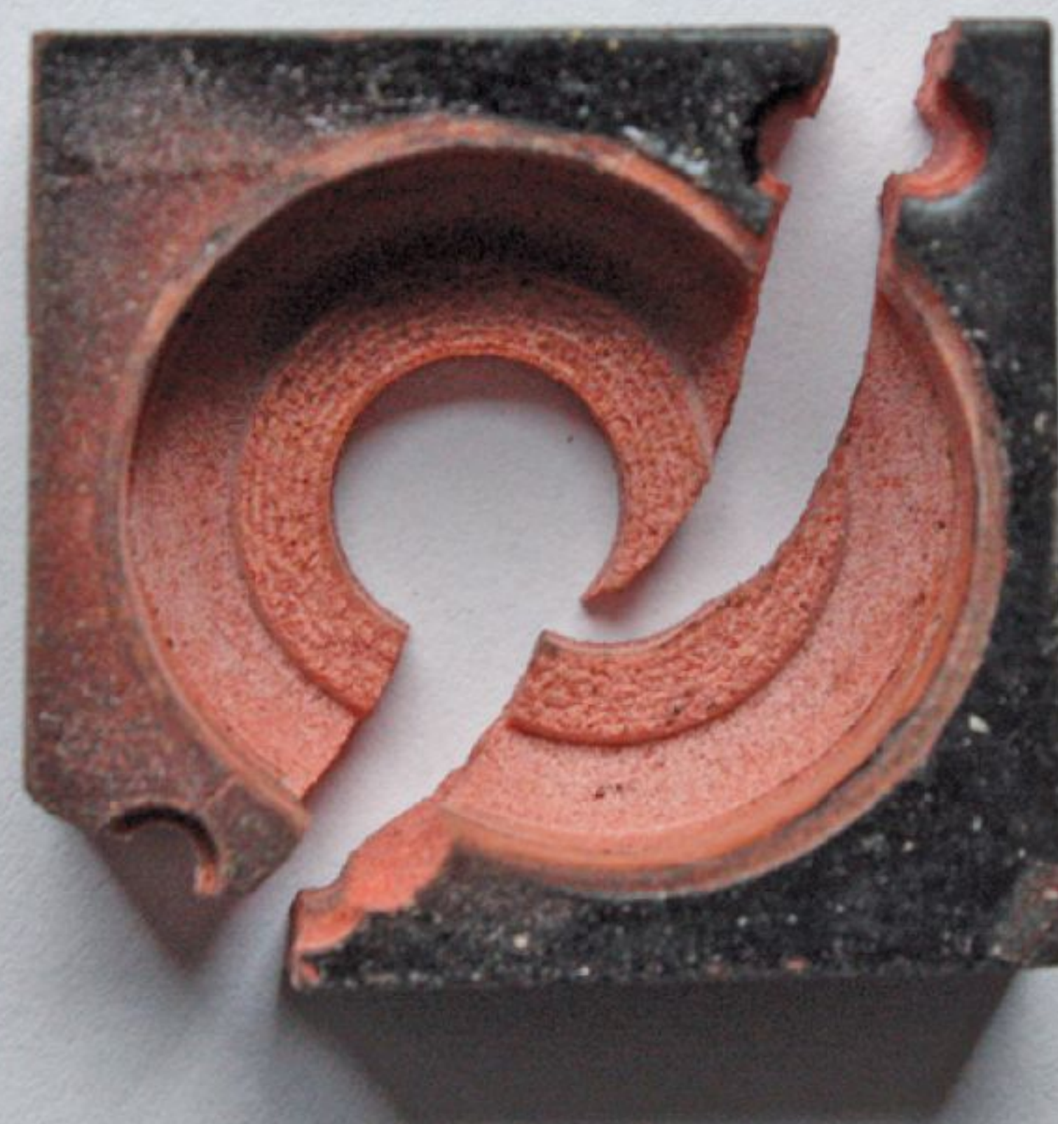
Zur Aufnahme des Kugellagers wurden Klötzchen gefräst, aus denen in entsprechender Tiefe die Bohrung mit dem Kugellageraußendurchmesser gedreht wurde. Die zwei Schraubenlöcher wirkten sich bei dem Entgleisungsschlag offenbar wie eine „Soll-Bruchstelle“ aus.
