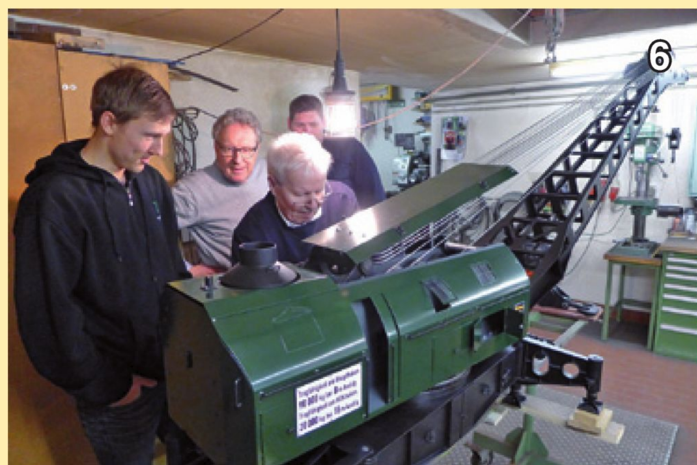
Die Werkstatt, die liefert: Ein Großteil der Fahrzeuge entsteht in den maschinell bestens ausgerüsteten Kellerräumen im Wohnhaus von Wolfgang Rohne. Hier das neueste Projekt, gesehen im Januar 2017: der 90t-Dampfkran „Nürnberg“, in aller Komplexität voll funktionstüchtig, nach Vorbild der Deutschen Bundesbahn im Maßstab 1:8! Die Begleitfahrzeuge zum Transport der Gegengewichte und zur Lagerung des Auslegers sind noch in Arbeit.
