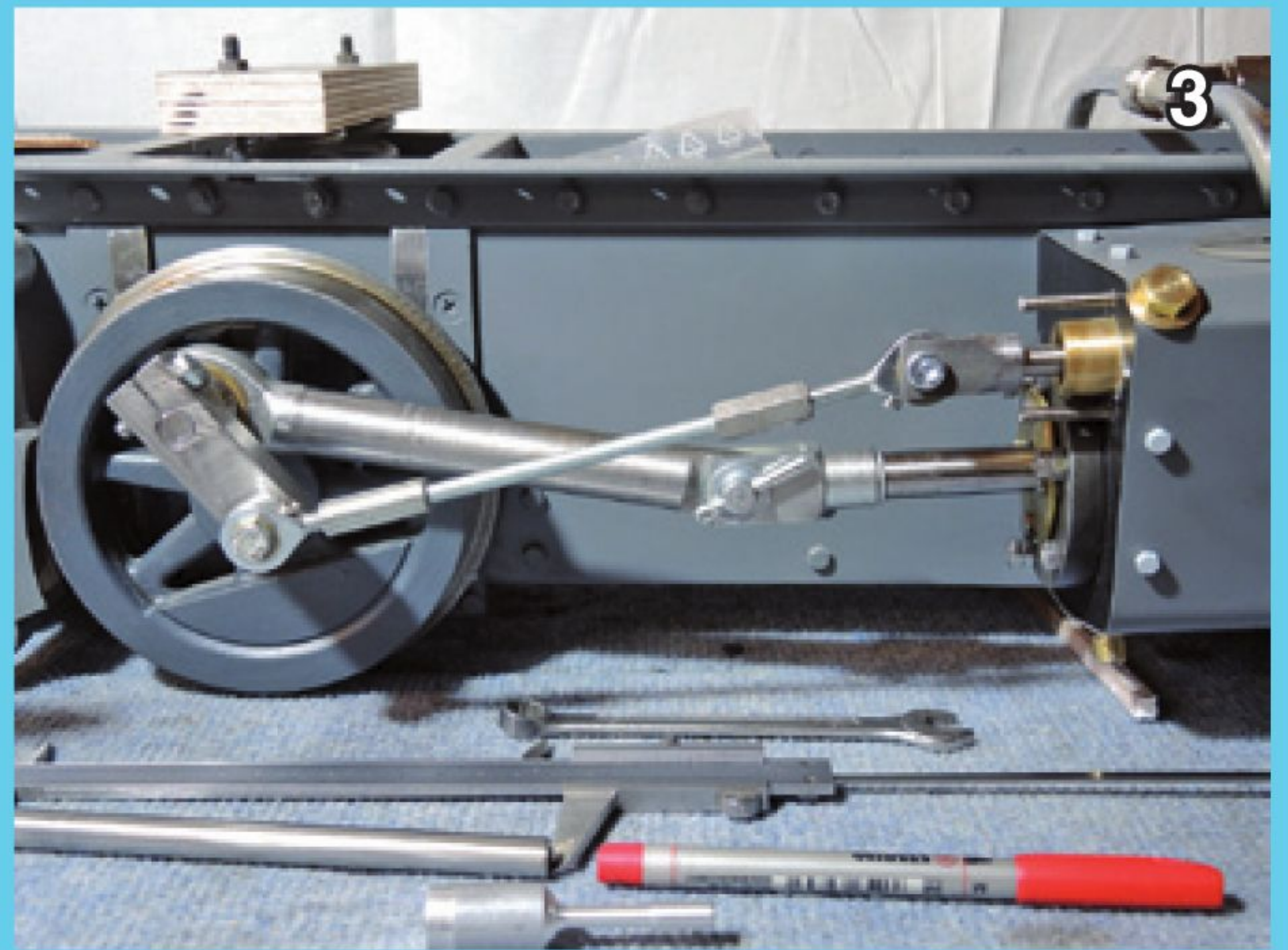
Ausmessen der Schieberantriebsstange
