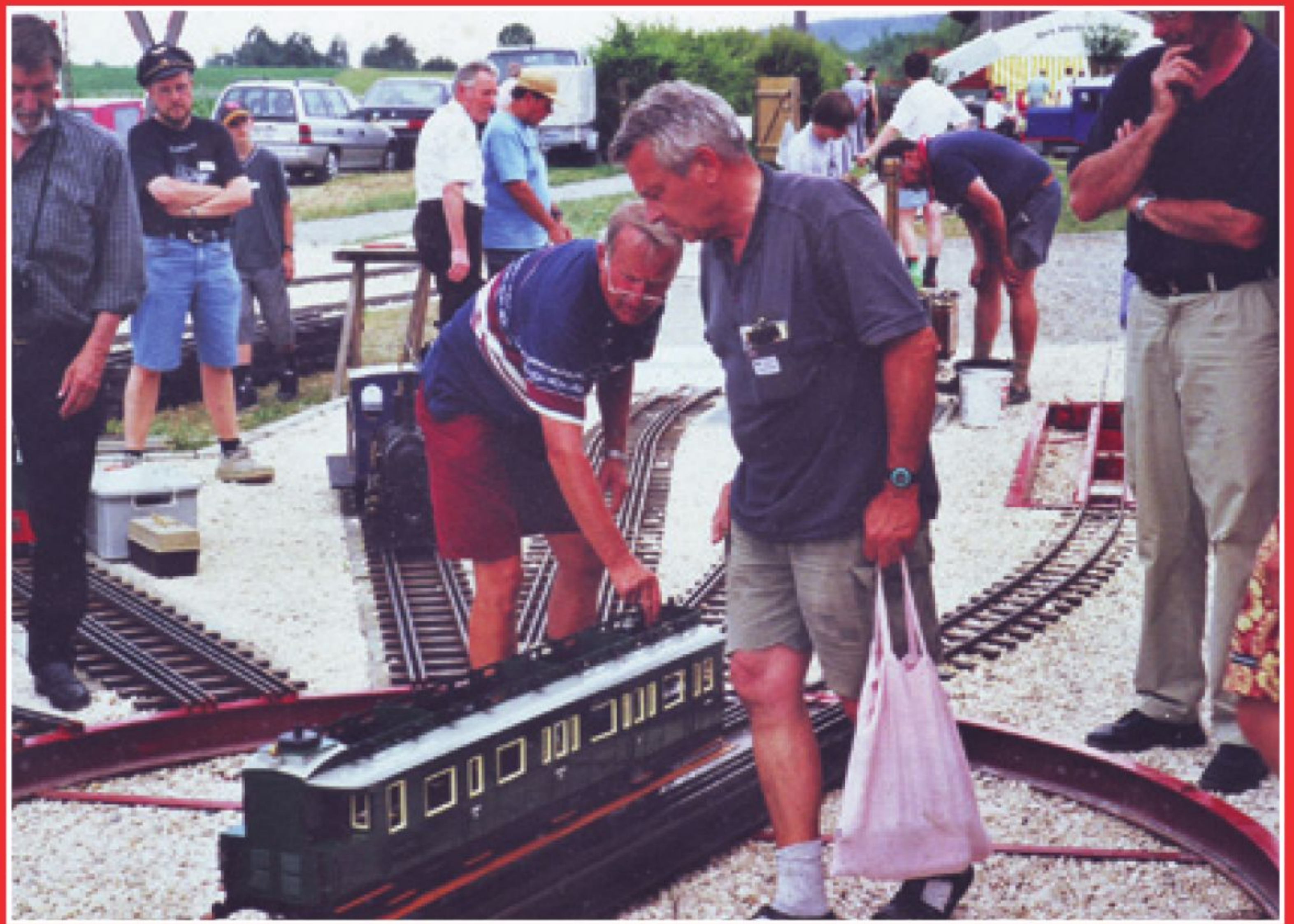
Der „Lindauer“ 5-Zoll-Versuchstriebwagen. Der Versuch mit der „Gas-Feuerung“ zeigte, so die Bemerkung von Fischer, dass diese ohne stets laufenden Hilfsbläser nicht sicher funktionierte. Das Gasflämmchen im Pilzbrenner sei so empfindlich, dass ein kräftiger Windstoß in den Abgaskamin die Flamme ausblasen könne. Die Aufnahme entstand auf der Drehscheibe der SEV-Anlage Kürnbach. Fotograf und Datum sind nicht bekannt.
