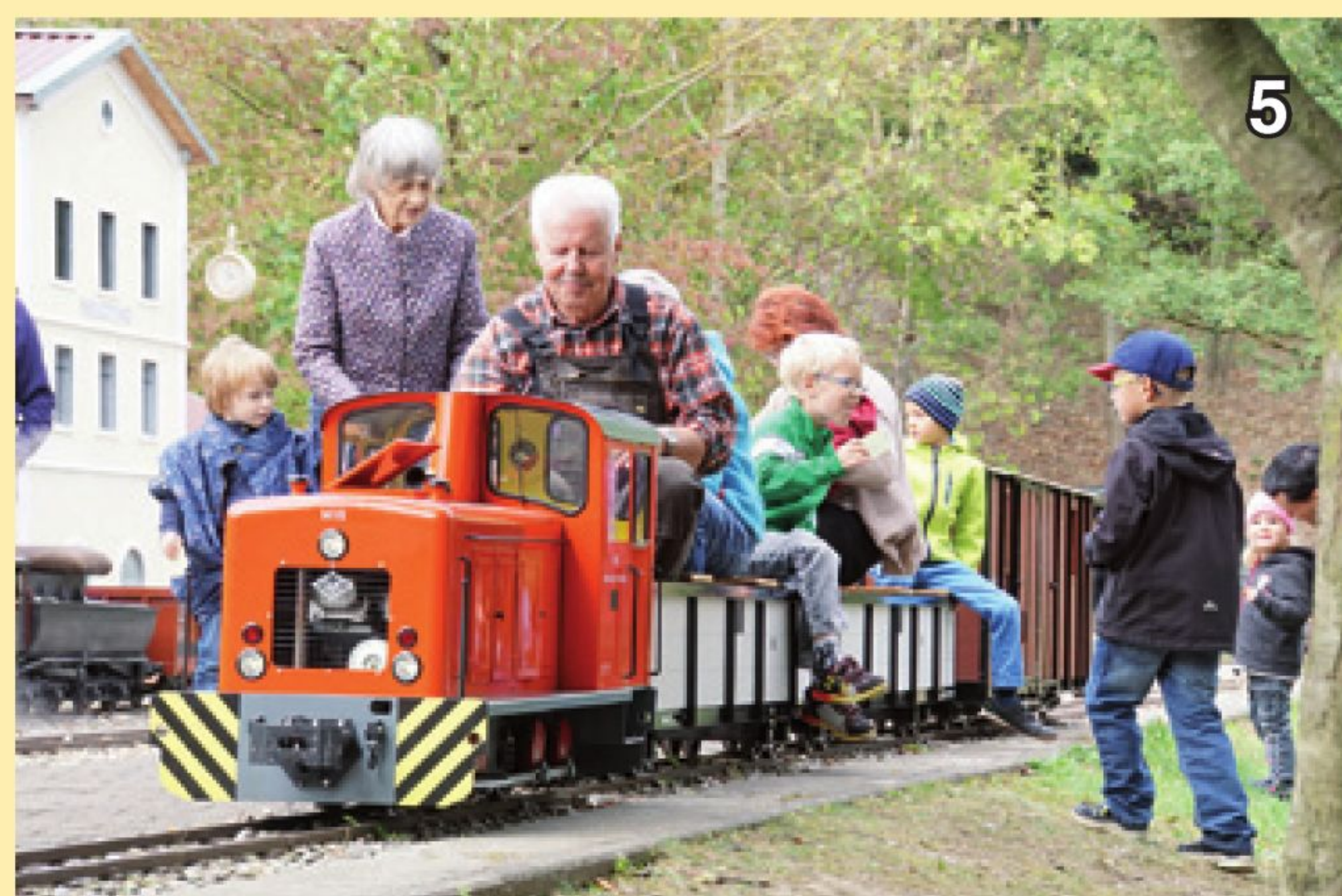
Seit 2013 ist auch eine echte V-Lok im Einsatz: mit Honda-Motor 6 PS und Eaton-Getriebe als Kraftübertragung, von Wolfgang Rohne gebaut nach schmalspurigem Vorbild D 11 der Zillertal-Bahn.
