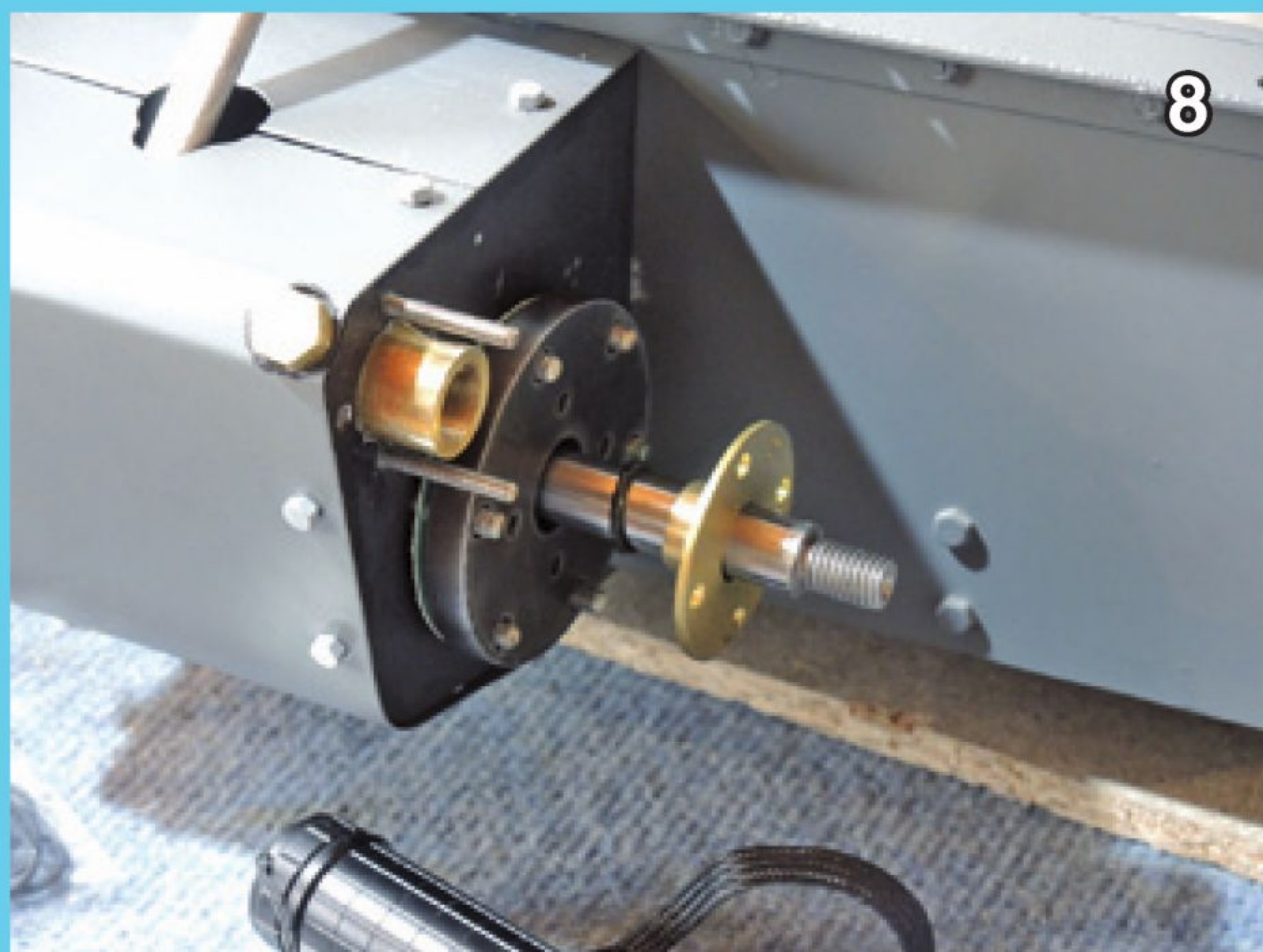
Zylinder am Rahmen mit Zylinderdeckel O-Ring und Stopfbüchsen
