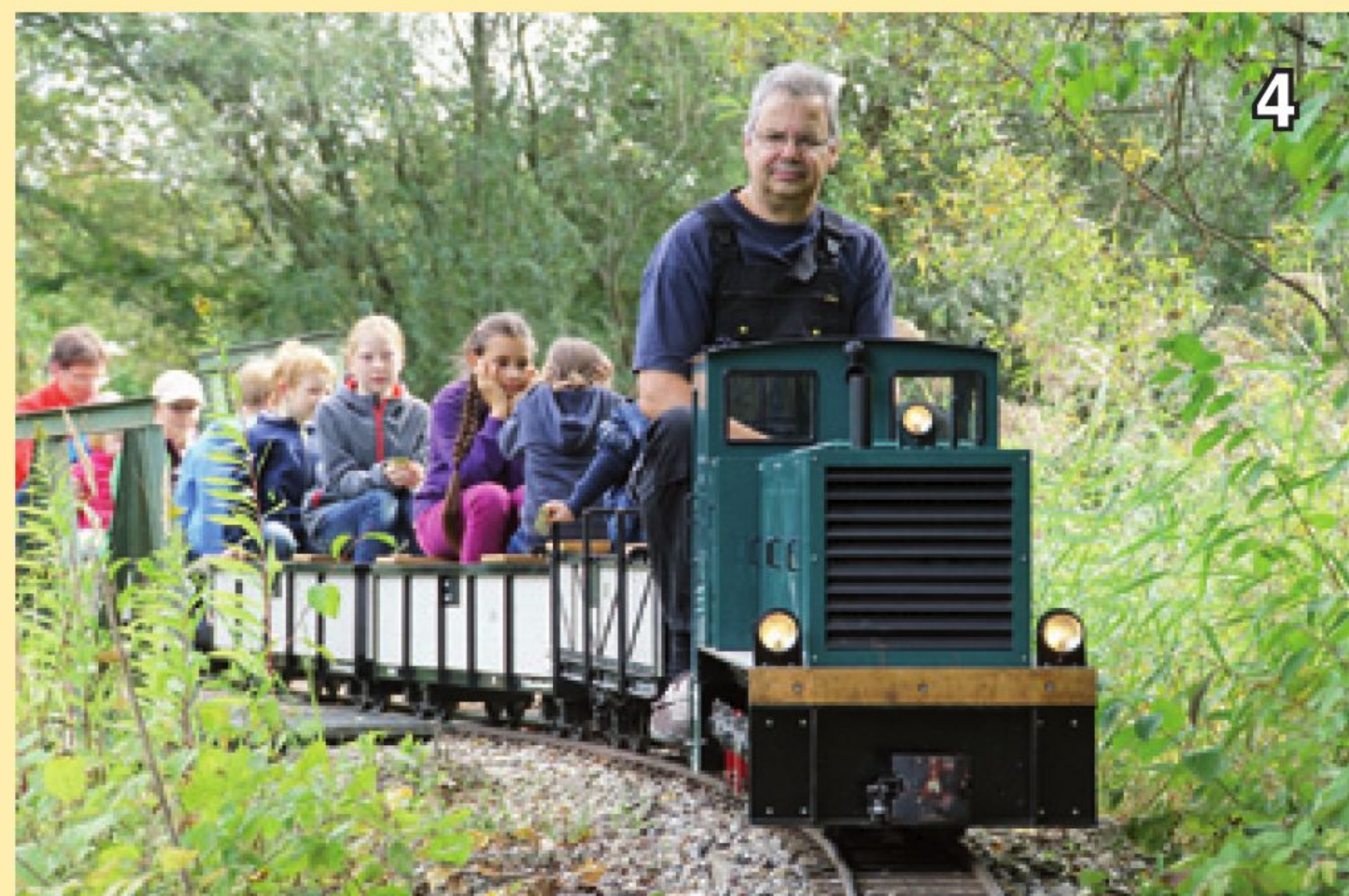
Stütze des Publikumstransportes ist die große Feldbahnlok HF 130 C mit Akkuantrieb, erbaut von Wolfgang Rohne im Jahre 2006. Auch der Zug besteht aus vorbildgetreuen Wagen nach Heeresfeldbahn-Vorbildern, Drehgestellwagen in schwerer Ausführung. Als Lokführer sehen wir hier Gerhard Friesenecker, den Fachmann für Elektrik und Elektronik im Verein.
