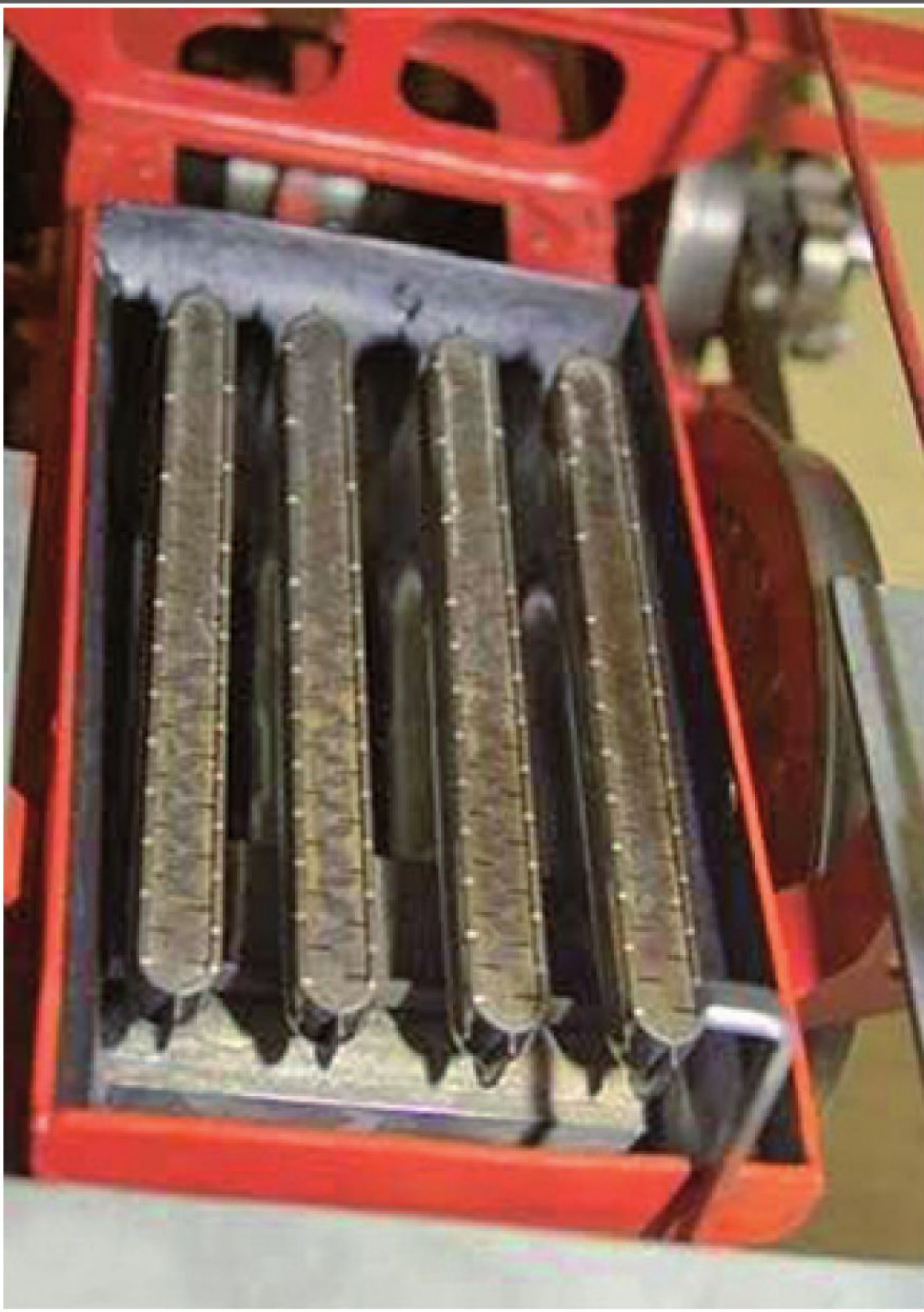
Kein Selbstbau, sondern industriell hergestellt, die Geyser, wie sie in sog. „Gas-Thermen“ eingebaut werden
