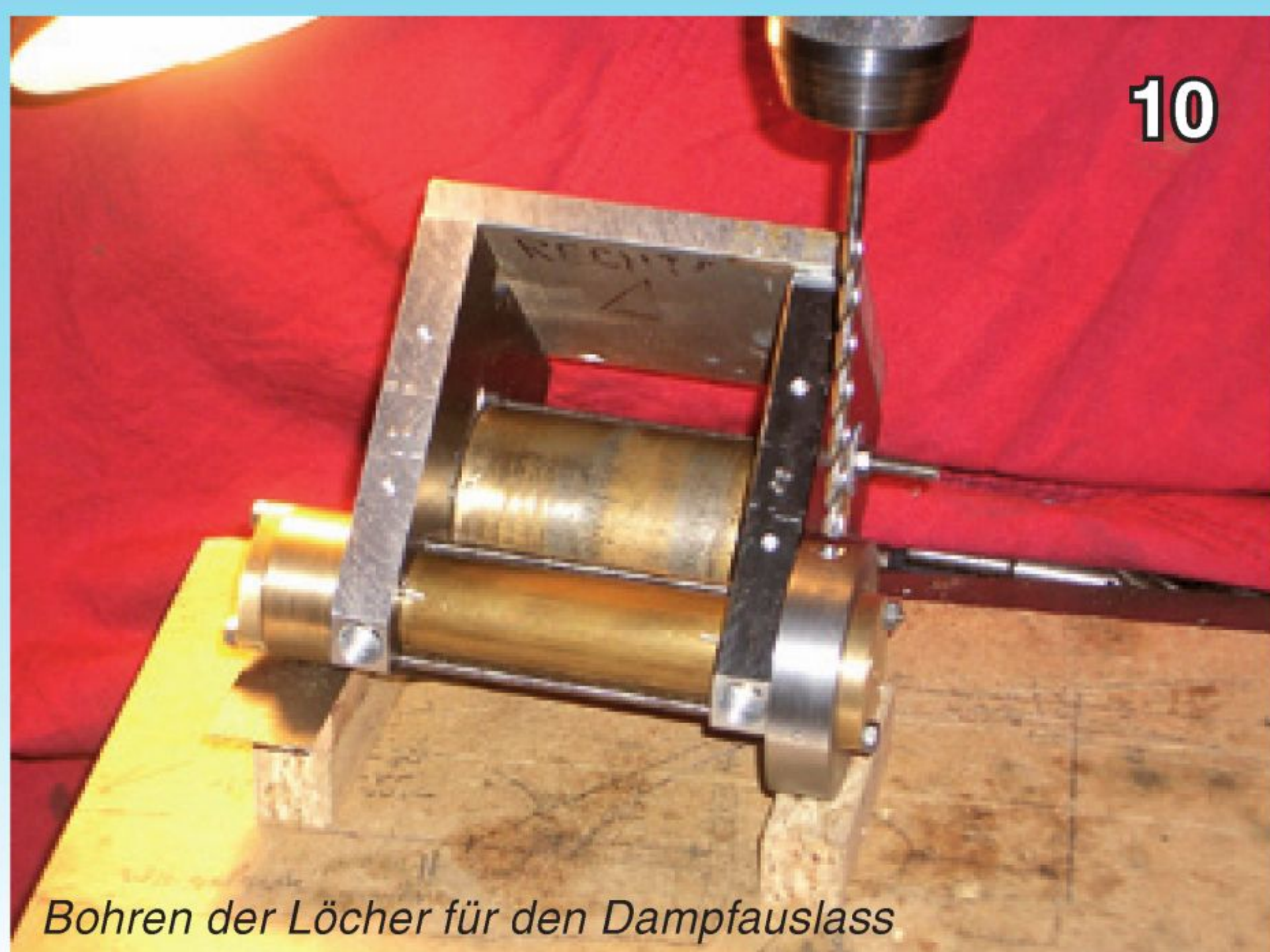
Aufspannen mit Schablone und Bohren der Dampfkanal-löcher in das Steuerungsrohr
