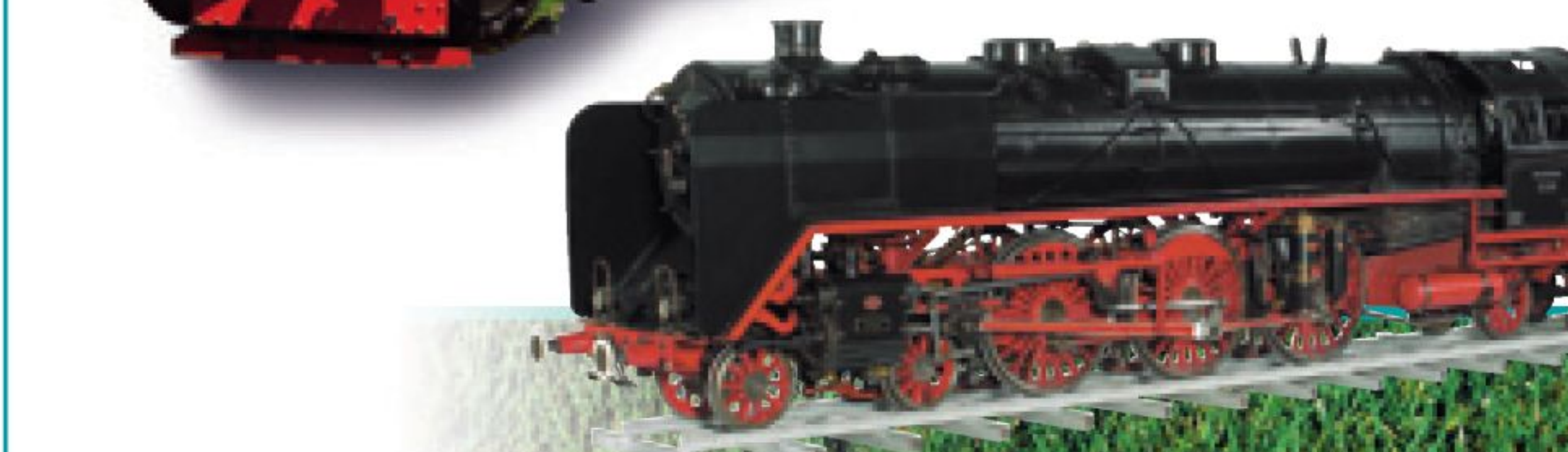
Dampflokomotive BR 01 176 | SPUR: 5" original kohlegefeuert
