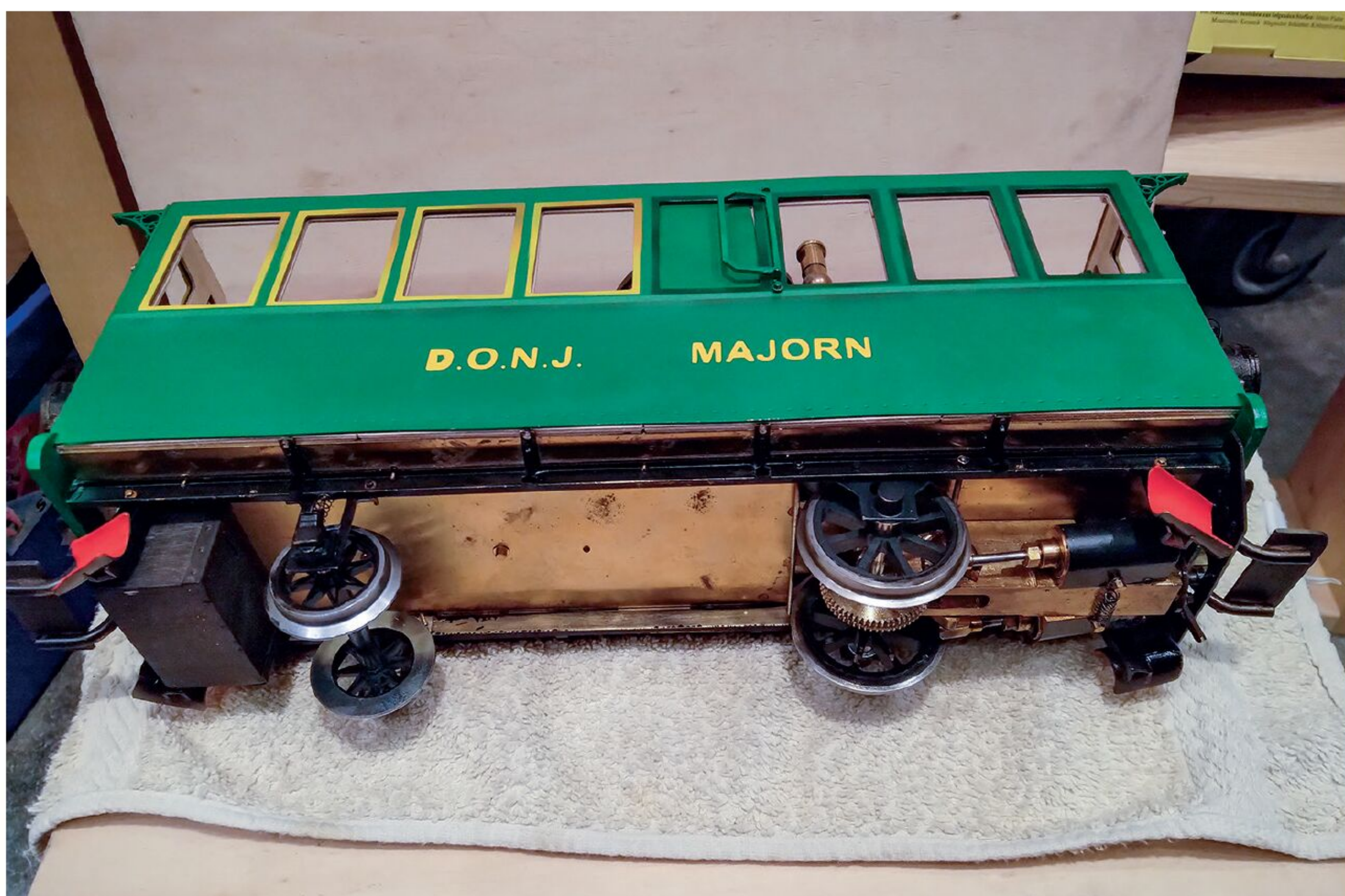
Blick auf die Unterseite mit Antrieb
