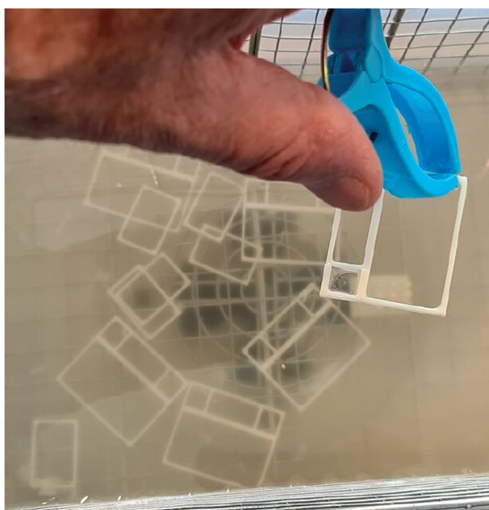
Eine Charge wird in IPA gereinigt. Die Wäscheklammer war besonders hilfreich, um diese Teile hinein- und herauszunehmen.
