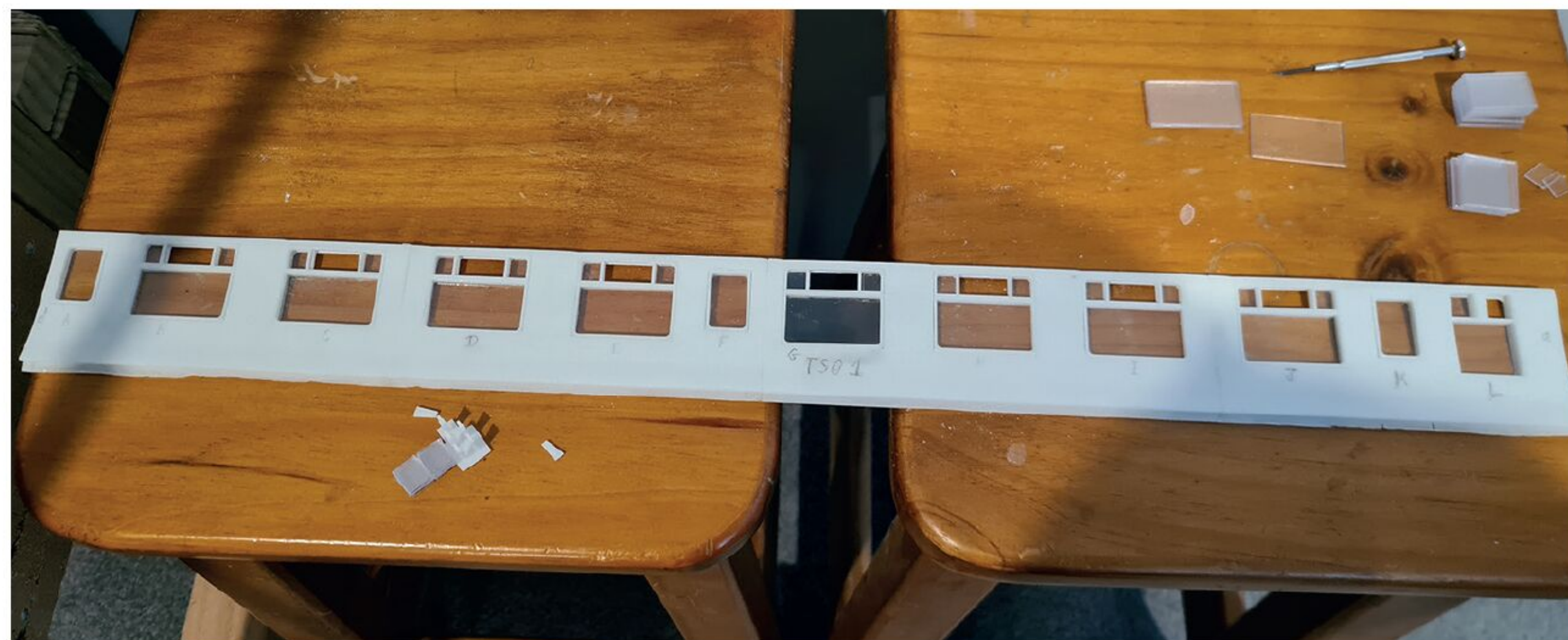
Eine Karosserie mit montierten Rahmen und Verglasung, auf denen der Wagentyp und die Nummer sowie die Fensternummern auf den Rahmen geschrieben sind.
