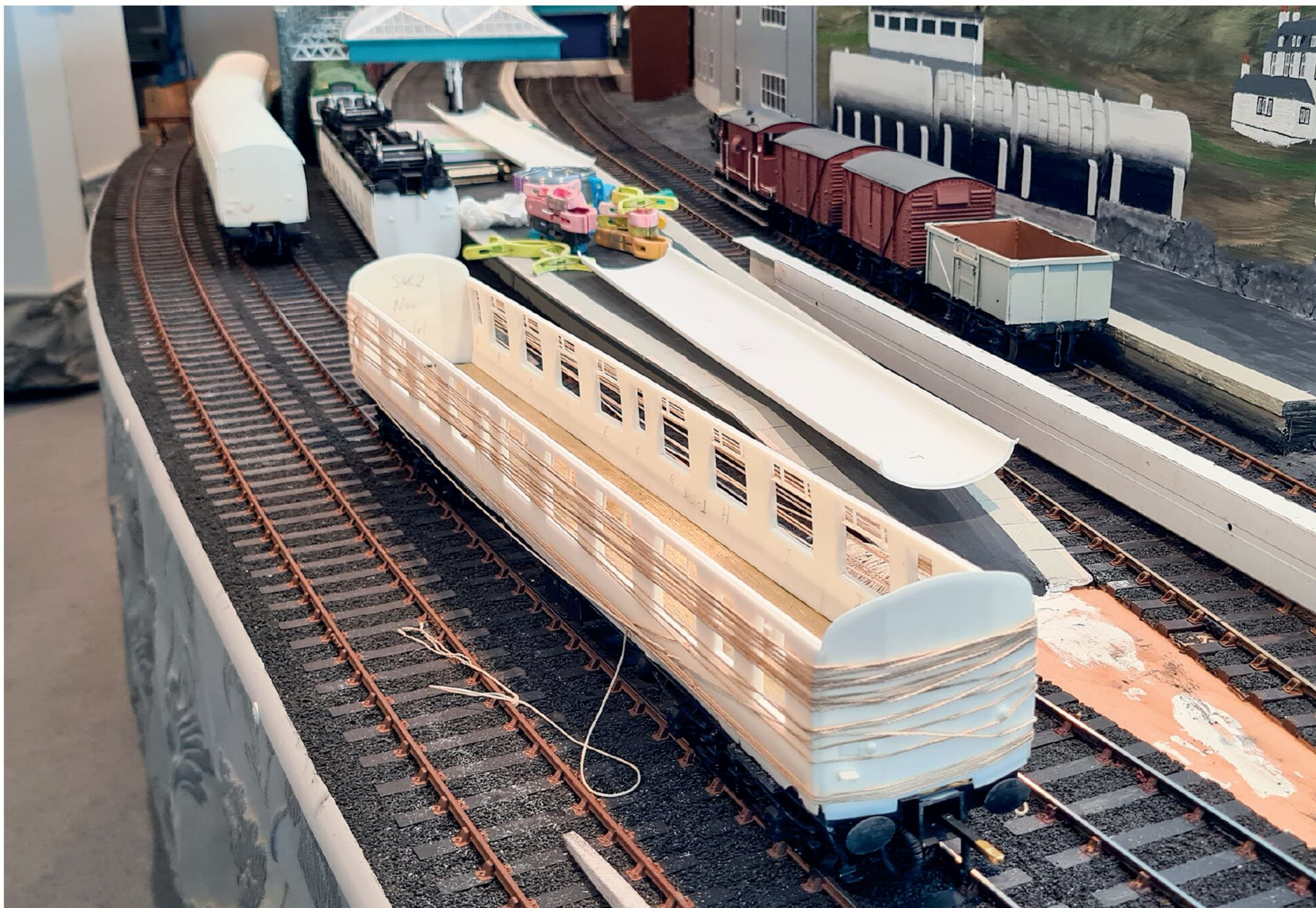
Eine neu montierte Karosseriehülle mit ausgehärtetem Klebstoff, kurz bevor die Schnur entfernt wird, die alles zusammenhält.
