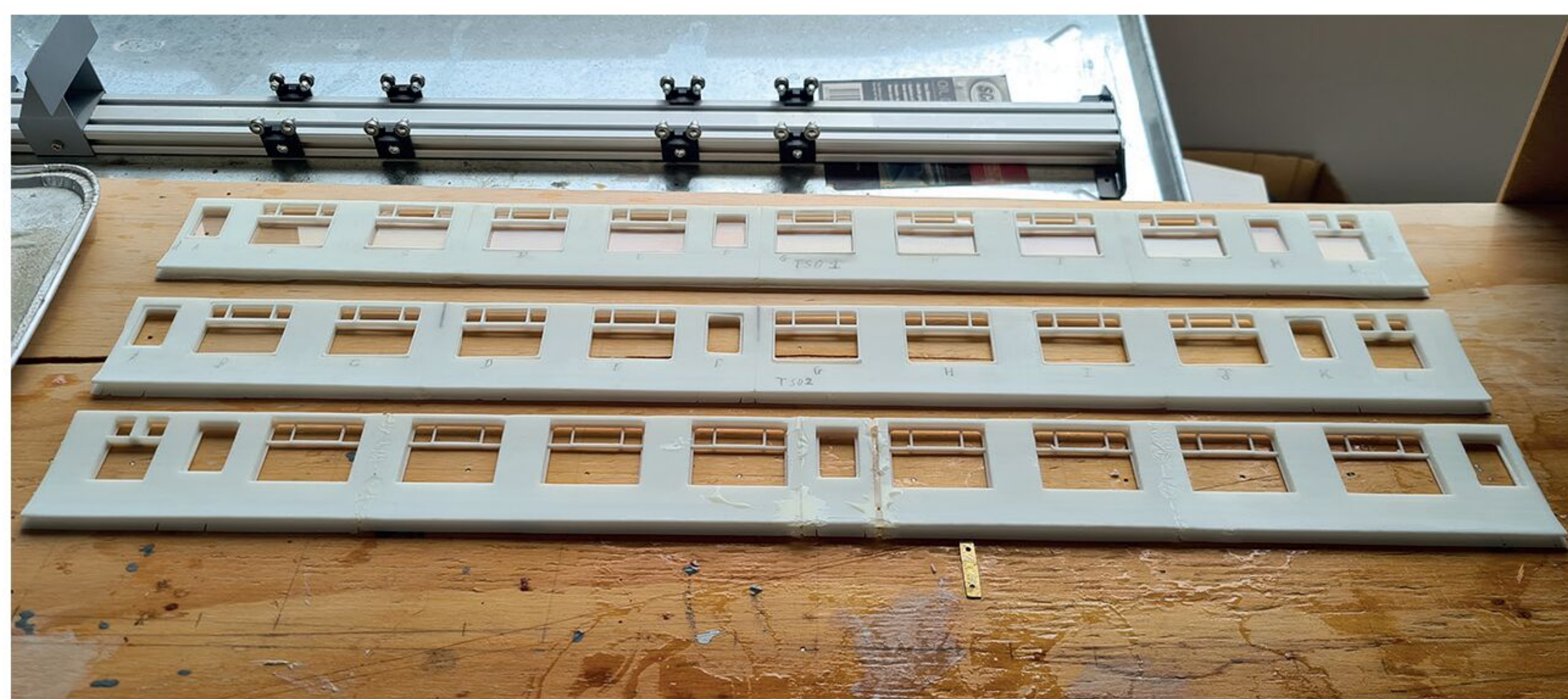
Phasen der Montage der Fensterrahmen an der Karosserie. Unten: Rohklebeabdruck. Mitte: geschliffene Karosserie mit montierten Rahmen. Oben: eingesetzte Verglasung.
