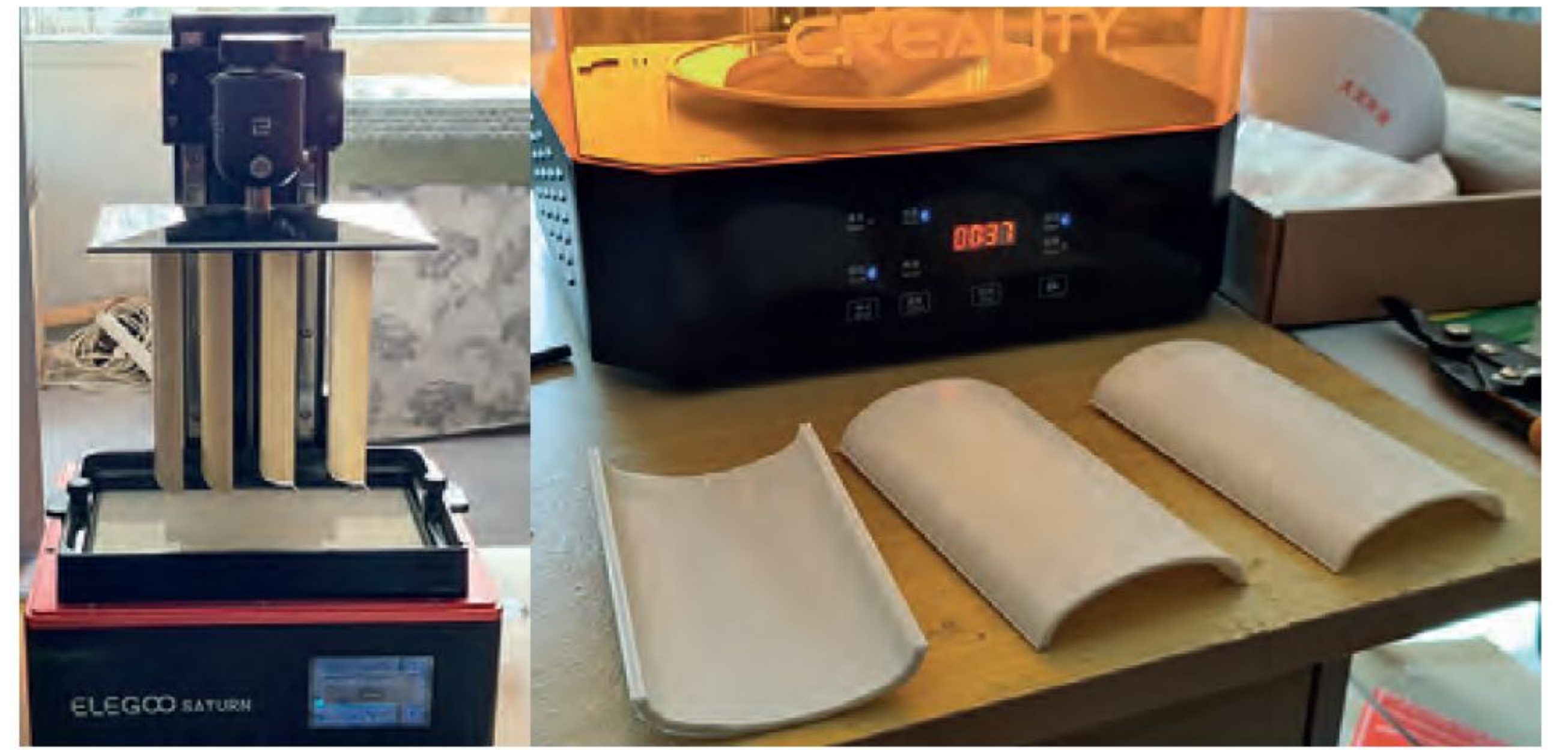
Gedruckte Abschnitte für einen Wagen im Drucker und rechts im Aushärtungsprozess. Beachten Sie, dass die Höhe der einzelnen Abschnitte den Drucker fast ausgereizt hat!
