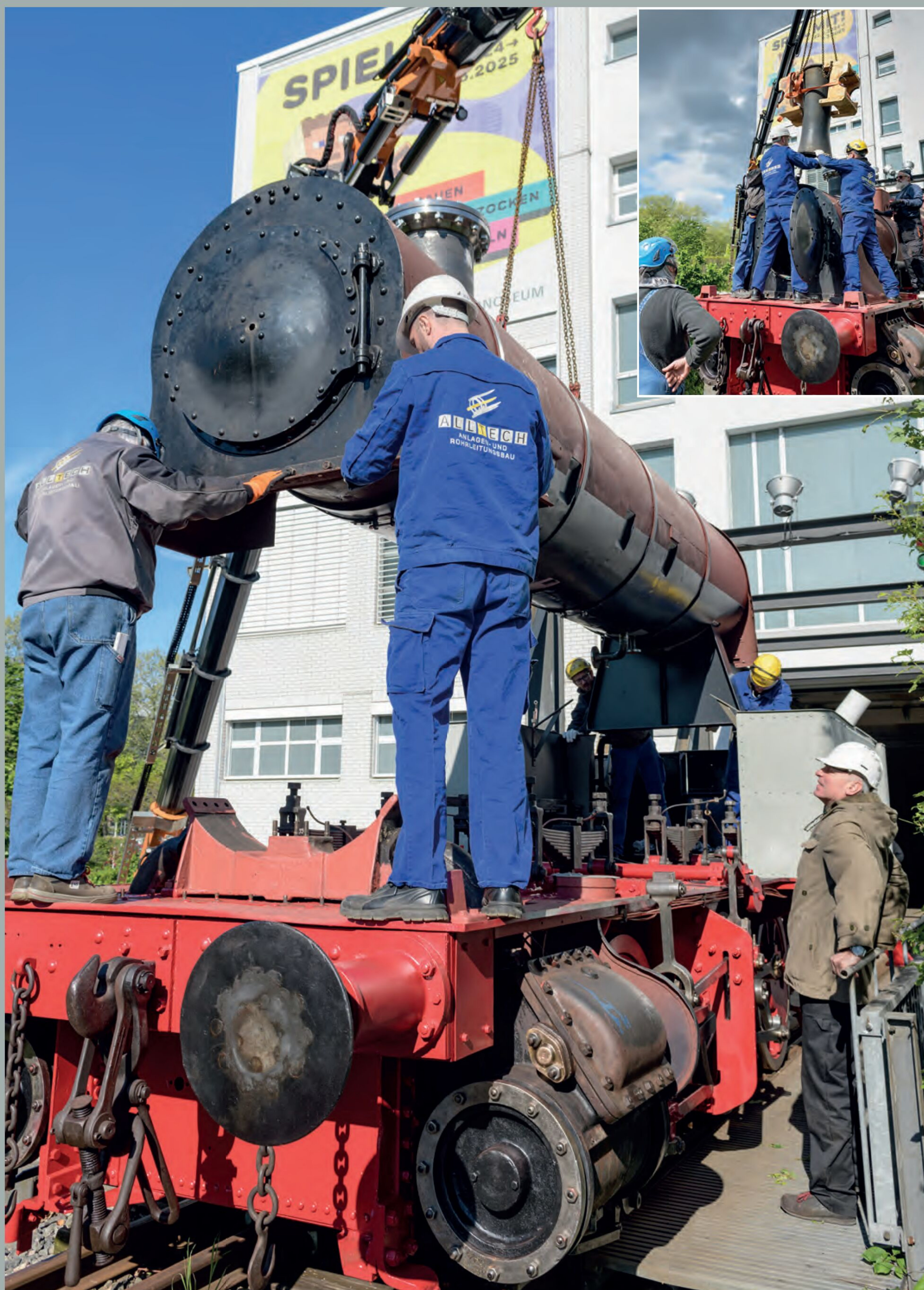
Einbau von Kessel und Schlot im April 2024 (Bildquelle: TECHNOSEUM, Klaus Luginsland)
