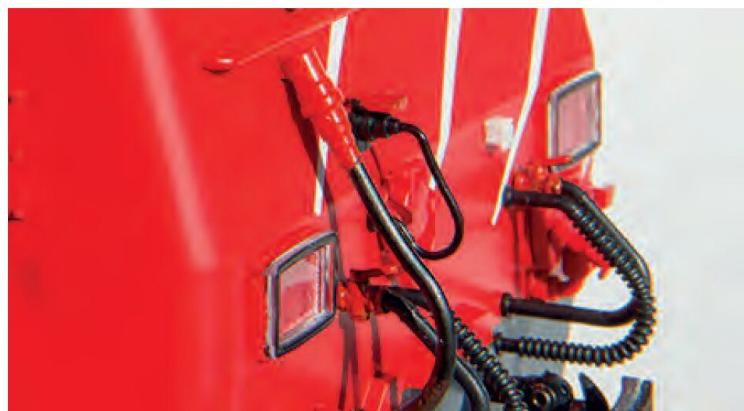
Heizkabel, LBT-Dose und Hähne der Bremsleitung lackieren
