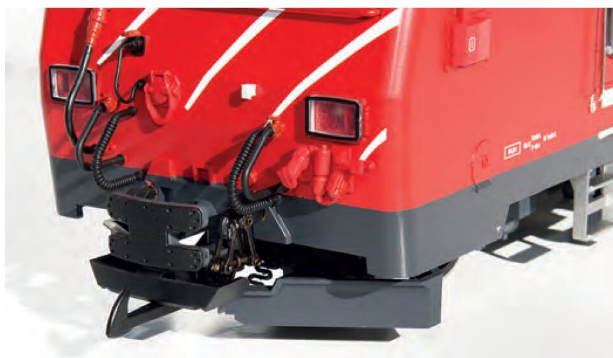
Puffer ersetzt, Pufferplatte montiert, Wippenkupplung mit Spur 1 Schraubenkupplung realisiert
