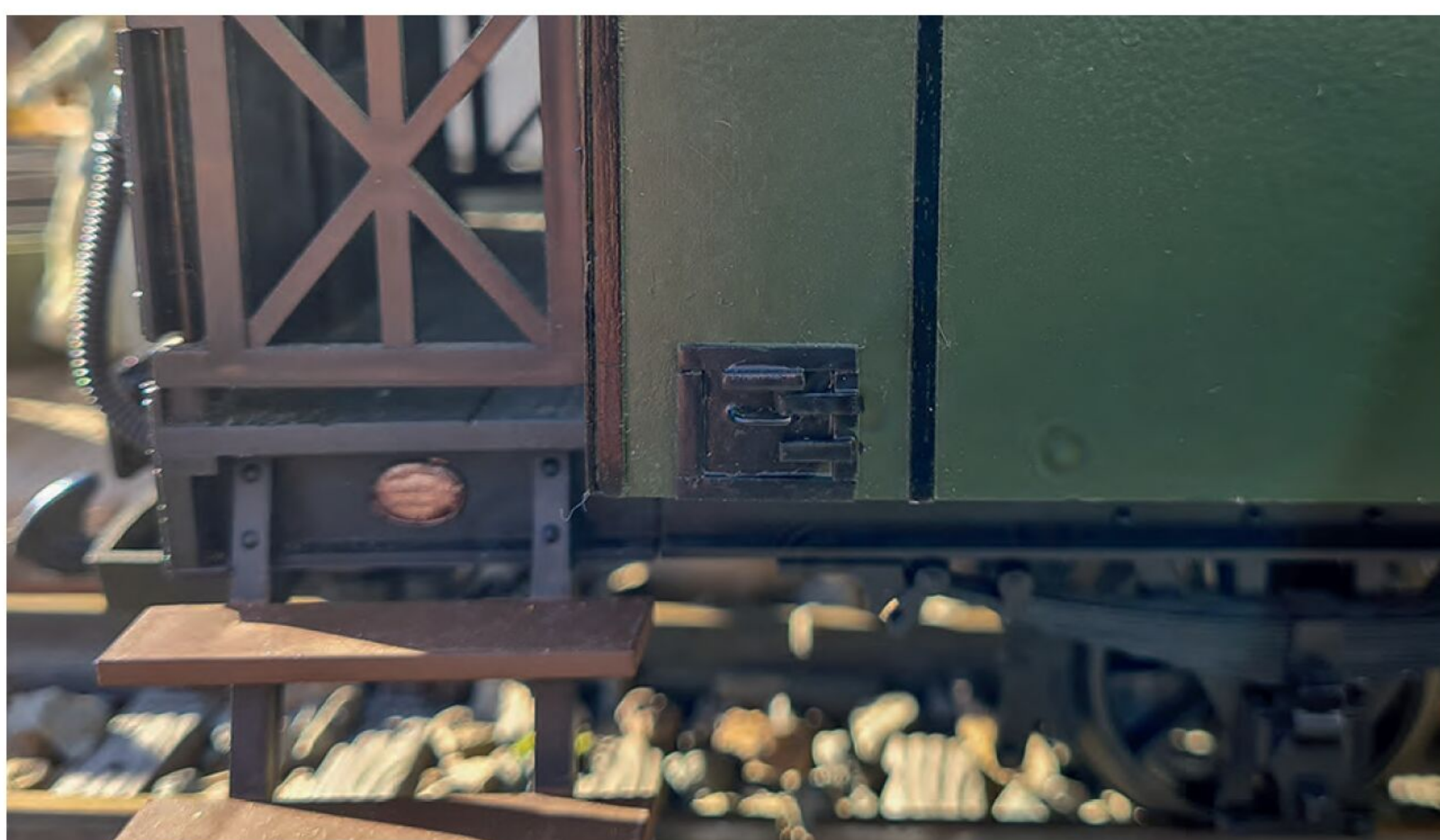
Einfüllöffnung für Presskohleneinsatz
