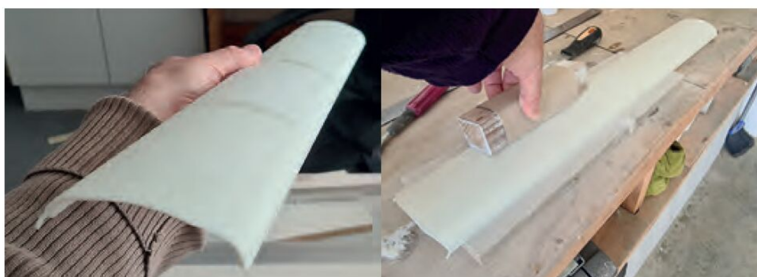
Nach zwei Tagen Aushärtung wird das verleimte Paneel aus der Schablone entfernt und dann auf der Ober- und Unterseite glattgeschliffen.
