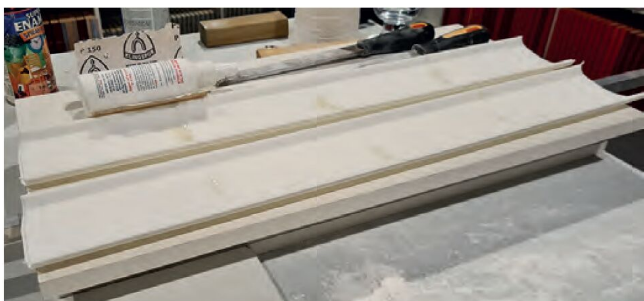
Fehler werden mit Araldite ausgebessert. Nach dem Trocknen und Aushärten werden diese noch einmal abgeschliffen.
