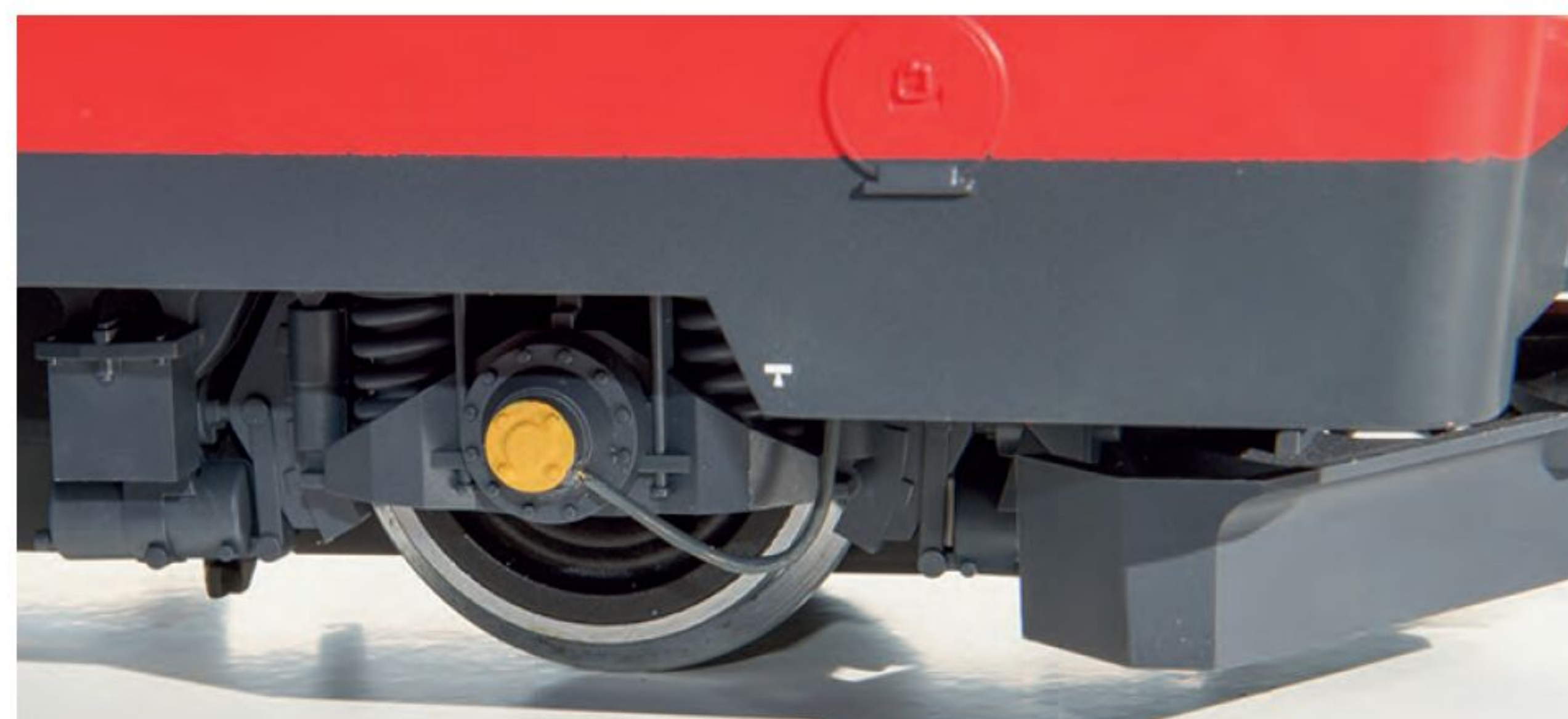
Achsgeber mit Kabel versehen und lackieren
