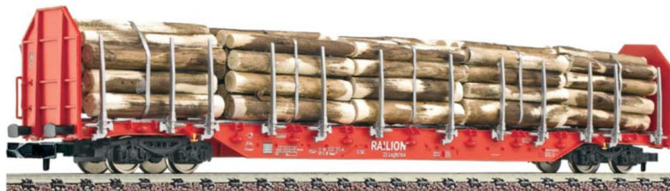
Il carro merci a 4 assi carico è fornito di 24 stanti e di ganci per il fissaggio di container. Locomotive ideali: 722002/722082, 722502/722582, 733502, 738001, 7385.
