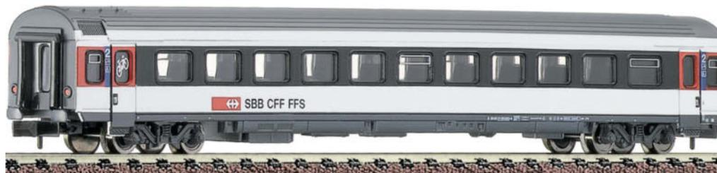
Carrozza passeggeri del tipo EW IV nella colorazione attuale. Le SBB e molte altre ferrovie private hanno inserito per i loro servizi interni molte carrozze a singolo compartimento EW. Dopo le prime carrozze con corridoio del tipo III, le industrie produttrici di carrozze ferroviarie assieme alle SBB iniziarono a produrre le nuove carrozze a scompartimento unico di tipo IV per la prima classe.
