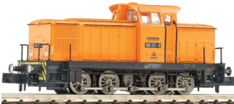
Prototipo: dal 1955 le DDR svilupparono la locomotiva diesel idraulica V60 per il servizio di manovra. Le locomotive da prima presso le DR erano denominate V 60, dopo il cambiamento del sistema di numerazione diventò la serie 106. Con in tutto 2.256 pezzi è una delle locomotive per scartamento normale più costruite. La sua potenza è di 478 kW.
