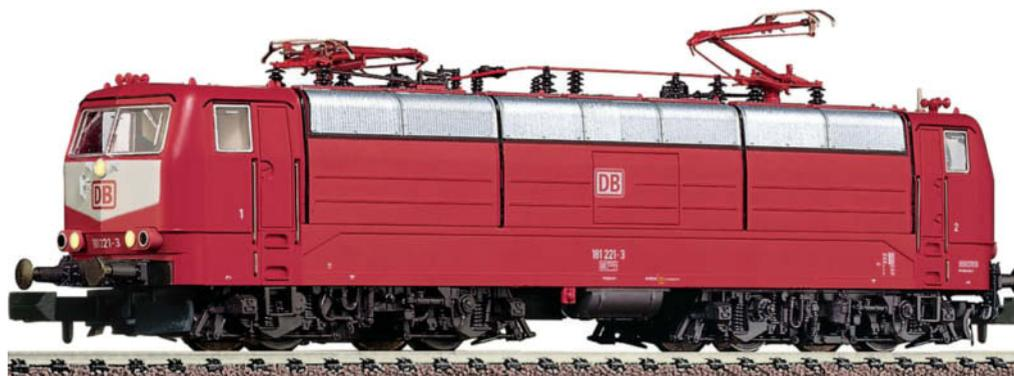
Adatti per il traffico oltre confine tra Germania, Francia e Lussemburgo, le DB impiegarono più di 25 esemplari di questa serie per più sistemi. I locomotori viaggiano sia con il sistema di corrente tedesco a 15 kV con 16 2/3 Hz sia con quello francese a 25 kV con 50 Hz.
