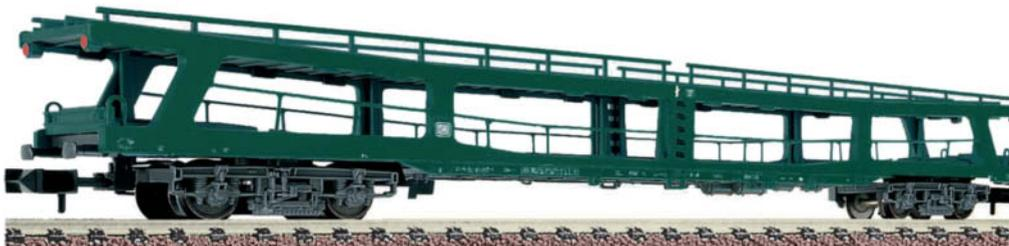
Il veicolo è verniciato nel caratteristico verde con sistema di frenata a magnete.
