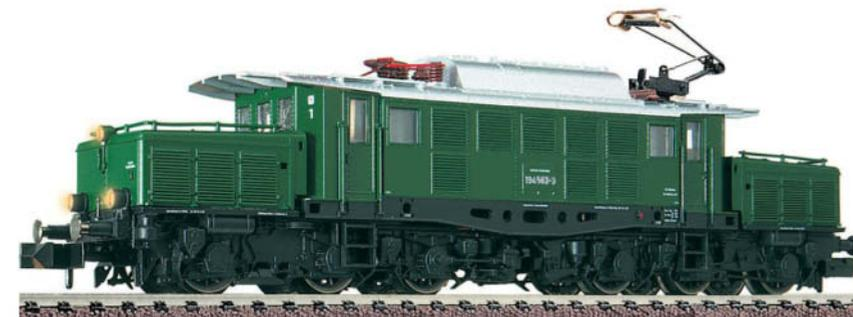
A fine carriera (1987 ca.) alcune 194 prestarono per poco servizio presso le SBB e per questo vennero equipaggiate di pantografi ad un braccio delle SBB. Anche se questo fu un piccolo intervento, l'aspetto dei locomotori cambiò di molto. L'intervento riguarda le seguenti locomotive: 194 563 - 565, 567, 576, 574, 575 und 580. Vi era anche una versione precedente con un pantografo DB davanti ed uno SBB dietro. (194 580-7).
