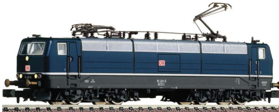
Adatti per il traffico oltre confine tra Germania, Francia e Lussemburgo, le DB impiegarono più di 25 esemplari di questa serie per più sistemi. I locomotori viaggiano sia con il sistema di corrente tedesco a 15 kV con 16 2/3 Hz sia con quello francese a 25 kV con 50 Hz.
