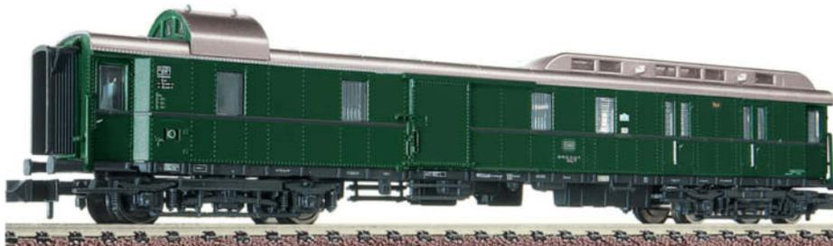
La produzione di veicoli tra il 1928 ed il 1929 prevedeva tra le altre la costruzione di Carri bagagliai e carri postali in Ganzstahlbauart, del tipo PwPost 4ü-28. I vagoni erano adatti per una velocità massima di 140 km/h. Dopo il 1950 le DB approtarono diverse modifiche. Fleischmann ripropone il modello nella livrea della IV epoca.
