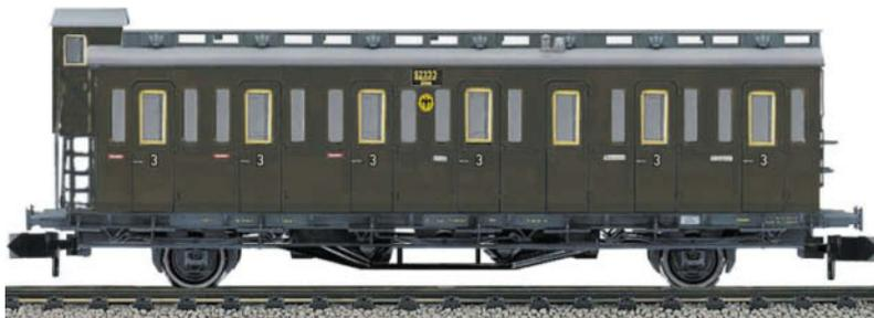
Prototipo: la costruzione delle carrozze a scompartimenti risaliva ancora agli inizi delle Ferrovie. Il tipo „pr 11/pr 21“ è una delle ultime carrozze a scompartimenti prussiane con lucernaio e contemporaneamente anche la carrozza passeggeri più riprodotta. La carrozza a 3 o 2 assi c'era sia con e senza la garitta del frenatore. Alcuni esemplari sono conservati come esemplari museali.
