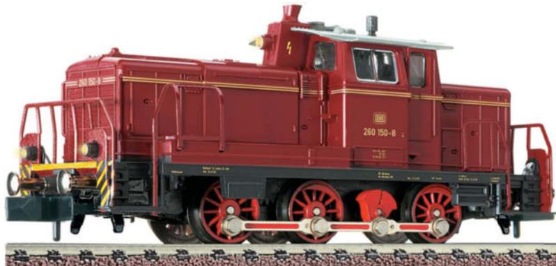
Il modello: motore che non necessita di manutenzione, carrozzeria e telaio in metallo pressofuso, illuminazione di testa a LED, avancorpo della carrozzeria esattamente in scala, scorrimento e passerelle in metallo a tuttotondo. Modello nella colorazione originale in rosso invecchiato. Vagoni adatti: 8258, 825801, 8259, 8283, 828302, 8224, 8225, 8319, 8330, 838701, 8410, 8411, 8480, 8481, 8510, 8524, 8525, 852400, 831403, 834602, 822701.
