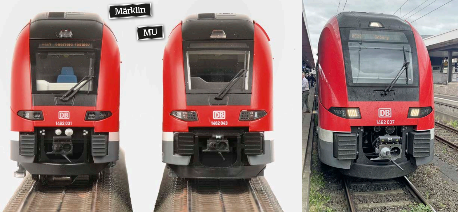
Frontansichten mit eingesteckter Scharfenbergkupplung, die für die Doppeltraktion ausgetauscht werden kann
