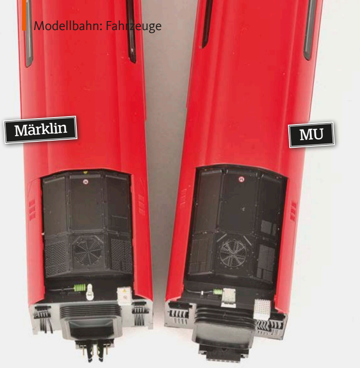
Beide Seiten der Mittelwagen sind im Dachbereich identisch ausgerüstet
