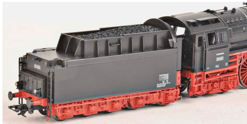
Der kurzgekuppelte Tender verfügt über ein zweiachsiges Drehgestell und drei feste Radsätze
