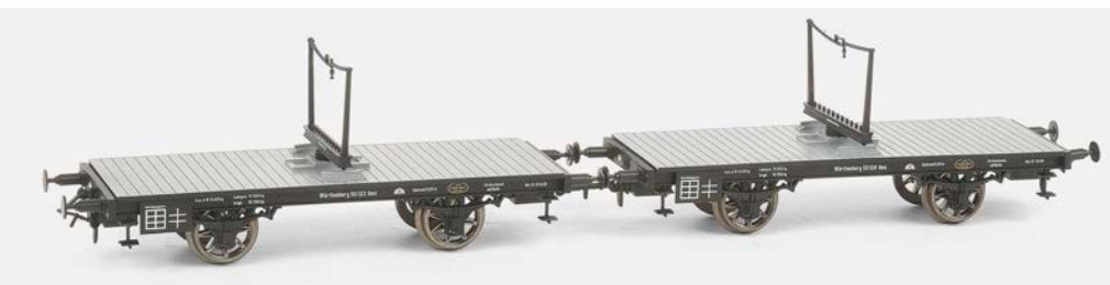
Das Länderbahn-Schemelwagengpärchen von Brawa ist ab Werk untereinander mit einer starren Kupplung in den NEM-Schächten verbunden MM
