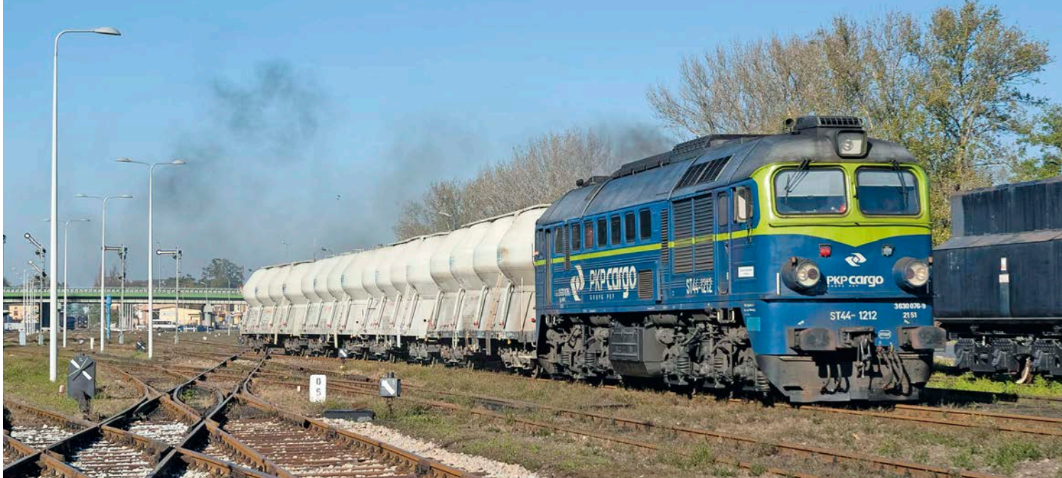
Die PKP modernisierte etliche Loks mit Caterpillar-Motoren und neuer Regelung. Von außen erkennbar sind die geänderte Luftansaugung sowie die Klimaanlage (Wolsztyn, Oktober 2014)
