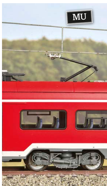
Der Märklin-Stromabnehmer (links) wird digital angehoben und federt weiter aus als der von Modellbahn Union
