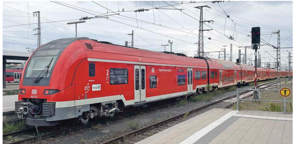
Die vierteiligen Desiro HC werden oft in Doppeltraktion eingesetzt
