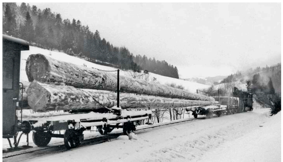
97 101 mit einem Langholztransport oberhalb von Obernzell mit Bremsleitungsverbindung sowie die dazu passende Vorschrift, die für Modellumsetzungen als Vorlage dienen kann Max Schütz/Eisenbahnstiftung
