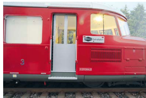
Die vier Schiebetüren des „Roten Pfeils“ lassen sich mechanisch öffnen
