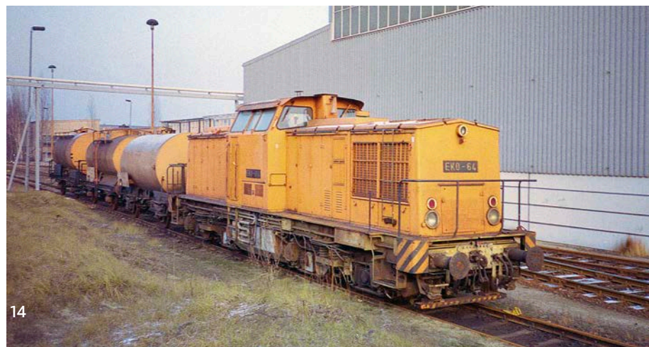
Vor allem Betriebe mit ausgedehnten Werkbahnnetzen – wie hier im Bandstahlkombinat Eisenhüttenstadt – hatten großen Bedarf an leistungstarken Rangierloks wie der V 100 4 Slg. Michael U. Kratzsch-Leichsenring
