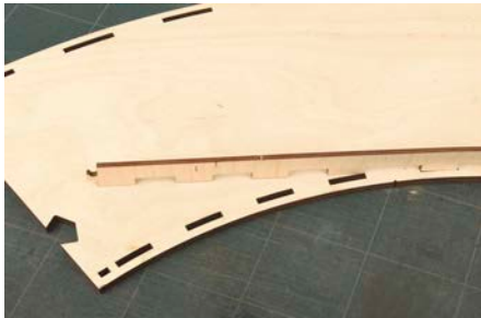
In die Nuten der runden Trassenbretter werden 15 Millimeter hohe Streifen eingeleimt, die für die Stabilität sorgen
