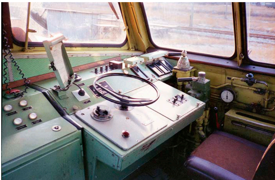
Das Fahrpult der V 100 4 /111 – hier im Lieferzustand – ist von der V 100 1 übernommen worden, primär für den Streckendienst ausgelegt und wurde bei späteren Loks geändert Slg. Michael U. Kratzsch-Leichsenring
