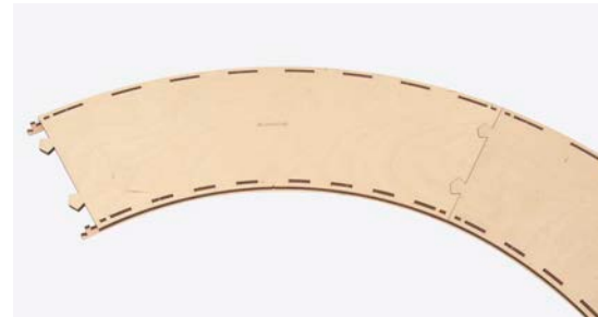
Am Basteltisch empfiehlt es sich, 180-Grad-Trassen vorzufertigen und diese erst später zum Gleiswendel zu vervollständigen
