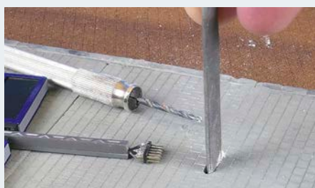
Für die Montage der Zugzielanzeiger wird eine Öffnung von vier mal acht Millimetern benötigt. Passende Abdeckkappen zum Verschließen des Spalts liegen bei
