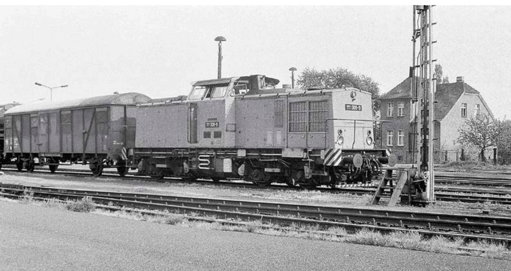
Am 11. Mai 1990 bespannt die Rangierlok 111 008 einen Güterzug in Wittstock. Die Lok trägt einen sonst nur bei den Industriemaschinen angebrachten Bahnräumer Slg. Friedhelm Köhler
