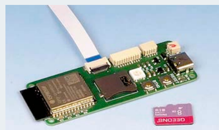
Zum Einbau der Videowerbedisplays ist ein Langloch von 5 mal 15 Millimetern erforderlich. Der Controller wird samt SD-Karte über ein Flachbandkabel mit dem Display verbunden
