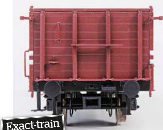
Exact-train Exact-train bildet vorbild- gerecht das seitlich versetzte Stirnbrett nach, auch an die Bremsschlauch- abdeckung wurde gedacht
