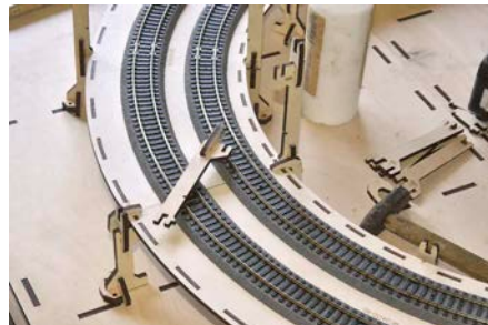
Die Stützen der zweiten Ebene fixieren die erste. Trotz der „verzahnten“ Nuten sollte man sie mit Leim dauerhaft sichern
