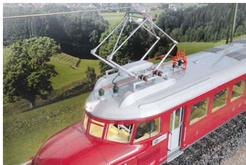
Der digital betätigte Dachstromabnehmer hat ab Werk einen Hub von maximal 47 Millimetern
