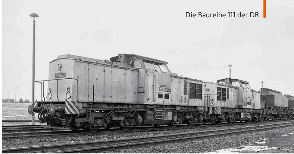
111 001 und 002 im Streckeneinsatz als Doppeltraktion Motor gegen Motor für den Umleiterverkehr mit Kalizügen nach Rostock Seehafen im Jahre 1982; diese Kombination reduzierte Lärm und Hitze im Führerstand DR/Slg. Dirk Endisch
