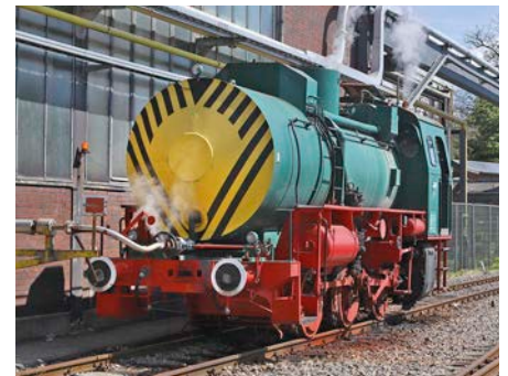
54 In Mannheim erhielten Dampfspeicherloks eine HU Guus Ferrée
