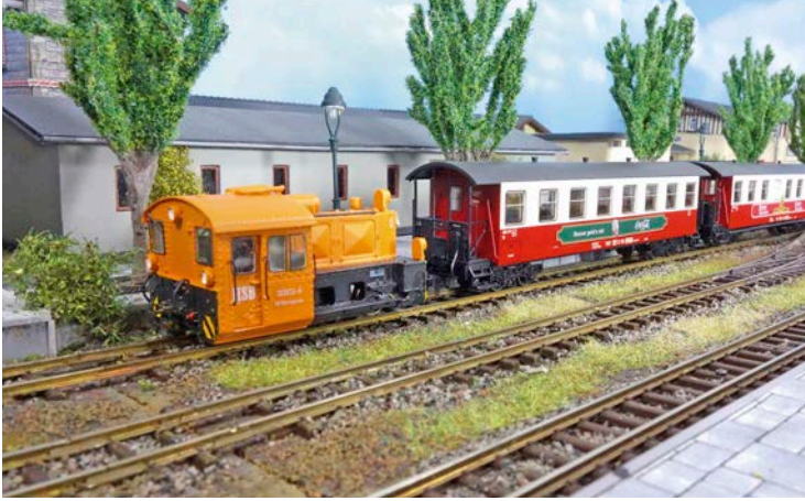
Die Köf II – ein Umbau eines Brawa-H0-Modells auf 12-Millimeter-Spurweite – erledigt die Rangierarbeiten im Bahnhof (links), während der Rottenkraftwagen vom Typ Skl 24 (rechts) für die Streckenarbeiten eingesetzt wird
