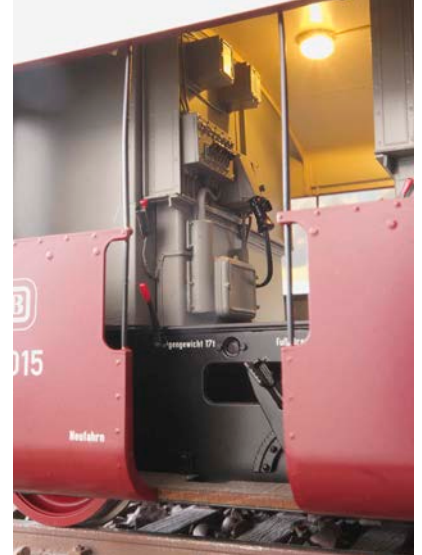
Exakt nachgebildeter Führerstand der auf ein geschlossenes Führerhaus umgebauten Ks 4015 Peter Pernsteiner (3)
