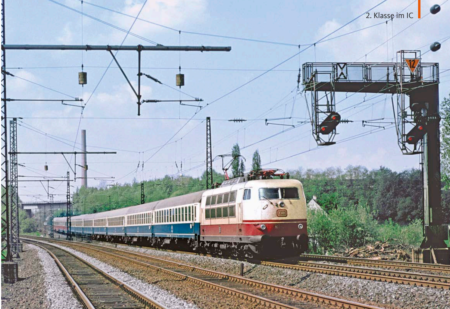
Bereits zweiklassig unterwegs ist IC 535 „Theodor Storm“ mit 103 124 in Dortmund-Somborn am 19. Mai 1979. Exakt an dieser Stelle befindet sich heute die Ausfädelung der 1988 in Betrieb gegangenen neuen Eckverbindung nach Witten. Selten im DB-Netz ist Einfach-Fahrleitung ohne Tragseil über den beiden Gütergleisen im Bildvordergrund Ulrich Budde
