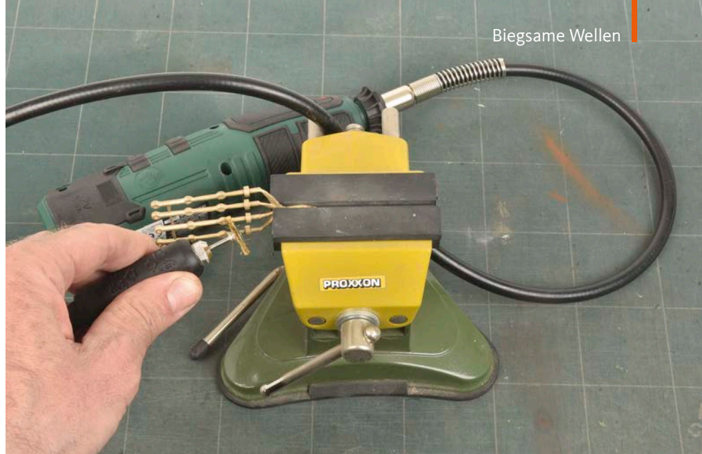
Wenn man regelmäßig die biegsame Welle an der Maschine montiert hat, sollte man diese nicht lose auf die Ablagefläche legen, sondern entsprechend befestigen
