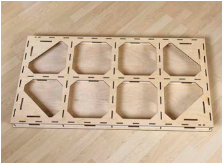
Sowohl die Basissegmente als auch jene mit Schattenbahnhof bieten an der Unterseite einen Hohlraum für die Verkabelung bzw. elektronische Bauteile
