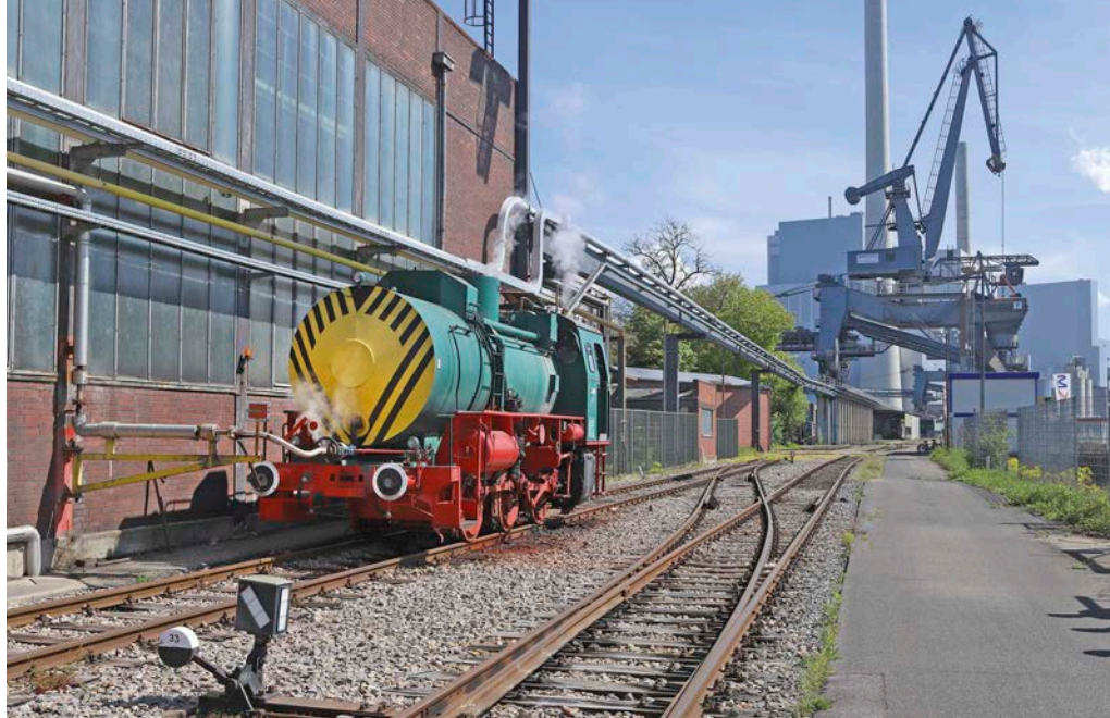
„Betankung“ an der „Wand“: Über eine flexible Leitung wird die GKM 4 mit frischem Dampf gefüllt Guus Ferrée
