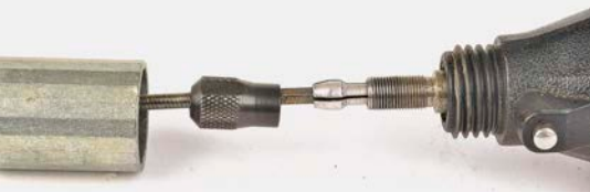
Zunächst werden die herausziehbaren Stahlwellen mittels Spannzangen und Rändelmutter befestigt (unten und mittig), anschließend wird die gesamte biegsame Welle mit der aufgeschobenen Mutter an der Maschine gesichert
