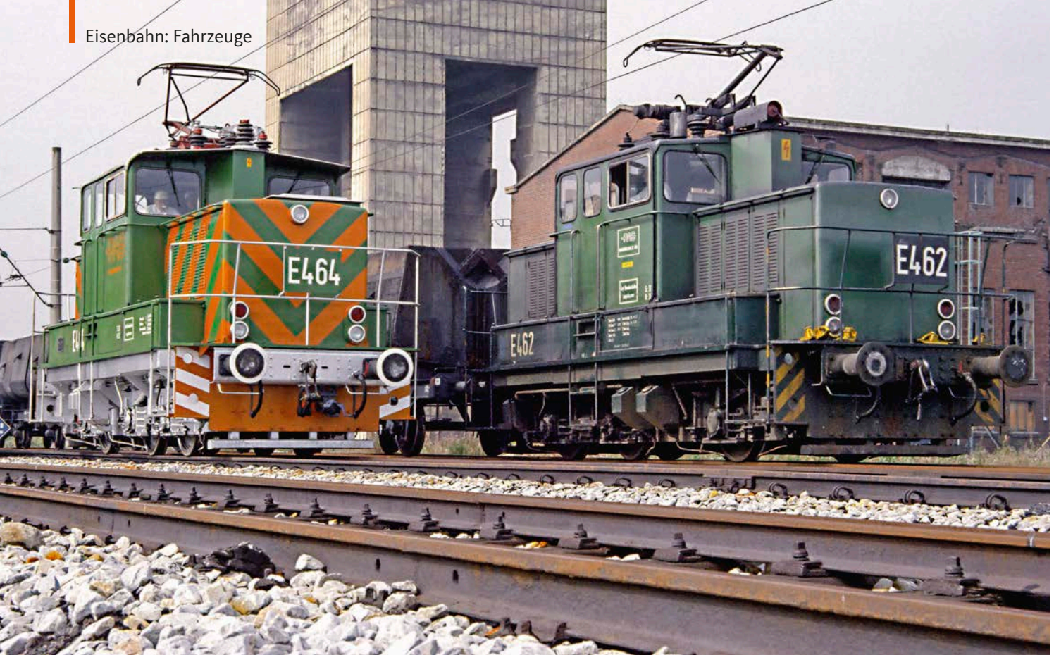
Vor und nach dem Umbau: Links die umgebaute Drehstrom-Dreisystemlok E 464. Rechts die Zweisystem-Ellok E 462 im Ursprungszustand. Die beiden Lokomotiven rangieren 1983 im Zechenbahnhof König Ludwig 4/5 Michael Maiss
