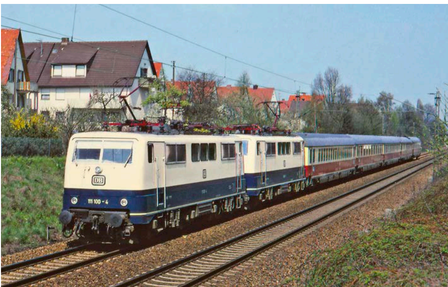
Die DB erprobt vor Einführung von IC '79, ob mit der Baureihe 111 (war ursprünglich nur für 150 km/h zugelassen) auch IC-Züge mit Tempo 160 gefahren werden können. Am 12. April 1979 ist 111 100 zusammen mit einer weiteren 111 und IC 173 „Mercator“ aus Hamburg-Altona bei Freiburg-Zähringen auf dem Weg nach Basel SBB Zeno Pilmann
