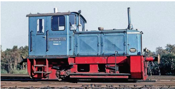
Drei Dieselloks des Typs AGM 517 R in explosionsgeschützter Ausführung (hier D 02) waren auf dem Streckennetz der Zeche König Ludwig im Einsatz K. Joachim Maiss
