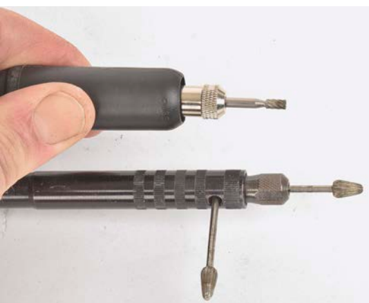
Während die drehbare Welle bei älteren Dremel-Geräten per Stift gesichert wird, verwendet Parkside ein verschiebbares Unterteil MM (7)
