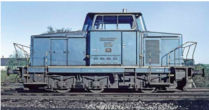
Im Zechenbahnhof König Ludwig 1/2/6 wartet D 07 auf ihren nächsten Einsatz. Die Lok vom Typ 530 C unterschied sich von den S 400 in Antrieb und Achsfolge K. Joachim Maiss
