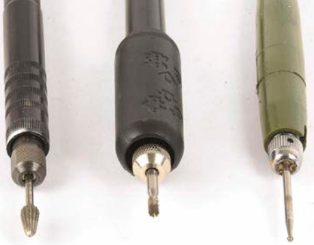
Verschiedene Werkzeugaufnahmen an den biegsamen Wellen von Dremel, Parkside und Proxxon (von links)
