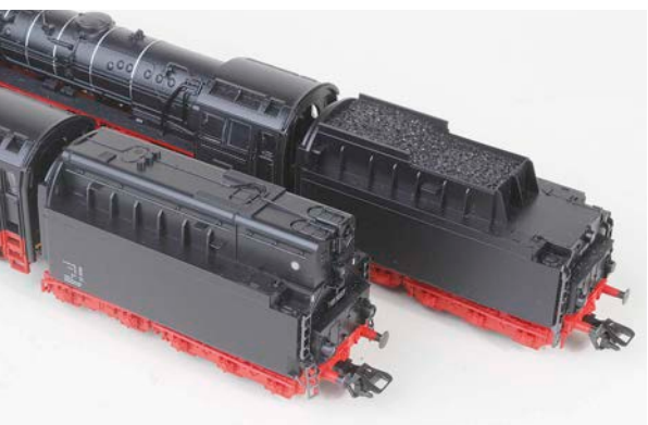
Typisch für die Baureihe 01 10 sind die fünfschigen Tender der Bauart 2'2 T 38
