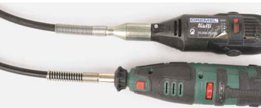
Wenn man regelmäßig die biegsame Welle an der Maschine montiert hat, sollte man diese nicht lose auf die Ablagefläche legen, sondern entsprechend befestigen
