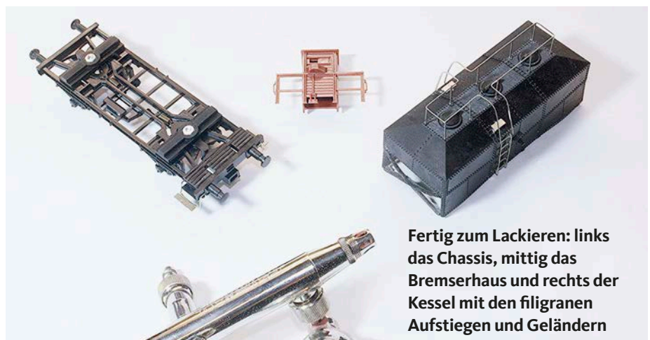
Die Baugruppen des Güterwagen-Fahrwerkes liegen für die Endmontage bereit
