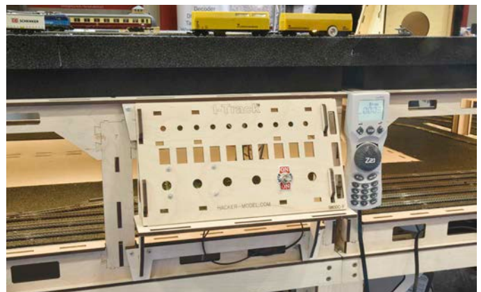
Für Stellpulte, Fahrregler usw. gibt es verschiedene an die Segmentkästen anschraub- bzw. ansteckbare Zusatzelemente MM (8)
