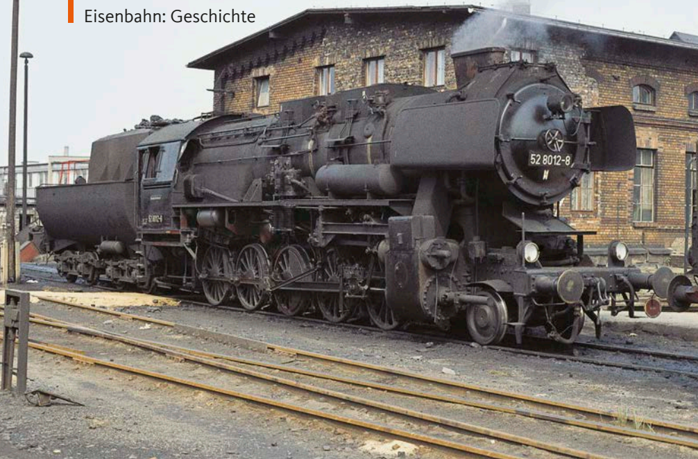
Im Frühjahr 1980 pausiert 52 8012 in der Est Dresden-Friedrichstadt. Sie ist zu dieser Zeit noch mit einem Giesl-Flachejektor ausgerüstet
