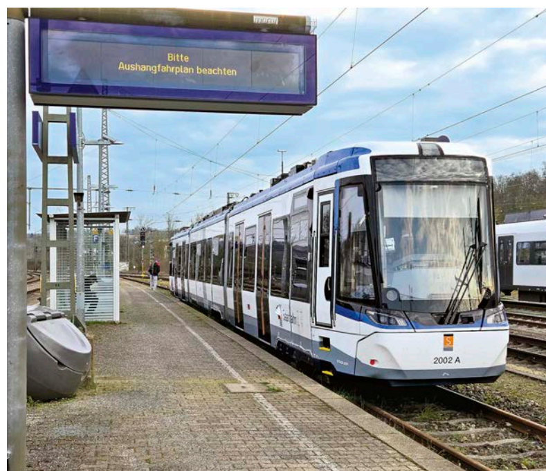
Saarbahn-TramTrain 2002 (D-SBS 94 80 0492 702) am 23. März 2026 in Plochingen. Für Probefahrten wurden an dem CITYLINK Messapparaturen angebracht Peter Garke
