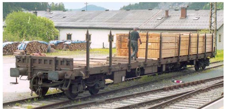
Der vierachsige Drehgestellwagen wird auf dem Gleisanschluss eines Sägewerks 2004 mit Schnittholz beladen
