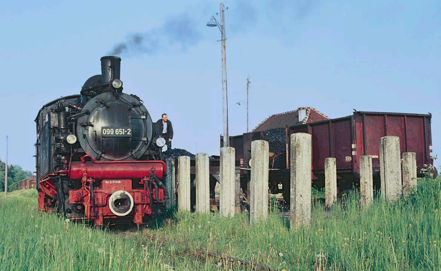
In Schussenried werden die Kohlevorräte mittels Schubkarren und Flechtkörben aus dem bereitgestellten E-Wagen ergänzt
