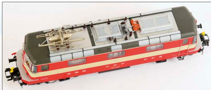
Dachbereich mit nur einem Stromabnehmer MM (6)
