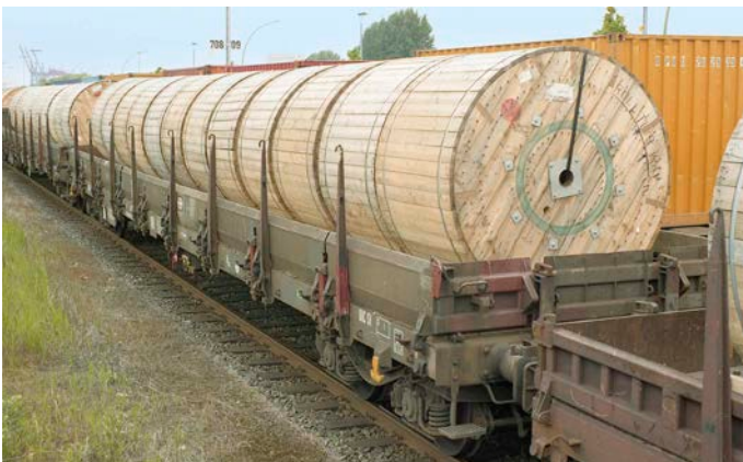
Die in Wagenlängsrichtung verladenen Rollen sind durch Festlegehölzer, Holme, Holzkeile und Streben gesichert bzw. auch zusammengebunden (oben, links unten). Die zwei Kabeltrommeln samt Transportsicherung unten rechts stammen von Busch
