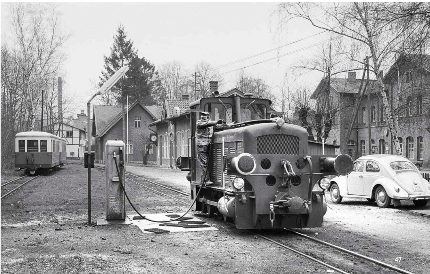
Kleinbahn-Idylle in Osterode (Harz) Nord: Im Frühjahr 1966 ergänzt V 11 ihre Kraftstoffvorräte an der Dieseltankstelle. Auf dem Nachbargleis steht der Triebwagen T 1 (Dessau 3085/1935) samt Beiwagen Wolfgang Zeunert/Slg. Dirk Endisch (2)
