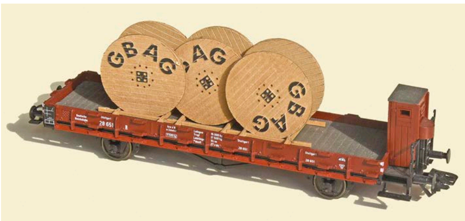
Wagengruppe mit kleineren Kabeltrommeln auf zwei- und vierachsigen Niederbordwagen. Die im oberen Bereich gesattelt verladenen Trommeln sind durch Holzlatten miteinander verbunden und mit Spanndrähten gesichert. Trommeln ohne Schutzbeplankung können auch verschachtelt verladen werden
