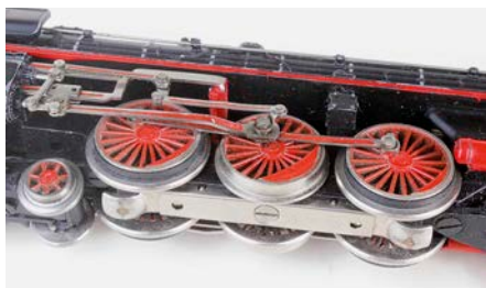
Trix-Antriebskonzept: Schleiferbleche zwischen den Kuppelrädern, erster und dritter Kuppelradsatz mit Haftreifen, und mittlere Spurkränze geschwächt, um durch enge Gleisradien zu kommen
