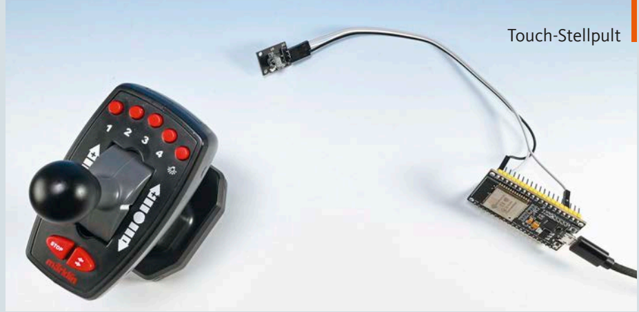
Zum Erkennen der Infrarotsignale dient eine ESP32-Entwicklungsplatine mit angeschlossener Infrarotempfangsleiterplatte
