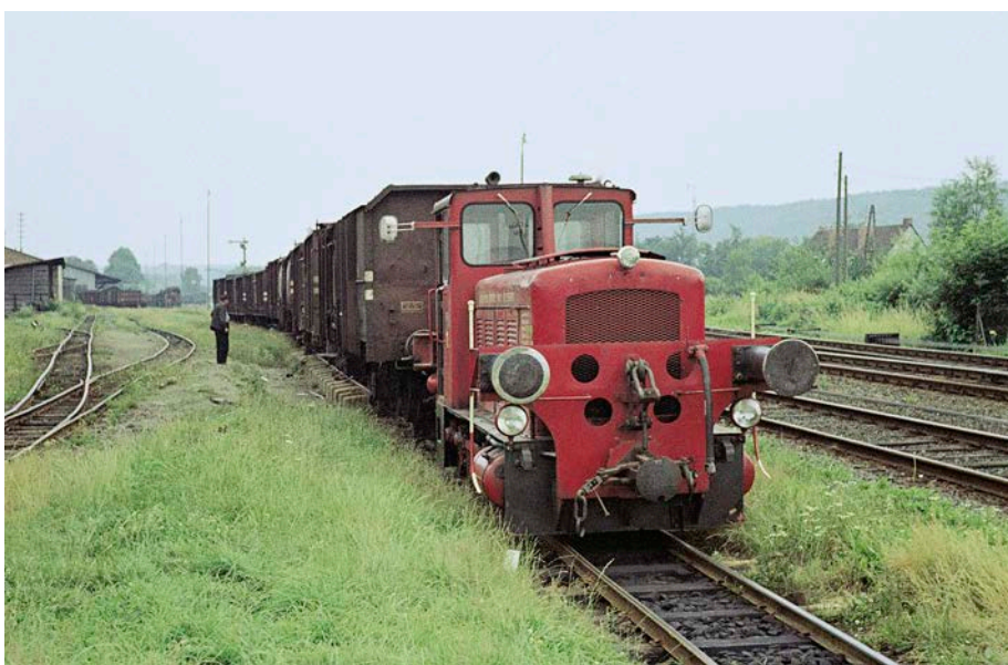
Markant fällt die breite Normalspur-Pufferbohle an V 11 (Jung 11770/1953) ins Auge. Im Bahnhof Osterode (Harz) Nord ist die Diesellok 1967 an der Rollbockgrube im Einsatz Wolfgang Zeunert/Slg, Dirk Endisch
