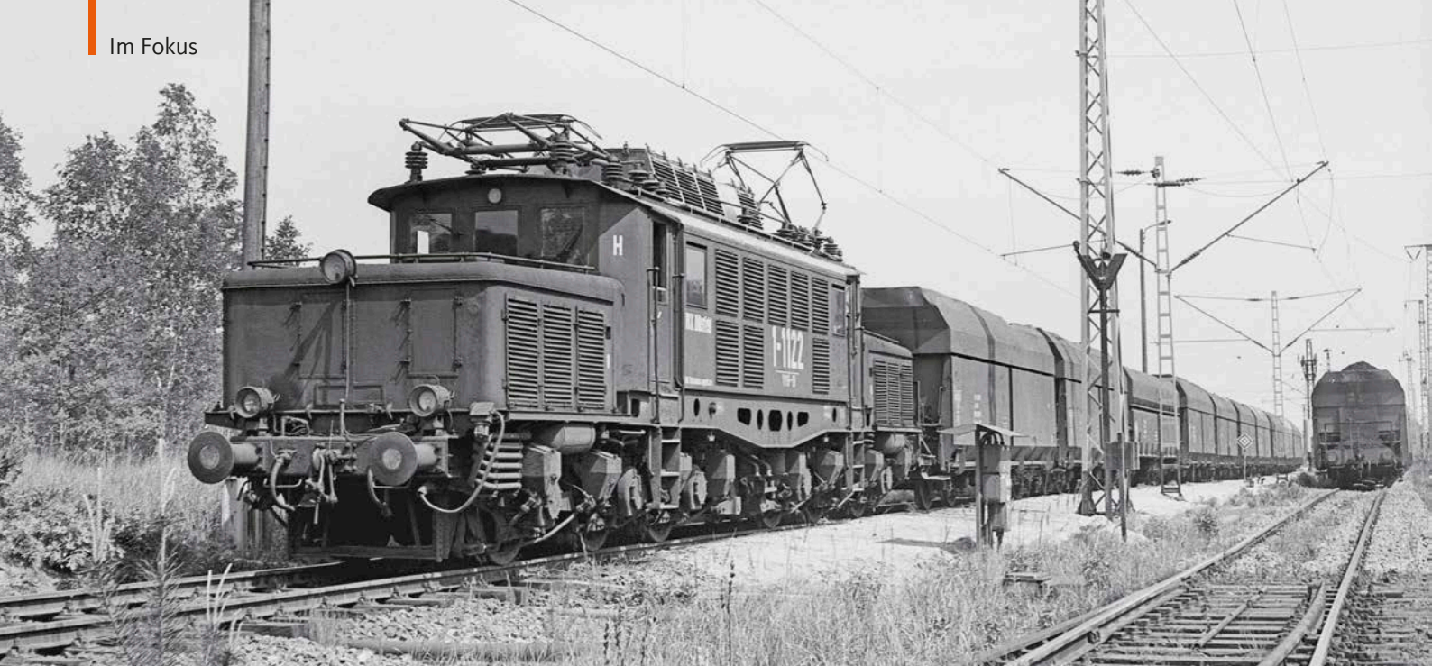
Die frühere E 94 058 stand seit 1979 im Dienst des Braunkohlenkombinats Bitterfeld und transportierte Züge zum Kraftwerk Muldenstein Slg. Michael U. Kratzsch-Leichsenring
