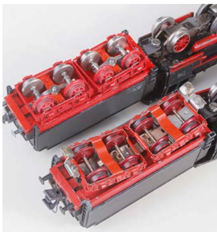
In den ersten Jahren waren am Tender Kunststoffräder mit je einem federnden Außenstromabnehmer pro Drehgestell verbaut (vorn), danach gab es Metallräder
