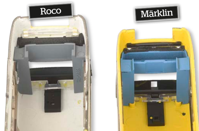
Die eingefärbten Führerstände sind von innen in das Kunststoffgehäuse eingesetzt MM (4)
