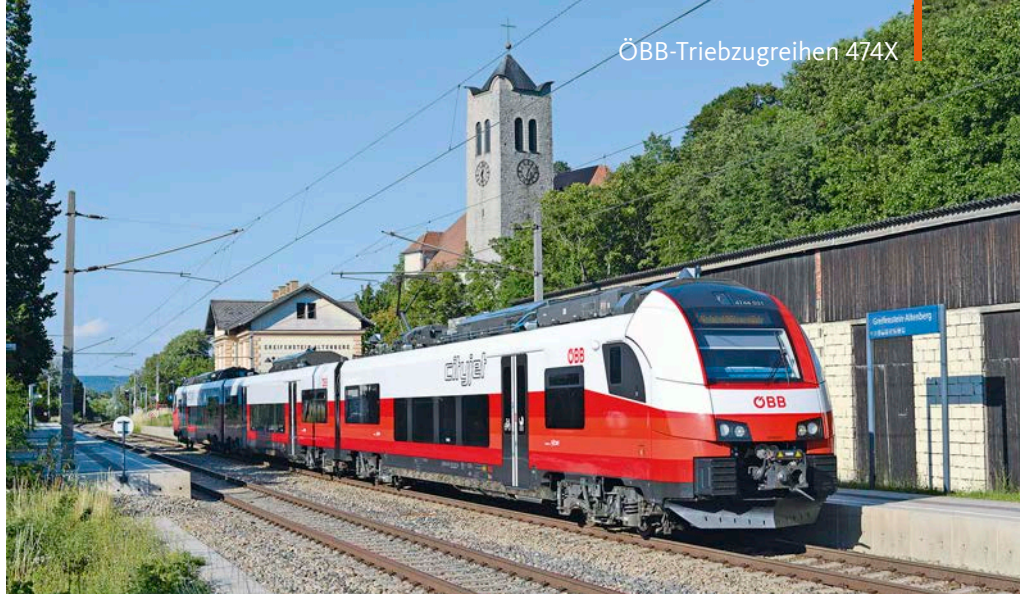
Die Reihe 4744 verfügt an den Triebköpfen nur über eine Seitentür wie hier am 4744 021 als S-Bahn-Garnitur 21050 am 26. Juni 2017 in Greifenstein Markus Inderst (3)
