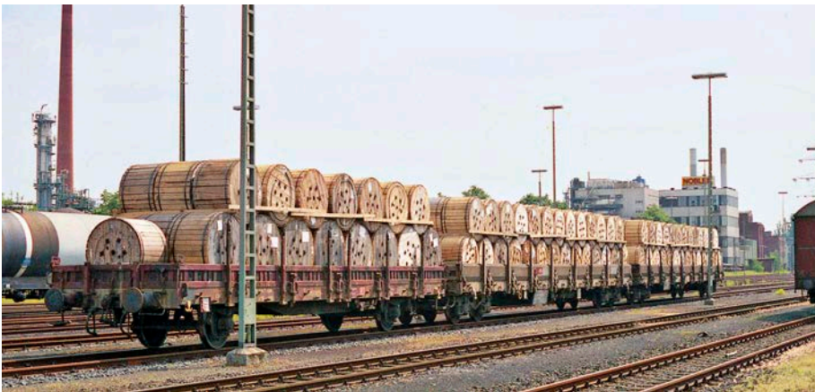
Ladeeinheit aus einer Kabeltrommel, die nicht schmaler als die Hälfte des Durchmessers ist (links), sowie mehrere schmale, zusammengebundene Kabeltrommeln (Mitte) auf durch Führungshölzer gesicherten Schlitten. Die schmaler als die Hälfte ihres Durchmessers ausgeführte Kabeltrommel ist zusätzlich durch Streben gegen Umkippen gesichert (rechts)
