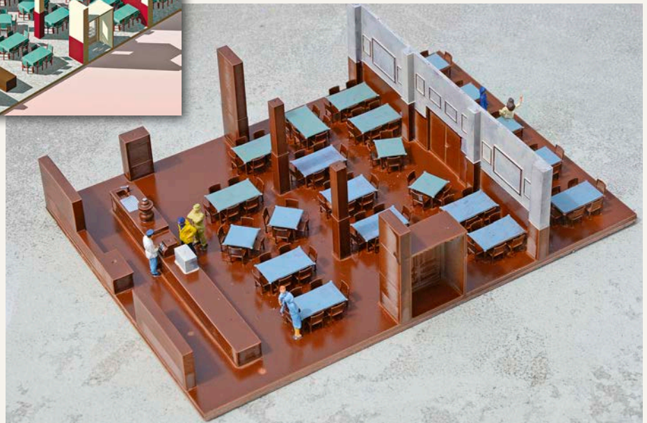
Nach der farbigen Konstruktionszeichnung wurde das Modell der Inneneinrichtungen gedruckt und bereits lackiert
