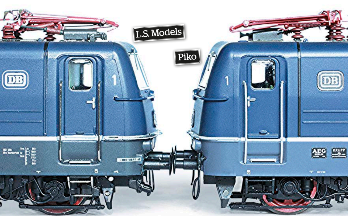
Die Aufstiegsleitern sind am LSM-Modell vorbildgerecht am Aufbau befestigt. Piko hat die praxistaugliche Variante mit am Drehgestell montierten Leitern gewählt Wolfgang Bdinka (3)
