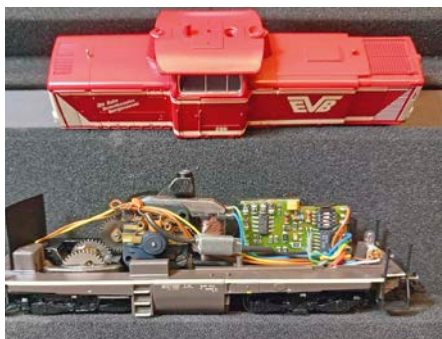
102 Neuer Antrieb und Decoder für Märklins H0-V 100 Soenke Janssen
