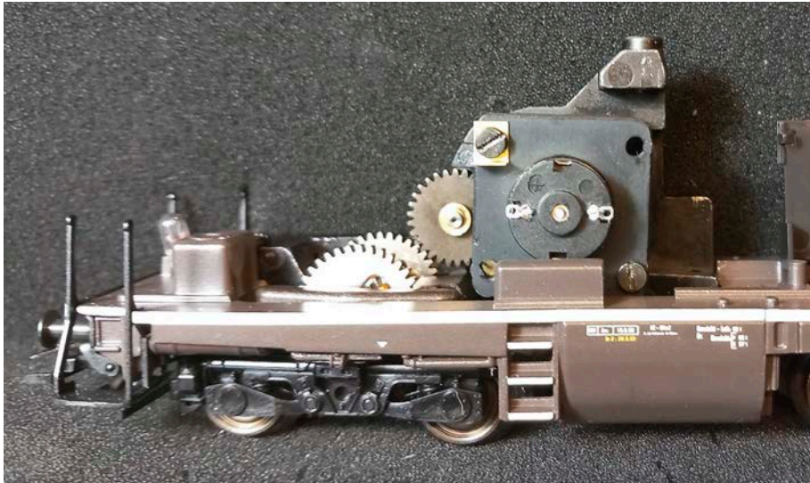
Der sb-Nachrüstantrieb mit seinem im 3D-Druck gefertigten Gehäuse ist mittels der originalen Märklin-Schrauben montiert. Das Getriebe lässt sich leicht drehen
