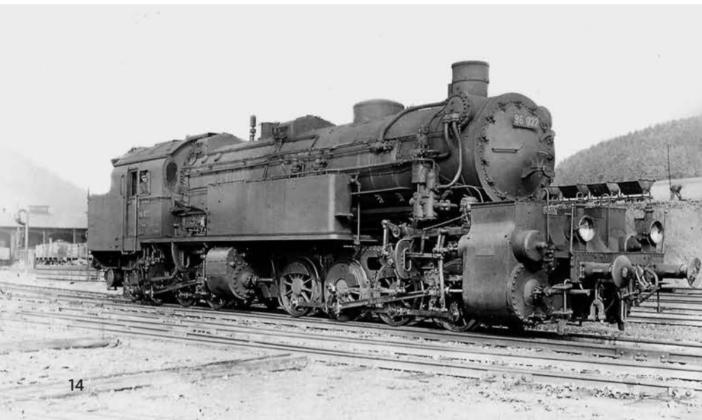
Im Bahnbetriebswerk Rothenkirchen zeigt sich 96 022 als Vertreterin des zweiten Maffei-Bauloses – erkennbar an Vorwärmer, separatem Dampfdom vor dem nach hinten gerückten Sandkasten und an der Doppelluftpumpe Carl Bellingrodt/Slg. TechnikMedia
