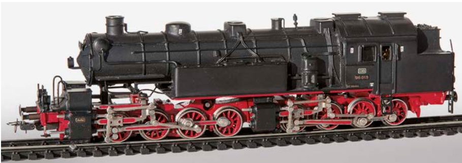
Die Modellbau-Werkstatt Schnabel aus Wiesau/Oberpfalz stellte die Gt 2 x 4/4 in diversen Qualitätsstufen ab 1960 auf Basis von zwei umgearbeiteten Fahrwerken der Märklin-Baureihe 81 her. Nur das hintere Fahrgestell ist dabei angetrieben Manfred Scheihing (2)
