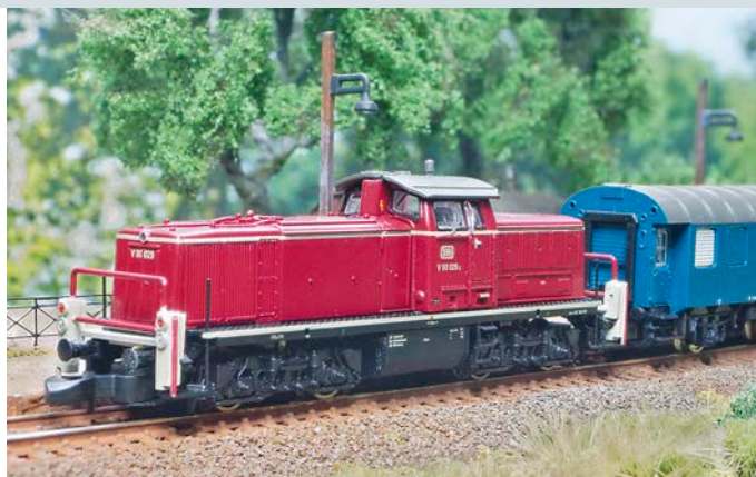
Märklin Z: An der Bühne sind die Blenden mit den eingebauten Leuchtdioden gut zu erkennen. Der Aufbau bietet viele Details und einen freien Blick durchs Führerhaus Trainini
