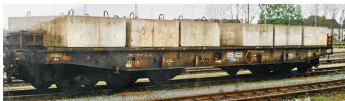
Derzeit in Nürnberg eingesetzter Bergbremswagen, der von Modellbahnern einfach nachzubauen ist Slg. Axel Polnik
