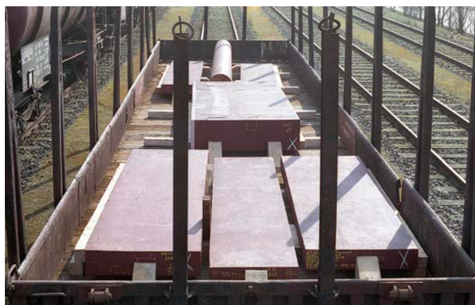
Werkzeugstahl in verschiedenen Größen und Formen auf einem zweiachsigen DB-Runnenwagen der Gattung Kbs mit einer Lastgrenze von etwa 25 Tonnen
