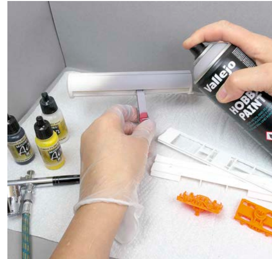
Die gedruckten Teile werden vor dem Lackieren grundiert. Nach dem Trocknen erfolgt für jede Baugruppe die endgültige Farbgebung mittels Airbrush Maik Möritz (3)
