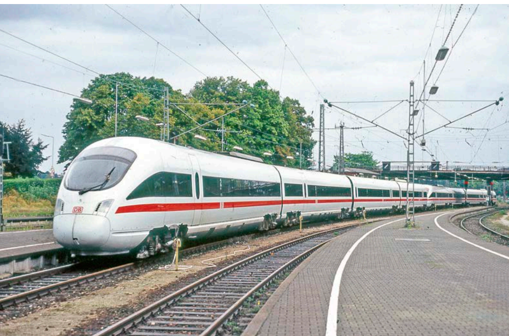
40 Jahre nach den VT 11 s beschaffte Deutschland nochmals fahrdrachtunabhängige Ferntriebzüge als ICE TD der Baureihe 605 – und zwar dieselelektrisch mit elektromechanischer Neigefunktion und eingesetzt zwischen München und Zürich sowie Nürnberg und Dresden – hier am 8. August 2002 in Lindau
