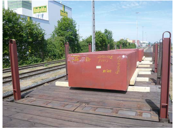
Drei Blöcke, von denen fast jeder 25 Tonnen wiegt, verladen auf einem sechssachsigen Drehgestell-Flachwagen der Gattung Samms; das Ladegut ist mit aufgenagelten Unterleg- und seitlichen Führungshölzern gesichert
