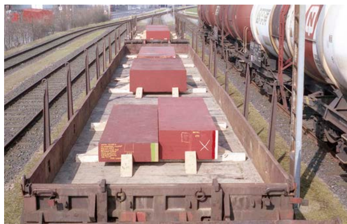
Vier verschieden große Werkzeugstahl-Blöcke auf einem Drehgestell-Flachwagen der Gattung Res mit Borden und einer Tragfähigkeit von etwa 55 Tonnen
