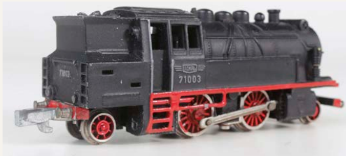
Tenderseitig erkennt man, wie sich die Rokal-Konstrukteure bemühten, das Fahrwerk der Schlepp-tenderlok B 1001 bzw. B 1003 für die 71er zu adaptieren
