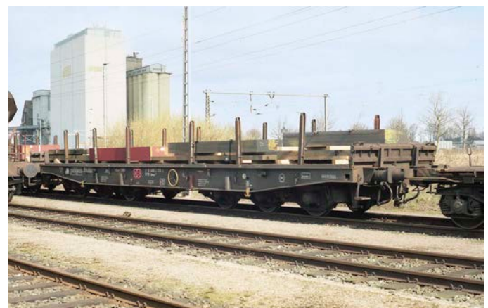
Auf sechssachsigen Drehgestell-Flachwagen der Gattung Samms sind ein einzelner schwerer Block Werkzeugstahl (links) und mehrere Stahlblöcke mit und ohne Farbanstrich als Korrosionsschutz verladen (rechts). Gut erkennbar sind auch die zur Ladungssicherung aufgenagelten Keile, den den großen Block gegen Verrutschen sichern sollen Benno Wiesmüller (8)
