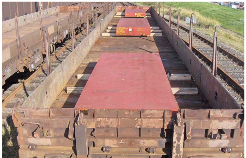
Drehgestell-Flachwagen der Gattung Res mit Seitenwänden, beladen mit drei ähnlich großen und jeweils über zehn Tonnen schweren Stahlblöcken
