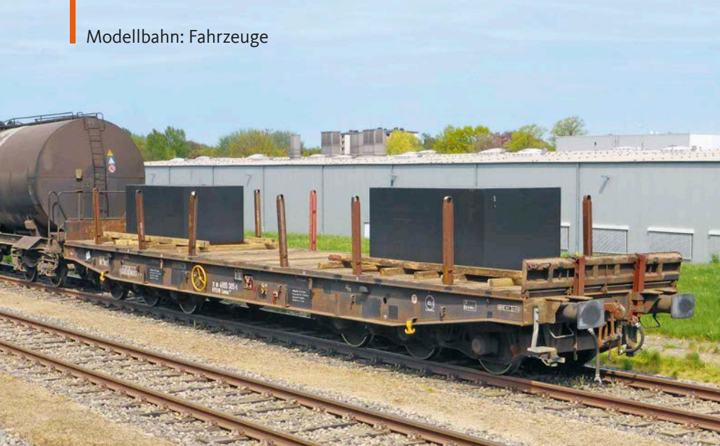
Zwei schwarze Stahlblöcke auf einem sechssachsigen Flachwagen Samms im Hamburger Hafen, die man leicht im Modell nachbilden kann Benno Wiesmüller (3)
