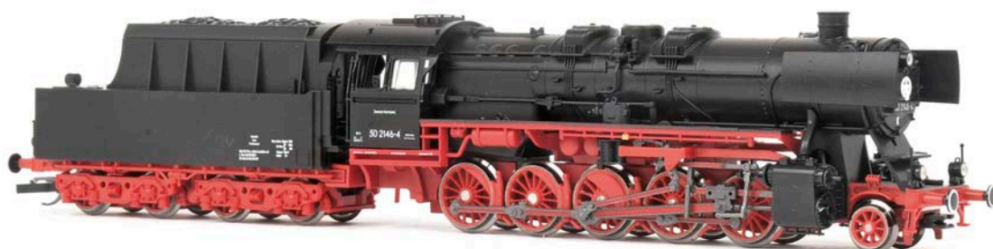
Tillig TT: insbesondere an der Front und am Führerhaus formgeänderte 50 2146 der DR MM (6)
