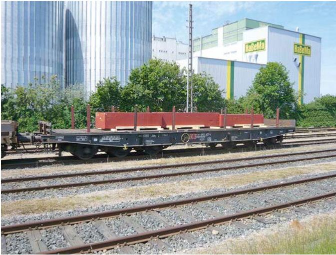
Drei Blöcke, von denen fast jeder 25 Tonnen wiegt, verladen auf einem sechssachsigen Drehgestell-Flachwagen der Gattung Samms; das Ladegut ist mit aufgenagelten Unterleg- und seitlichen Führungshölzern gesichert
