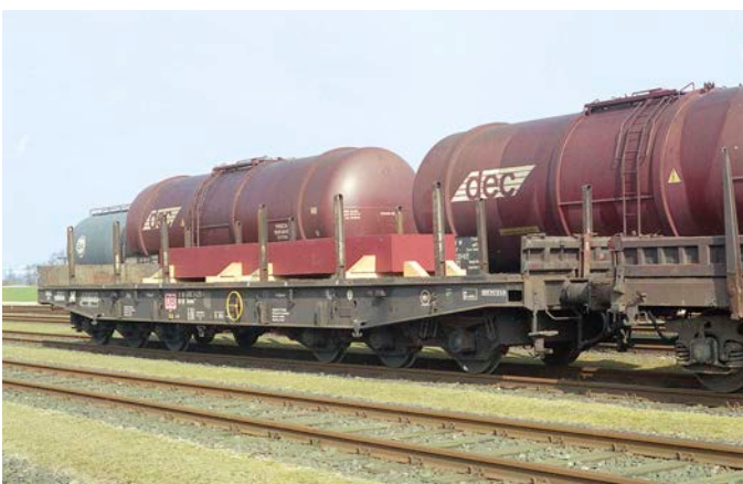
Auf sechssachsigen Drehgestell-Flachwagen der Gattung Samms sind ein einzelner schwerer Block Werkzeugstahl (links) und mehrere Stahlblöcke mit und ohne Farbanstrich als Korrosionsschutz verladen (rechts). Gut erkennbar sind auch die zur Ladungssicherung aufgenagelten Keile, den den großen Block gegen Verrutschen sichern sollen Benno Wiesmüller (8)
