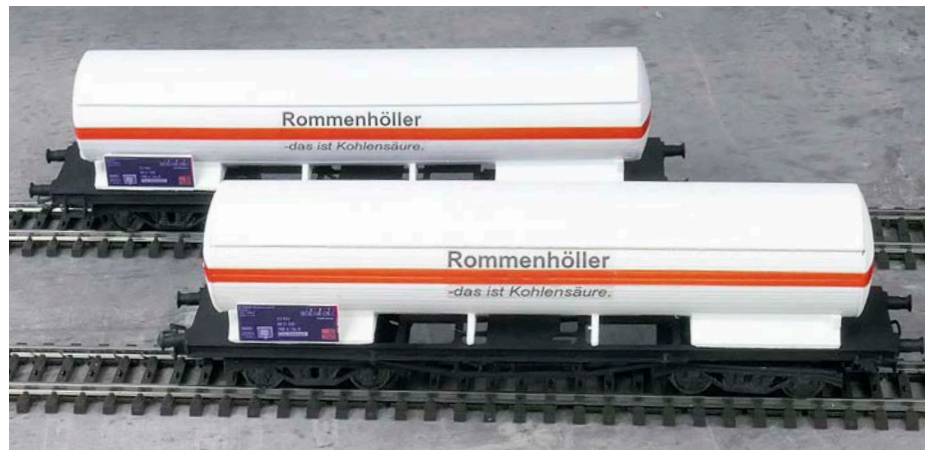
Die fertig beschrifteten Kesselwagen machen eine gute Figur. Drehgestelle aus PETG-Filament und Metallradsätze sorgen dafür, dass sie tauglich für den Zugsinsatz sind
