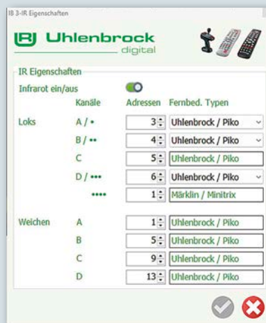
Auch ein Infrarot-Empfänger ist wieder eingebaut. Mit diesem können neben den IRIS-Fernbedienungen nun auch die ProfiControl-Sticks aus den Märklin/Trix-Startpackungen genutzt werden Heiko Herholz (7)
