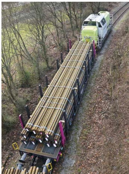
Auf dem Runtenwagen sind die einzelnen Rohrbündel jeweils mit mehreren Gurten gesichert sowie die gesamte Ladung am Wagon verzurrt
