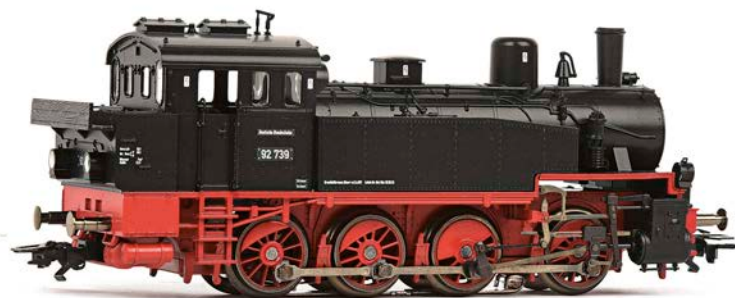
Märklin/Trix HO: Alle vier Radsätze der 92 739 sind angetrieben
