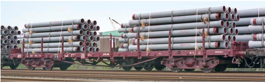
Wechelseitig verladene Rohre mit Flansch auf einem Rs-Wagen der CFL. Die doppelte gebundenen Rohre sind schichtweise verladen und durch Spanngurte gesichert
