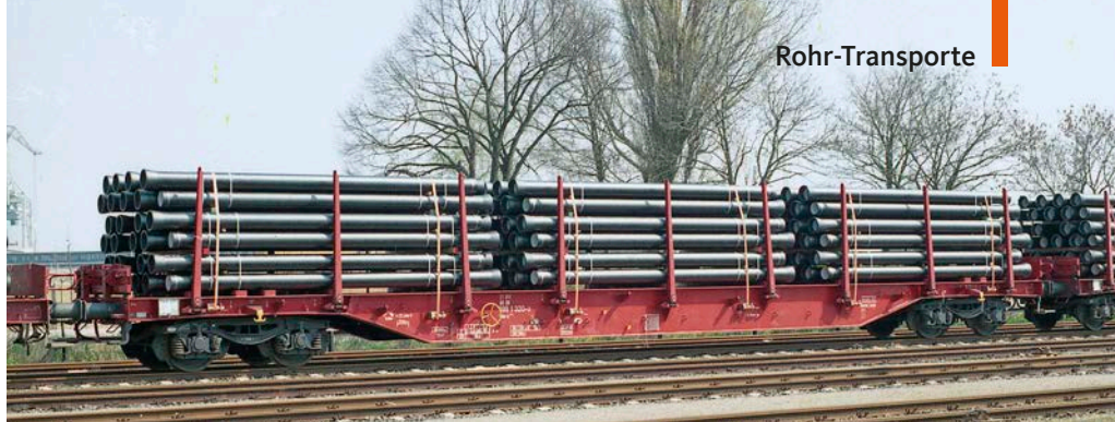
Doppellagig geschichtet und gebundene Rohre in mehreren Lagen verladen und durch am Wagen vorhandene Niederbindungseinrichtung gesichert
