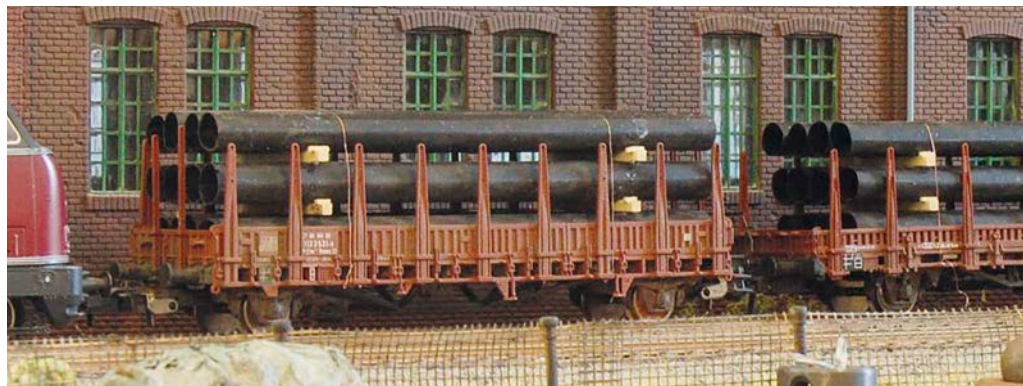
Auf dem Rmms 33 (links) bzw. dem Ks 56 (rechts) von Piko sind zwölf Rohre vorbildgerecht verladen und durch Keile und zwei Abspanndrähte aus Metall gesichert
