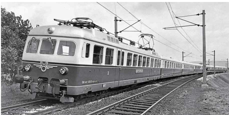
Zwei „Transalpin“-4130-Garnituren auf der Westbahn in Österreich 1958; auf der gesenkten vorderen Stromabnehmerschere mit normalen ÖBB-Maßen ist die schmale SBB-Wippe mit 1.320 Millimetern Breite und Aluschleifstücken aufgesetzt SGP-Wagner/Slg. Dr. Helmut Petrovitsch
