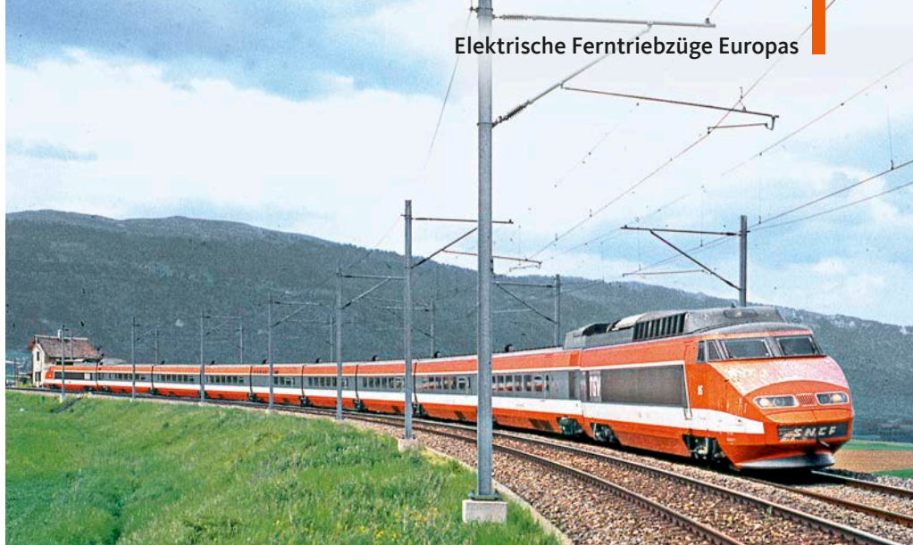
Seit mehr als vierzig Jahren schon fahren mehrsystemige TGV unter 16 2/3 Hertz zu Zielbahnhöfen in der Schweiz. Im Bild der TGV 115 bei Arnex 1984 auf dem Weg nach Lausanne
