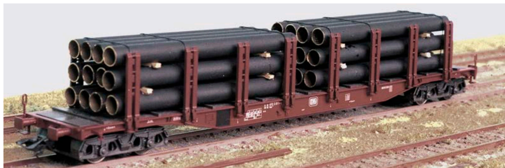
An den Rungen anliegende, geschichtet verladene Messingrohre mit sieben Millimetern Durchmesser auf einem Snps-Wagen in H0 von Märklin
