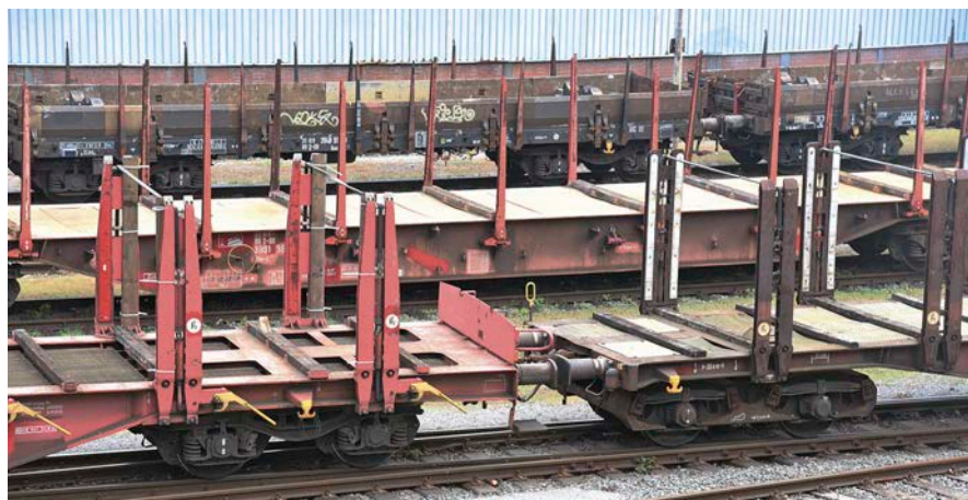
Auf den leeren Wagen erkennt man gut die Holzbohlen als Unterlage (oben), die teilweise noch die aufgenagelten Keile haben (unten). Für regelmäßige Transporte werden auch verstellbare Ladungssicherungen aus Metall genutzt (ganz oben)
