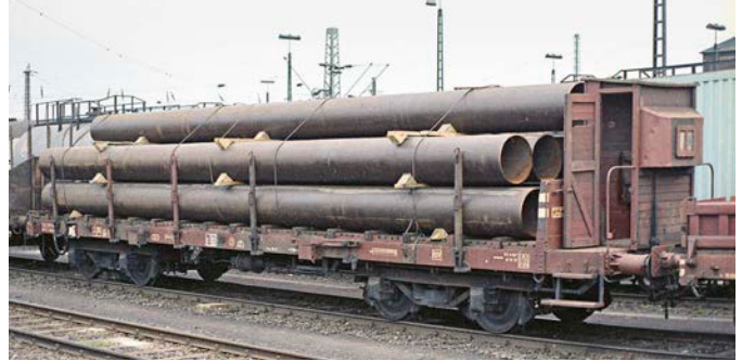
Durch Spanndrähte und Zwischenlagen gesicherte und geschichtet verladene Rohre 1973 auf einem Flachwagen der FS Italiens
