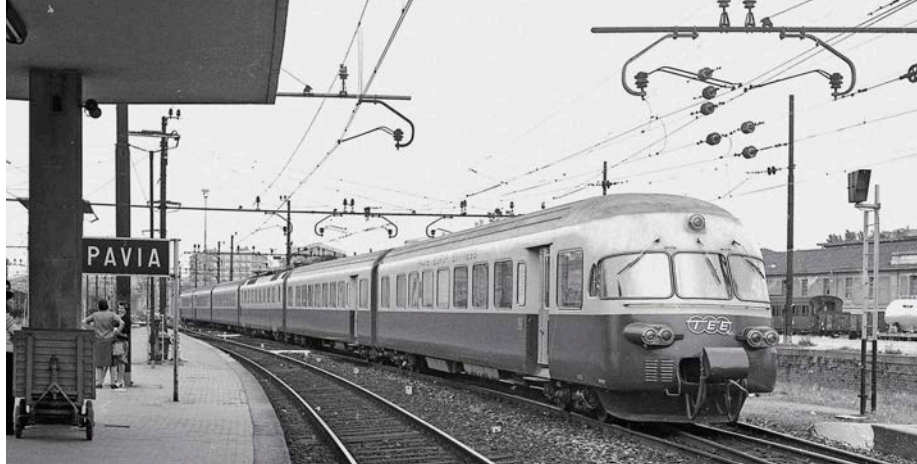
Viersystem-TEE „Gottardo“ unterwegs im Juli 1976 unter 3-Kilovolt-Fahrleitung von Mailand nach Genua während der Durchfahrt in Pavia. Der SBB-RAe hatte an beiden Garniturenden Steuerwagen, der Maschinenwagen ist hier an dritter Stelle eingereiht
