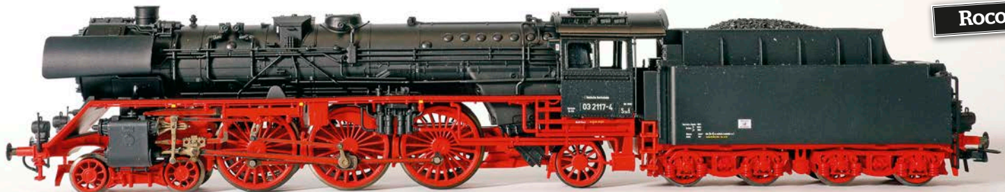
Seitenansicht der von Roco 2020 überarbeiteten Maschine von Fleischmann mit Rekokessel und Mischvorwärmer
