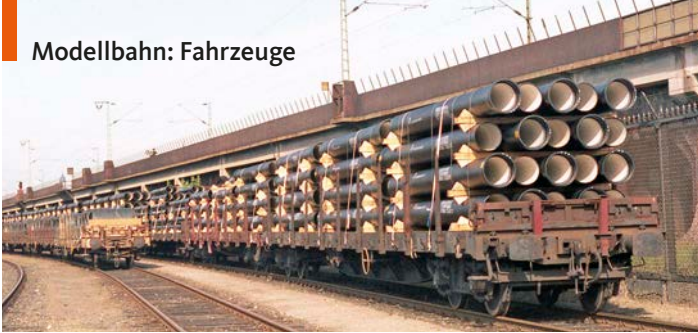
Wagengruppen mit Rohren, die mit Zwischenlagen samt Keilen aus Holz geschichtet verladen sind
