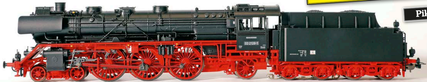
Seitenansicht der neu konstruierten Piko-Maschine mit Altbaukessel und Mischvorwärmer. Besonders gefällt der filigrane Rahmen
