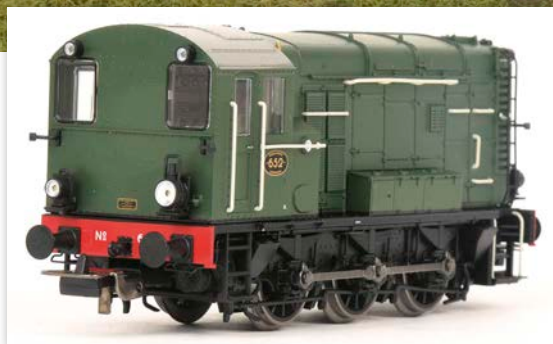
Piko H0: An der Front- und Rückseite sind die Lampen des weißen Spitzensignals unten, die roten Schlusslichter oben angebracht
