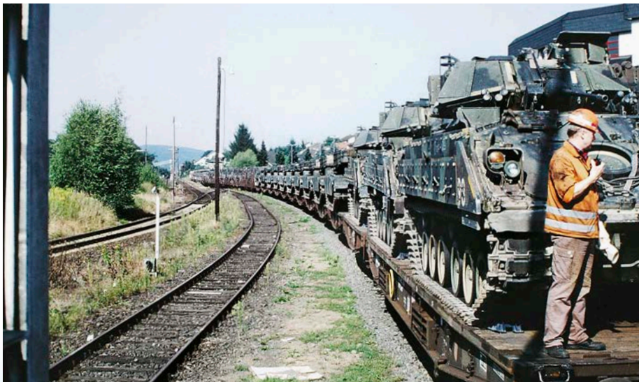
Der Wagenmeister überwachte die Verladung, prüfte Lademaße auf Überbreiten und sicherte die Fahrzeuge auf den Flachwagen
