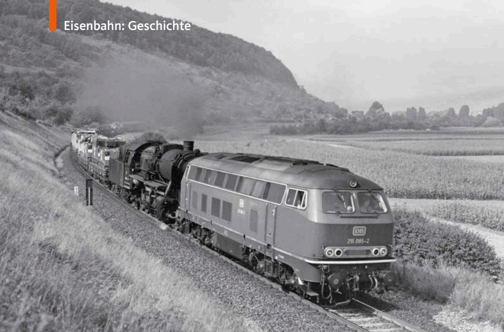
Panzerzug im Taubertal bei Edelfingen, 215 085 leistet der 50 Vorspann. Wegen des beschränkten Lichtraumprofils im ehemaligen Schwarzkopftunnel im Spessart sind die Panzerzüge in Richtung Grafenwöhr oft ab Aschaffenburg über Miltenberg, Wertheim, Lauda, Crailsheim weiter nach Nürnberg gefahren
