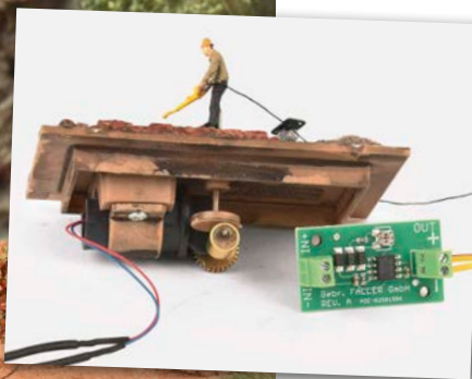
Faller HO: Unter der gestalteten Bodenplatte ist der Antrieb montiert
