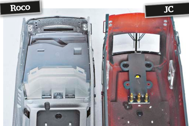
Roco und JC haben mit Lichtleiter (links) und selbst entwickelter LED-Platine (rechts) unterschiedliche Beleuchtungslösungen
