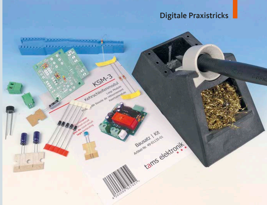
Das Kehrschleifenmodul KSM-3 wird von Tams auch als preiswerter Elektronikbausatz angeboten. Wer Spaß am Basteln hat, die Arbeit nicht scheut und eine gute Lötstation besitzt, kann hier einige Euros sparen
