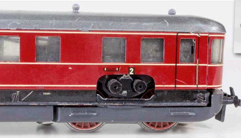
Triebgestellseite des Trix-VT 50 mit den seitlich sichtbaren Motor-Kohlestiften sowie die Drahtersicht auf die zahlreichen Schleiferbleche
