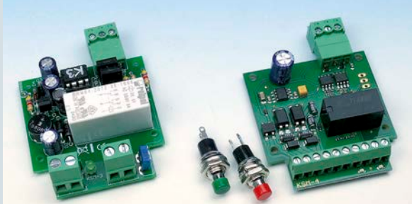
Die Tams-Fertigbausteine der Kehrschleifenmodule KSM-3 und KSM-4 werden komplett geliefert und sind vom Hersteller vollständig auf Funktion geprüft
