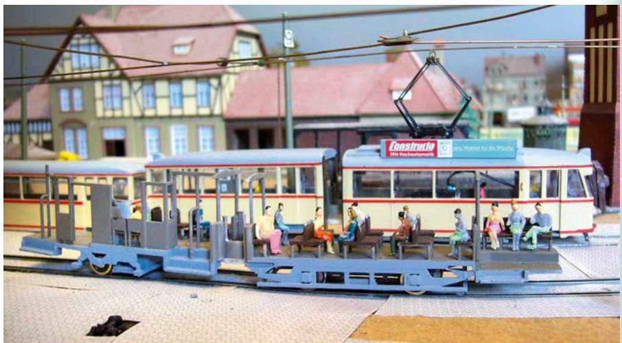
Erhältlich ist auch eine Fahrzeuginnenraumversion mit kompletter Bestuhlung, die zwar keinen Platz für einen Antrieb bietet, aber das Einsetzen von Fahrgastfiguren ermöglicht
