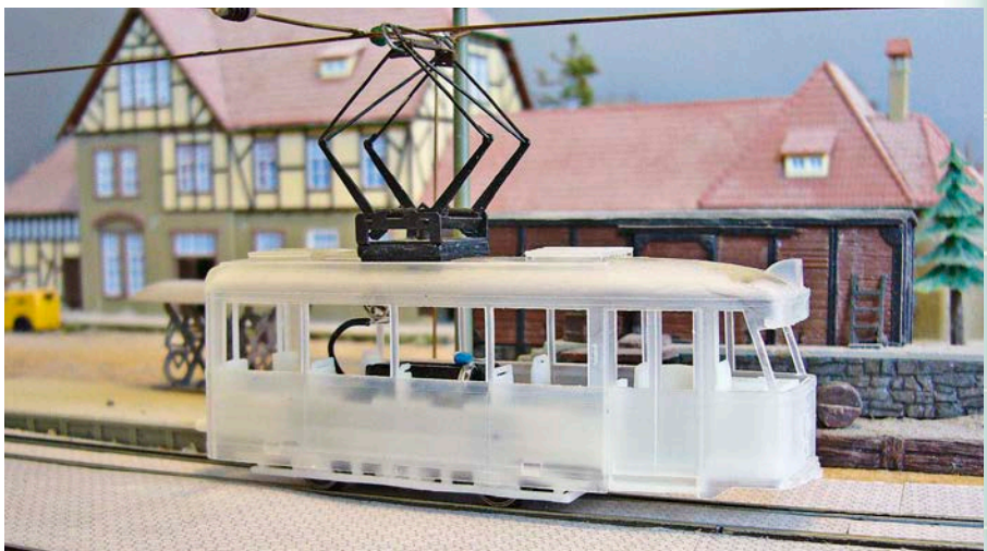
Fertiger Rohbau des mit Antrieb versehenen Vorderteils des Trambahnzuges mit aufgesetztem Sommerfeldt-Pantograf; der Motor ermöglicht innen nur eine Teilbestuhlung
