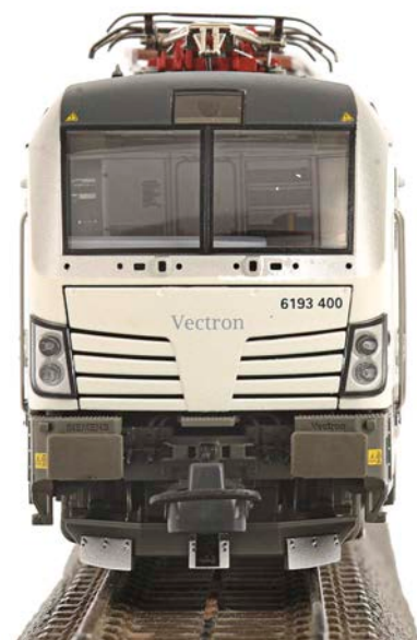
Roco H0: Formvariante des Siemens-Vectron 193 400 mit neu gestalteten Pufferträgern und Schienenräumern
