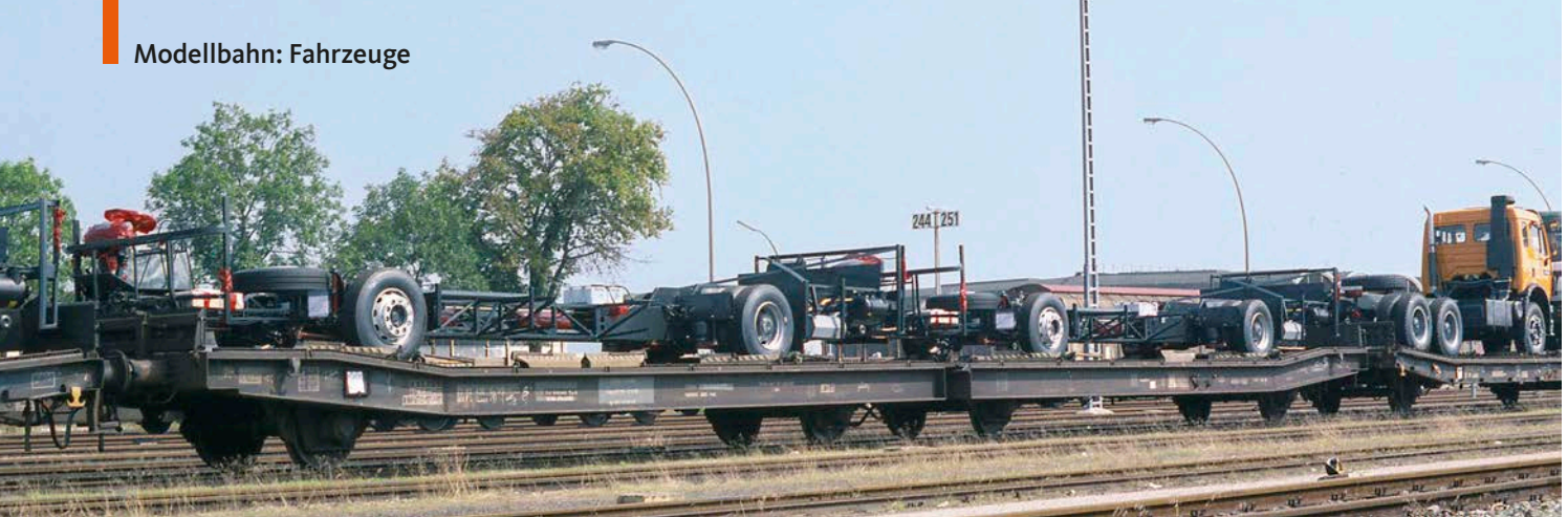
Untergestelle von Autobussen nach Übersee, hier im Hamburger Hafen, lassen sich auch für den Modellbahnbetrieb nachbilden. Abweichend vom Vorbildfoto (oben) wurde ein einzelnes Fahrgestell auf einen Kls von Roco gesetzt (unten)
