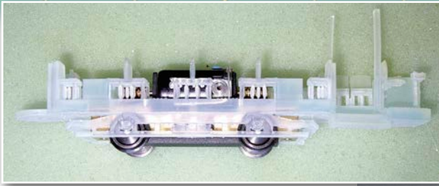
Basis des Straßenbahntriebwagens bilden die 3-D-Druckteile des Anbieters i-materialise und ein pmt-Fahrwerk Helmut Gieramm (5)
