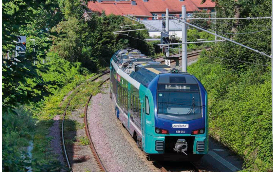
In Kiel hat DB InfraGO die Oberleitung vom Hauptbahnhof bis zum Bahnhof Kiel Hassee CITTI-Park verlängert. Vermutlich wegen wiederholter Störungen fahren die FLIRT Akku hier derzeit sicherheitshalber mit gesenktem Stromabnehmer
