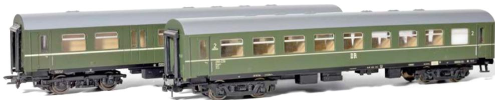
*HO-Vergleich eines Tillig-Epoche-III-Wagens von 2010 mit korrekten Schwanenhals-Drehgestellen (rechts) mit einem BDghws-Modell auf Görlitz-V-Drehgestellen (links)*
