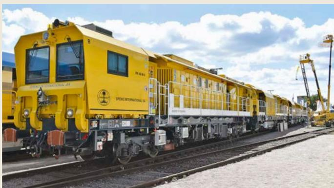
**Dieser Speno-Schienenschleifzug kann nicht nur schleifen: umfangreiche Messeinrichtungen erfassen den Schienen- und Gleiszustand vor und nach der Schleiftätigkeit**
