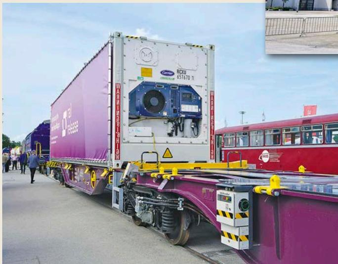
ropa, zeigte in München eine Lösung zur Verladung von Trailern mit Reachstackern, die bislang nur Container von Tragwagen bewegen konnten. Möglich macht es ein Korbsystem, auf das der Trailer gezogen wird und das der Reachstacker anheben kann. Der slowakische Hersteller nutzte die Freifläche der Messe München, um den Prozess zu demonstrieren – und lieferte damit eine der wenigen Live-Präsentationen auf der transport logistic.
