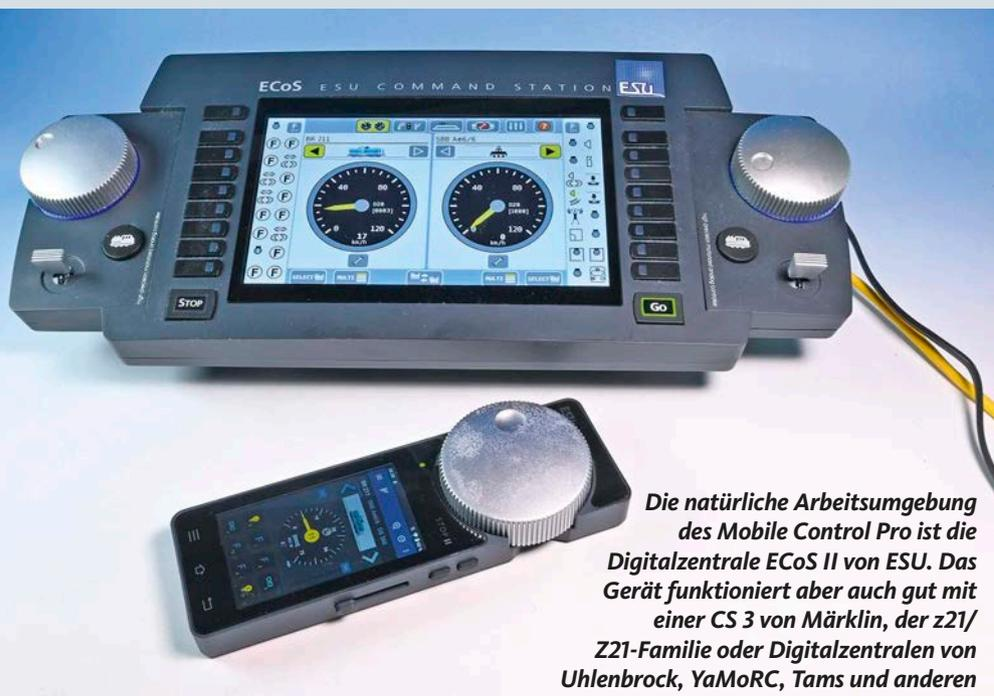
**Die natürliche Arbeitsumgebung des Mobile Control Pro ist die Digitalzentrale ECoS II von ESU. Das Gerät funktioniert aber auch gut mit einer CS 3 von Märklin, der z21/Z21-Familie oder Digitalzentralen von Uhlenbrock, YaMoRC, Tams und anderen**
