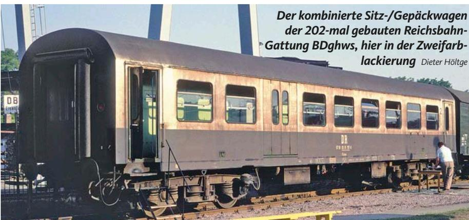
das Untergestell überholt. Der Innenausbau des Prototypen erfolgte im Raw Potsdam. Dort wurden die vom „Langen Halberstädter“ bekannten Übersatzfenster verwendet. Außerdem stammten die WC-Einrichtung, die Schaltgerüste, die Türschließ- und Blockiereinrichtung sowie die Innenverkleidung von den Bmh-Wagen. Dadurch konnten etwa sieben Tonnen Stahl und 1,4 Kubikmeter Holz im Vergleich zu einem Neubaufahrzeug eingespart werden.
