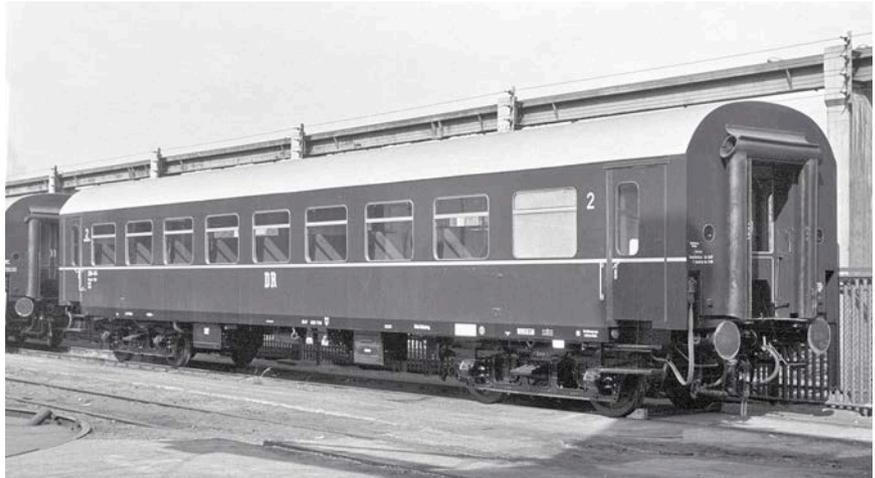
**Vergleich zweier Bghw-Versionen mit Regeldrehgestellen (o.) sowie als zweites Baumuster mit der Drehgestell-Bauart Görlitz V und Übersatzfenstern (u.)** Werk/Slg. Dirk Endisch (2)
