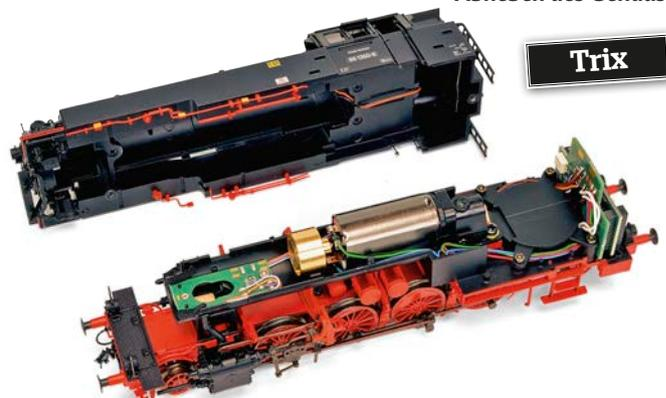
Zum Öffnen der Trix-Maschine genügen das Lösen zweier Schrauben und das vorsichtige Abheben des Gehäuses
