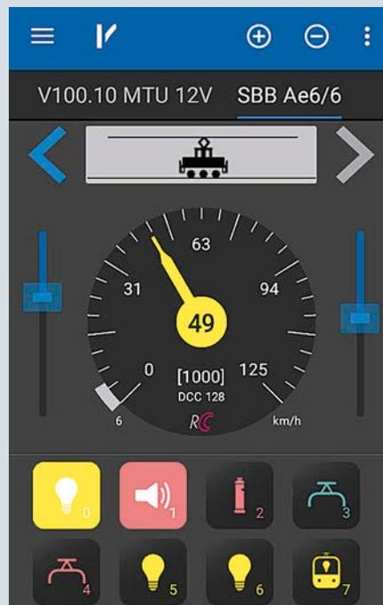
Der MCPPro unterstützt auch die per RailCom mittels ECoS zurückgemeldete Ist-Geschwindigkeit der Modellfahrzeuge
