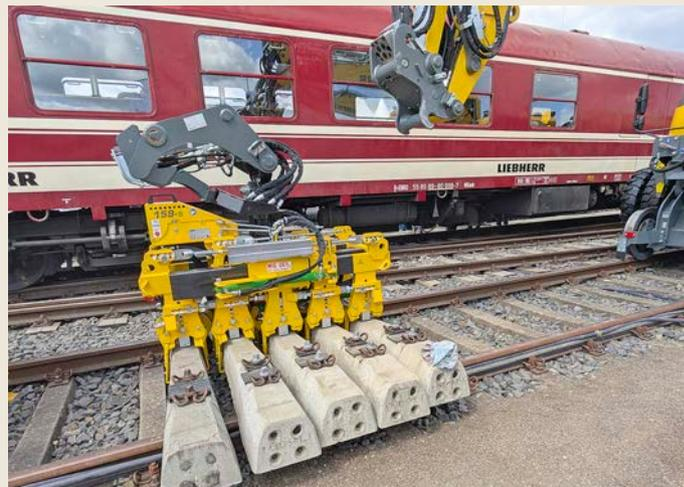
**Mit Adapter für Zweibege-Bagger können auch kleine Baustellen möglichst effektiv bedient werden. Hier ein Adapter für den gleichzeitigen Ein- oder Ausbau von fünf Betonschwellen** Heiko Herholz
