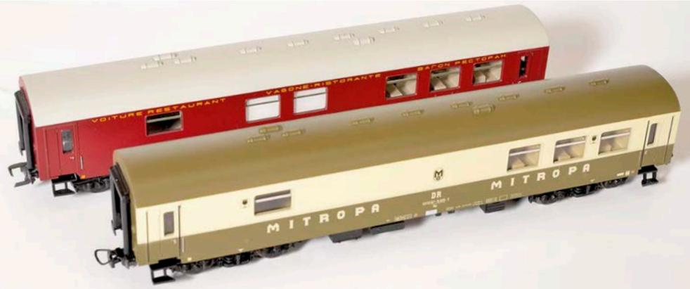
Schwanenhals-Drehgestelle besaßen. Deren Achsstand erlaubte es, bei den Modellen die Einstiegstritte fest mit dem Wagenkasten zu verbinden, ohne dass es zu Störungen auf dem Piko-Standardgleisradius von 380 Millimetern kam.
