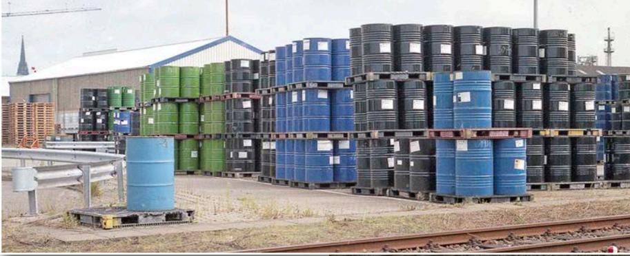
**Auf speziellen Paletten zu je vier Stück gebündelt zusammengefasste Fässer aus Metall auf einem Lagerplatz im Hamburger Hafen (oben) sowie verladen auf einem Drehgestellflachwagen der Gattung Res (rechts)** Benno Wiesmüller (6)
