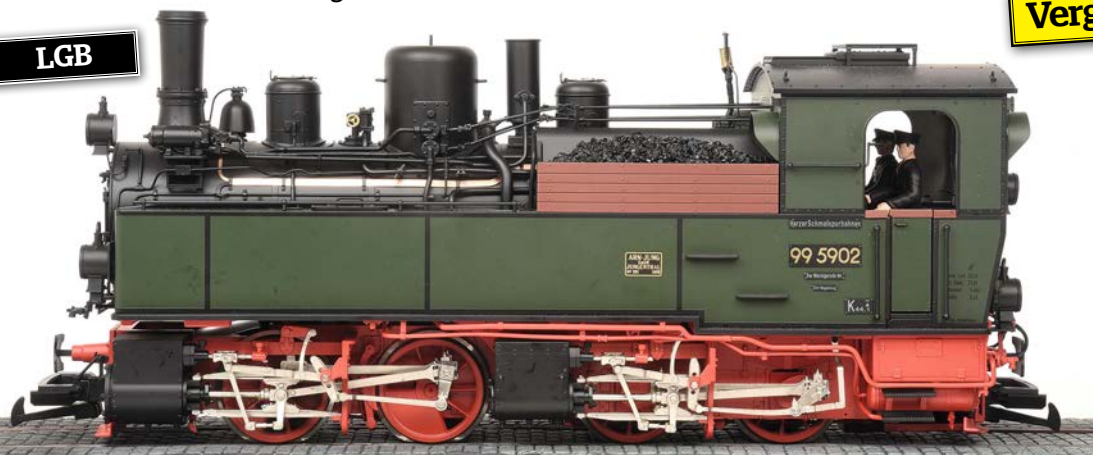
Auf der Heizerseite fällt der Kohlenkasten mit Bretternachbildung besonders ins Auge. An der LGB-Lok (oben) sind zu Demonstrationszwecken die Haken der Digitalkupplung abgesenkt
