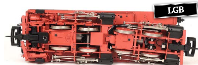
Um enge Radien durchfahren zu können, sind am TrainLine-Modell jeweils zwei Radsätze in einem Drehgestell gelagert. Die LGB-Lösung (oben) ist vorbildgerechter, da beide hinteren Radsätze im Außenrahmen nur leicht beweglich angeordnet sind
