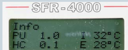
Der neue Handregler zeigt sogar die Temperaturen der Komponenten an, was dem Bediener Gefahren signalisiert
