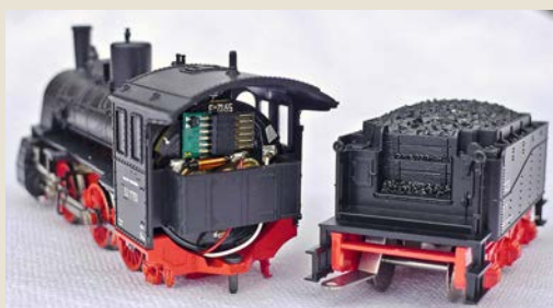
Fleischmann-HO-Lok 53 7751 der DB mit dem Originalmotor und einem Ritzel-/Kronen-/Stirnrad-Getriebe als selten bei Modellbahnloks angewandte Kraftübertragung zu den Radsätzen Michael Jaschke (2)
