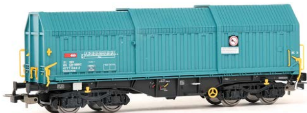
Piko H0: Die vierachsigen Teleskophaubenwagen der SBB sind mit Y-Drehgestellen ausgestattet
