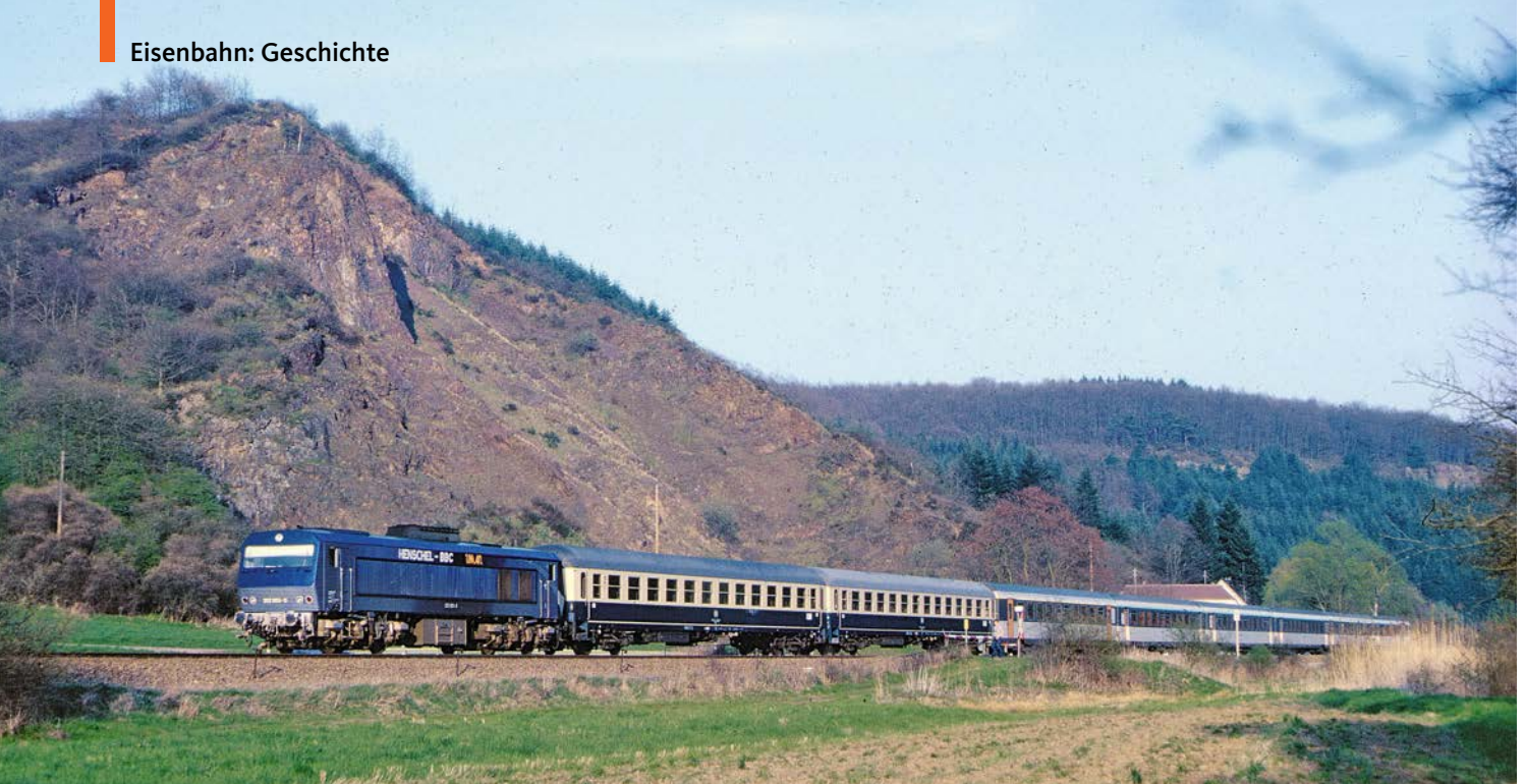
Auch eine dieselelektrische Versuchslokomotive vom Typ DE 2500 von Henschel-BBC versieht in den 80er-Jahren Schnellzugdienste in der Pfalz. Am 19. April 1985 hat 202 003 den D 255 am Haken (Aufnahme bei Schleißweiler)
