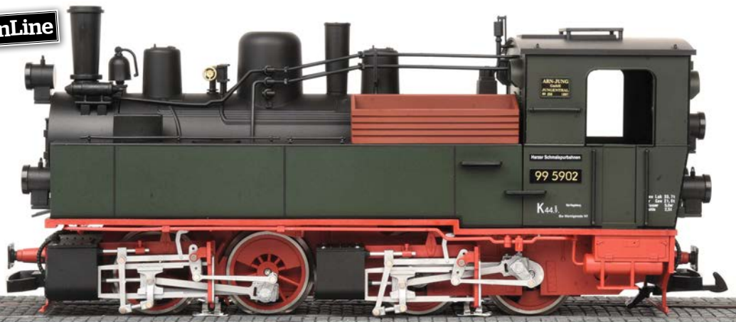
Auf der Heizerseite fällt der Kohlenkasten mit Bretternachbildung besonders ins Auge. An der LGB-Lok (oben) sind zu Demonstrationszwecken die Haken der Digitalkupplung abgesenkt
