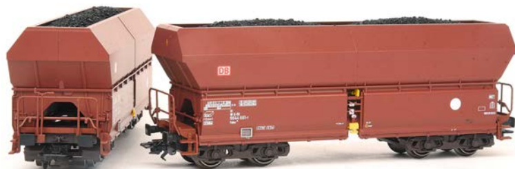
Märklin/Trix H0: formneuer Falns 182 der DB AG mit (links) und ohne Handbremse im Betriebszustand nach 2014 MM (8)
