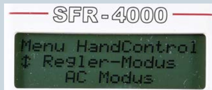
Der Drehregler kann sich wahlweise wie ein Wechsel- oder Gleichstromregler verhalten; intuitiver ist der AC-Modus
