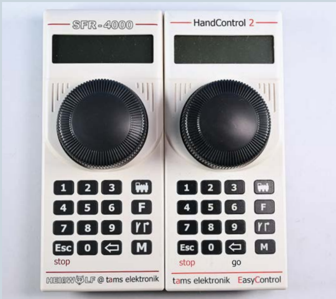
HandControl des Heißwolf-Analogsystems (links) und HandControl 2 des digitalen Tams-Systems im Vergleich, wobei beide Gehäuse von Lenz zugeliefert werden
