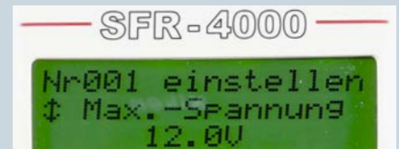
Die Maximalspannung ist einstellbar, wodurch sich das System auch für HOi-Feldbahnen oder die Nenngröße Z eignet
