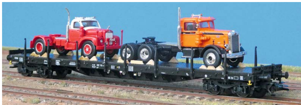
In Nenngroße H0 zusammengestelltes Ladegut aus zwei US-Trucks von Brekina, die die Ladefläche des verwendeten vierachsigen Märklin-Rungenwagens gut ausfüllen. Als Vorbildvorlage dienten die im Mai 1975 in Hamburg-Wilhelmsburg fotografierten kanadischen Gebraucht-Lkw für Persien, die auf einem belgischen Rs-Wagen verladen und mit Holzkeilen und Draht zuverlässig gesichert sind Benno Wiesmüller (6)
