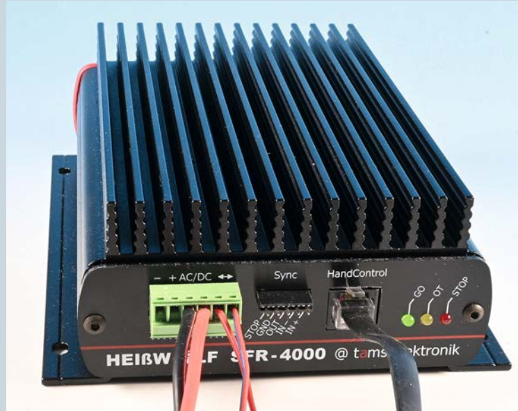
Die PowerUnit sitzt in einem massiven Gehäuse samt Kühlkörper und erwärmt sich nur geringfügig. Mal sehen, ob Tams später auch einen Booster in diesem schicken Gehäuse herausbringt
