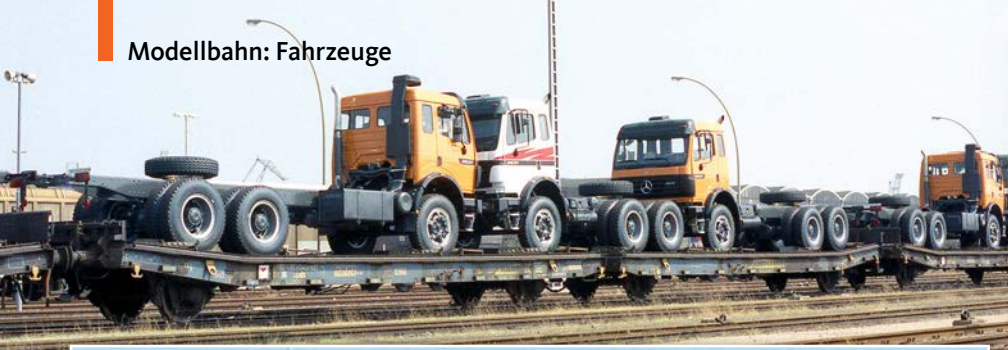
Lkw auf kurzgekuppelten Flachwageneinheiten mit abgesenkten Ladeflächen und zum Schienenfahrzeug gehörenden Radvorlegern, sodass keine zusätzlichen Sicherungen erforderlich sind. Die HO-Umsetzung für große Bogenradien erfolgte mit einer Marienberger Laas-Einheit und Herpa-Lastern Benno Wiesmüller (3)
