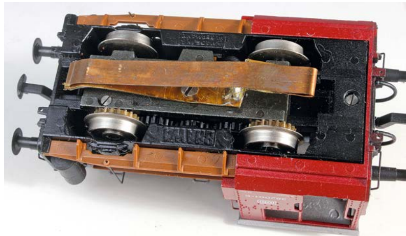
Die Kraftübertragung erfolgt beim Brawa-Modell mittels Zahnradern. Der hier montierte Mittelschleifer ist eine schlichte Eigenbaulösung
