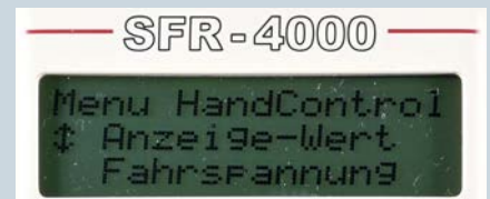
Wahlweise können eine interne Fahrstufe oder die Gleisspannung im Heißwolf-Handregler angezeigt werden Heiko Herholz (8)
