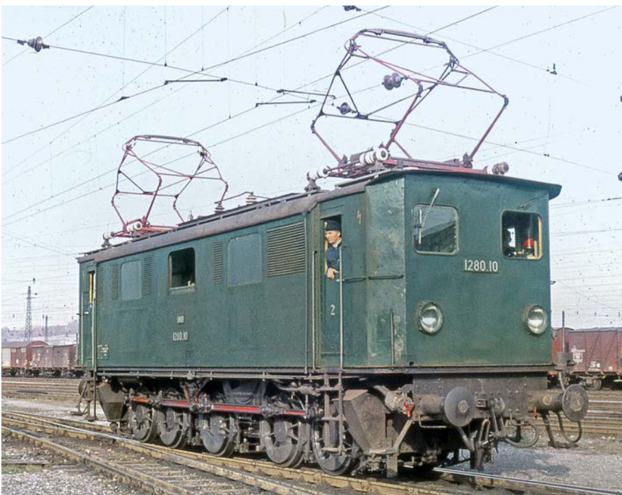
1280.10 im November 1962 in Salzburg Gnigl; gegenüber dem Ablieferungszustand – den das Bild links dokumentiert – ist der Stirnübergang entfallen und sind die Lufteintritte zwischen die Maschinenraumfenster nach oben versetzt worden Hermann Gessmann/Slg. Dr. Helmut Petrovitsch
