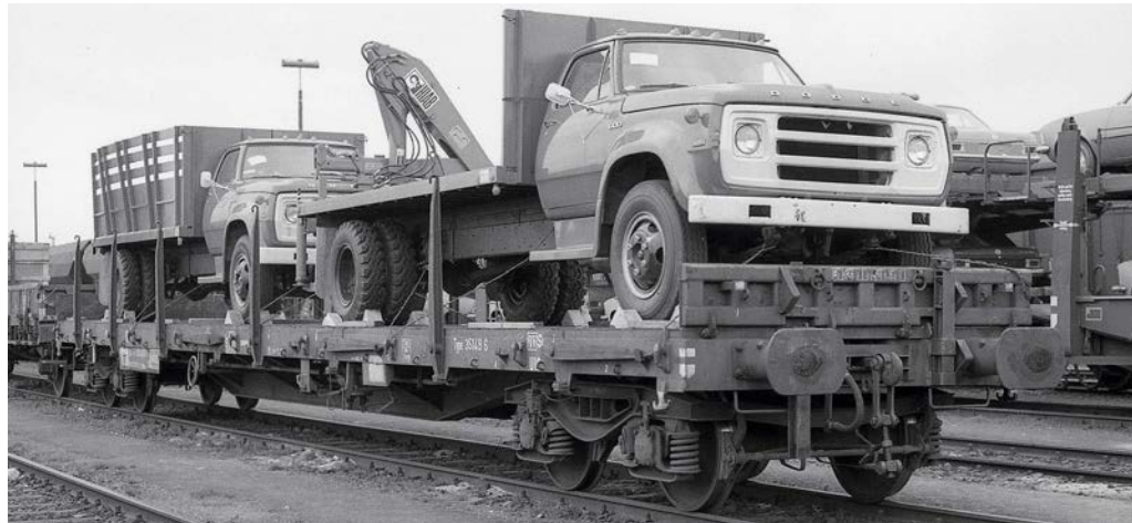
In Nenngroße H0 zusammengestelltes Ladegut aus zwei US-Trucks von Brekina, die die Ladefläche des verwendeten vierachsigen Märklin-Rungenwagens gut ausfüllen. Als Vorbildvorlage dienten die im Mai 1975 in Hamburg-Wilhelmsburg fotografierten kanadischen Gebraucht-Lkw für Persien, die auf einem belgischen Rs-Wagen verladen und mit Holzkeilen und Draht zuverlässig gesichert sind Benno Wiesmüller (6)
