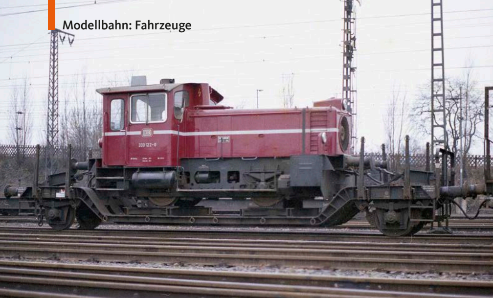
Auf einem Bahndienst-Tiefladewagen verladene und über die Kupplungen gesicherte DB-Kleinlokomotive der Leistungsgruppe III im Januar 1976 in Hamburg-Wilhelmsburg
