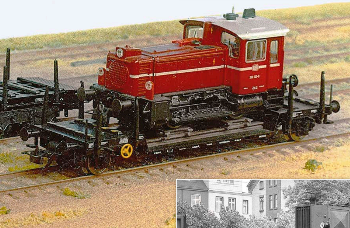
Aus einem Kbs/Kls-Rungenwagen umgebauter Bahndienstwagen mit einer Kö II – aufgenommen 1973 in Hamburg-Wilhelmsburg
