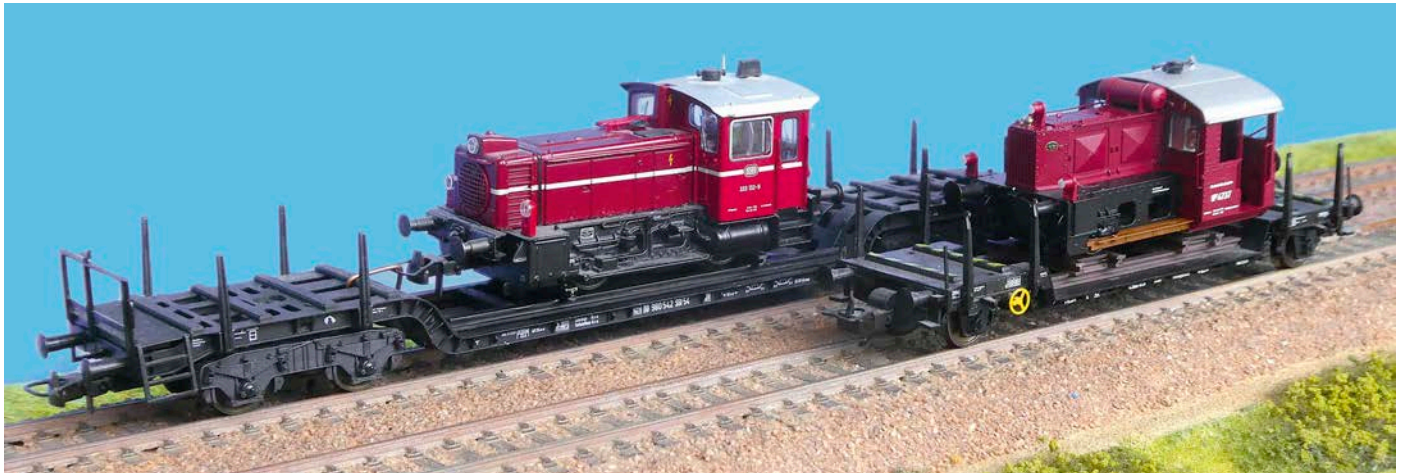
Verschiedene Möglichkeiten, wie Festlegehölzer bei Lokomotiven auf Flach- oder Tiefladewagen auf beiden Seiten angebracht werden können
