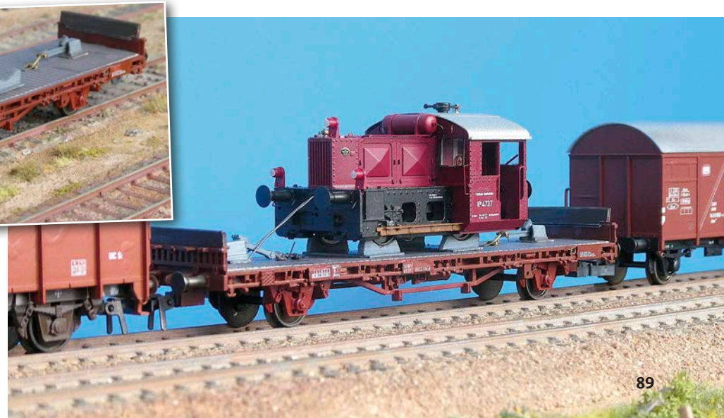
Aus einem Roco-SNCF-Flachwagen hergerichteter Spezialwaggon für Kleinloks mit einer Brawa-Köf II als Ladegut, für deren Räder und Kupplungen Aufnahmevorrichtungen angefertigt wurden Benno Wiesmüller (10)
