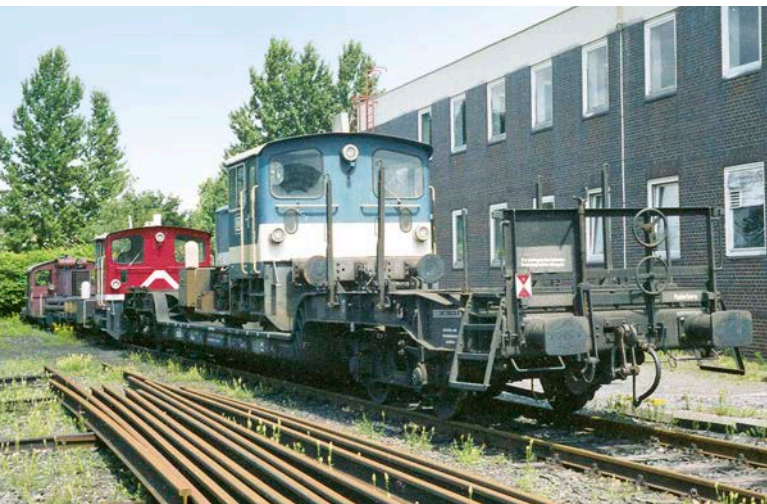
Vierachsiger Drehgestell-Tiefladewagen mit einer Köf III im Bw Wilhelmsburg 1993, wobei die Radsicherungen gut erkennbar sind
