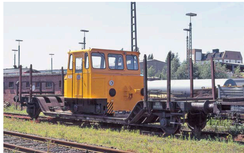
Ebenfalls über die Kupplungen arretiertes Akkuschleppfahrzeug aus dem einstigen DR-Bestand auf einem zweiachsigen Tiefladewagen
