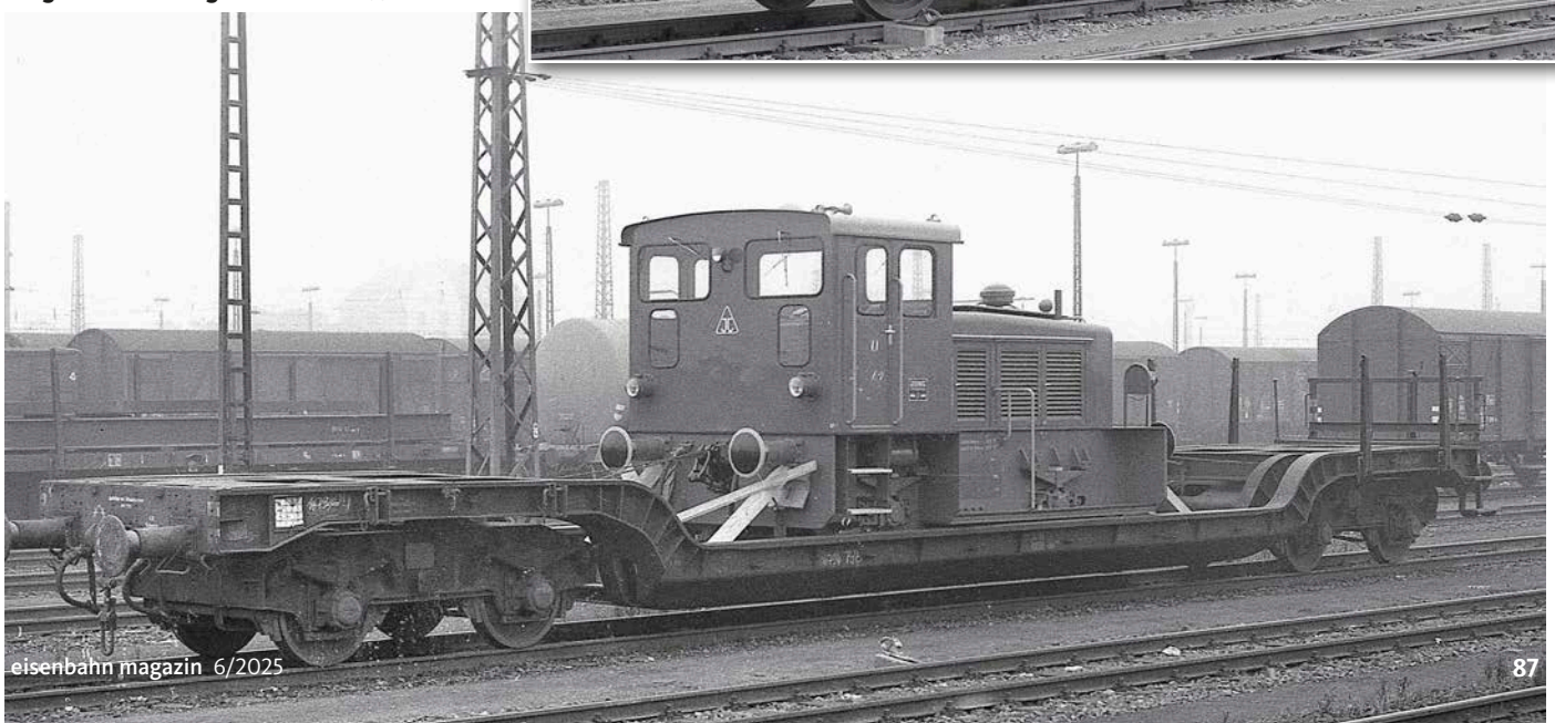
Durch hölzerne Verstreibungen gesicherte Jung-Werklok auf einem Tiefladewagen Uai 726 im Oktober 1971 in Hamburg-Wilhelmsburg Benno Wiesmüller (4)
