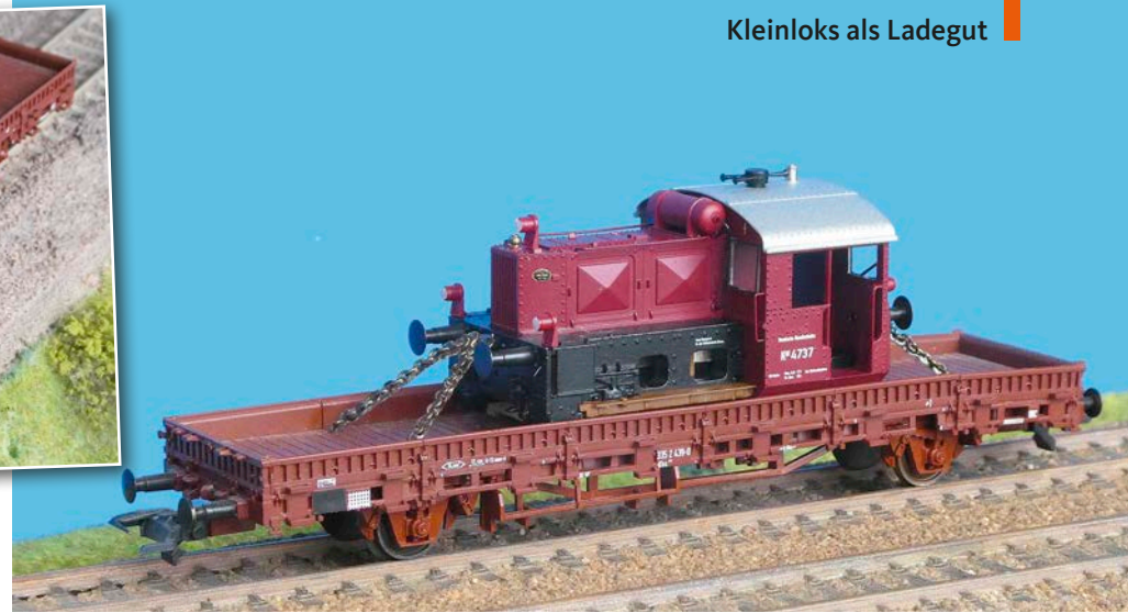
Brawa-Köf II auf einem Roco-UIC-Rungenwagen; dem Vorbild entsprechend steht die Maschine auf einem Holzgestell, was die Lokspurkränze und den Wagenboden schont
