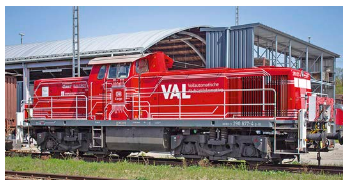
290 677 am 30. April 2024 in München Nord Rbf: Mit der umgerüsteten Rangierlok sind die Grundlagen für die Automatisierungstechnologie gelegt worden
