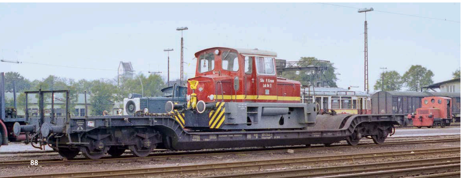
Mittels Ketten festgelegte Werklok der Firma Kruse auf einem vierachsigen Tiefladewagen 1981 an der Wilhelmsburger Ladestraße
