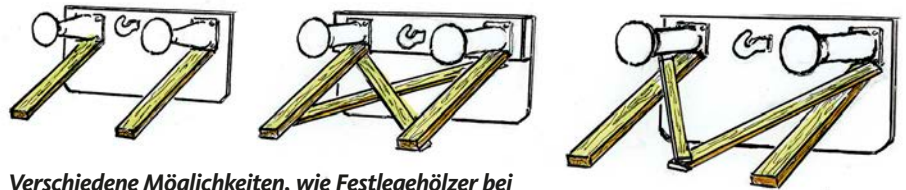
Verschiedene Möglichkeiten, wie Festlegehölzer bei Lokomotiven auf Flach- oder Tiefladewagen auf beiden Seiten angebracht werden können
