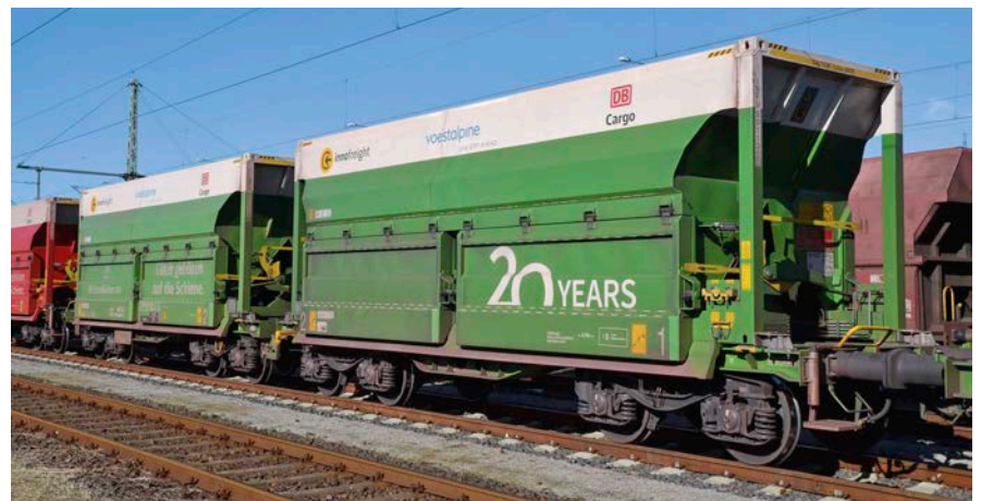
Dass moderne Güterwagen alles andere als langweilig und detailarm sind, beweist der abgebildete Sgmmrrs mit der Wagennummer A-IF 35 81 4658 045-3, welcher am 26. Februar 2023 in den GAG 47928 Linz Stahlwerke – Hamburg-Waltershof Hansaport eingereicht ist. Gut sind die gelben Containerzapfen zu erkennen, auf welchen der Aufbau abgesetzt ist. Für Containerwagen ungewöhnlich: Ein Großteil der Wagenanschriften ist auf den Rocktainern angebracht und nicht am Fahrzeugrahmen
