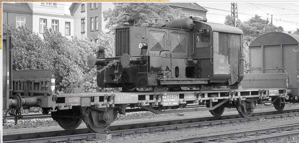
Aus einem Kbs/Kls-Rungenwagen umgebauter Bahndienstwagen mit einer Kö II – aufgenommen 1973 in Hamburg-Wilhelmsburg
