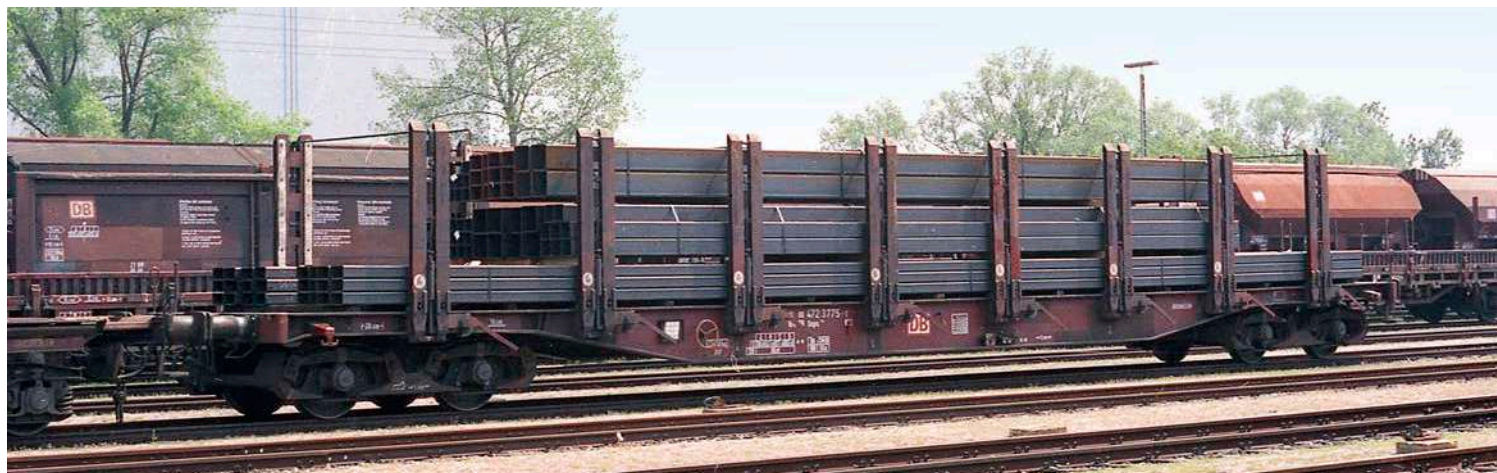
Drehgestellflachwagen Snps mit Niederbindungseinrichtung und beladen mit gebündelten Vierkantrohren im Mai 1997 im Hafen Hamburg
