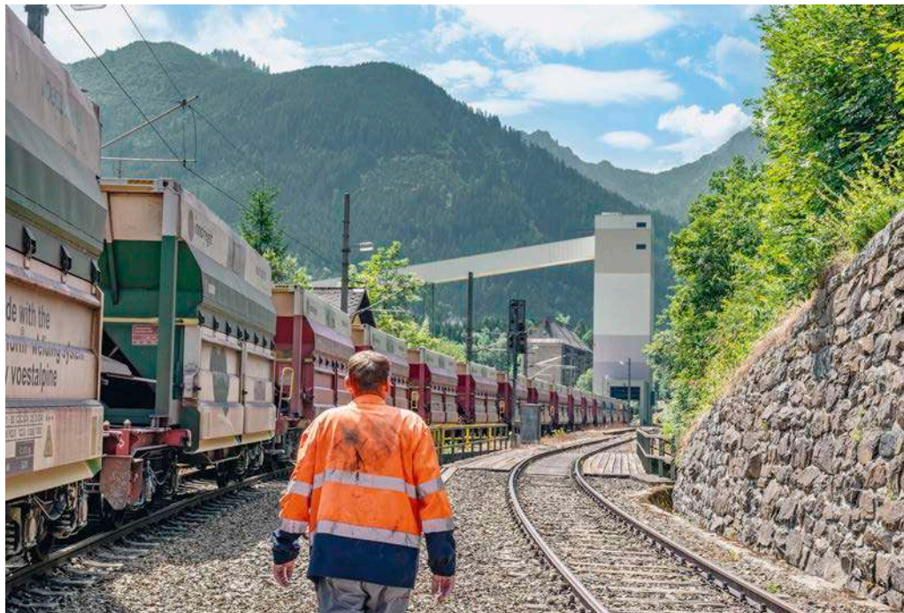
Unter den kritischen Augen des Verschiebers wird der noch leere Zug vor der Beladung durch den 37 Meter hohen Verladeturm (im Hintergrund) geschoben
