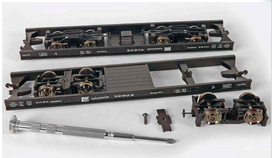
Montage des schwarz umlackierten Schnellenkamp-Rollwagens und der KS-Tauschdrehgestelle sowie die DR-Epoche-III-Beschriftung mit den Decals von Henke Modellbau
