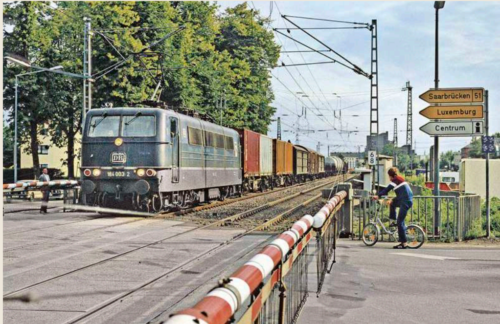
Die Weststrecke zählte zum klassischen Laufsteg der DB-Viersystemloks der Baureihe 184 des Bw Saarbrücken. Am 25. Juni 1985 passiert 184 003 mit dem mit Ng 67559 Trier West – Ehrang einen Bahnübergang
