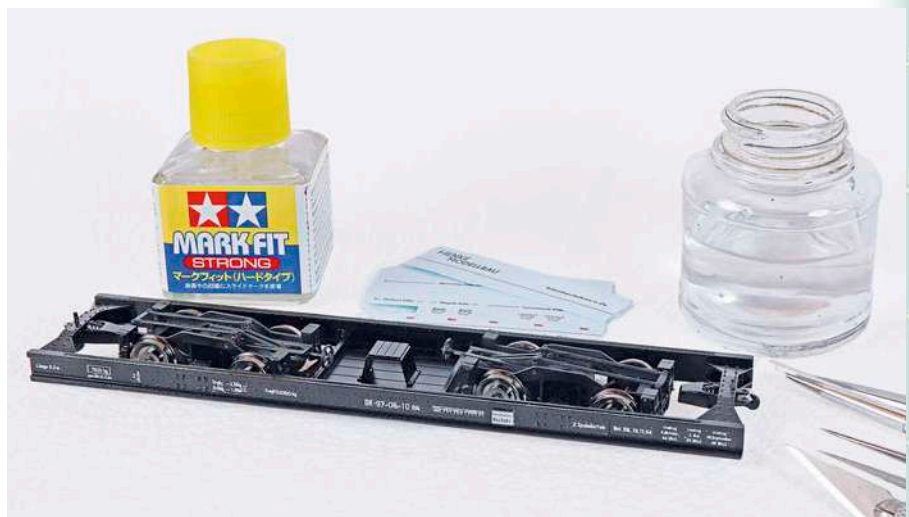
Montage des schwarz umlackierten Schnellenkamp-Rollwagens und der KS-Tauschdrehgestelle sowie die DR-Epoche-III-Beschriftung mit den Decals von Henke Modellbau
