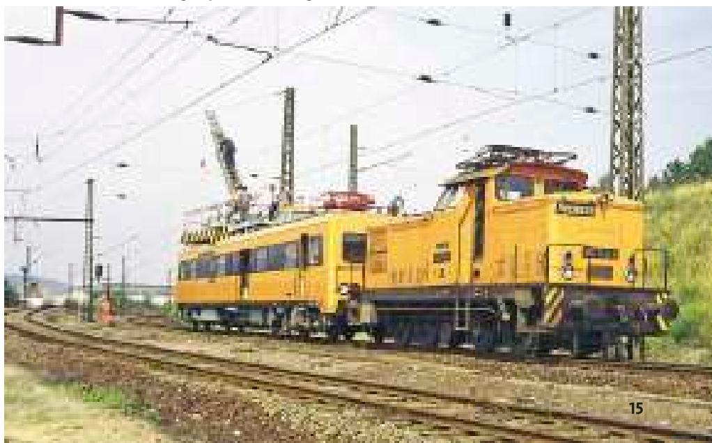
Die 106 742 gehört zu jenen Maschinen, die mit einem Lehrstromabnehmer ausgerüstet waren und bei Fahrleitungsreparaturen eingesetzt wurden
