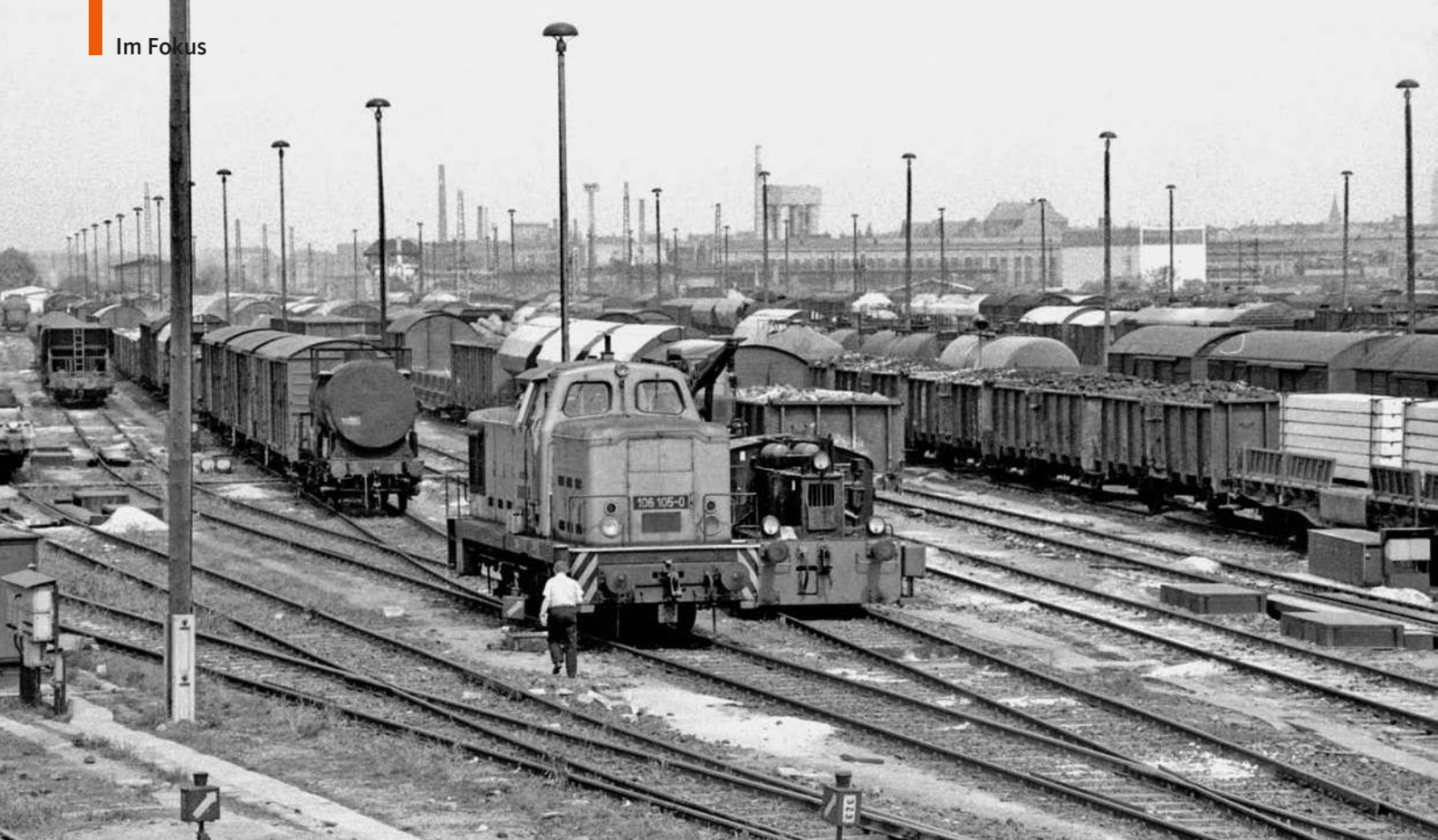
In erster Linie waren die Loks der DR-Baureihen 105/106 für Verschubaufgaben auf großen Rangierbahnhöfen gedacht, wie hier Mitte der 1970er-Jahre in Magdeburg-Buckau Lok 106 105 unter Beweis stellt
