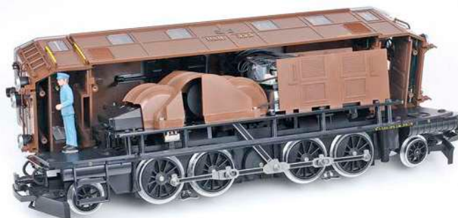
Die Antriebstechnik und Elektronik wird durch gestaltete Blenden verdeckt. Im Führerstand steht ein Lokführer
