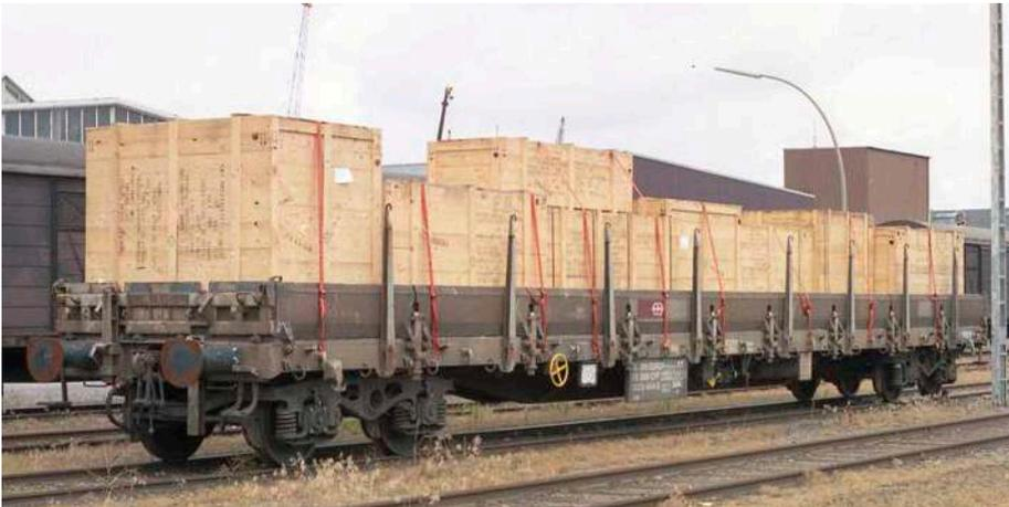
Die Kisten auf diesem Res mit Bordwänden sind mit Spanngurten gesichert
