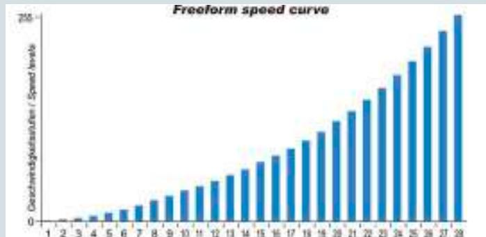
Für ein optimales Fahrverhalten kann mittels Digitalzentrale für jede Fahrstufe ein eigener Wert für die Motorspannung programmiert werden, wofür die CV 67 bis 94 zuständig sind. So kann mit geeigneten Triebfahrzeugen besonders gefühlvoll rangiert werden
