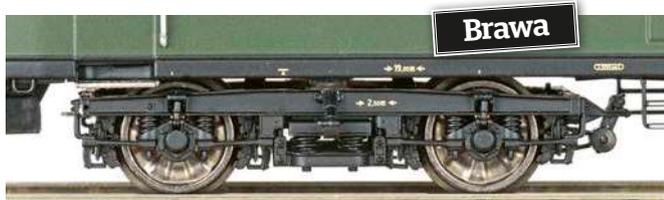
Die Bremsgestänge und die Riemenlichtmaschine sind separate Teile, die Radscheiben zeigen sich vorbildgerecht gewellt
