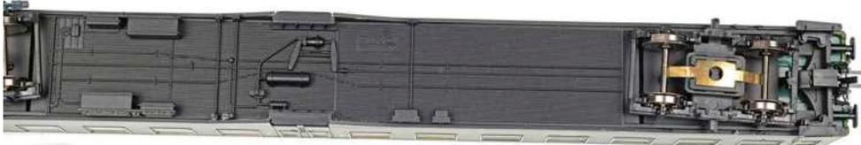
**Piko** *Alle Details sind angeformt. Der Steuerwagen hat Achsschleifer*
