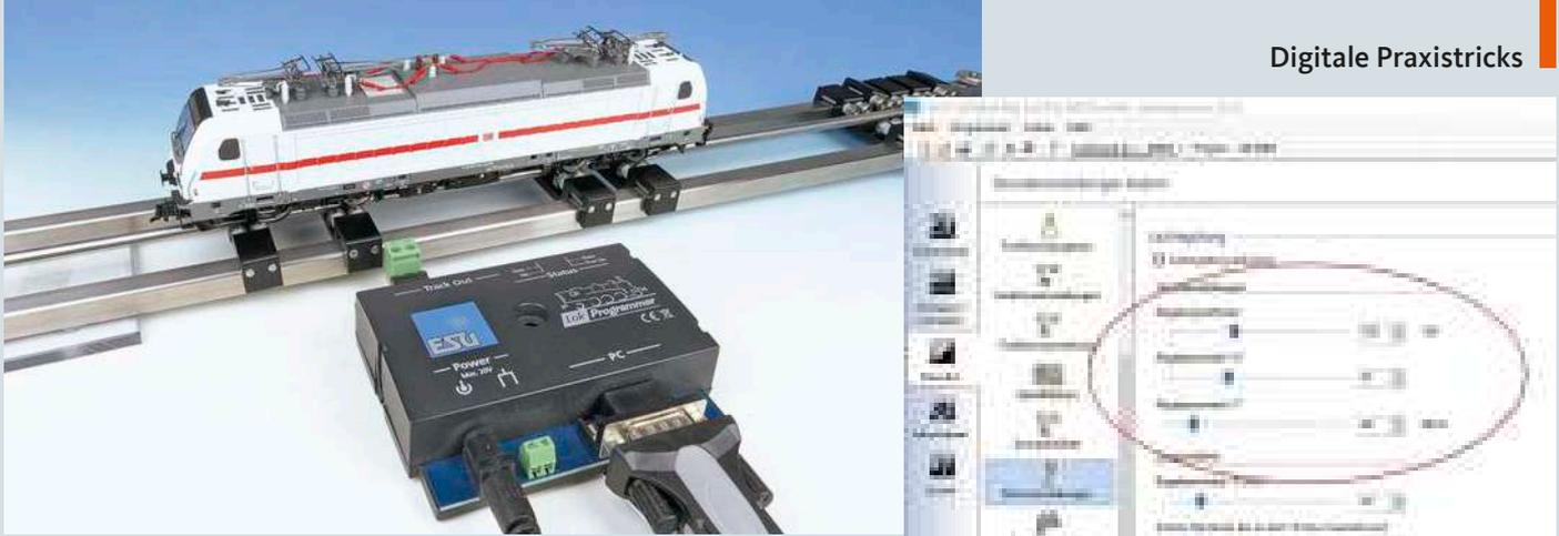
**Sämtliche Einstellungen in puncto Lastregelung müssen stets im Zusammenhang betrachtet werden. Deshalb am besten immer nur einen Wert verändern, um die Wirkung beurteilen zu können! Hier die Einstellung der Lastregelung anhand des ESU-LokProgrammers in Verbindung mit dem PC**
