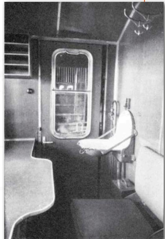
che mit dem Wannentender ließen sie zunächst mehrere Tender 2'2'T 30 umrüsten, die nun jedoch eine deutlich größere Kabine mit zusätzlichen seitlichen Fenstern erhielten. Von diesen mit der Reihe 52 gekuppelten Tenders besaßen die ÖBB nicht nur viele, sondern die Bauart bot auch den Vorteil, den durch die Kabine um vier
