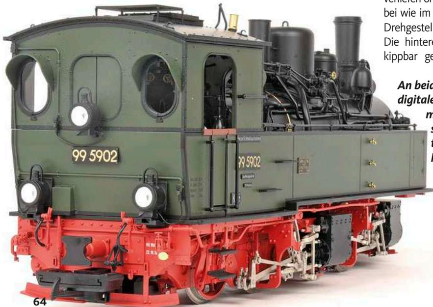
*An beiden Seiten sind digitale Kupplungen montiert, die sich austauschen lassen*
