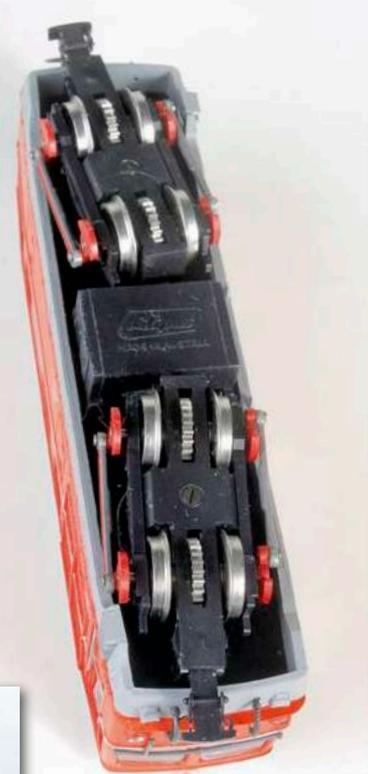
**Ein konventioneller Antrieb über Zahnräder auf sämtliche Radsätze zeichnet Liliputs 2095.11 aus. Leider brachen später bei vielen Modellen die Gestänge seitlich der Drehgestelle**
