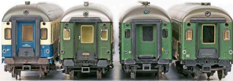
*Die Stirnseiten wirken verschieden nicht nur durch teilweise unterschiedliche Fenstergrößen, sondern auch durch die variierenden Hervorhebungen der Fensterrahmen und der Scheibenheizeinrichtungen*
