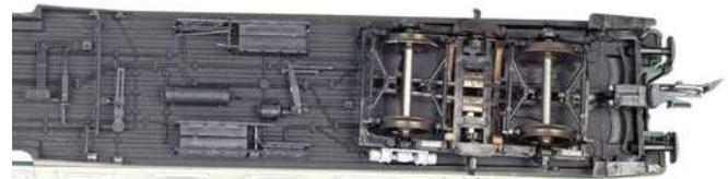
**Boden mit vielen Steckteilen und 2,16 mm schmalen Rädern**
