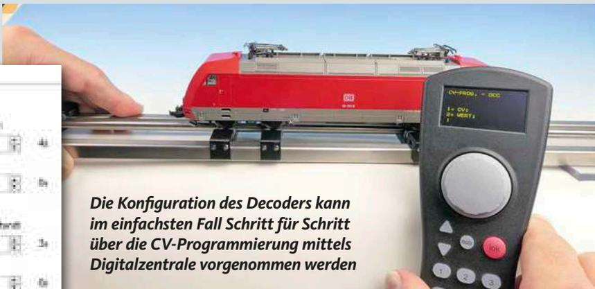
Die Konfiguration des Decoders kann im einfachsten Fall Schritt für Schritt über die CV-Programmierung mittels Digitalzentrale vorgenommen werden
