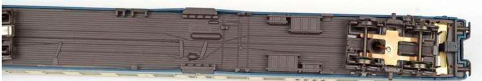
**Märklin** *Die Details am Wagenboden sind angeformt. Die Drehgestelle tragen Mittel- und Achsschleifer*
