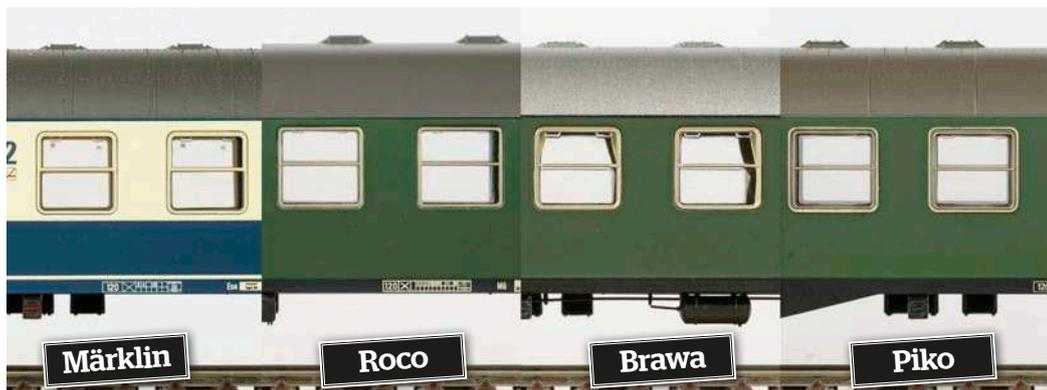
**Der Schnittvergleich der Wagenkästen: Trotz grundsätzlich gleicher Dachhöhen bei Märklin, Brawa und Piko bestehen deutlich Unterschiede bei den Fensterlagen und -rahmenproportionen**
