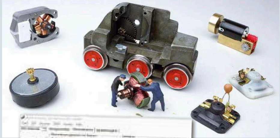
Je nach Motorbauart muss die PWM-Frequenz des Decoders angepasst werden. Das geschieht entweder über die Programmierung in CV 9 oder mithilfe einer Programmiersoftware wie hier jener von Zimo. Bei Glockenanker-Motoren sollte die Frequenz mindestens 15 Kilohertz betragen
