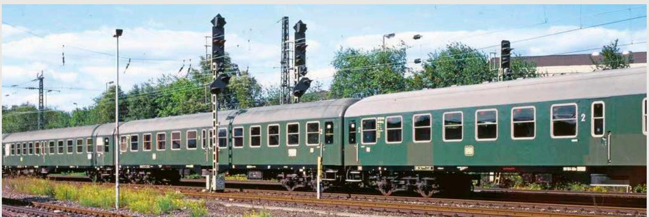
Wenn die Signalbauart 1969 nicht wäre, könnte man fast in alte Zeiten der 1950er-Jahre zurückversetzt sein: Sonderfahrt aus yl-Wagen zu einem Gewerkschaftstreffen 1996 in Bonn-Mehlem. Zu sehen sind zwei AB-Wagen und rechts im Anschnitt ein BPw4ymg
