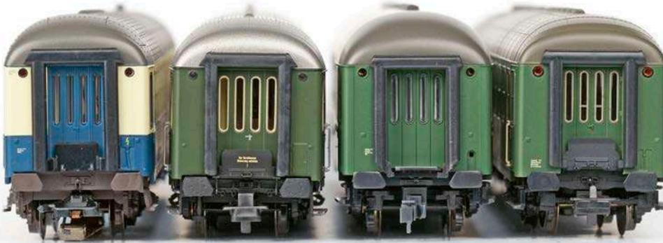
*Variantenbreite von Puffertellern, Türfenstern, Gummiwülsten, Blechen und Schlusslichtergrößen*
