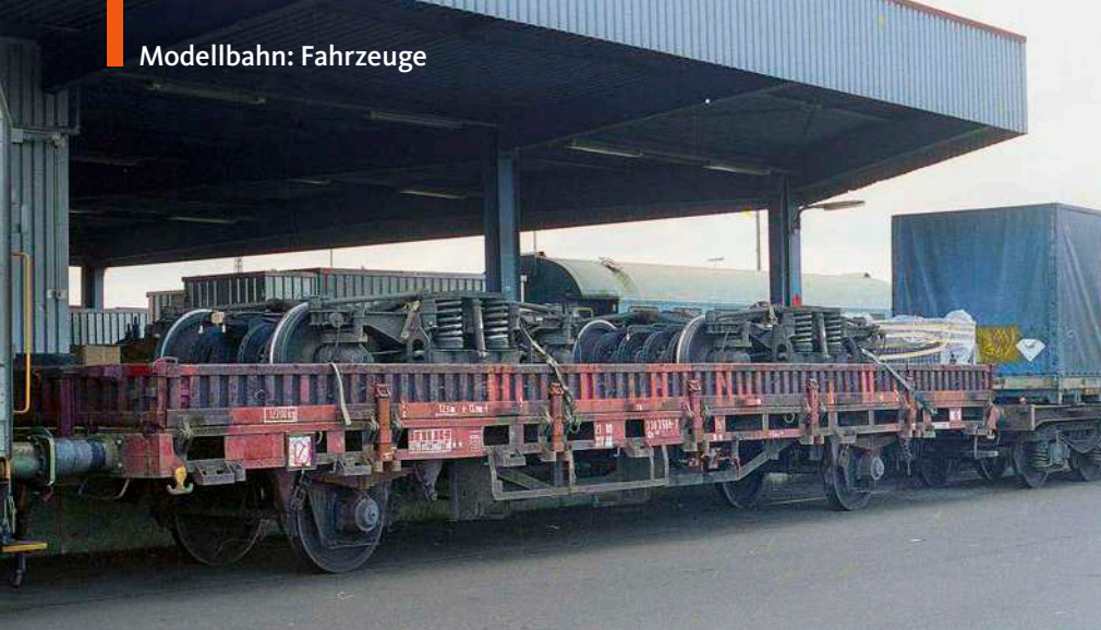
Im Jahr 2000 in Maschen fotografierter Kls-Rungenwagen mit zwei Drehgestellen als Ladegut, die mittels Holzgestellen und Gurten fixiert sind
