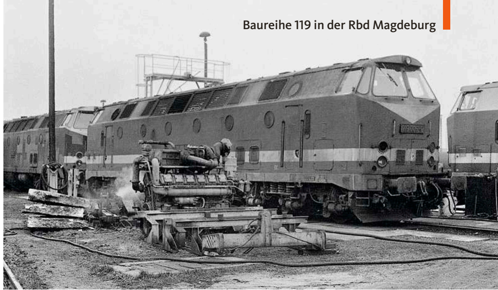
Bild einer desaströsen Beschaffung: Im Bw Oebisfelde befindet sich im November 1990 ein ausgebauter rumänischer Motor vom Typ MB 820 SR vor 119 009 Friedhelm Köhler/Slg. Dirk Endisch
