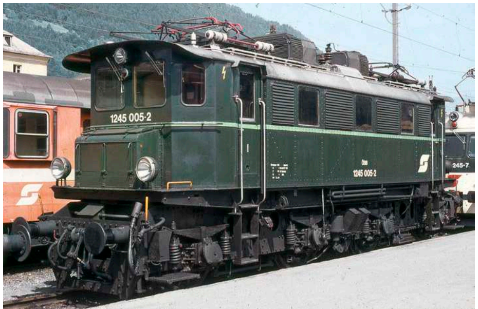
1245.527 ist die vormalige 627 aus der Flachland-Teilserie mit 1971 nachgerüsteter E-Bremse zur Eigengewichtsabbremmung – aufgenommen 1984 in Leoben Donawitz Dr. Helmut Petrovitsch (2)
