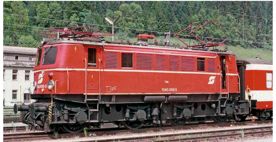
Der Abbau der Bremswiderstände vom Dach ab 1990 aufgrund stillgelegter E-Eigenabbremsung veränderte die Silhouette der Reihe 1040 deutlich – hier 1040 008 im August 1997 in Hieflau
