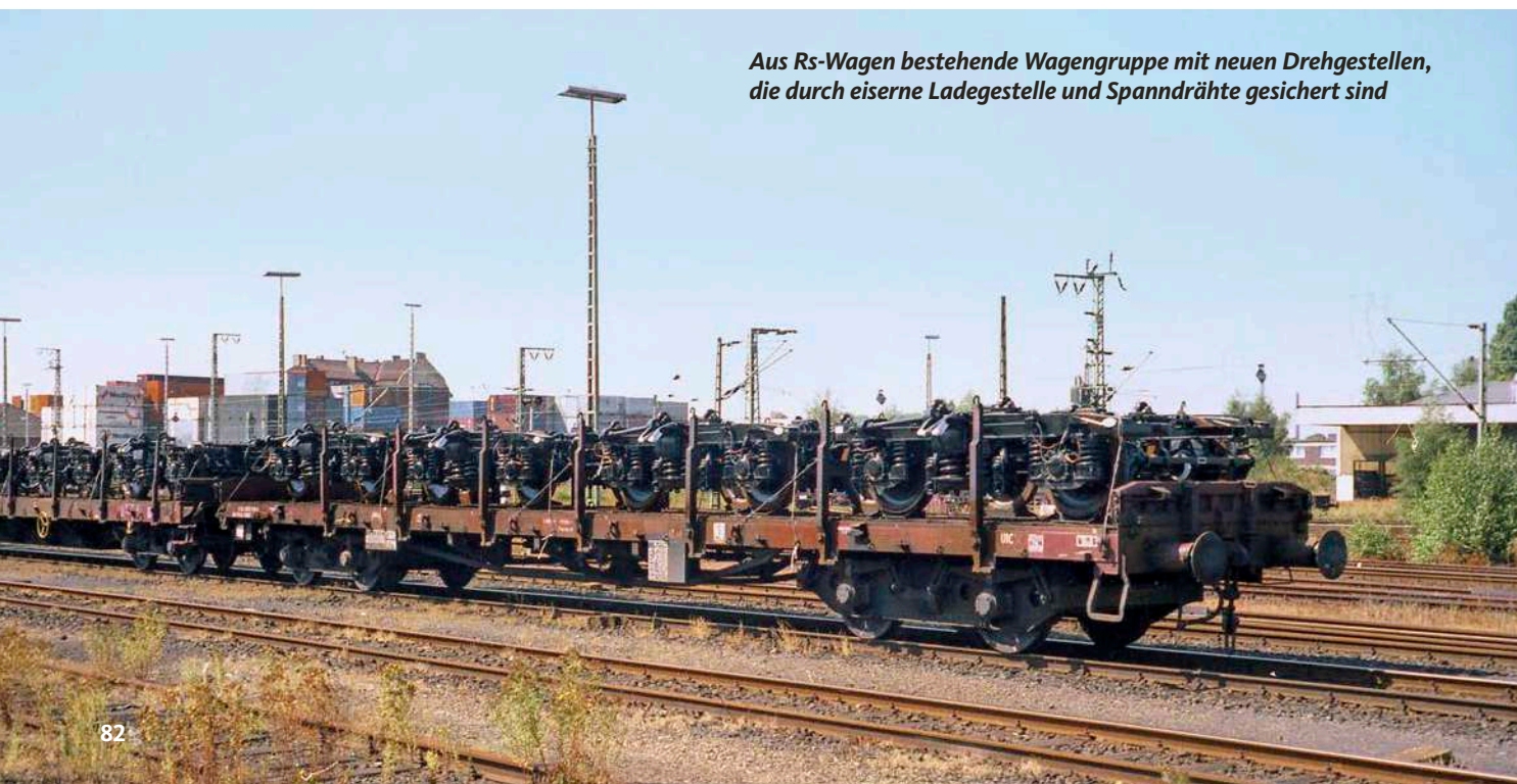
Durch je vier Ladegestelle und Ladegurte gesicherte Drehgestelle auf einem vierachsigen DB-Flachwagen, aufgenommen im Juni 2001 in Maschen
