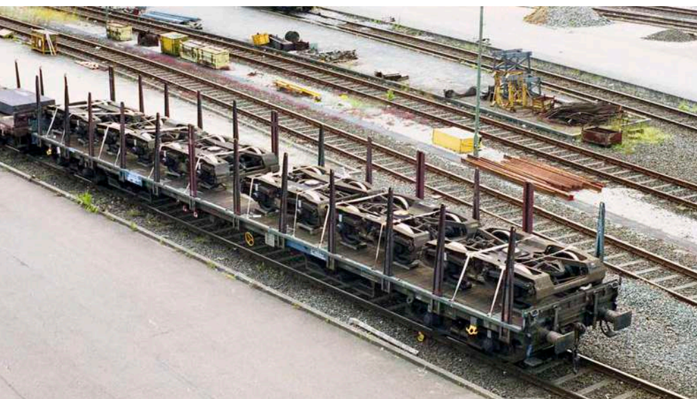
Durch je vier Ladegestelle und Ladegurte gesicherte Drehgestelle auf einem vierachsigen DB-Flachwagen, aufgenommen im Juni 2001 in Maschen
