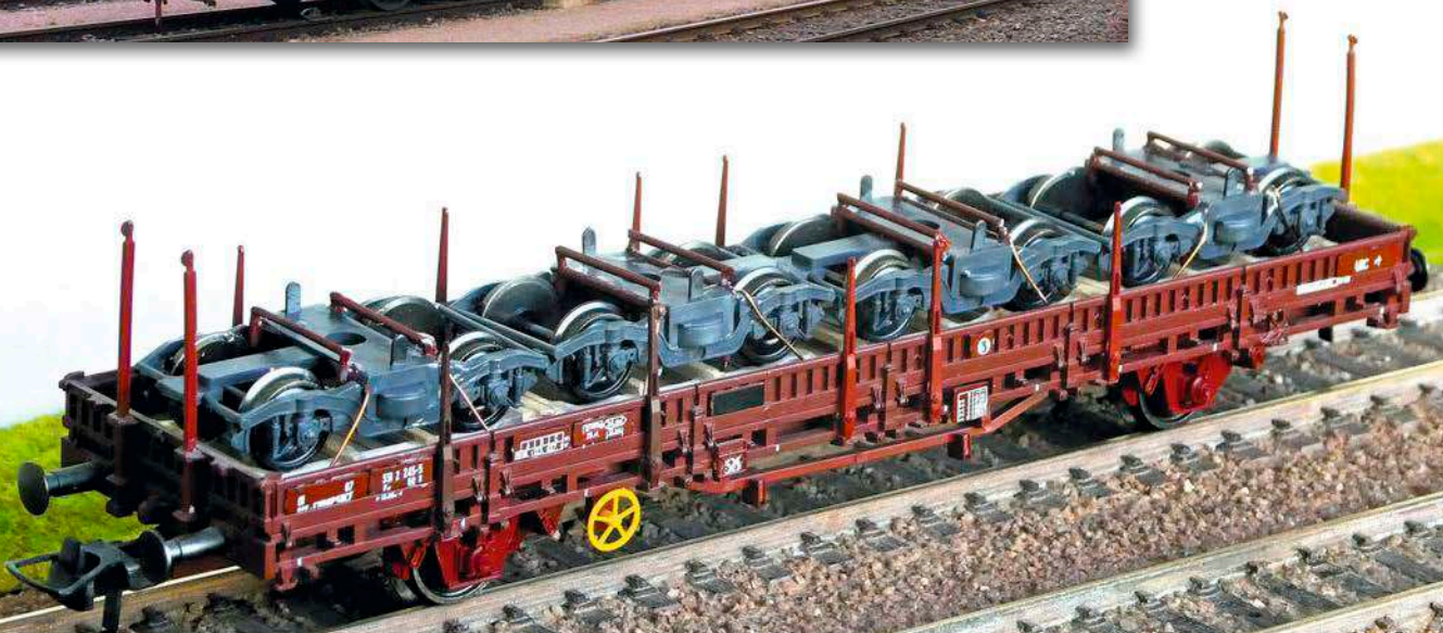
Eine aus drei Ks-Wagen bestehende Gruppe mit jeweils vier Schmalspur-Drehgestellen von Ganz/Budapest beladen, aufgenommen im September 1996 im Hamburger Hafen; die Umsetzung im Maßstab 1:87 (unten) entstand auf Basis eines Roco-Rs der SNCF und vier H0m-Drehgestellen von Bemo Benno Wiesmüller (6)
