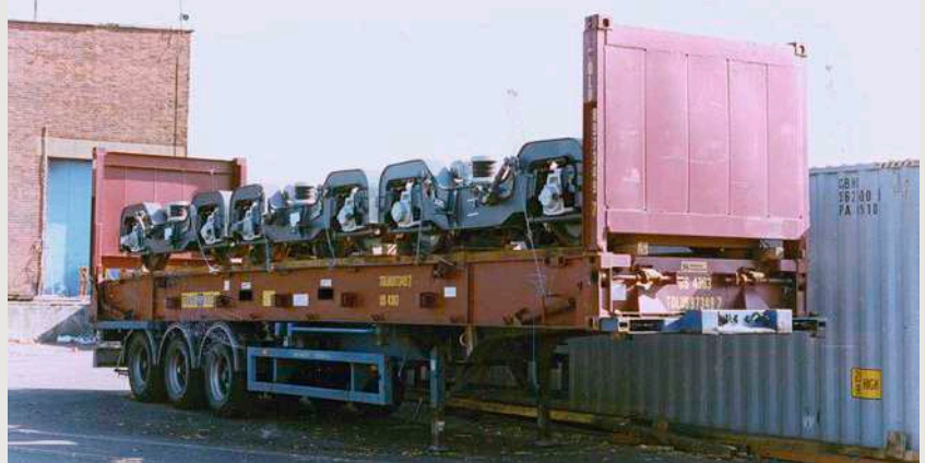
Lkw-Sattelaufleger mit einem Flat-Rack-Container, auf dem drei ADtranz/DUEWAG-Eisenbahn-Drehgestelle verladen sind
