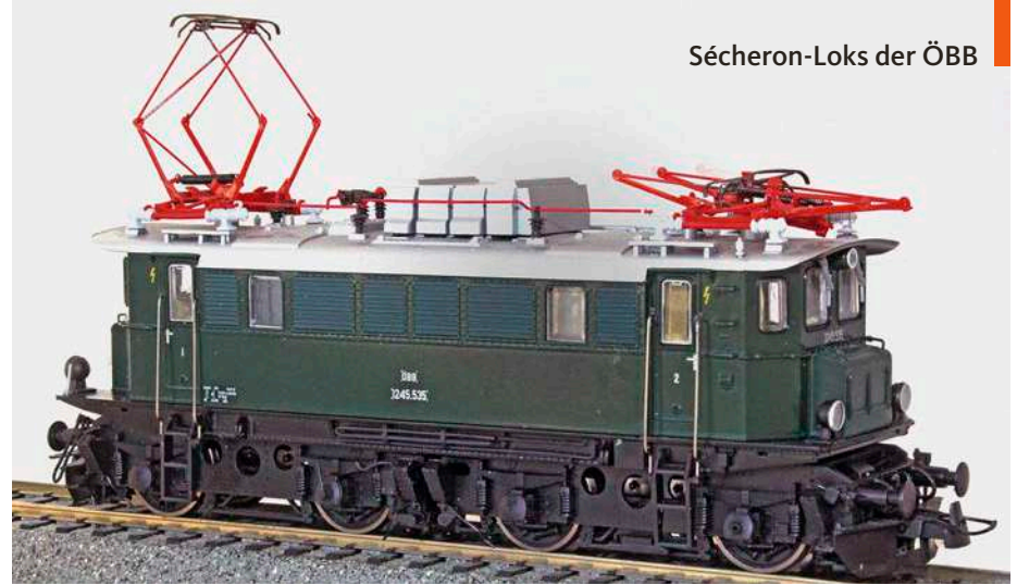
2009 präsentierte Roco die 1245.535 in der ÖBB-Modernisierungsform der 1960er-Jahre, aber noch mit den unterschiedlich weit nach vorn reichenden, nicht vereinheitlichten Frontplattformen – laut Beschriftung gemäß Bauzustand von 1970
