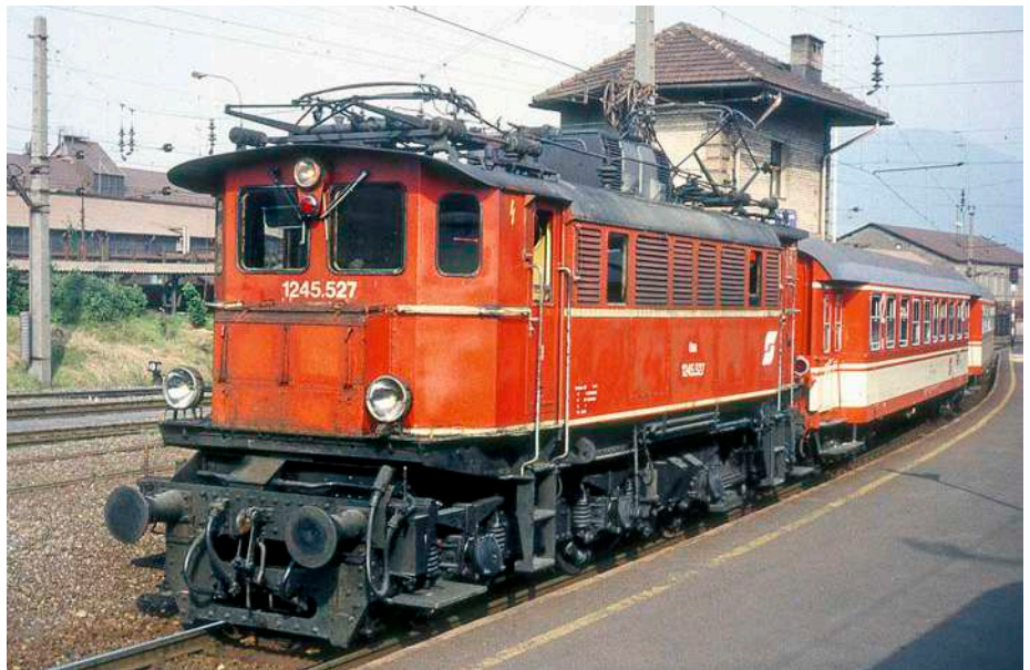
1245.527 ist die vormalige 627 aus der Flachland-Teilserie mit 1971 nachgerüsteter E-Bremse zur Eigengewichtsabbremmung – aufgenommen 1984 in Leoben Donawitz Dr. Helmut Petrovitsch (2)
