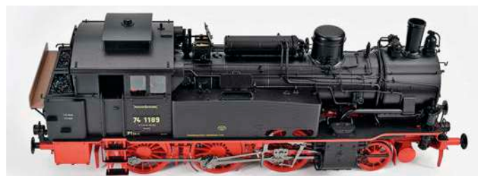
Blick auf die Lokführerseite mit geöffneter Klappe des Sanddoms
