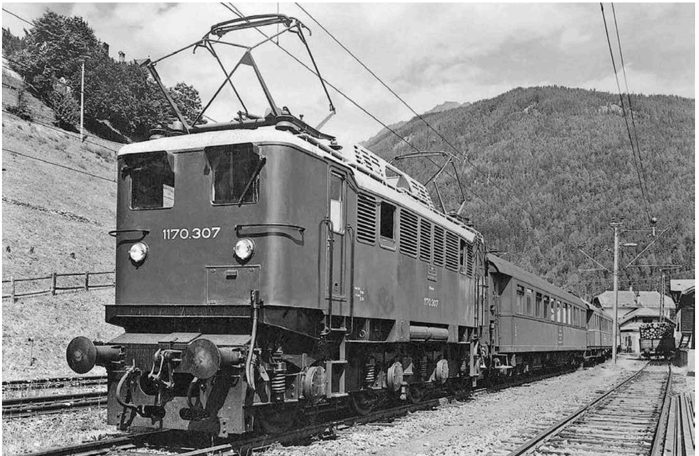
Die ÖBB-Ellok 1170.307 entstammt der ersten Nachkriegsbauserie Österreichs aus dem modifizierten Fortbau der 1170.2 mit vereinfachter Kastenform. Die Aufnahme entstand 1951 während einer Messfahrt am Tauern
