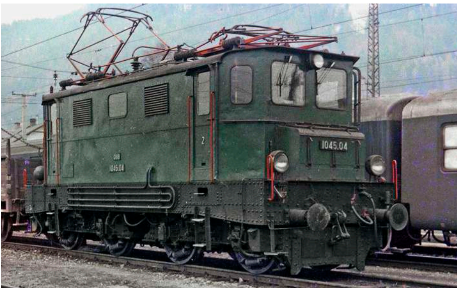
1045.06 am 15. März 1975 in Hiefalau im Gesäuse; deutlich treten die an diesem Lokomotivtyp nachträglich vorgenommenen massiven Verstärkungen im Bereich der Pufferträger hervor
