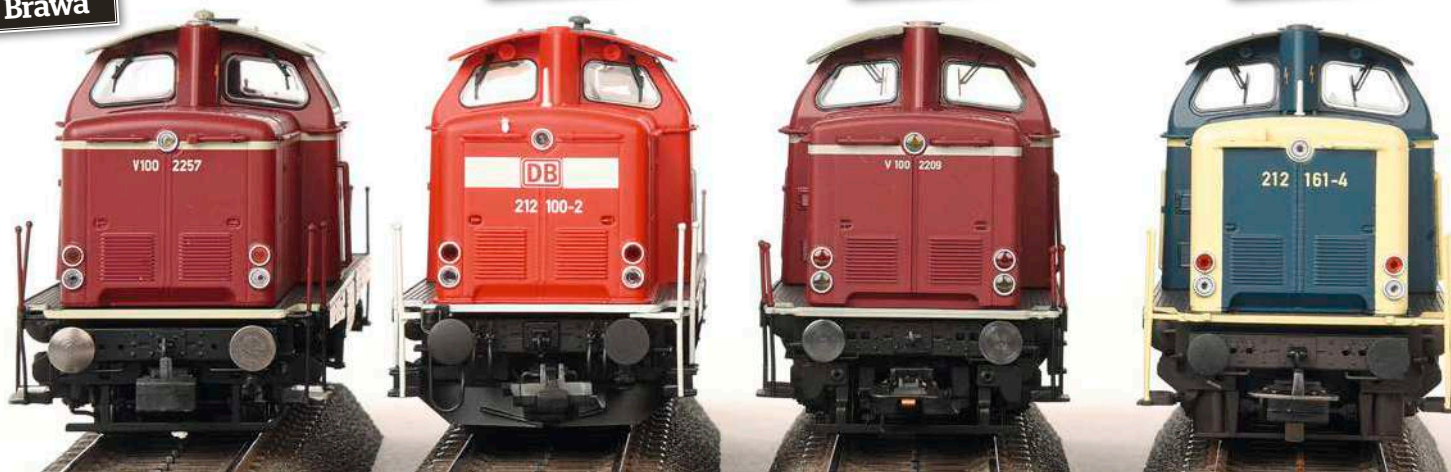
Frontansicht auf die kürzeren Vorbauten, die im unteren Bereich vor dem Heizdampfkessel entsprechende Lüftungsöffnungen aufweisen
