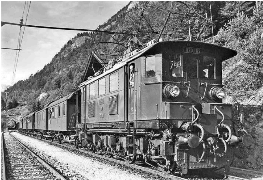
Die Ellok 1170.102 aus der Erstserie für die Mittenwaldbahn legt 1929 einen Halt in der Ausweiche Martinswand ein. An der Front die Schläuche für die Saug- und Druckluftbremsen Werk/Slg. Dr. Helmut Petrovitsch
