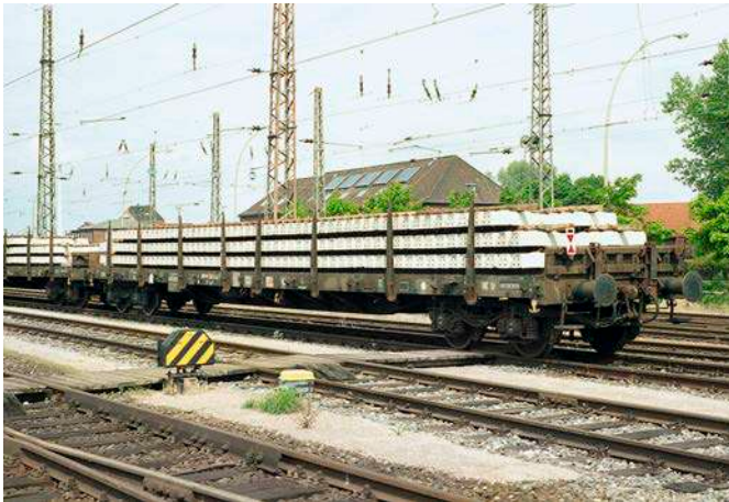
Vorbildbeispiel von neuen Betonschwellen mit Kleineisen auf einem Bundesbahn-Güterwagen der Gattung Rs verladen; für die HO-Modellumsetzung wurden von einem Peco-Gleisjoch abgetrennte Einzelschwellen auf ein Piko-Modell verfrachtet
