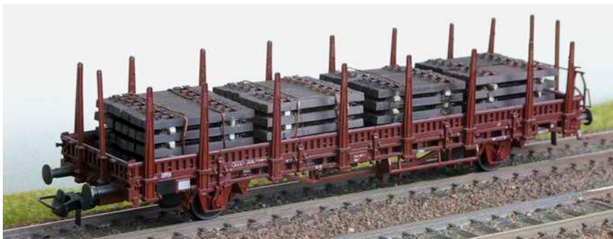
Auf dem H0-Modell eines Kbs-Wagens in Längsrichtung mit hölzernen Zwischenlagen verladene Holzschnellen mit Kleineisen; auch hier sind die Schwellen gebündelt und verzurrt
