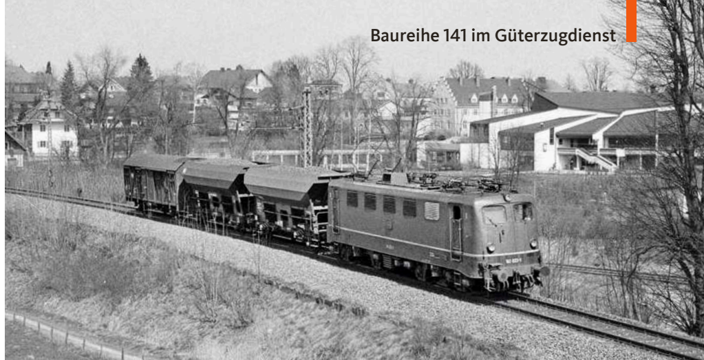
Mit ihrer geringen Achsfahrmasse waren die Elloks der Baureihe 141 besonders geeignet für den Einsatz auf Nebenstrecken. Mit der Üg 67672 strebt die mit Einfachlampen ausgestattete 141 033 am 11. April 1983 in Murnau Ort Oberammergau entgegen Brian Rampp
