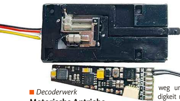
Decoderwerk: motorischer Antrieb für Bettungsgleise
