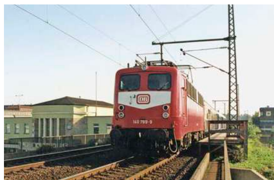
Neben der ersatzweise eingesetzten 140 789 erkennt man gut die Holz-Stahl-Konstruktion des Behelfsbahnsteigs am Mülheimer Hauptbahnhof
