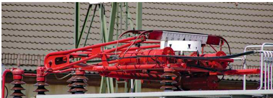
Der Messstromabnehmer VS H4 verfügt über einen stufenweise einstellbaren Anpressdruck und eine Skala zur Kontrolle des Zickzack-Laufs der Fahrleitung (Foto auf 708 332)
