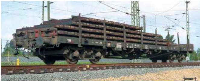
Neue Holzschwellen mit Unterlegplatten und Befestigungsmitteln auf einem Rs-Wagen; zwischen den Schwellenschichten sind hölzerne Zwischenlagen im Verlauf des Kleineisens vorhanden
