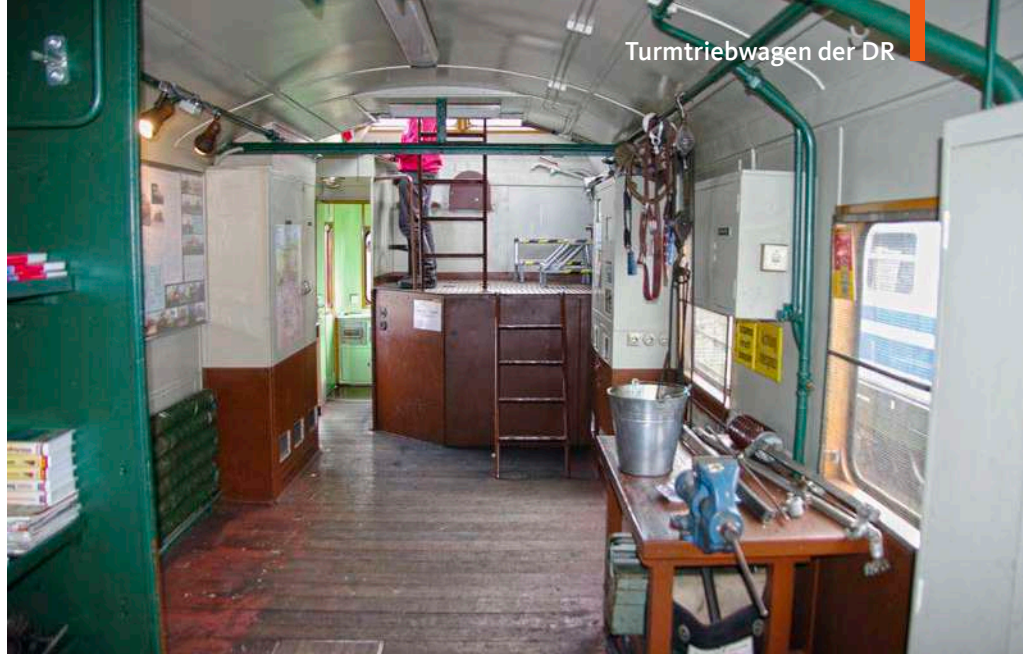
Blick in den Werkstattraum von 708 202 mit Platz für Ersatzteile, Werkzeuge und Werkbänke. Unter dem mit Leitern ausgestatteten Podest der Aussichtskanzel befindet sich die Antriebsanlage für die Hubarbeitsbühne
