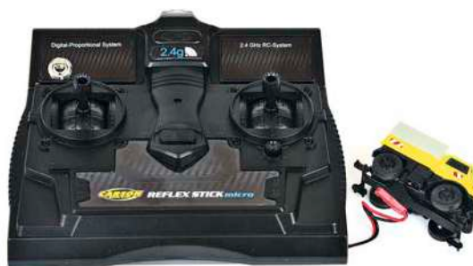
Der Zwei-Wege-Unimog wird über ein Kabel an der Fernsteuerung geladen
