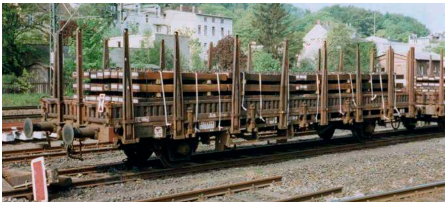
Kbs-Güterwagen mit Schwellen samt Kleineisen; zwischen den Schichten liegen Holzzwischenlagen. Die Schwellenpakete sind in Längsrichtung verladen und durch Spanngurte gesichert
